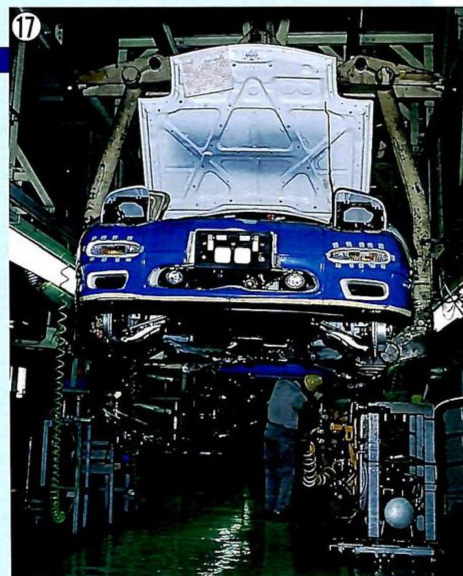
▲エンジン、駆動系、足まわり、エキゾースト系などパワートレインと駆動系が終了し、作業は細部の組み付け行程に入る。当たり前だが、絶妙なタイミングでパーツが流れてきたり、各作業行程で終了を告げるアナウンスがされるなど、すべてのパーツと作業が管理されていて組み立てラインは止まることのない。
