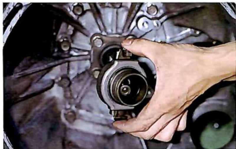
11 クラッチリリースカラーもスリーブから取り外してしまおう。これもリリースフォーク同様、必要な時までフォークと一緒に保管しておこう。
