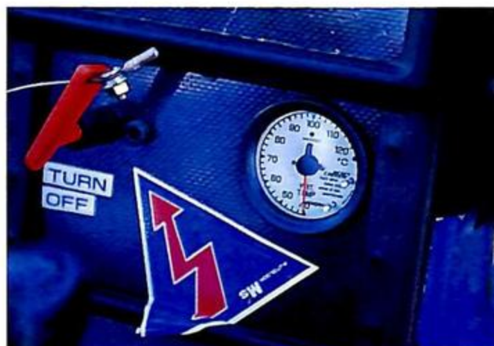
▲全車必ずついているのが、サーキットブレーカーとかカットオフスイッチともいうこのキルスイッチで、左フロントと同時に作動してすべての電源をオフにする。
