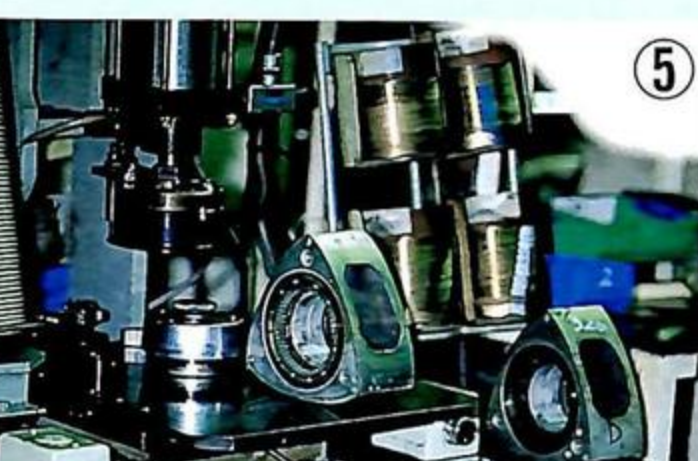
▲ローターにオイルシールをセットする。ここまでがローターに関するエンジン組み付けの事前作業。この後、シール類がセットされ、エンジン組み付け作業の中で、サイドハウジングやエキセントリックシャフトにドッキングする。
