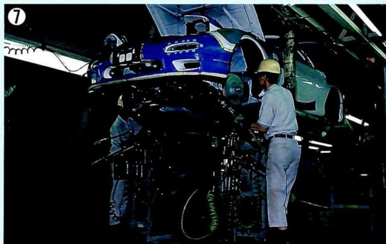
▶エンジン、ミッション、サスペンションASSYがドッキングした状態でクロスメンバーにマウントされ、寸分狂いもなく下からボディに納まってしまふ。ここでメンバーの取り付けボルトを仮締めする。
