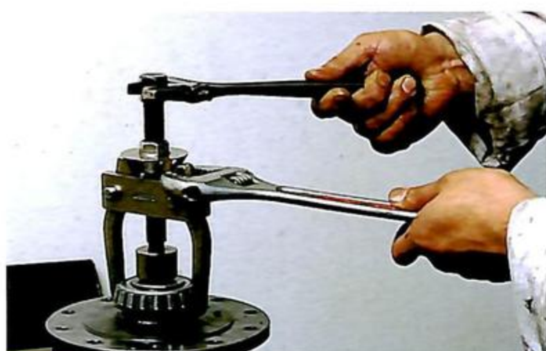
14 サイドベアリングを再使用する場合は、このようにベアリングプーラーを使って抜き取る。または、予め新しいベアリングを2個用意しておいてもいい。
