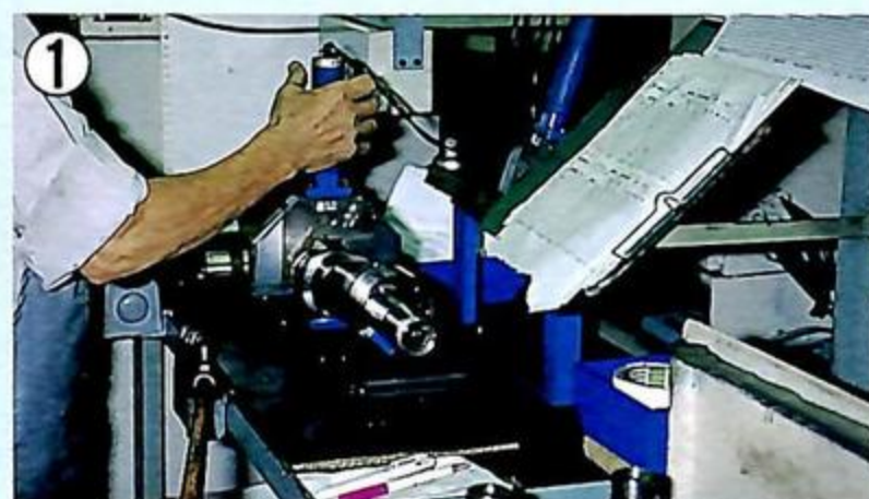
▲エキセントリックシャフト軸寸法を測定する。この結果を基にして、サイズの合ったメタルの入ったローターを組み合わせる。
