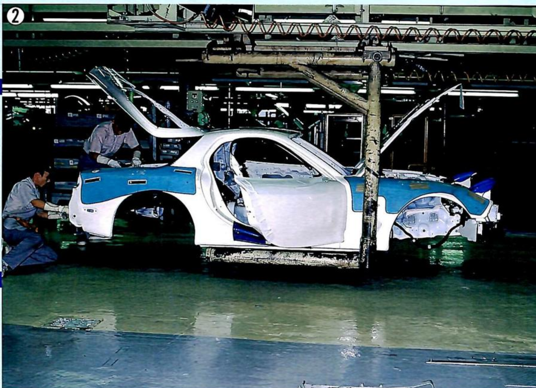
▲FD3Sは、すでにドアとボンネット、リフトゲートが組み付けられ、この後で前後バンパーが組み付けられた。
