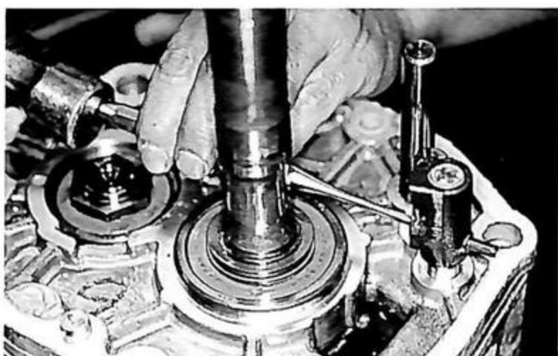
12 ピンはポンチとハンマーを使って、ゆっくりと叩きながら抜く。とくに抜ける直前は、ピンを飛ばさないように注意しながら行おう。
