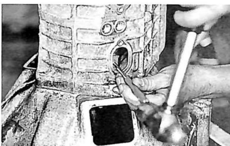
16 ブラッジャーが付いていた部分の、下の窓からポンチを入れて、真ん中のシャフトのピンを抜く。これで二重かみ合いが可能になる。
