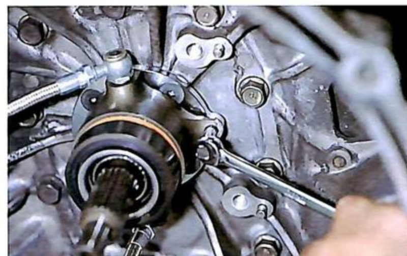
17 その位置決めシャフトを取り付けて、ハイドロリリース本体をロックする。作動するのは、ハイドロリリース先端のベアリング部となる。
