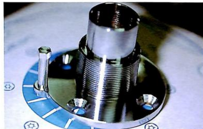
13 これがキットのスリーブで、同じくキットのハイドロリリースがここに固定状態で組み付けられる。つまり、リリース自体が油圧によって作動する。
