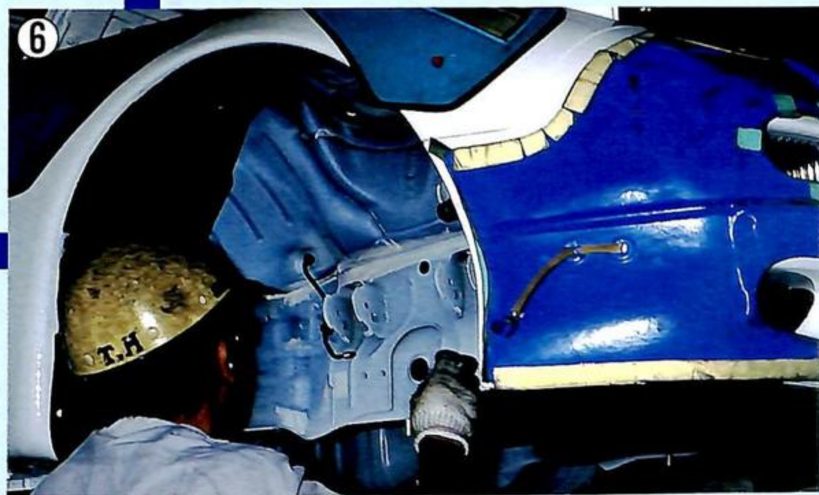
▲フェンダー内のマッドガードを取り付ける。
