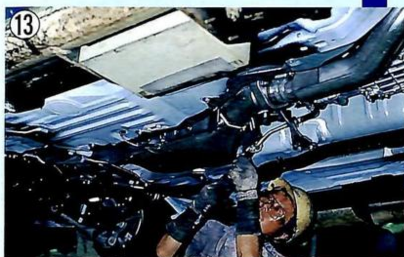
▲エキゾーストパイプや触媒、マフラーの組み付け。エキゾースト系の作業は簡単なパーツだが、その素早さは想像以上のものがある。
