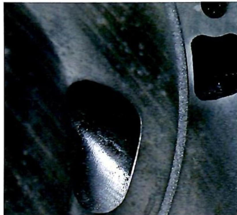
▲これではほぼ完成に近い。ポート形状自体は大幅に拡大されていらないが、段付きが修正されて表面のザラツキもなくなり、効率の良い吸入が行われる。
