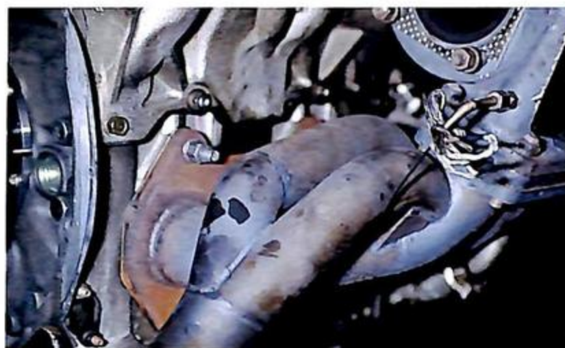
▲最終パワーチェック前に各パーツのチェックも行う。テスト中にマニホールドが割れて破損し、せっかくのパワーチェックができないと困るからだ。
