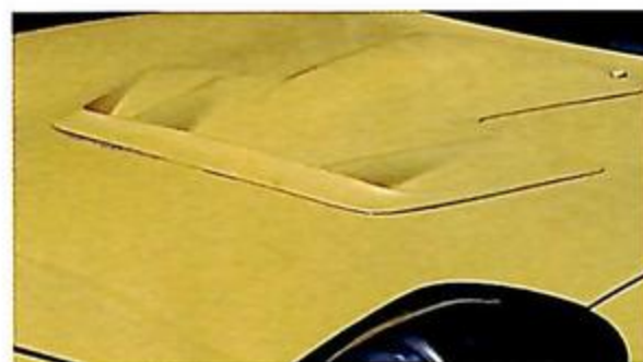
◀流入エアは、入り口ばかり広げてもダメ。このようなデュアルアウトレット・クーリングボンネットの装着で、エアが十分に抜けることが必要だ。
