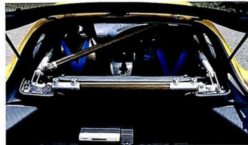
▲6ポイントのアルミロールバーは、スペシャルワンオフされたカーボンで覆われている。
