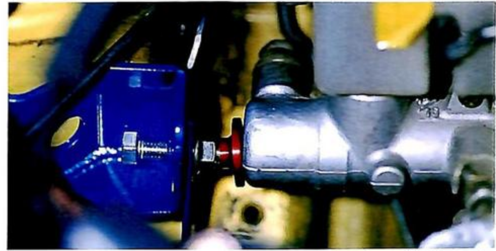
▲ブレーキシリンダーストップバーの有無は、フルブレーキングをすればわかる。やっぱり必需品だ。
