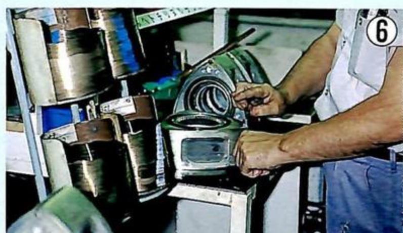
▲ローターにオイルシールをセットする。ここまでがローターに関するエンジン組み付けの事前作業。この後、シール類がセットされ、エンジン組み付け作業の中で、サイドハウジングやエキセントリックシャフトにドッキングする。
