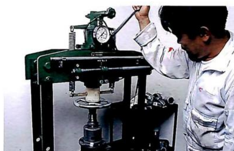
3 油圧プレスを使わないでベアリングを叩いて組み込む方法もあるが、ベアリングが最後まできちっと入っていないと、あとでガタが出る原因となる。
