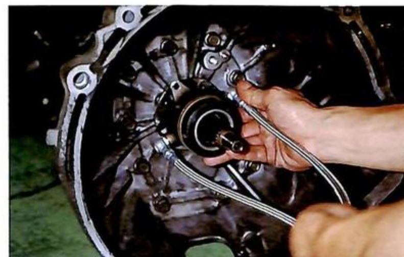
16 ハイドロリリースをスリーブにねじ込みながら組み付ける。一番奥までねじ込んでから約2回転戻した位置で、リリースとスリーブの位置決めを合わせる。
