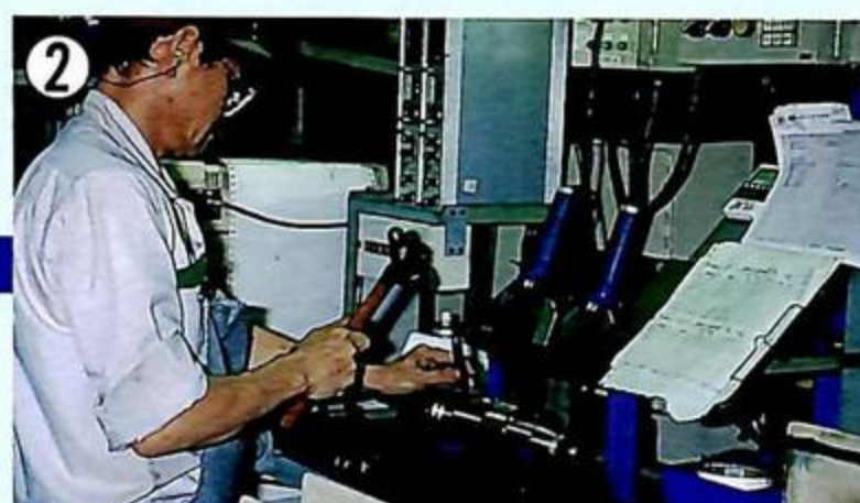
▲エキセントリックシャフト軸寸法の測定結果をナンバーパンチで刻印。この作業が終わると、やっとなん人前のエキセントリックシャフトになる。
