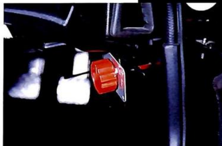
▲エンジンは完璧なサンプ方式となり、ドライサンプ化され、そのエンジンオイルタンクがここにあった。レーシングエンジンでは常識のドライサンプは、よりエンジンを低くマウントすることが可能だ。
