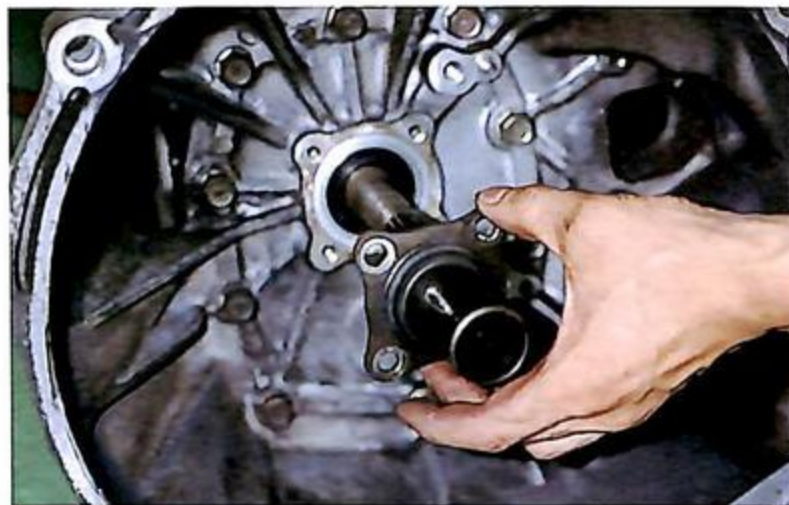
12 ボルト締めで組み付けられている、リリースカラーがスライドするスリーブも、キットのパーツと交換する。
