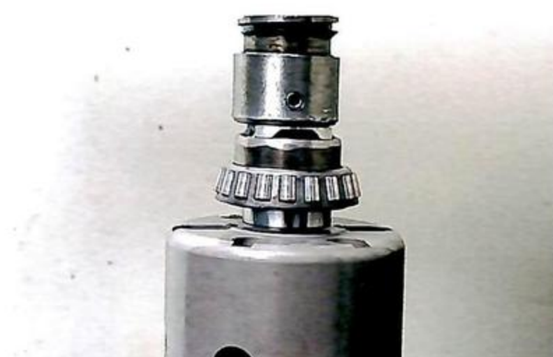
4 反対側のベアリングも圧入する。ベアリングの直径と押すカラーのサイズがきちっと合っていることが大切。組み付けはやはり油圧プレスがいい。
