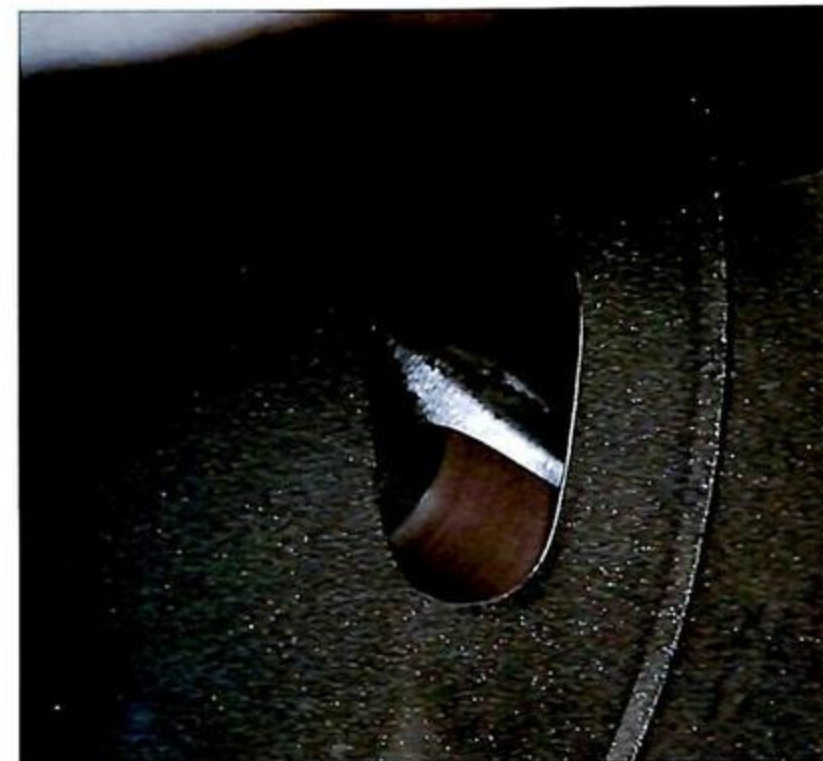
▲さらに磨き込み、ラバー砥石を使って仕上げる。ノーマルに比べるとポート表面はツルツルになり、出口付近の段付きも修正されている。
