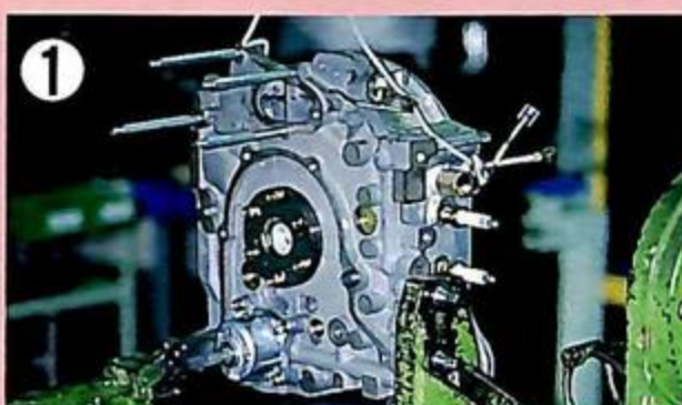
▲エンジンの組み立ては、フロントハウジングをエンジンスタンドにセットすることから開始。この時点ですでにプラグが付けられている。
