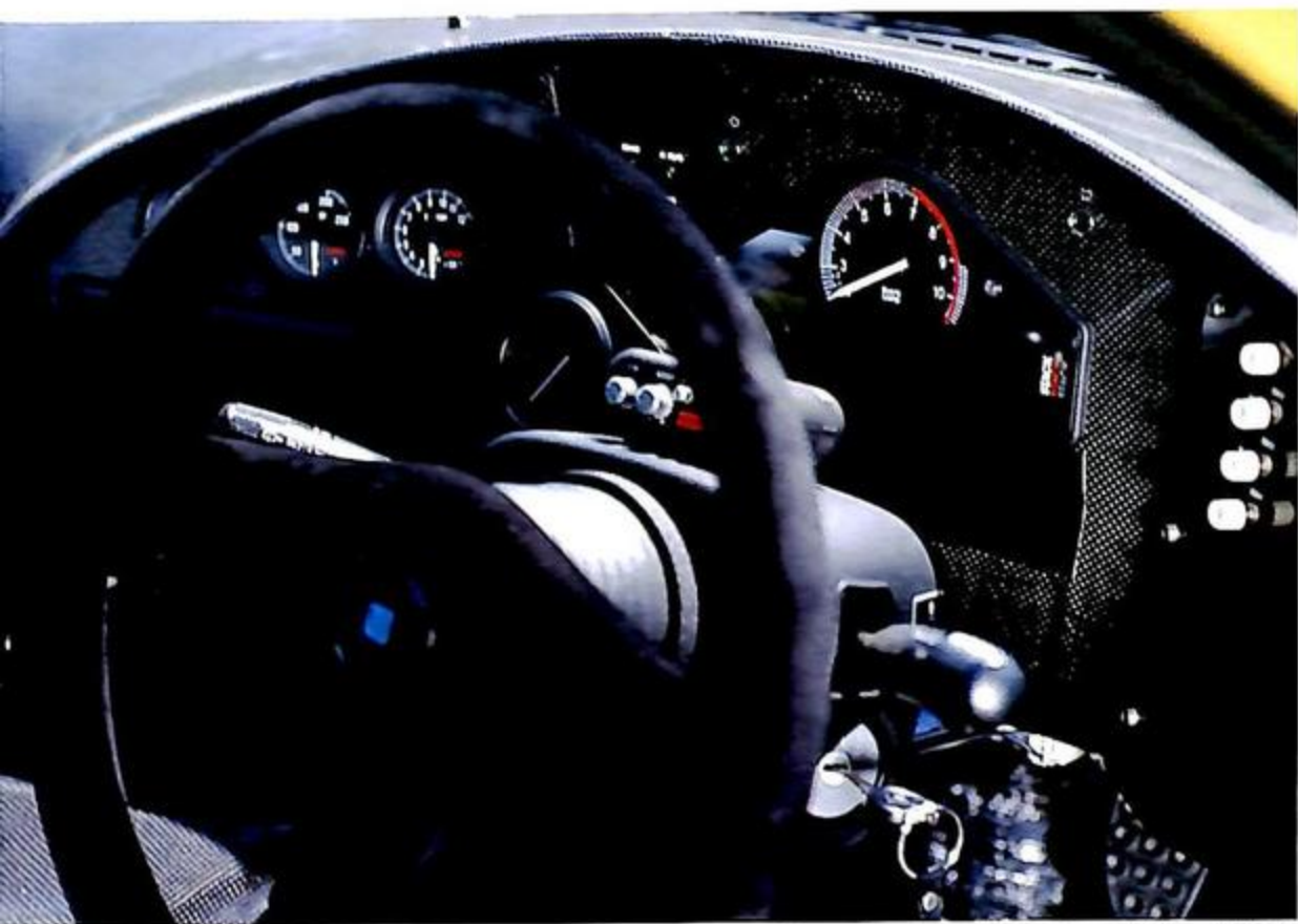
▲ワンオフ製作のカーボン・スペシャルメーターパネルはいかにもレーシングカー的な作りで、STACKのST8100ディスプレイシステムが鎮座する。エンジン回転数、油圧、水温、バッテリー電圧、車速、走行距離（オド）、車速距離（トリップ）の表示が可能だ。
