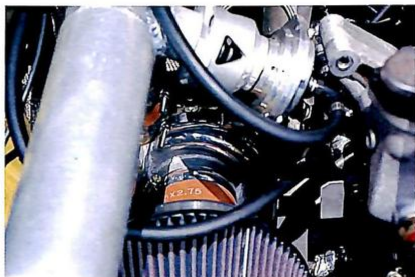
▲K&Nオリジナル・エアクリーナーを取り付けたパワーユニットは、ブーストコントローラーのEBSによって1.0kg-cm 2 に設定されている。
