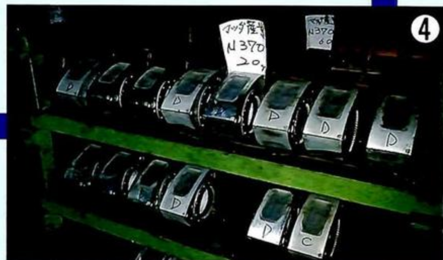
▲重量測定が終わったローターがズラリと並ぶ。以前はCランクを中心に合わせた組み合わせで組んでいたが、今は同ランク同士で組む。
