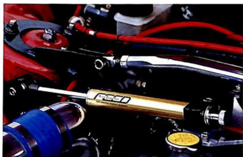
▲ハイパワーエンジンほどそのパワーを余すことなく伝える。そのためにもパイピングの抜け防止などのマイナートラブルを防ぐダンパーは必需品だ。
