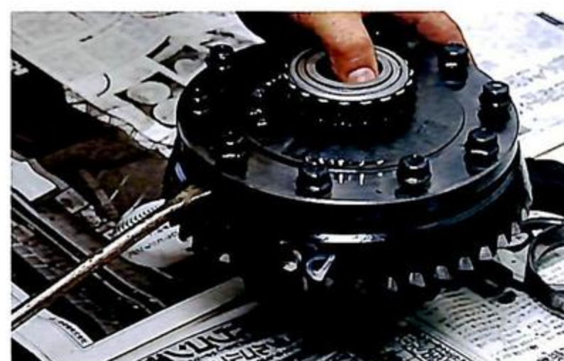
13 ボルトがゆるんだところでリングギヤを外してやる。ボルトを緩めた状態で、ボルトの頭をショックレスハンマーで平均に軽く叩いてもいいだろう。
