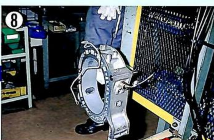
▲必要な小パーツが組み付けられて、エンジン本体組み付けの出番を待つローターハウジング。
