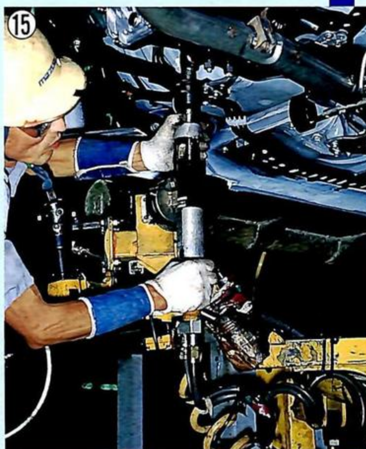
▲P.P.Fの締め付けトルクは、15~18kg-mと強い。そこで締め付けロボット(?)を使って、高トルク部分のナット・ボルトを締め付けていた。
