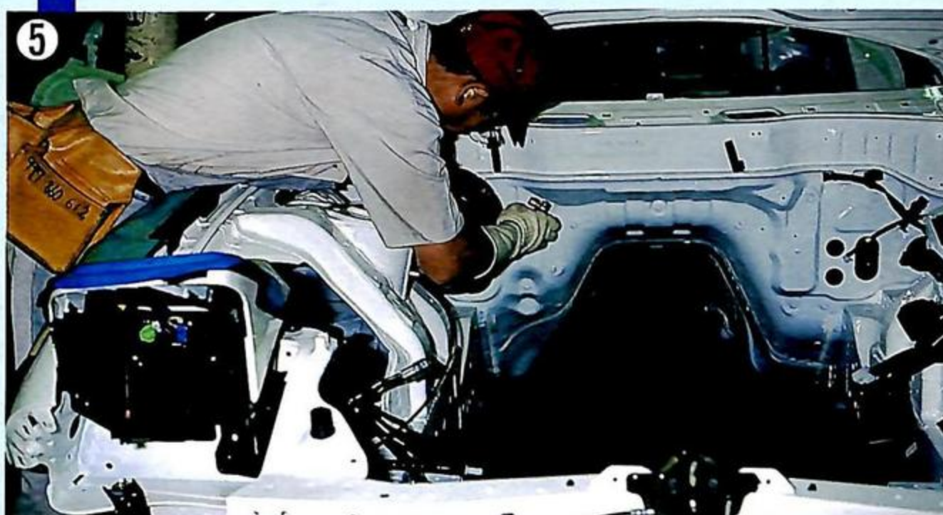
▲エンジンを組み付ける前に、ブレーキマスターバック関係のパーツを組み付ける。
