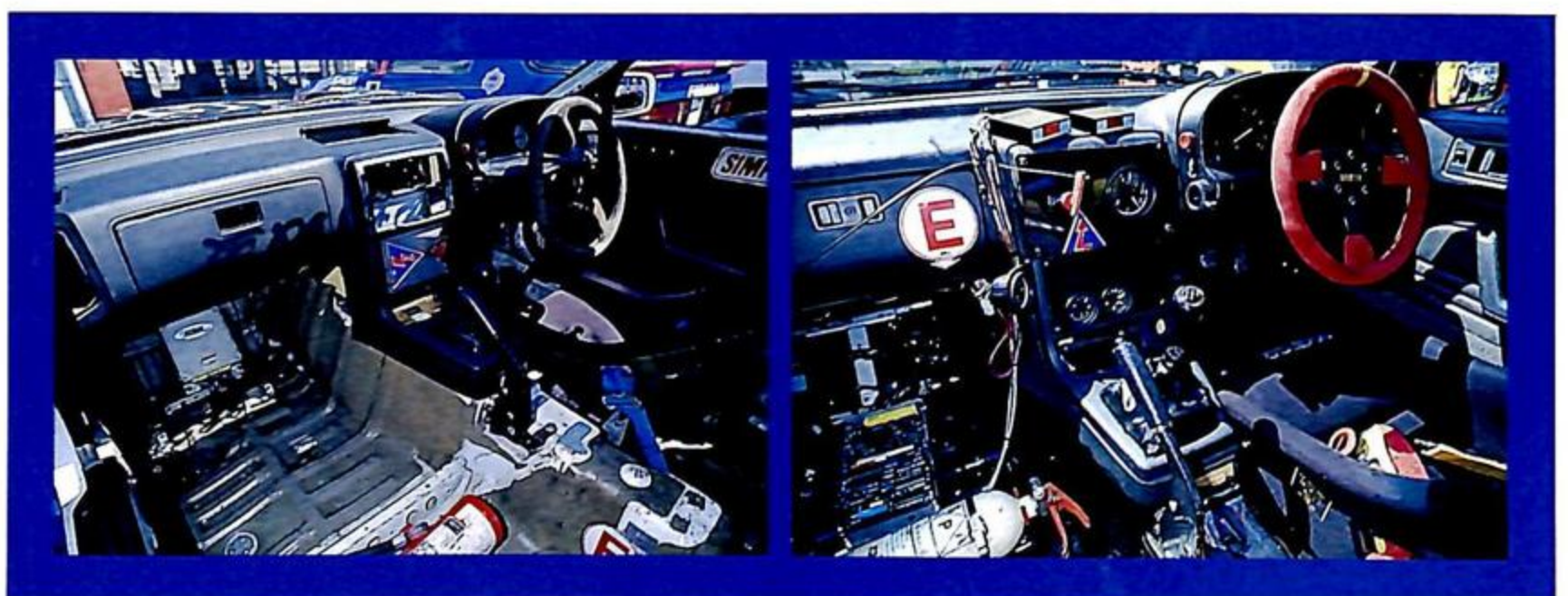
▲全車必ずついているのが、サーキットブレーカーとかカットオフスイッチともいうこのキルスイッチで、左フロントと同時に作動してすべての電源をオフにする。
