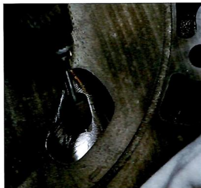
▲大きく削り込むときはリユーターを使い、表面を磨き込む場合はサンドペーパーを巻いた状態になっているサンダーバンドを使用する。
