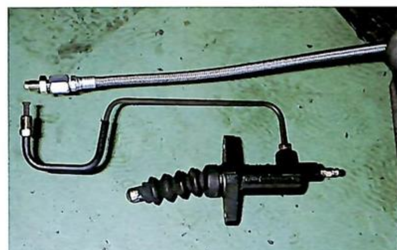
20 レリースシリンダーとパイプに代わって、このホースとクラッチマスターシリンダーのホースとが接続されるのだ。
