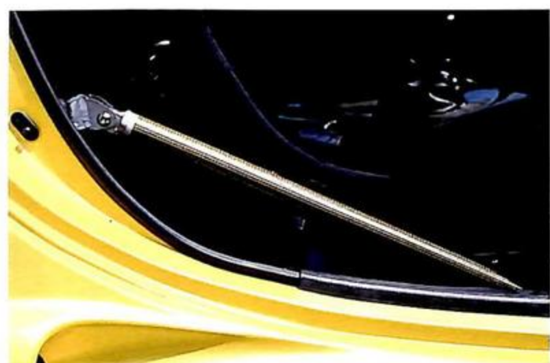
▲ブリッドのGTカースペックジーク、タイプRZのバスケットシート横のサイドバーもカーボンでカバーされ、いかにもレーシングカー的なイメージだ。
