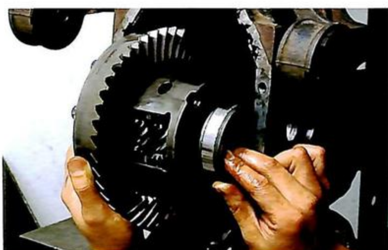
11 また、ベアリングにはアウターレースが被さっているが、このアウターレースも左右の識別ができるように、荷札などに左右の別を書いておくといい。
