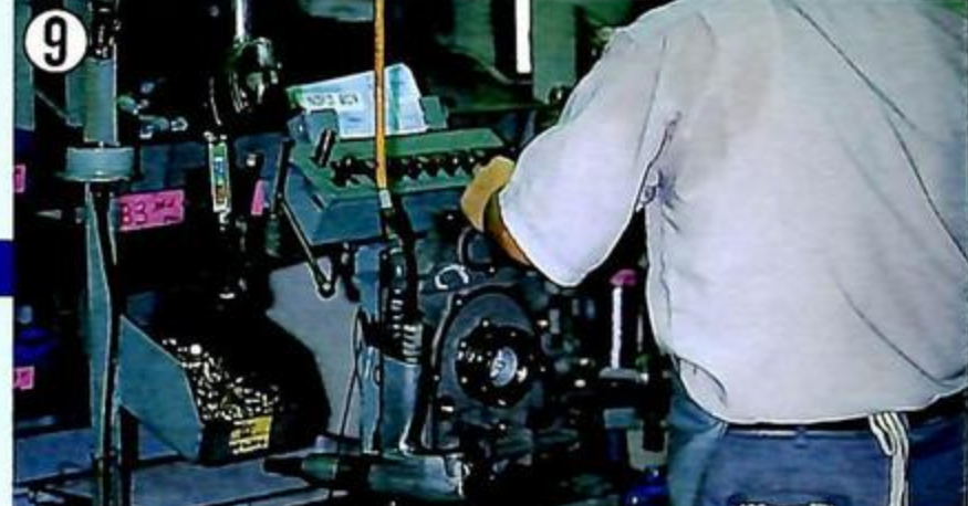
▲フロントハウジングステーションナリーギヤのハウジングをネジ留め。インパクトレンチで仮留め後、トルクレンチで最終締め付け。
