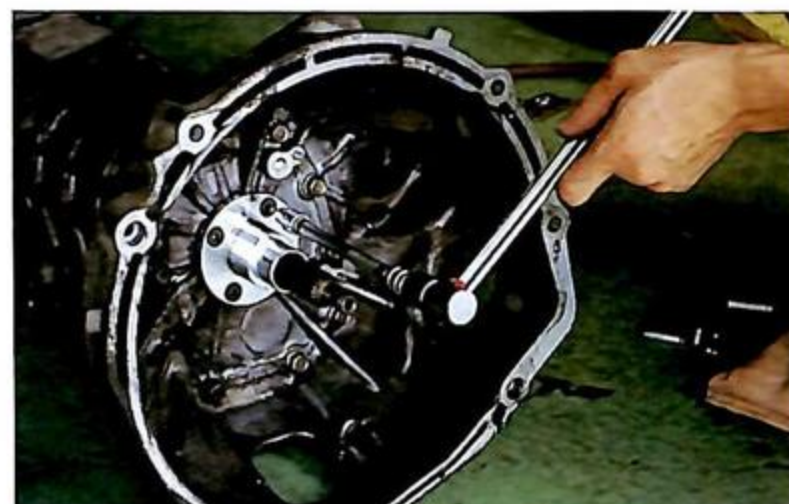
15 ハイドロリリースの油圧ホースの位置の関係で、向かって右側にハイドロリリースの位置決めをするシャフトがくるように組み付けるのがポイント。
