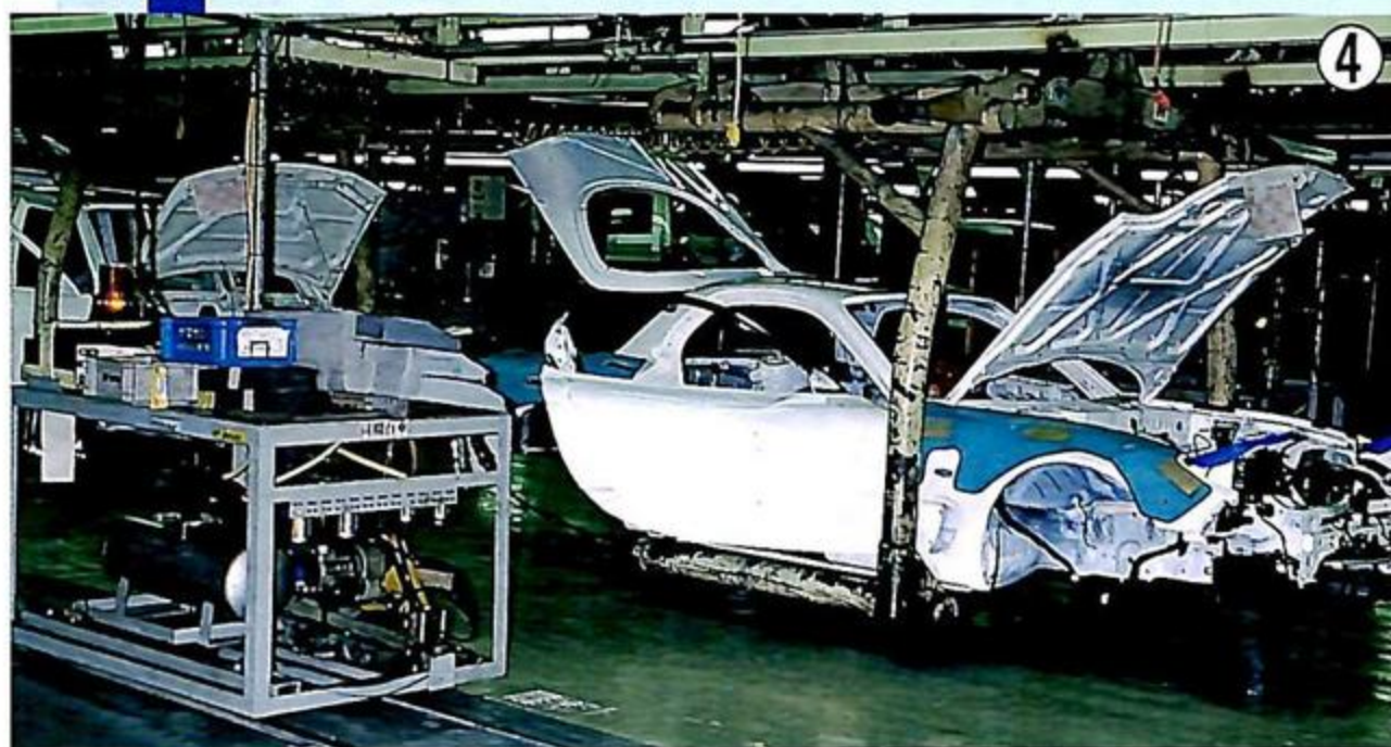
▲ボディのわきにあるのがエアコンプレッサーで下にレールが見えるが、流れるFDとともにレールの上を移動していた。このFDの作業が終わると、また所定の位置にもどっていく。
