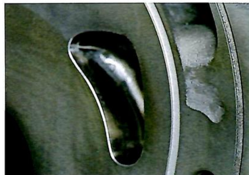
▲そのポートの出口形状。ターボチューンとの組み合わせでブーストにもよるが、簡単に400psオーバーは確実となり500psに迫りオーバーする実力も備わる。
