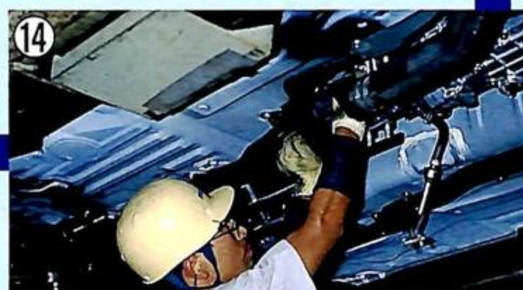
▲ミッションとデフをつなぐパワープラントフレーム(P.P.F)を組み付ける。まだ仮締め状態だ。
