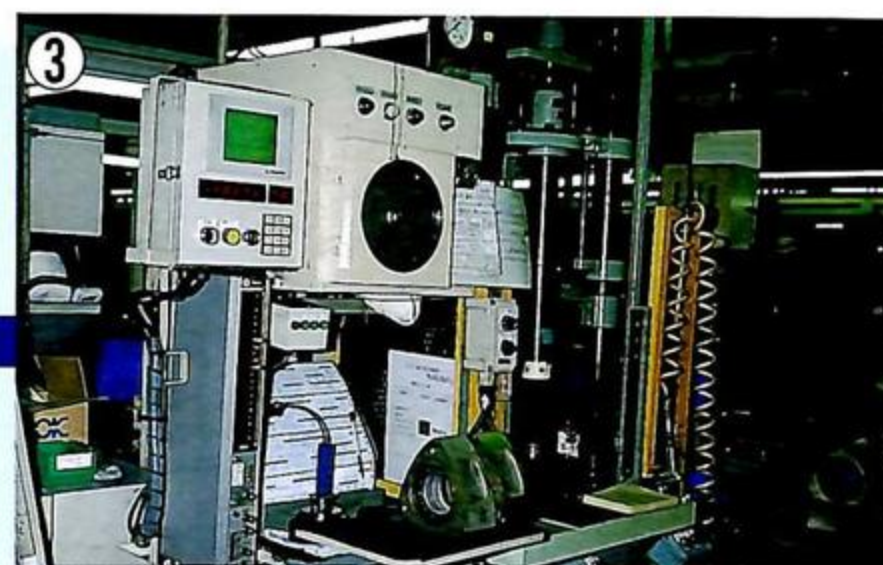
▲ローターの方は重量を測定する。組み付けのときには同じ重量ランクのローターを2個組み合わせて使用する。
