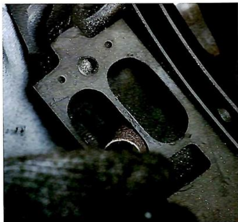
▲ポートの入り口を拡大すると、マニホールド側も修正する必要がある。表面の錆肌をきれいにするだけでも効果がある。
