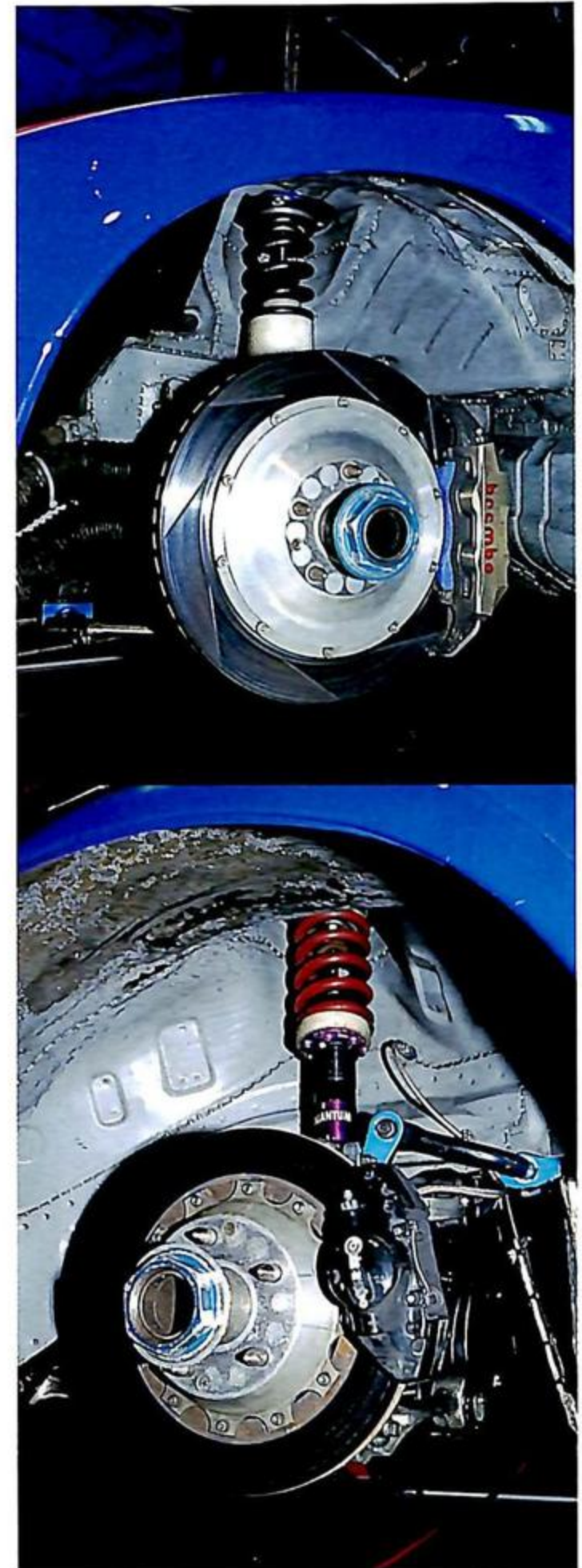
▲フロント・リヤともセンターロックタイプのホイールナット。さすがブレーキキャリパーもローターもビッグサイズだ。
