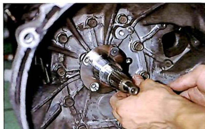
14 ミッションにスリーブ本体を組み合わせる。スリーブにはハイドロリリースの位置決めがあるので、ミッション側の組み付けに注意する。
