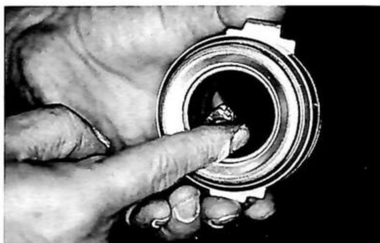
52 せっかくミッションオーバーホールを行ったのだから、ついでクラッチのリリースベアリングも交換する。ベアリングの内側にはグリスを塗っておく。
