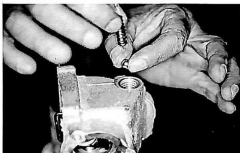
49 ブランジャーの中で動くボールを付ける。ニュートラル状態を確かめてから、切り欠きの真ん中の部分に入れ、ボルトを締め付ける。
