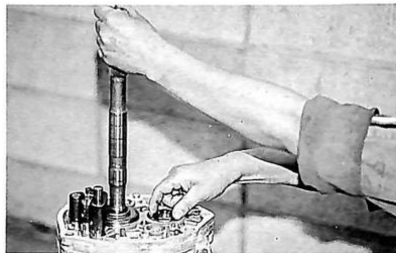
10 メインシャフトを回転させ、右側のシャフトが回転しないことを確認する。もし回転するようなら、ニュートラルになっていない証拠だ。
