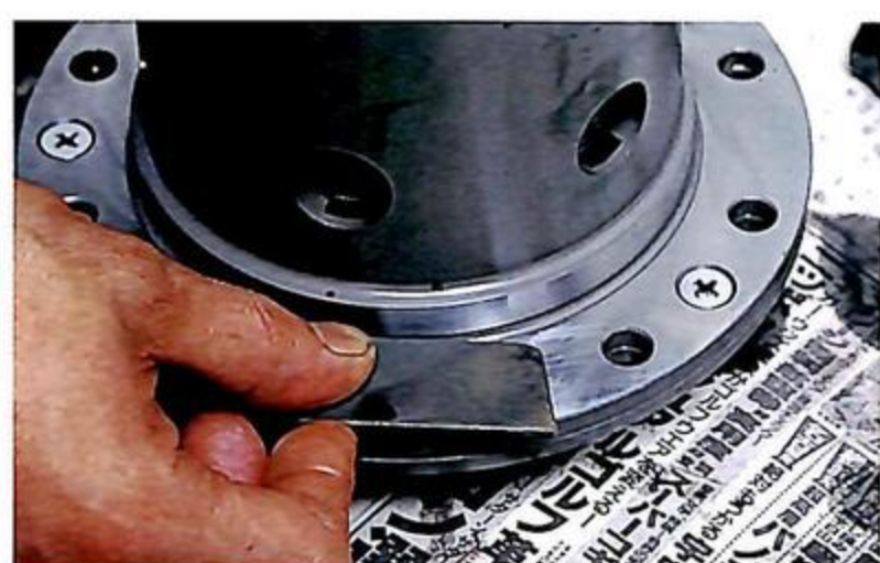
5 組み付けるデフのリングギヤ取り付け面にわずかなバリや異物の付着があっても、リングギヤの振れとなるので、オイルストーンを当ててやるといい。
