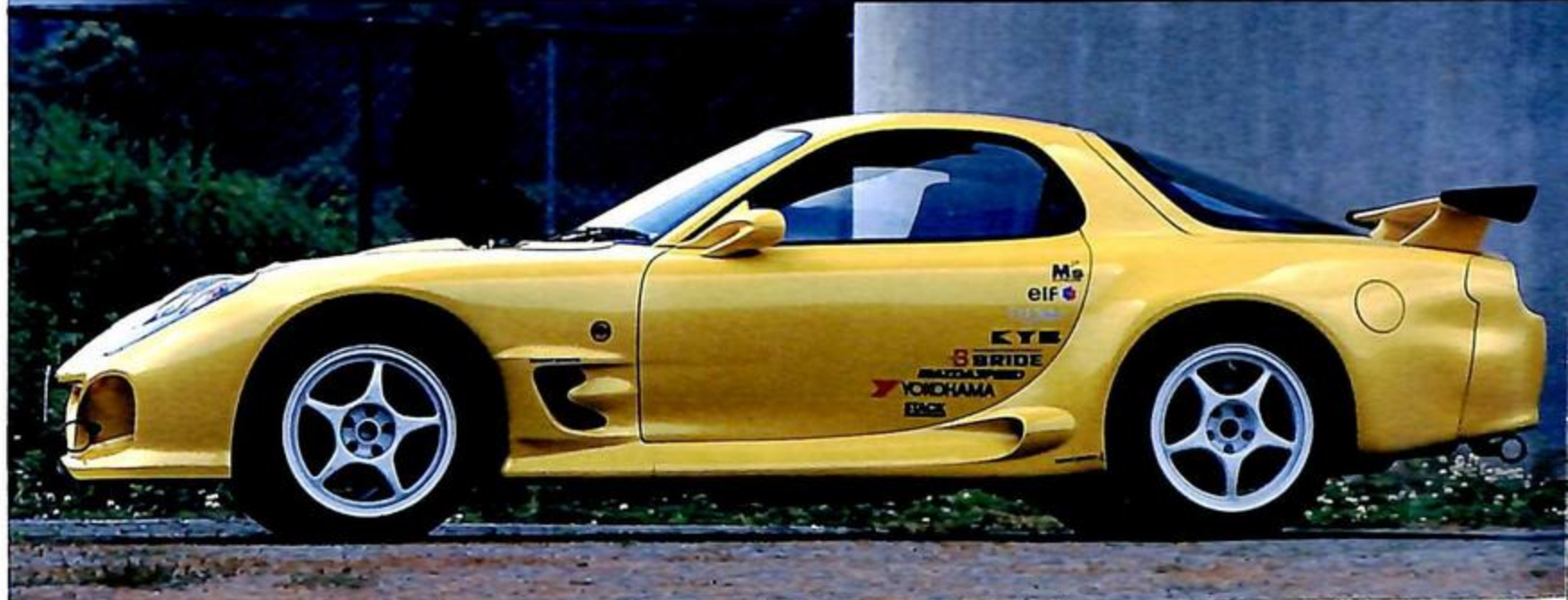
▲サイドから見ると「アルティマ」ブランドのエアロパーツはフロントバンパースポイラー、オーバーフェンダー、サイドスカート、リヤオーバーフェンダー、リヤエンドパネル&バンパースカート、リヤウイングスポイラーの装着が確認できる。
