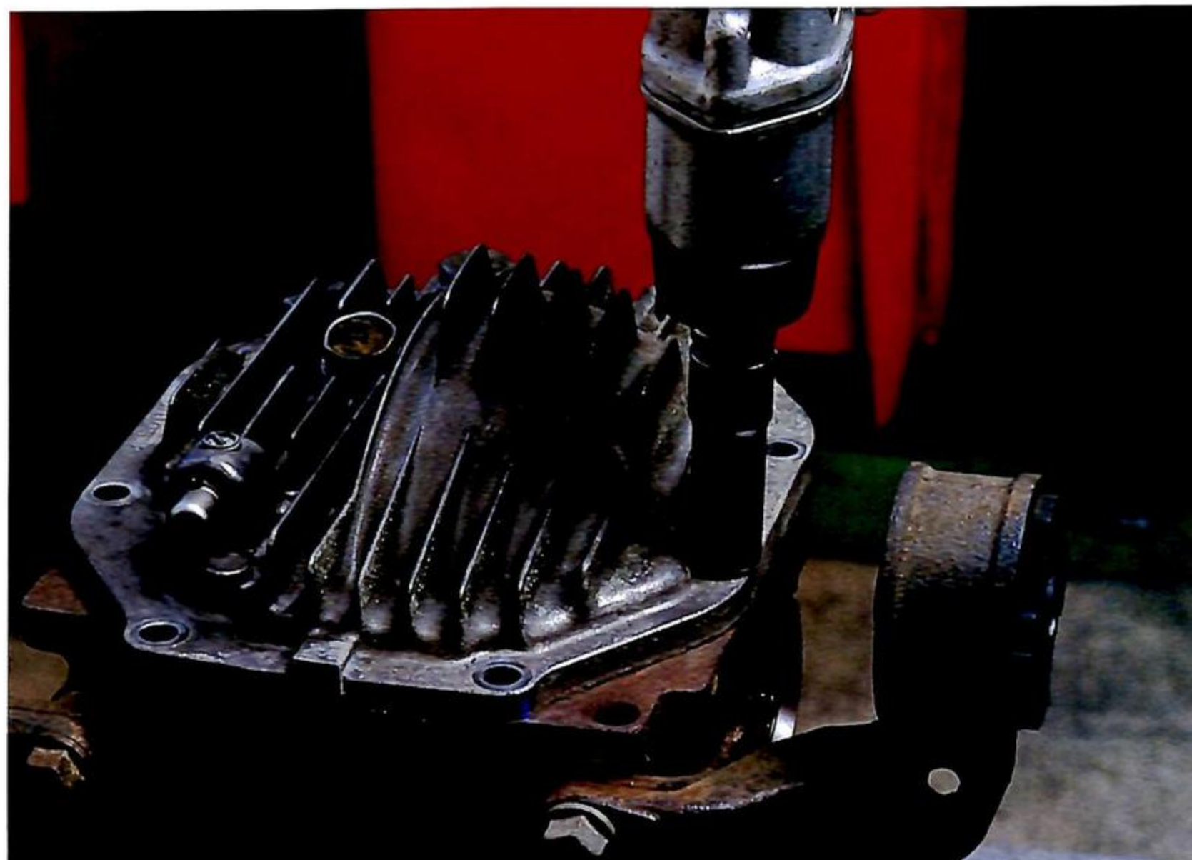
7 デフマウントが付いた状態のまま、万力に取り付けてもいいだろう。インパクトレンチが使える状態なら、デフをこのように立てて、ボルトを一気に取り外すことができる。インパクトレンチを使わない場合は、万力に固定して取り外し作業を行った方が安全で確実な作業ができる。
