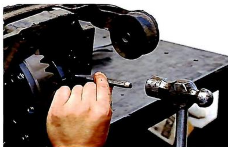
9 左右にあるベアリングキャップは、左右の入れ替えや組み付け位置を間違えないように、ポンチマークを打刻しておくといい。
