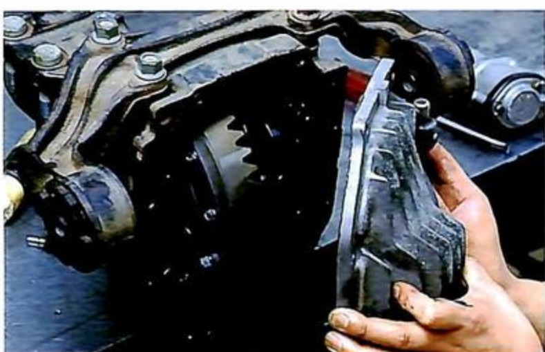
8 カバーを開けるとリングギヤとトルク・センシング・リミテッド・スリップデファレンシャル、通称トル・セン LSD が組み込まれている。
