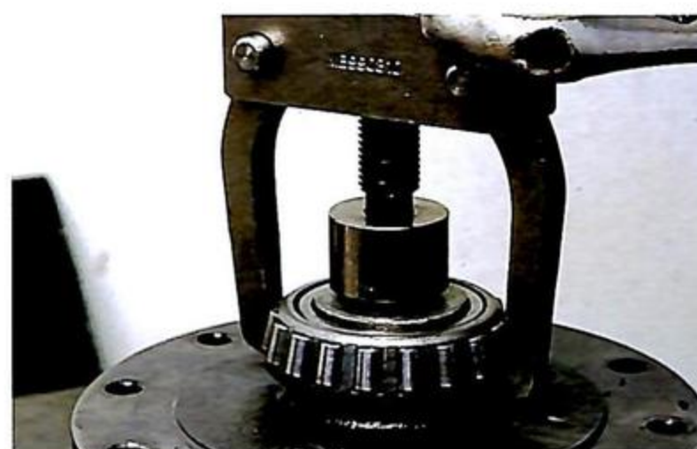
15 ベアリングプーラーがないと、このようにベアリングを正しく抜きとることができない。そんな場合も新しいベアリングがあれば、圧入するだけで済む。
