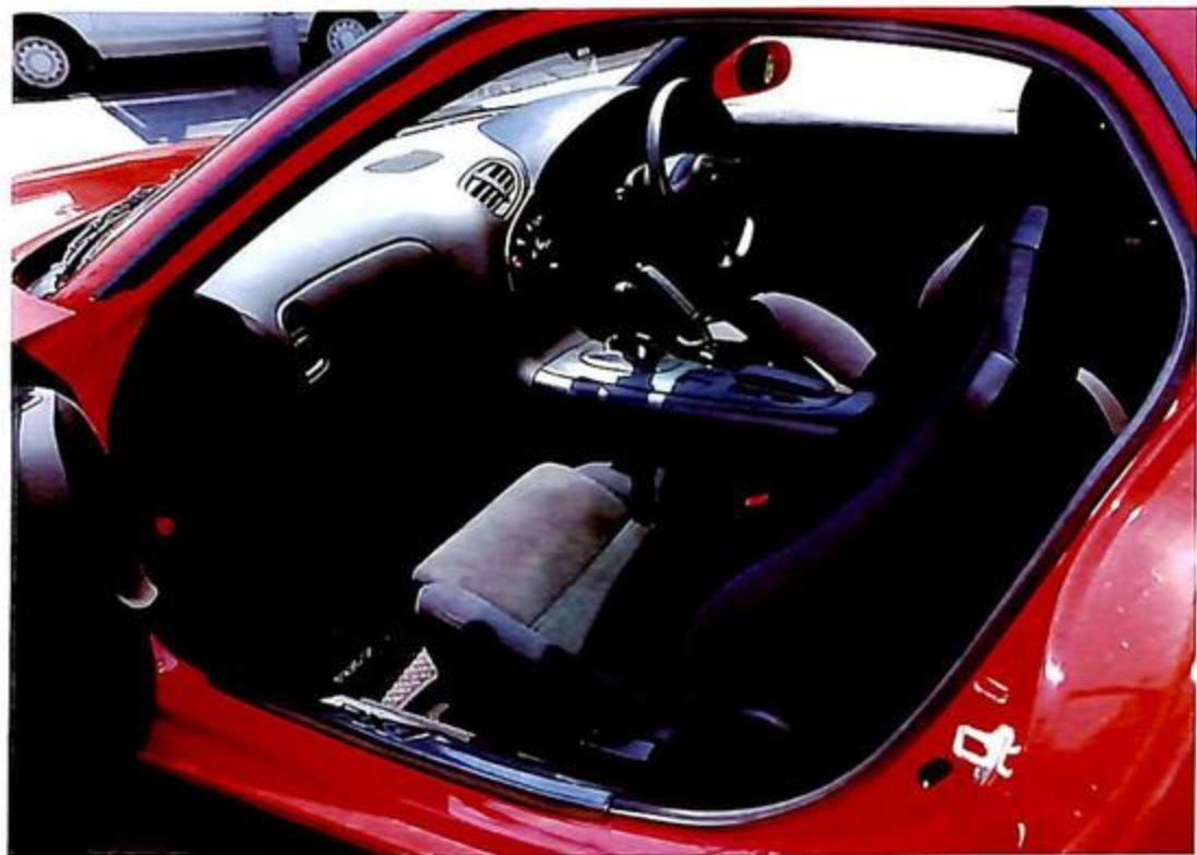
▲ドアを開けて、フロントピラーからステップに至るまでスポット溶接部分が均等にあるか、内張りを外した痕跡はないか、などをチェックする。スポット溶接の位置や数が左右で違っている場合は、溶接部の上からパテを塗って修理したかも知れない。
