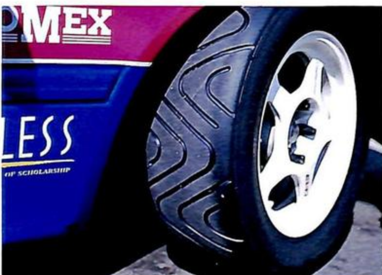
▲タイヤはダンロップのワンメイクとなっているので、参戦するRX-7全車ダンロップを履く。タイプはD98Jだ。
