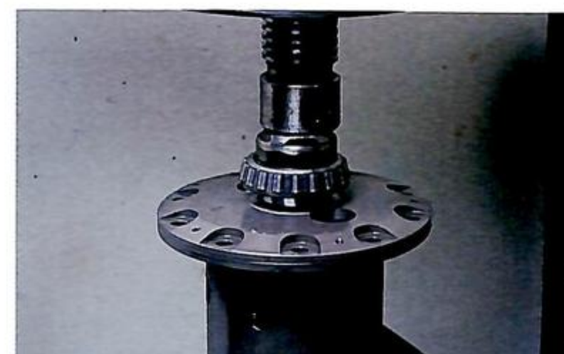
1 トルク・センLSDから抜き取ったサイドベアリングをタイプRSデフに圧入する。ベアリングは再使用だが、新品を用意して組み付けてもいい。
