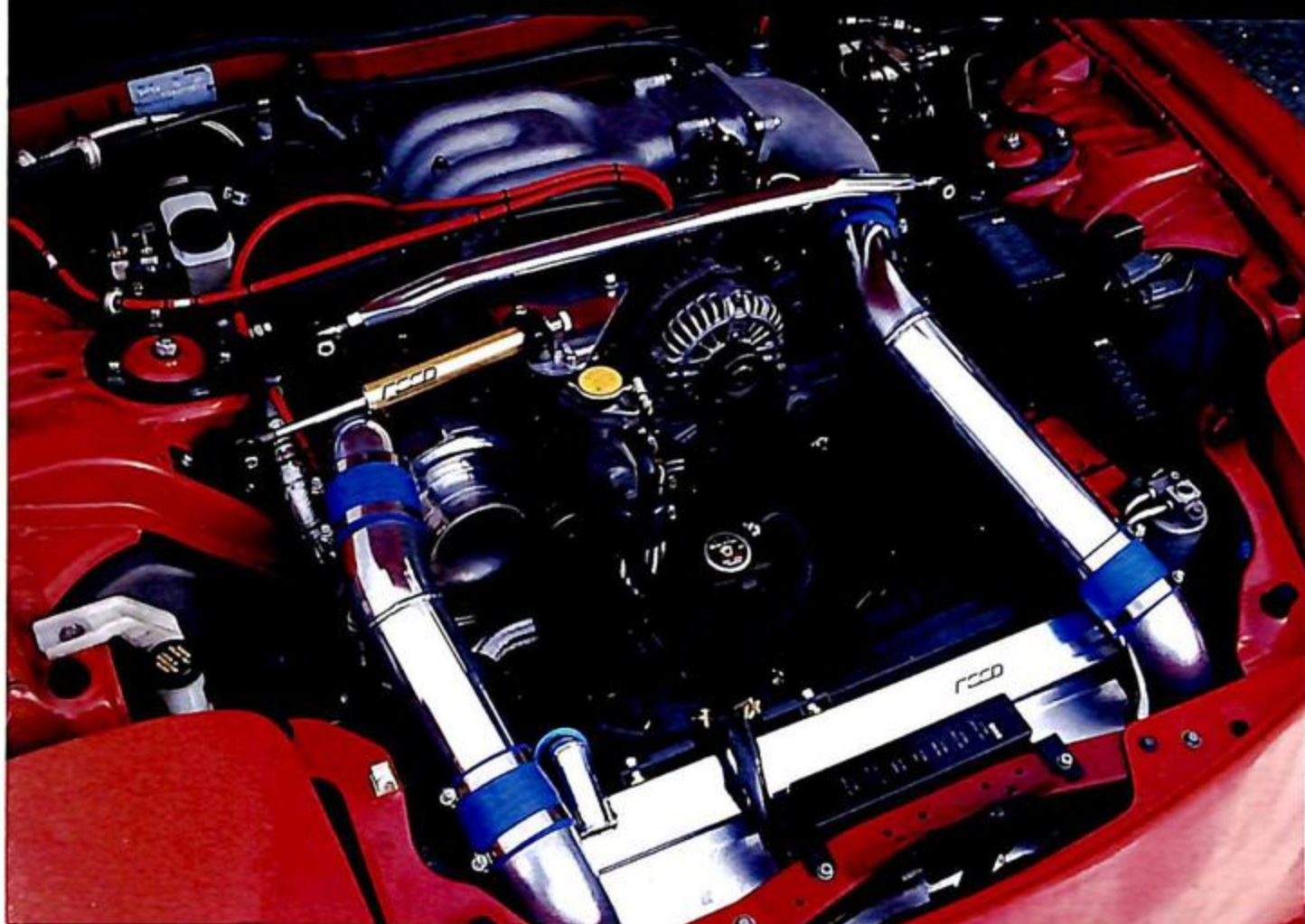
▲サイドポート加工されたエンジンは、シングルターボ化により、ブースト1.2kg-cm 2 で500psものパワーを絞り出す。それでいてフィニッシュワークはピカイチだ。
