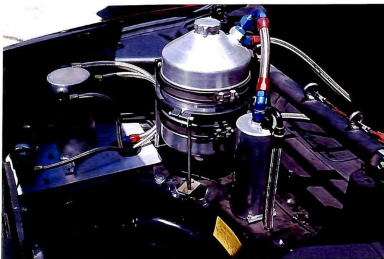
▲エンジンは完璧なサンプ方式となり、ドライサンプ化され、そのエンジンオイルタンクがここにあった。レーシングエンジンでは常識のドライサンプは、よりエンジンを低くマウントすることが可能だ。
