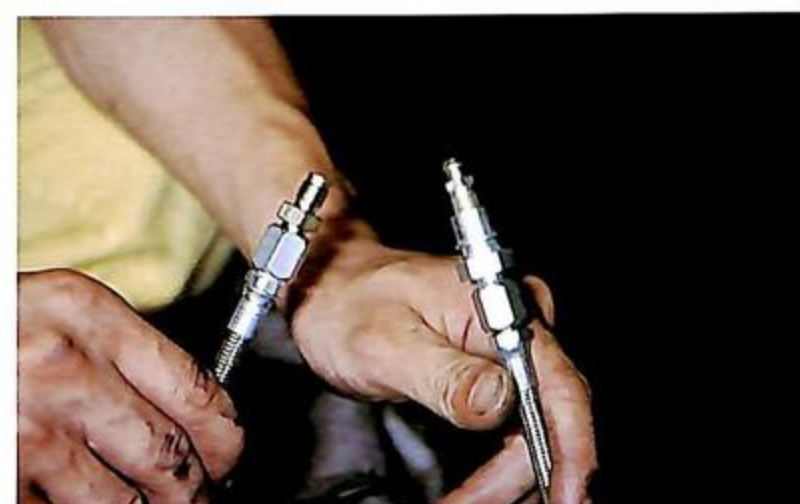
21 片側はクラッチマスターシリンダー側へ接続し、もう一方はエア抜き用のホースとなるので、ミッション側に固定しておく。
