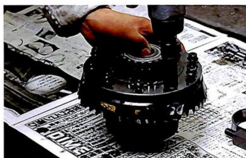
12 トル・セン LSD に付いているリングギヤを取り外す。リングギヤは再使用するので、ケース側のピニオンギヤは取り外す必要はない。
