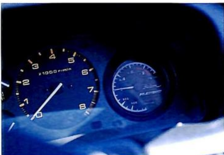
▲タコメーターのわきにブースト計を追加したシンプルなメーターパネル。必要最小限の取り付けでマイナートラブルは回避できる。
