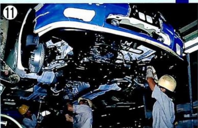
▲すでにリヤのサスペンション関係、デフが組み付けられてしまった。FDは作業工程やパーツ点数が多いので、他から熟練した「職人」が駆けつけ、アッという間に作業が済んでしまう。
