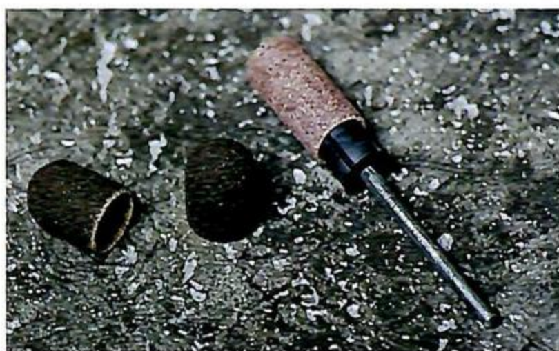
▲こちらのサンダーバンドは、先端が丸くなったキャップタイプだ。先端の丸い部分がポートの細かい部分のR仕上げに都合がいい。
