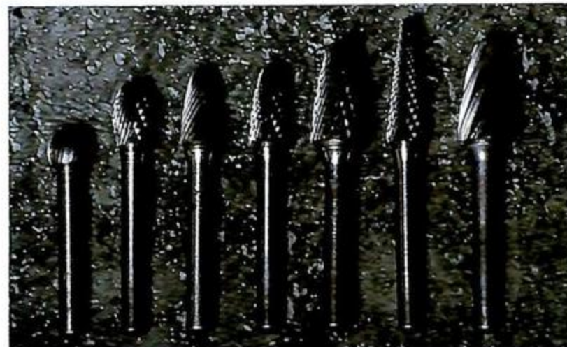
▲ポートをあらゆる角度から削るためのタンガロイ（ロータリーバー）が使われる。さらにシャングが長いものや先端とシャングが細いタイプもある。
