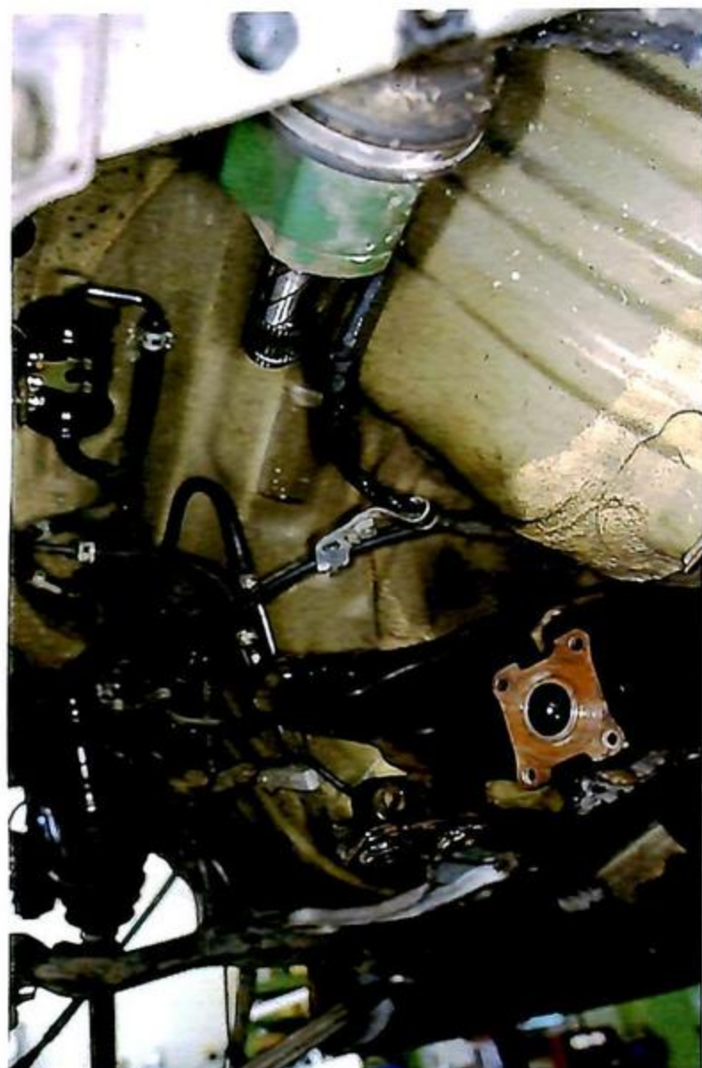
6 デフが取り外されたボディ。その取り外し作業は思ったより作業工程が多く、組み付け後は足まわりのアライメントチェックを行う必要を感じた。
