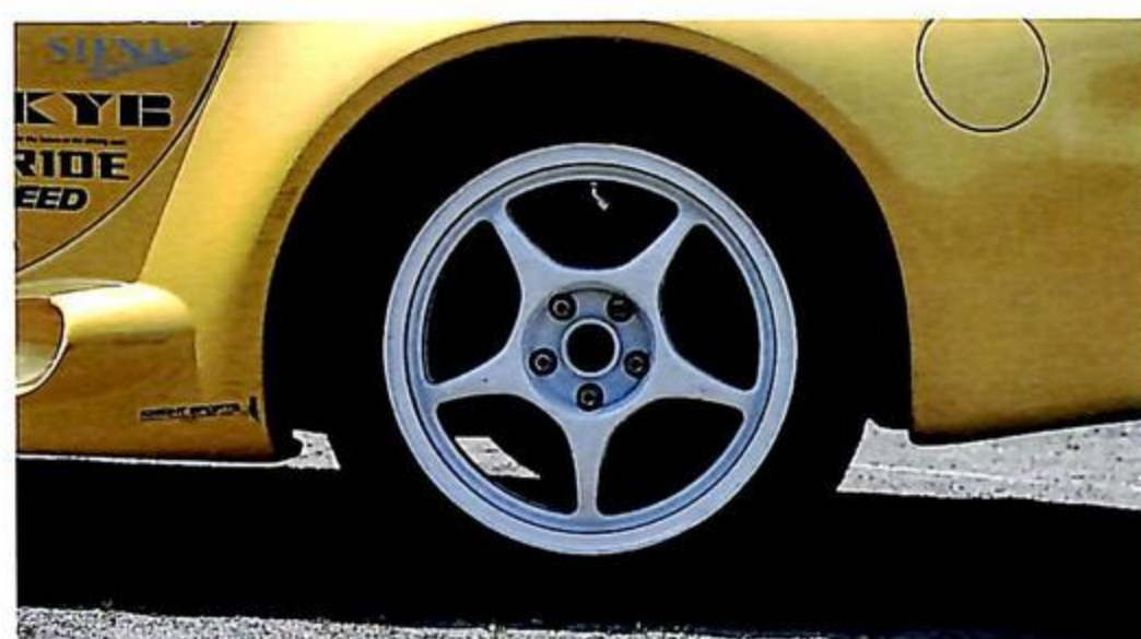
▲ホイールはエンケイRP-01、フロント8.0J-17、リヤ9.0J-18で、それぞれヨコハマ032Rフロント245/45ZR-17、リヤ245/35ZR-18を履く。ちなみにワイド化されたボディとともに、サスペンションアライメント変更と、フロント25mm、リヤ50mmのホイールスペーサーが組み込まれている。
