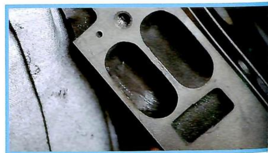
◀藤田氏はいつもタイヤの上に置き、1本の棒でローターに角度を付けて加工する。これは15インチだが、14インチがベストだと教えてくれた。
