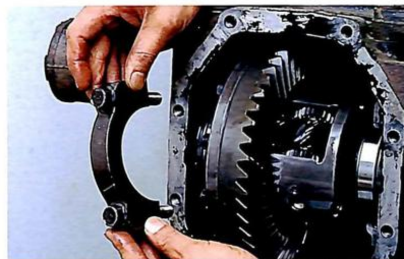
10 ベアリングキャップを外すとベアリングとデフケースの間にアジャストシムが入っていることを確認する。このシムの左右が識別できるようにしておく。
