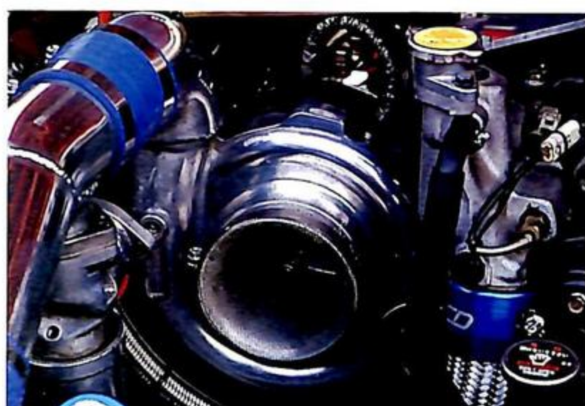
▲T F 50シングルターボチャージャーのパワーは、本誌のエンジンベンチテストデータも参考にしてほしい。ブースト1.0kg-cm 2 で無理せず400psをオーバーしている。ブースト1.2kg-cm 2 なら、500psもうなずける。
