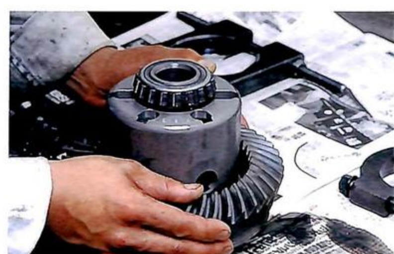
7 デフにボルトの穴位置を合わせるようにしてリングギヤを組み付ける。リングギヤを温めてデフに組み込む必要はない。
