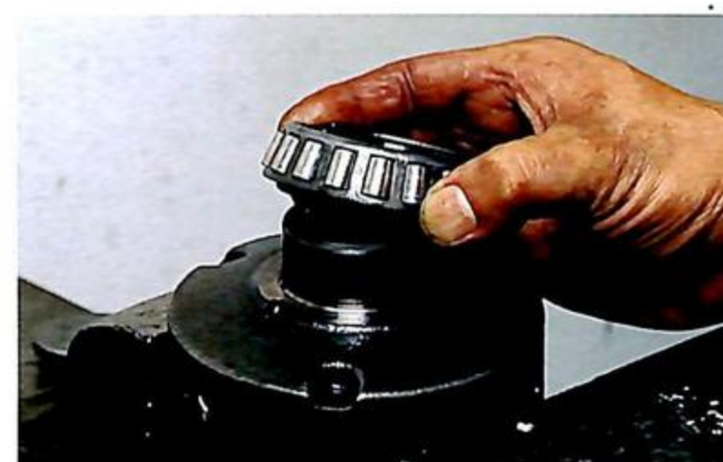
16 抜き取ったベアリングとアウターレースを一体にして、タイプRSのLSDに圧入するまで保管しておく。個々のパーツの入れ違いに注意する。
