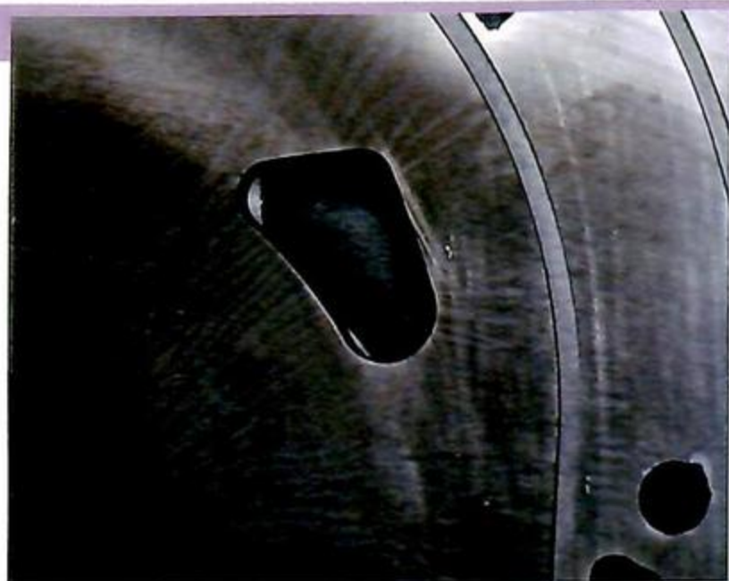
▲よく見てほしい。左上のちらっと光る部分がこのポートの段付き部分で、メーカー側で面取り加工されたもの。この部分の段付きを修正するのだ。
