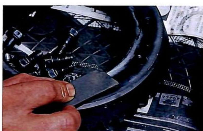
6 同様にリングギヤの取り付け面もオイルストーンを当てる。組み付ける前には、双方の取り付け面をよく洗浄しておくこと。
