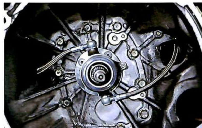
18 ハイドロリリースの油圧ホースはリリースシリンダーとリリースフォークの取り付け穴を使ってレイアウトされるため、スリーブの位置を決めたわけだ。
