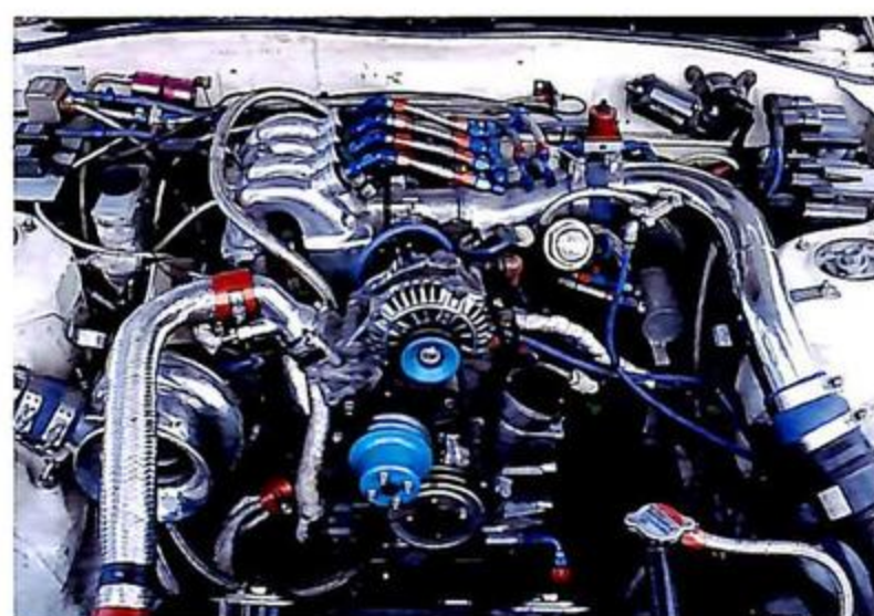
▲オリジナルの前置きインタークーラーは米国スビルコ社製コアを使用し、その効果は絶大。燃料系やパイピング、エアフローのレイアウトにも気遣いがうかがえる。
