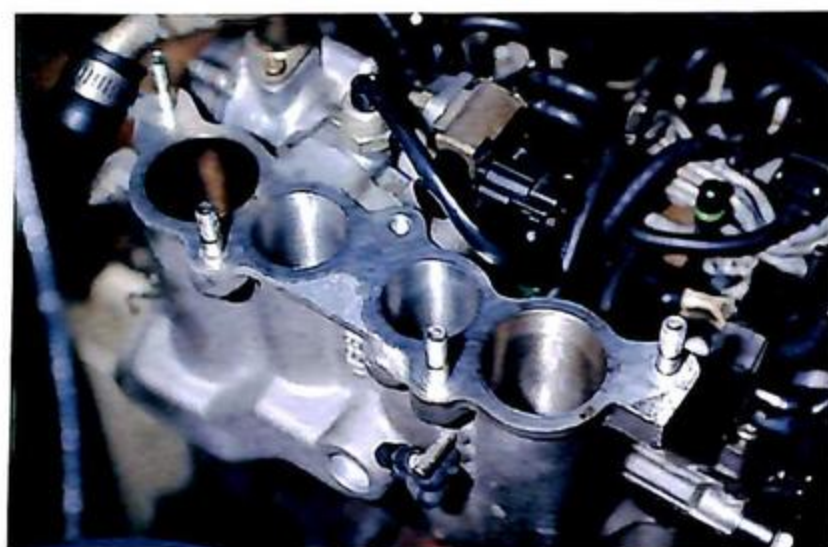
▲ノーマルのマニホールドを取り外し、段付き修正拡大加工を施したインテークマニホールドとスロットルを組み付ける。
