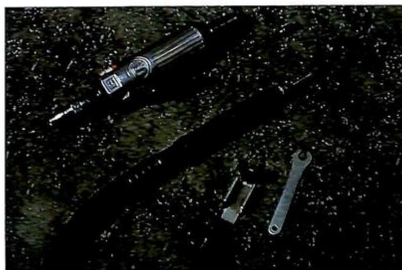
▲エアリユーターは、おもにガンガン削るために使うものと、細かいところや仕上げ用に使うものを使い分ける。
