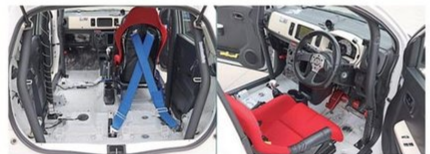
助手席はサーキット入り後に外す。サイトウロールケージの6点式。ステアリングはモモで、ナビのモニターにはラップタイムが表示されるように設定
