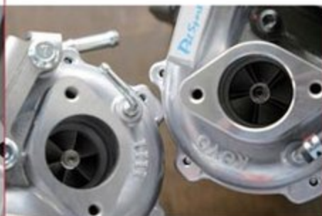
左が他社製で右がパルスポーツ。ブレードの形状が違うのは一目瞭然だろう。こういった細かいコダワリが各所に盛り込まれる。
