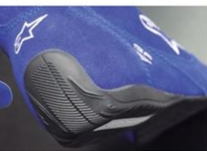
ヒールアンドトゥの際にかかとがアクセルペダルに引っかかりにくいよう、ソール側面を逆台形型にしている。これは全モデル共通
