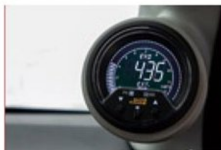
排気温度がいつもの値から上がる状況はエンジン効率が落ちているので排温が上がってきたらクーリング走行に切り変える
