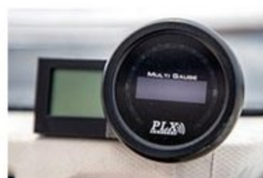
これはセッティング時に使用する空燃比計。エンジンの異常がすぐわかるのでサーキット派なら付けておいていいかも
