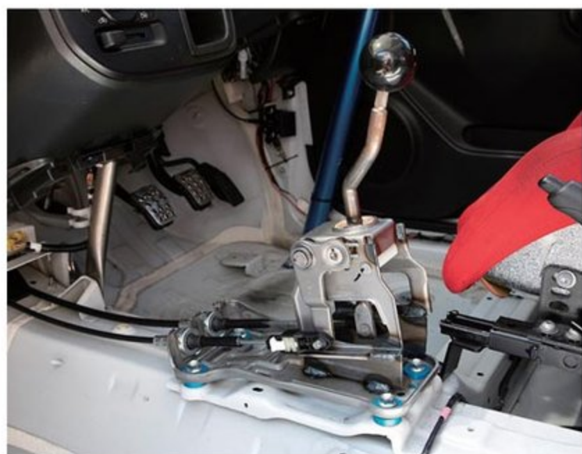
シフトレバーは台座の角度をスペーサーで調整する。バン用MTはレシオがワイドだがトルク特性と合わせると使いやすい面もある
