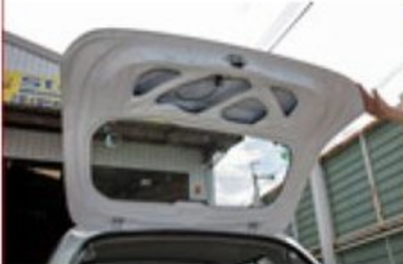
レースカーに装着しているFRP製リヤゲート。もともと大きく高い位置にあるのでこの軽量化は運動性向上におおいに効く
