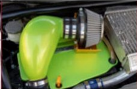
ワークス、ターボRS用の3Dサクシオンチャンバーはフルチューン対応の容量を持ち、熱対策面で本体をCFRPにしたという逸品だ
