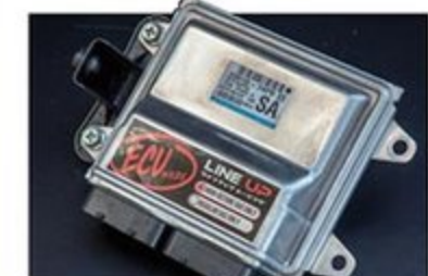
36アルトバン用ECU。アクセルオンでのエンジンの反応が劇的に向上。レギュラー仕様は5万8000円、ハイオク仕様は6万8000円
