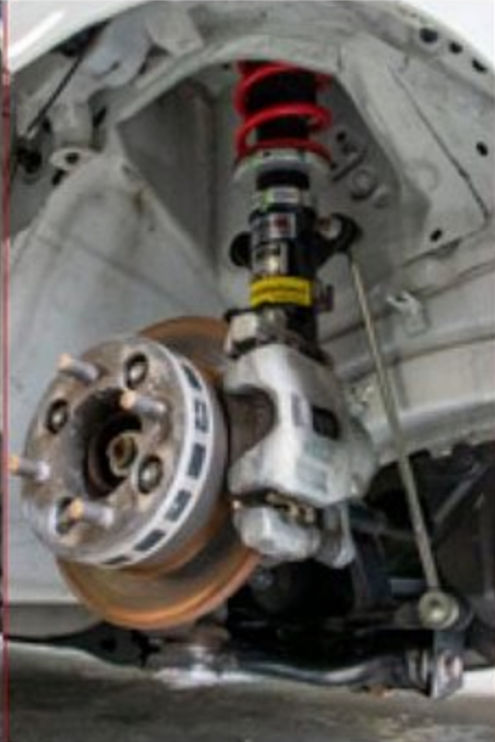
方向性とセッティングはコンプリートスピードが行いRS☆Rが製造するオリジナルキット。ターボ、NAどちらにも適合する
