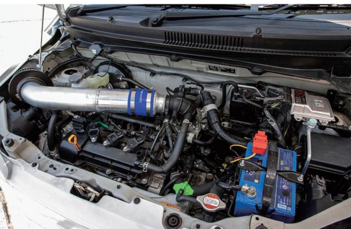
エンジン本体はノーマル。アルトバンはVVTがないモデル。インテークパイプは断熱性もある2層構造。これは初めて見た作りだ
