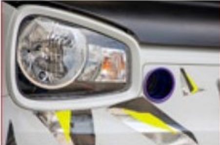
NAレースカーに施してあったエア導入ダクト。裏にホースが繋がってリアアクリーナーへ引かれる。ちょっとした加工だがカッコいい
