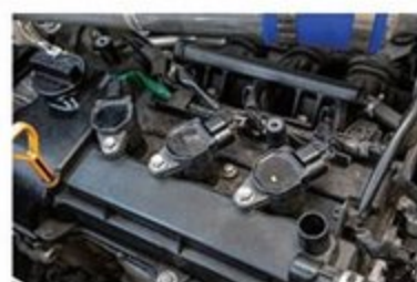
点火コイルやプラグのメンテも大事。パワーが少ないので、チューン云々の前にメンテ不足が原因のロスをなくしていきたい
