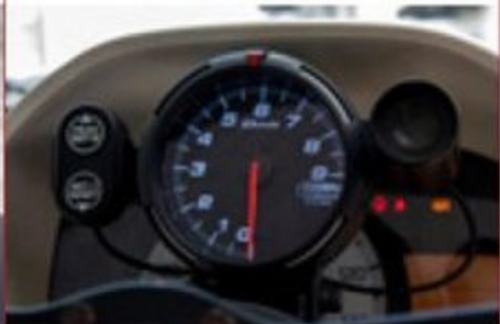
NAアルトにはタコメーターがないのでDefi製を追加する。NAアルトのサーキット仕様を作りたいときもここに相談したい
