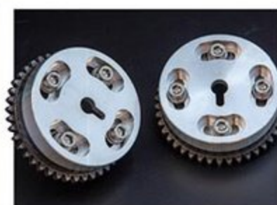
今後のエンジンチューンを見据えたパーツ。VVTなしエンジンのバルブ調整用アイテム。IN&EXセットで価格は3万8500円
