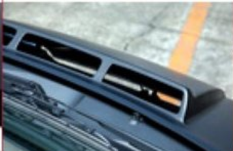
ダクトからグリル部の前部開口部が見える。これで空気の流れのよさがわかるだろう。これからの季節はとくに効果あるはず
