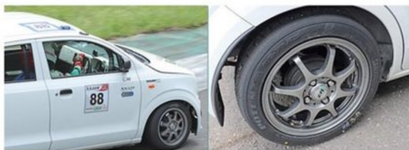
レギュレーションでSタイヤやスリックタイヤは使用禁止。5クラスはハイグリップラジアルタイヤが使用可能のため、ポテンザのRE-71RSの15インチを履く
