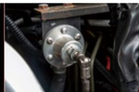
ブーストアップに対して燃圧が安定しなかったのがキャドカーズはリターンを設けた。燃圧の最適値安定化は必須の条件だ
