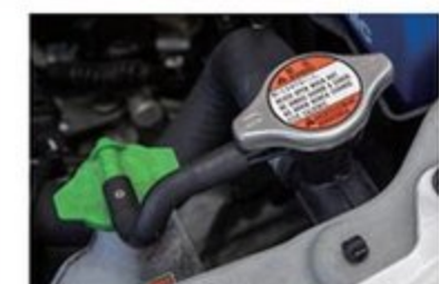
冷却水の温度もエンジンにとって効率のいいところで安定するようにセッティングする。冷やすと言うよりも保温という考えだ
