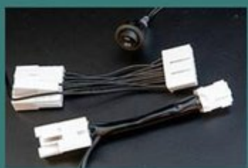
ブレーキオーバーライドの機能を止めてヒール&トゥを可能にするアイテム。ワークスを含めてアルトのMT車でスポーツ走行しているユーザーには必需品といえるものだ
