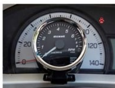
NAアルトにはタコメーターがないのであと付けは必須。エンジン的には高回転まで回すより6000rpm付近でのシフトがあう
