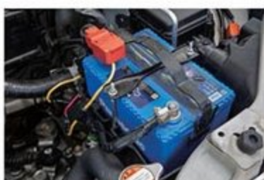
オルタネーターが余計に動かないことと、点火系パーツへできるだけ安定した電気を供給するためにもバッテリーのメンテは重要
