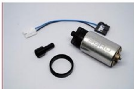
インジェクター容量が増えたこととハイブーストになることの補助として圧送能力が高い強化燃料ポンプも必要になる。
