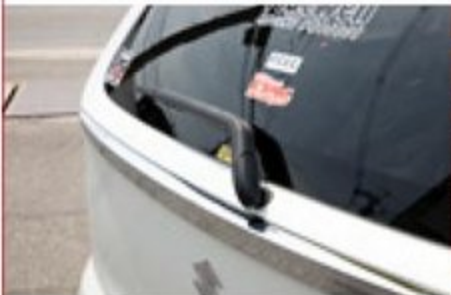
ノーマルはリヤワイパーが付くがFRPリヤゲートはなくなるので見た目もスッキリする。ドレスアップでも使えるものだ
