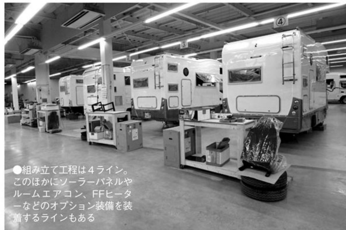
●タイにあるバンテックセールスの工場で作成され、コンテナに入れて運ばれてきたキャブコンのシェルを、カムロードなどのシャシー車にドッキング
