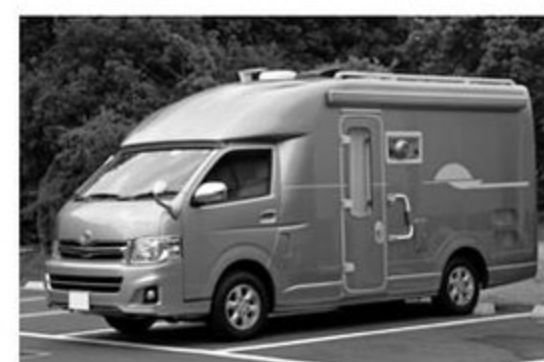
●ハイエーススーパーロングをボディカットし、家電製品を生かせるACSシステムを搭載したキャブコンモデル。ソーラーパネルで発電した電気をサブバッテリーに蓄え、大容量インバーターを使ってルームエアコンや電子レンジを動かすことが可能
