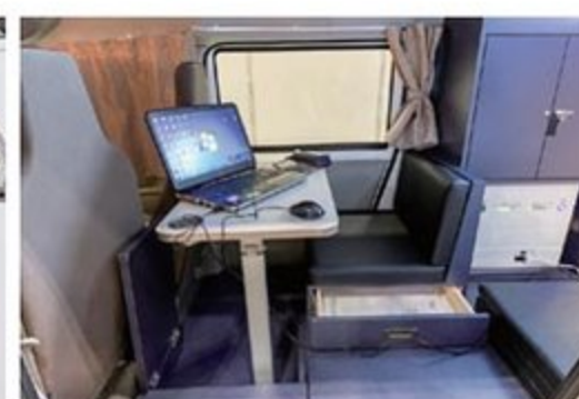
●キャンパー鹿児島が製作した軽キャンパー仕様の防災&オフィスカーが「secure」。事務作業用の机とイス、1人が横になれる折りたたみ式マットを搭載。蓄電池システムとソーラーパネルにより、災害地や工事現場で必要な電力を使用できる
