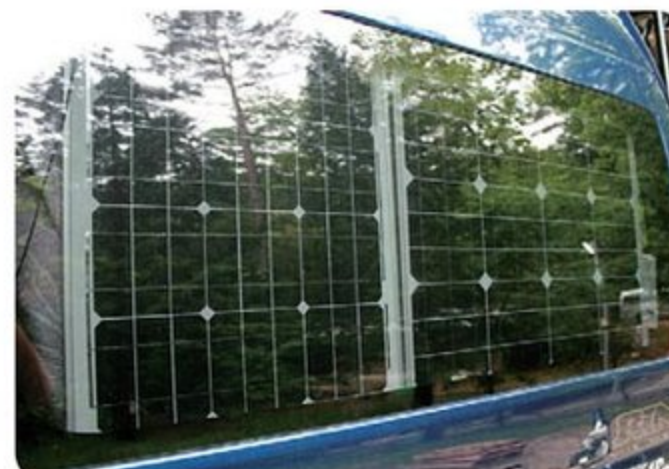
●基本的に1人使用が多いので、車内後方は各電装品などのDIY品スペースとする。ウインドウ内にはソーラーパネルをビッシリ設置
