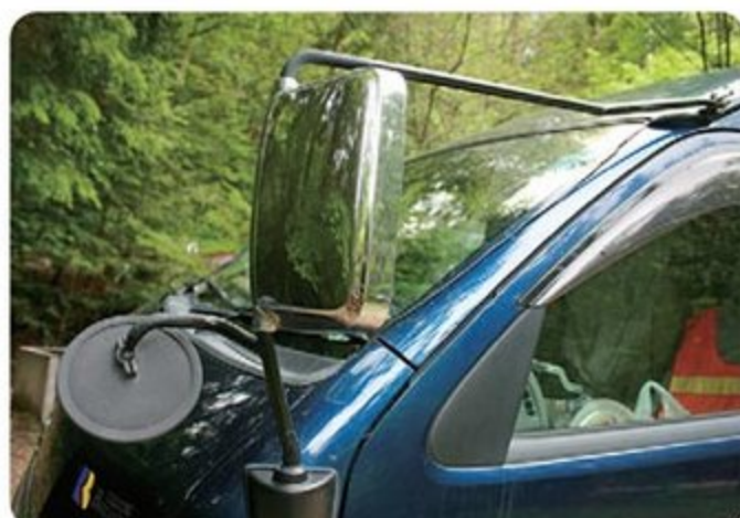
●トレーラーを引くので、後方の巻き込み確認が確実にできるようミラーもサイズアップ。パーツは他車用を使い、ステーを自作して装着
