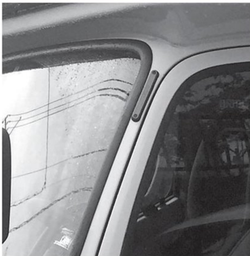
●移設したアンテナ部分にもジュラルミン製のカバーを付けた。メタルブルーのカラーリングでフロントまわりのいいワンポイントになった
