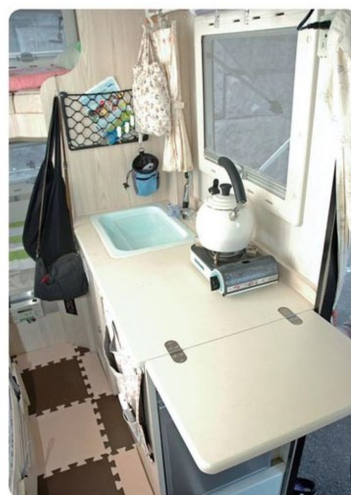
●キッチン台の延長はロータスRVセールスに製作してもらった。一般的なのは下に折りたたむが、冷蔵庫と干渉するため、キッチン台側に折りたたむ
