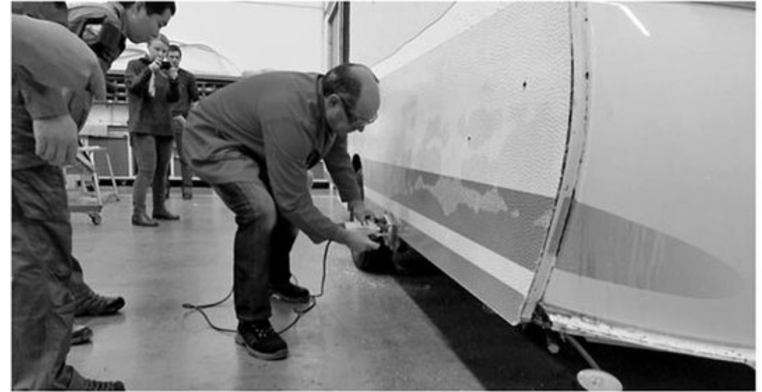
●次にルーターを使用しアルミパネルの開口部のカットを行なう。刃物の回転方向やアルミモールの取り付けが車体と水平になるよう注意が必要だ
