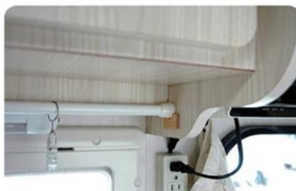
●キッチン上部の壁に突っ張り棒。下に板をかませることで棒の落下を防止する。カーテンをつり下げている
