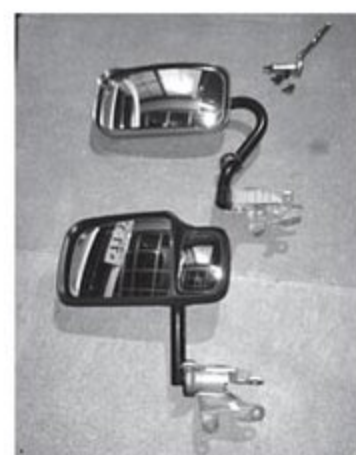
●サイドミラーはデュトロ用を流用。ベース部に加工が必要なのでキャン友に製作依頼した。ありがとうございます
