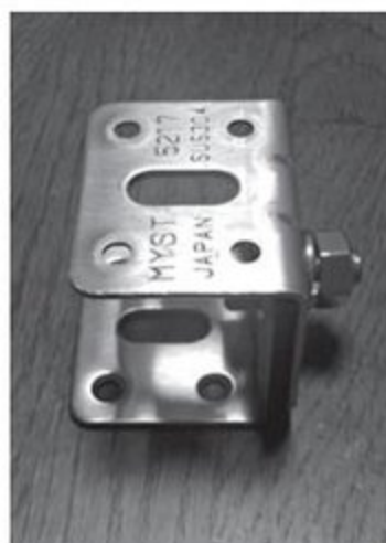
●FFヒーターの燃料ポンプの作動音を減らすため防振対策を施工。音は気にならなくなりました
