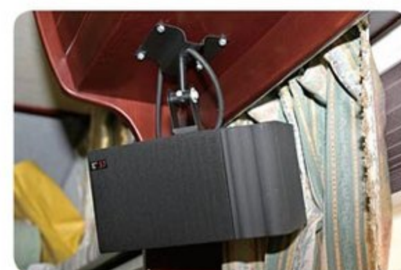
●車内で映像や音楽を楽しむために、お気に入りのスピーカー「DENON SC-5.5」を設置。天つりブラケットで固定
