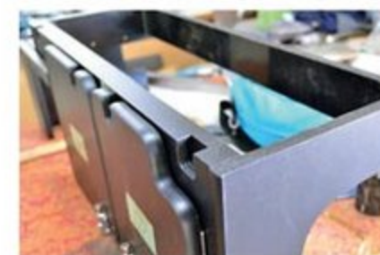
●スライドドア開口部の縁、フロアやモールをエッジまできちんと追いつけていることがわかる。車両の公差に合わせて1つずつ家具を製作しているためだ。量産品ではなかなかこうはいかない
