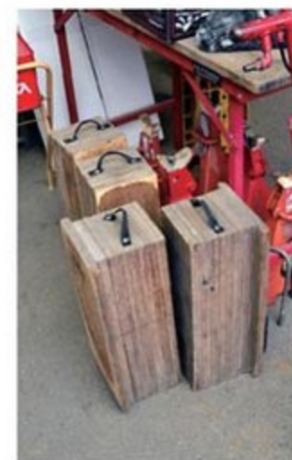
●キャンピングカー製造現場でよく目にするこれ、車体下での架装作業を手際よく行なうためのリフトアップ台である。ジャッキとウマを使うより安定性に優れるのだ
