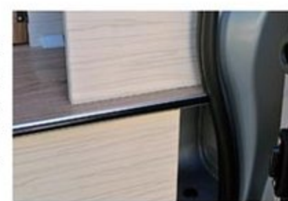
●スライドドア開口部の縁、フロアやモールをエッジまできちんと追いつけていることがわかる。車両の公差に合わせて1つずつ家具を製作しているためだ。量産品ではなかなかこうはいかない
