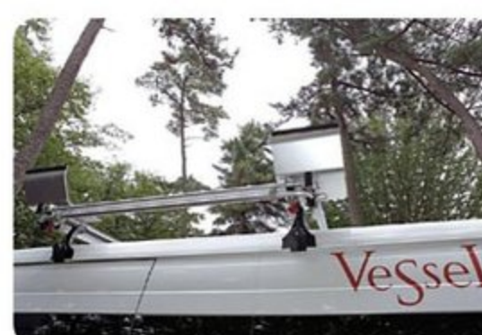
●ルーフ上にボードを積み下ろしするのをサポートするオーバースライダー。キャンプ場では物干し代わりに活用している
