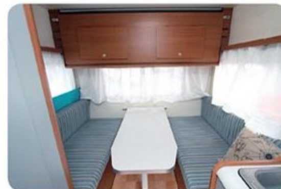
●ニの字ダイネットはマットを敷くだけでベッドに作り替えられる。子供用の折りたたみバンクベッドも備わる
