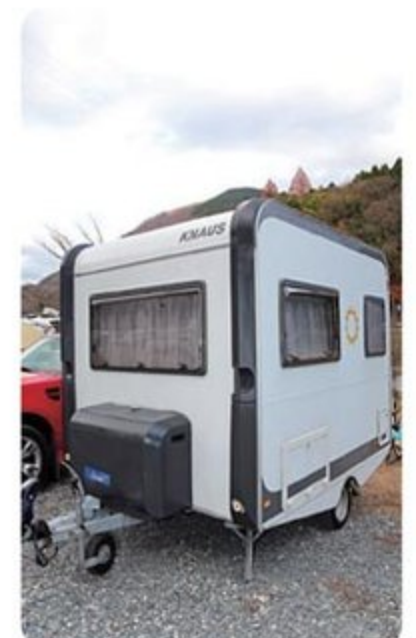
●デセオボックスのサイズは全長3720×全幅2100×全高2620mm。総重量720kgなのでけん引免許不要。スクエアな形が愛らしい
