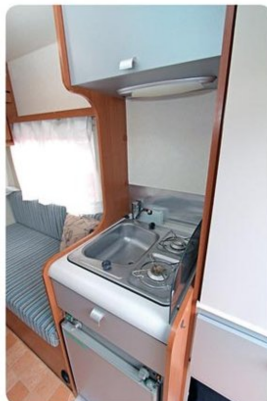
●デセオボックスの売りは日本の使用に適したVエディション。冷蔵庫とコンロのエネルギー源はコンビニでも調達できるカセットガス。暖房は灯油式FFヒーターを採用
