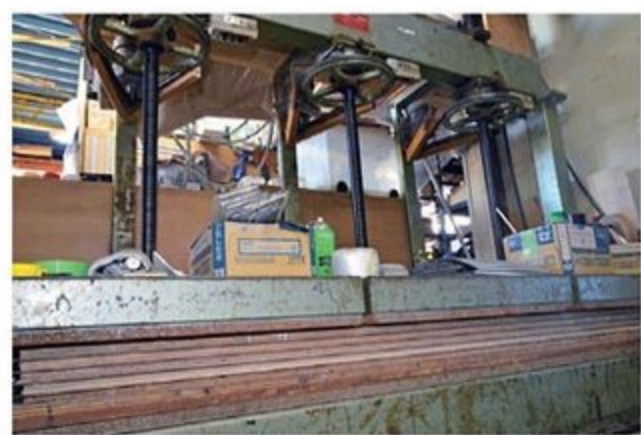
●プレス機で接着中の合板。作り置きはしないという、キャンピングカー作りの信念を表しているのがこの機械、とはいいいすぎか
