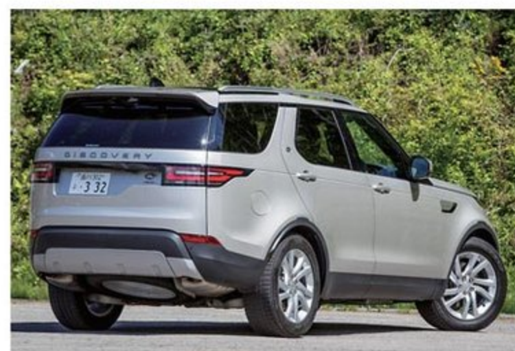
●ボディの85%にアルミを使うことで最大360kgもの軽量化を実現。前後にスキッドプレートを備え、悪路走破性が高い本格オフローダーだ
