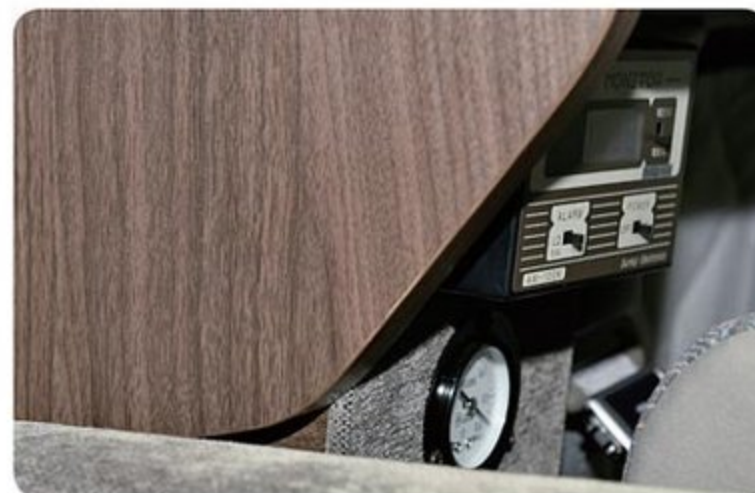
●エアサス用のタンク内空気圧をモニタリングするためのメーターは、車内に設置済み。車内で過ごしながらチェックすることが可能
