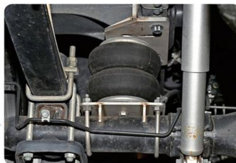
●海外製のエアサス用エアバッグと、自分で設計したブラケットを組み合わせたリヤのエアサス。仕事柄こうした金属加工はお手のもの
