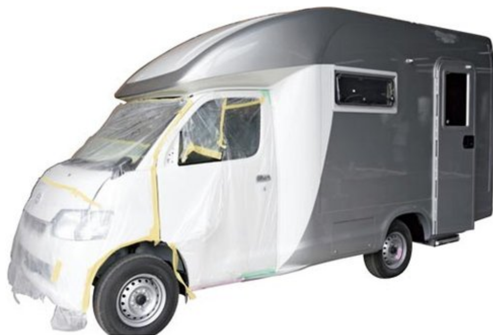
今回のパネル工法製作車両 TOM23
