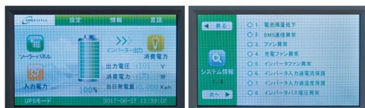
●充電は外部AC100Vと太陽光。入力電圧70～150Vのソーラーパネルに対応。バッテリー残量や充放電状態をグラフィックと数字で表示する液晶タッチパネルは移動可能
