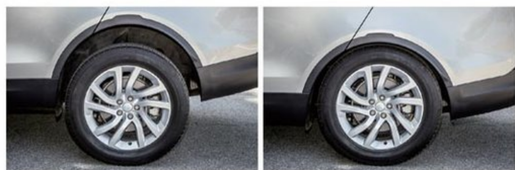
●エアサスは最大115mm車高を上げることができ、乗降時にシートベルトを外すと15mm低く、ドアを開けるとさらに25mm低くなる
