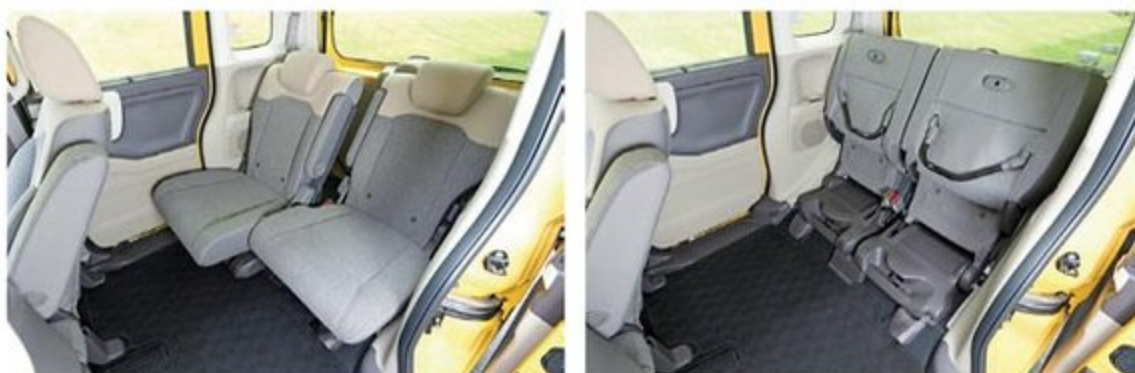
●リヤシートは左右が独立して190mmスライド可能。もちろんクッションを跳ね上げられるチップアップ機構付きのため、後席フロアに大きな荷物を積載することができる
