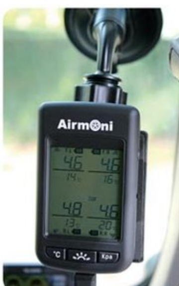
●タイヤの異常をいち早く発見できるよう、空気圧と温度をリアルタイムに表示するエアモニを装着。重い車両には心強いアイテム
