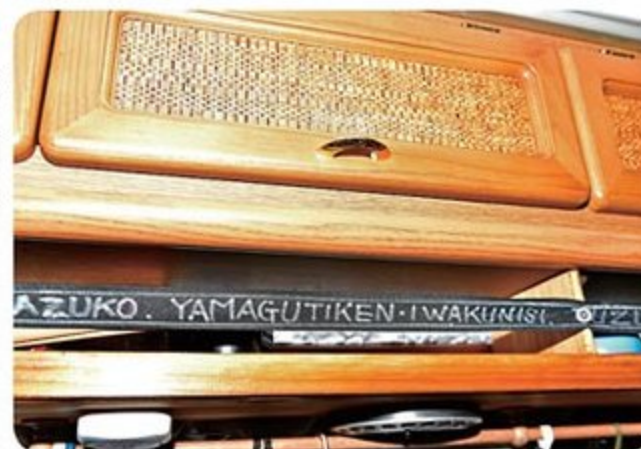
●上部収納の下にあるラックは、DIYにより追加されているがそのままだと収納物が落ちてしまうためゴムバンドを装着
