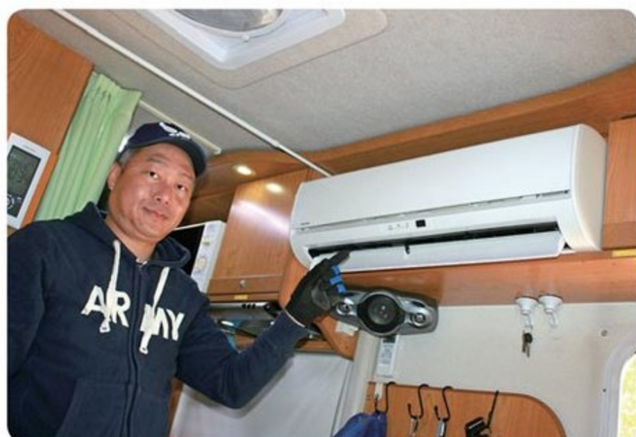
●キッチン上部の収納庫にキレイに収まった家庭用エアコン。室外機は車体左側のフロア下に搭載し走行性能の低下を抑制
