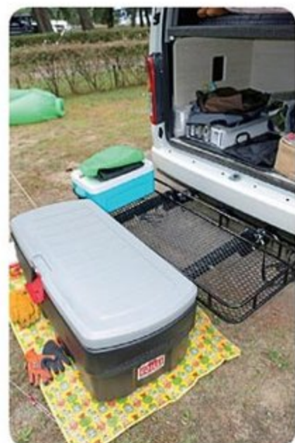
●車内に入り切らない荷物はヒッチキャリアに収納。リヤオーバーハングが長くなるものの、収納スペースが限られるバンコンでは利用価値が高い
