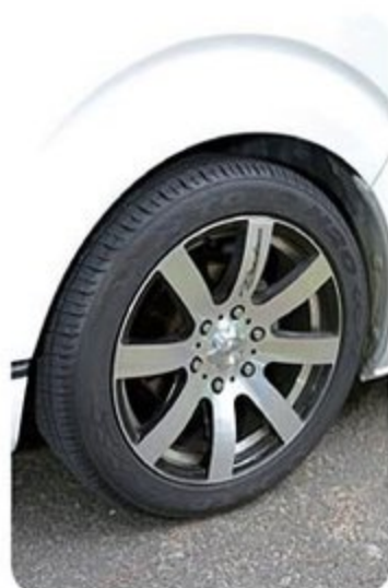
●ファミリーワゴンLは3ナンバーだが、ベース車は商用バンのハイエースなのでJWL-T規格をクリアしたホイールとバン用タイヤを履かせている
