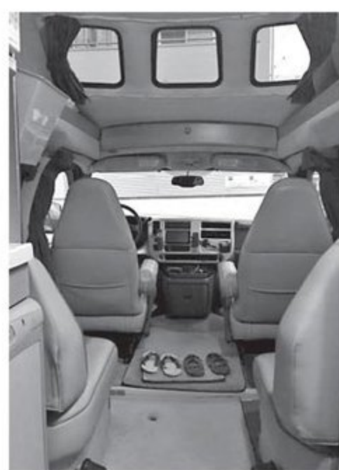
●フロントシートを回転させ、セカンドシートとで4人分のダイネットになります。中央の通路も確保され、室内の移動もしやすい
