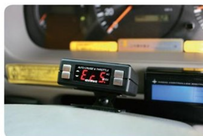
●高速巡航時に便利なオートクルーズコントローラーも装着。アクセルレスポンスも変えられるので、運転疲れの軽減にも効果的だ
