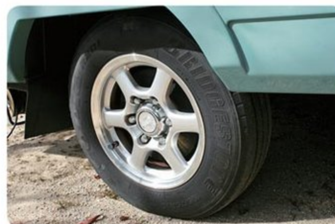
●タイヤはブリヂストンのエコピアを装着。トレッド部のブロック剛性が高いので、しっかりとした走行フィールを与えてくれる
