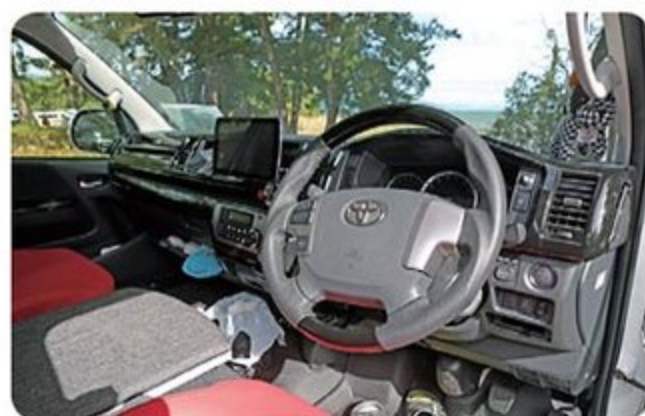
●インパネまわりは市販のパネルを装着して質感アップ。ステアリングはエアバッグやスイッチ類など純正の機能を損なわずに握りやすいグリップ形状に変更
