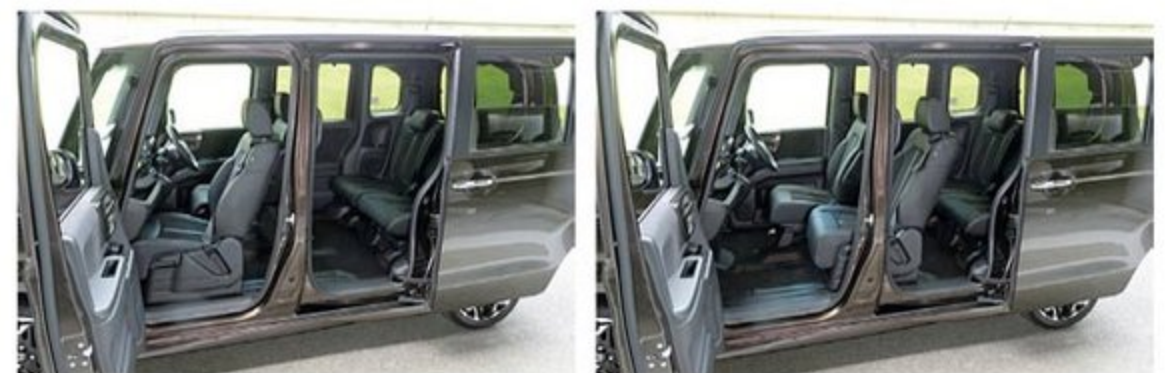
●新設計のセンタータンク採用によって実現したのが、助手席スーパースライドシート。後方にスライドさせ、運転席から助手席側に足を出せば靴をヒールからスニーカーに履き替え可能
