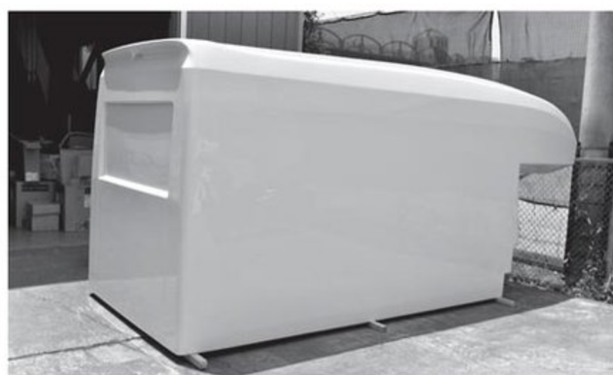
●型から取り出されたFRPシエル
