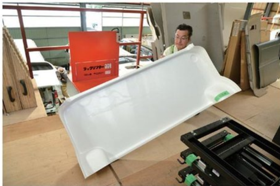
●高品質なリヤマルチルームの防水パンなどは自社製。組み込みには、驚くほど高度な技術が必要なのだ
