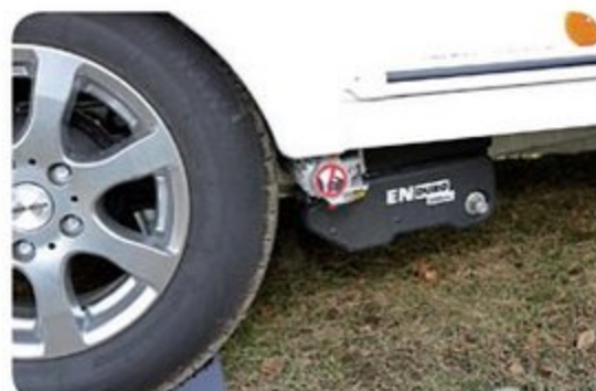
●「便利過ぎてバックでの駐車がいっように上達しません…」と藤田さんを嘆かせるムーバー。切り返しが困難な狭いサイトでもスムーズに駐車できる
