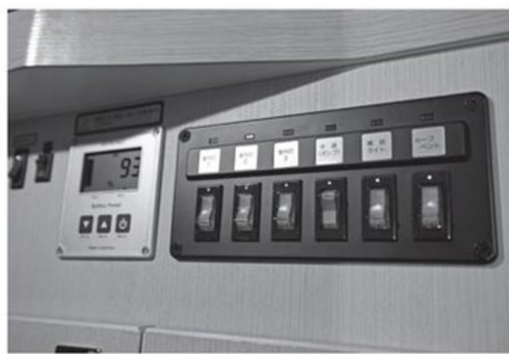
●こちらが6連スイッチ。ひと目でわかるのが便利。左のデジタル表示のパネルは電圧計だ
