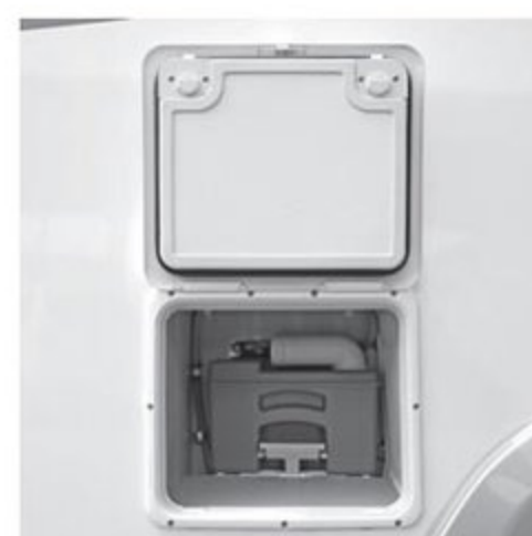
●カセットトイレは汚水タンクを車外から取り出して処理する
