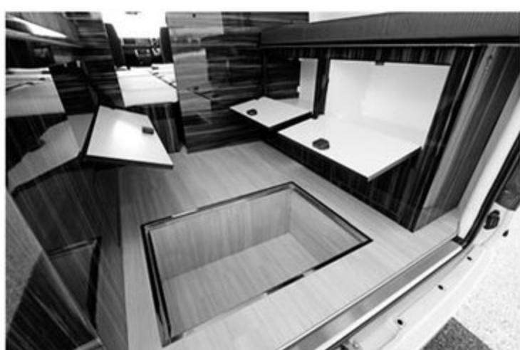
●キッチン前の室内高を確保するための裏技的手法だが、床下収納庫としても十分な容量がある
