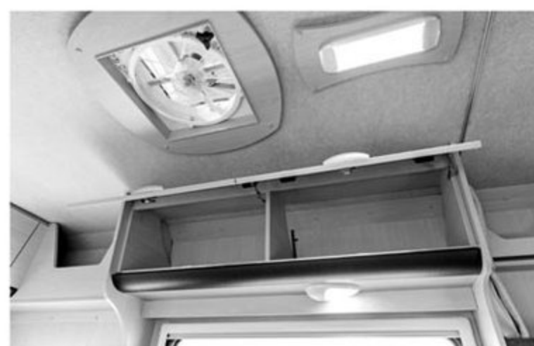
●上部収納庫にストッパーが付いていると、扉を開けたままで出し入れができるので便利
