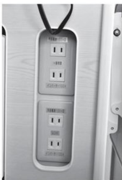
●サブバッテリーを介さず100V製品が使えるコンセントと、サブバッテリー&インバーターを介するタイプとを分けているモデルもある
