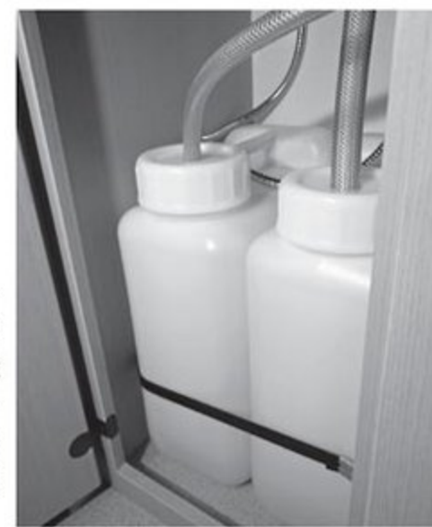
●国産キャンピングカーの典型的な給排水タンク。走行中、収納庫から飛び出さないようにバンドなどで固定されている
