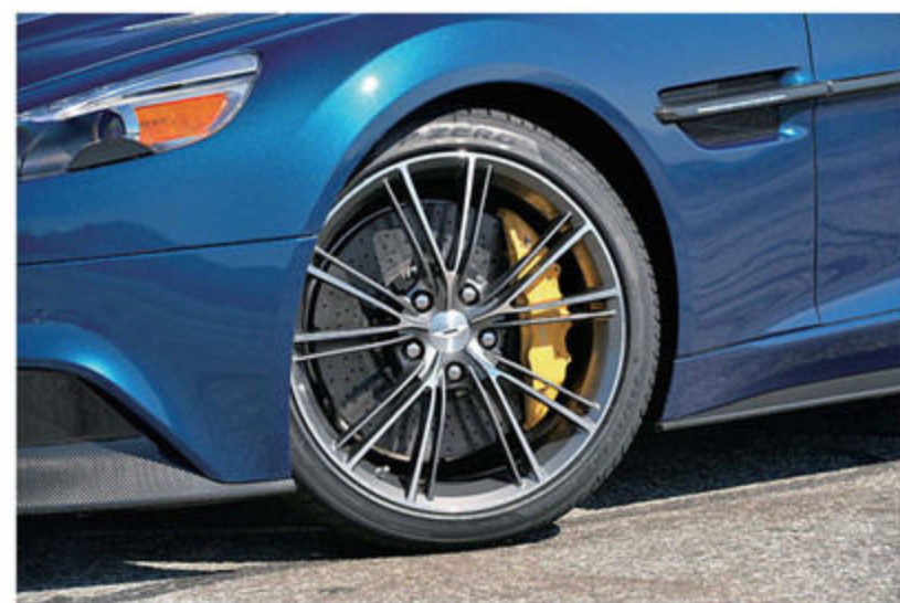
最高出力573ps/最大トルク63.2kgmを発揮する6ℓV12は、前項で 取り上げたV12ヴァンテージSと同じスペックではあるものの、ヴァ ンキッシュ・ヴォランテが積むエンジンの型式はAM11となる。ブ レーキはブレムボ製の第3世代カーボンセラミックを採用。
