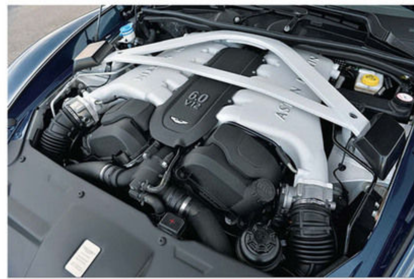
最高出力573ps/最大トルク63.2kgmを発揮する6ℓV12は、前項で 取り上げたV12ヴァンテージSと同じスペックではあるものの、ヴァ ンキッシュ・ヴォランテが積むエンジンの型式はAM11となる。ブ レーキはブレムボ製の第3世代カーボンセラミックを採用。
