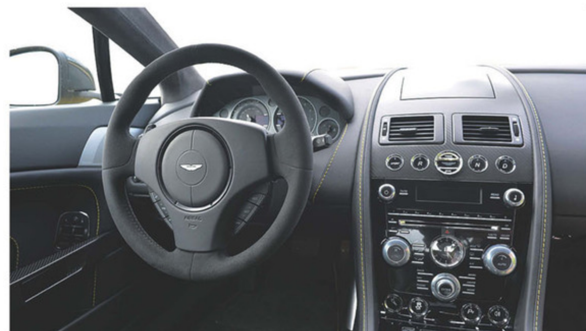
近代アストンマーティンの方程式を取り入れたスポーティかつラグジュアリーなキャビンでは、驚異的なまでにノイズが削減される。また、カーボンケブラーを積極的に用いたシートは17kgの減量に成功し、運動性能向上に貢献している。
