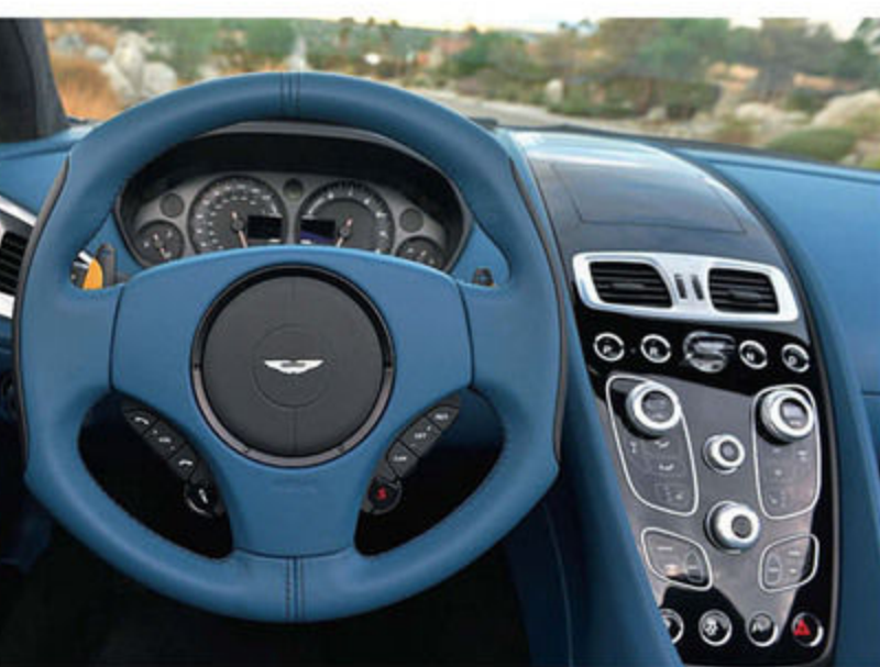
オープンモデルらしく外から見えることを意識したインテリアデザインが秀逸。安全面ではサイドカーテンエアバッグを始め、アクシ デント時にはリヤヘッドレスト裏からロールバーが飛び出す“ロール オーバープロテクションシステム”を搭載し万全を期す。
