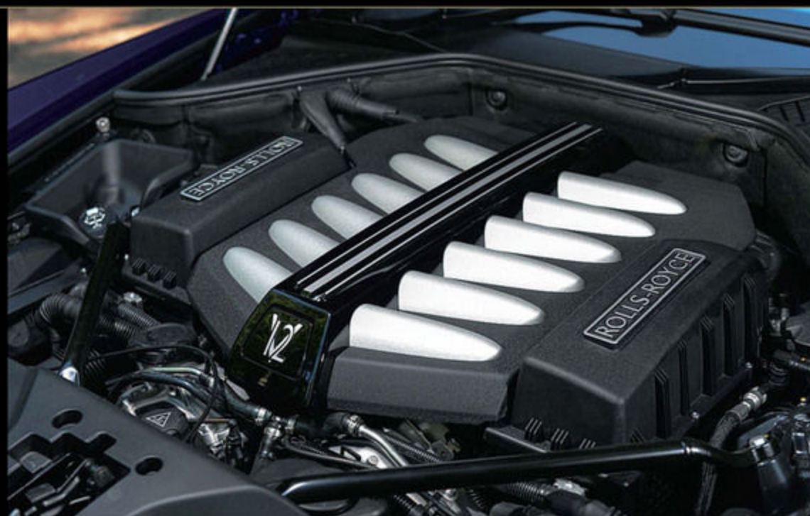
搭載されるエンジンは、6.6ℓ仕様のV型12気筒ツインターボ。最高出力630ps、最大トルクは800Nmという、ベースのゴースト比で60ps & 20Nmの向上を果たしている。しかもアクセラレスポンスも明らかにレイスはスポーティ仕立て。俊敏性は桁違い。
