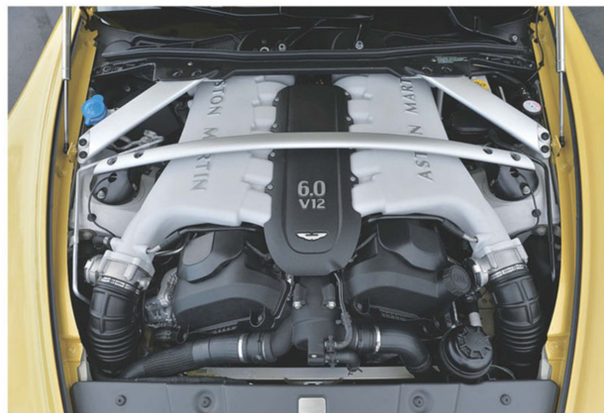
6.0 V12NAエンジンは最高出力573ps／最大トルク63.2kgを発生し、0→100km/hを3.9秒で駆け抜け、最高速度は330km/hに達する。このエンジン型式AM28と呼ばれるユニットはベースであるV12ヴァンテージに専用のチューンを施し、56psの向上を得ている。
