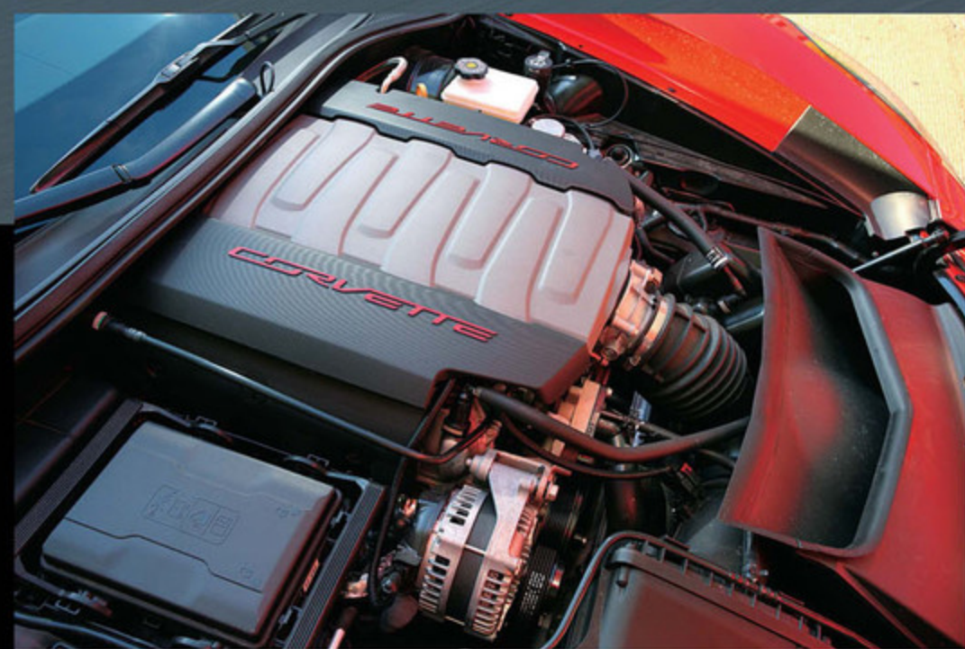
スモールブロックの6.2ℓLT1ユニットは直噴化され、可変バルブタイミング機構が与えられている。クーペ用はウエットサンプ式だが、Z51用は先代C6のZ06やZR1で採用されていたドライサンプ式となった。インテークマニホールドは全面刷新されている。
