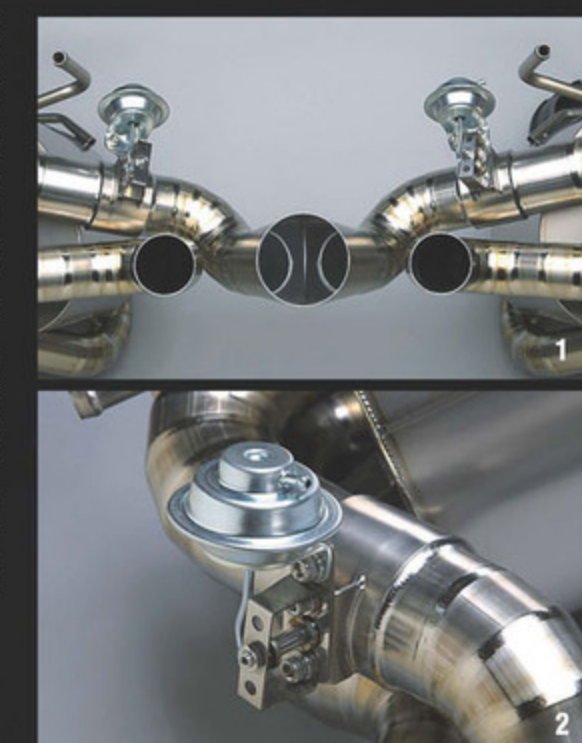
1.バルブを開放時は中央から9割、残りの1割の排気ガスが両サイドから排出される。重量は純正マフラーの約29kgと比べてキャタストリート仕様は約20kgも軽く、運動性能の向上にも寄与する。 2.パイプやサイレンサー、バルブもチタン製。キャタパイプフランジも無垢材の削り出しだ。バルブは純正動作の他、無段階アクセル連動タイプ、ワイヤレスリモコンで作動する。 3.スパインでは「3D計測システム」という3次元のスペース解析装置を使用。サスペンションやボディフレーム、ディフューザーに当たらないレイアウトをPC上で解析している。
