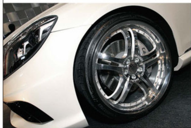
レース活動が市販プロダクトに活かされるその代表例がホイールである。ホイール自体の強さと軽さが耐久レースでの勝利へと直結する。写真は1/5 EVO Ultra Light Forgedだ。
