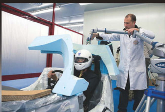
ほぼデザインが決まっているというだけに、カーボンモノコックのサイズも確定しているのだろう。コクピットのルーフクリアランスを確認をしている。そしてこのプロジェクトのキーマン、パオロ・ガレラ氏の姿も確認できる。
