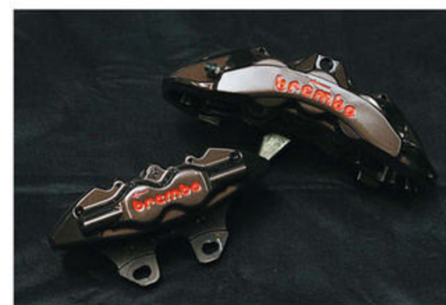
ブレーキの加工、流用なども人気メニュー。写真はAMG製キャリパーに切削とペイントを施したもの。その他、様々なオーダーに対応する。
