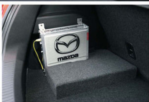
車体構成はベースとなったデミオEVと共通点が多く、インパネにはパワーメーターと航続可能距離を表示する。タンク容量9ℓのガソリンで発電し約400km走行が可能。トランクスペースを犠牲にしない設計であり、僅かにラゲッジルーム左側に制御ユニットを備えるのみ。発電時にエンジンは始動するがその静粛性の高さは特筆すべきポイントだ。
