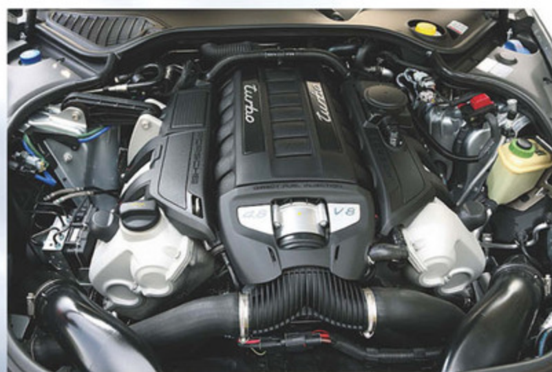
4.8 L V8 ツインターボは520psの最高出力と700Nmの最大トルクを発生。7速PDKを通じて全輪を駆動する。オートスタート/ストップ機能により、走行速度が7km/h以下で自動停止するなど、低燃費性能も進化した。
