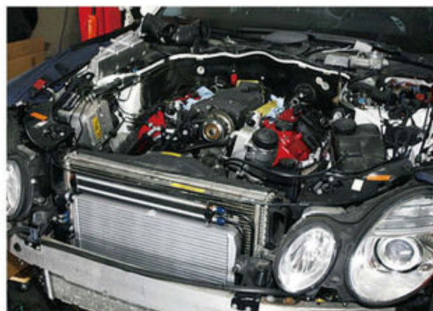
←現在進行中なのが、E320にAMG C32のエンジンを積み替える作業。ワンオフパーツの製作や大幅な加工により、きれいに収まっている。
