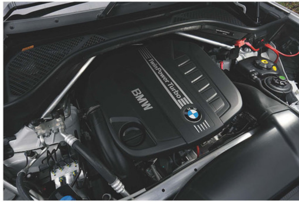
3.0L直6ディーゼルターボエンジンが発揮するパフォーマンスは、最高出力258ps/最大トルク560Nm。世界でもっとも厳しいと言われる日本の排出ガス基準「ポスト新長期規制」をクリアするBMW BluePerformanceテクノロジーを採用し、燃費は13.8km/ℓを達成する。
