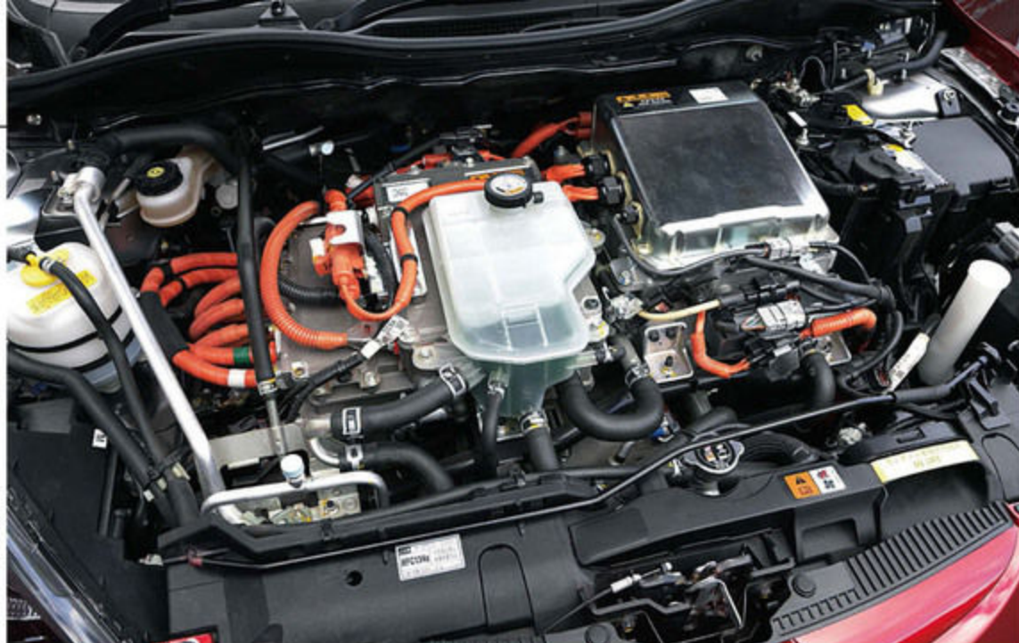
通常ではエンジンがあるボンネット内にフロントアクスルを駆動するモーターと補機類を備える。発電に用いられる1ローター・330ccのロータリーエンジンは水直配置として、リヤのトランク下に収まるように天地長を抑えたコンパクトな設計。最高出力は29.9ps。
