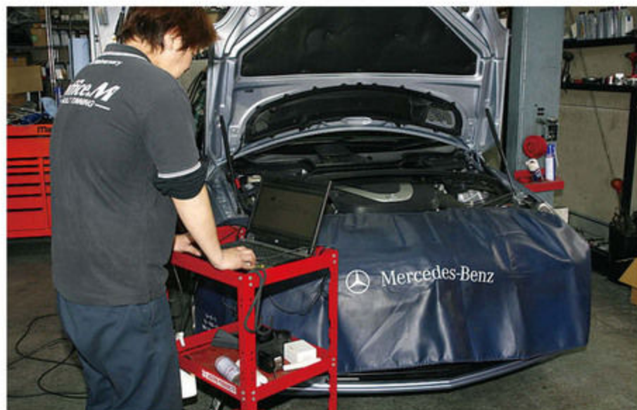
メルセデス・ベンツ純正のテスター「DAS」をはじめ、各種テスターを用意しているので、全てのベンツの整備、修理が可能だ。
