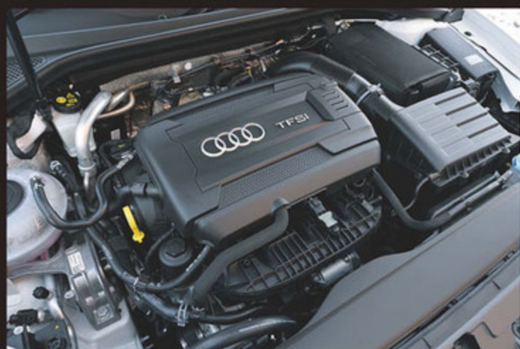
エンジンは1.8ℓのTFSI。最高出力は180psと平凡だが、280Nmの最大トルクが1750rpmから発生し、最高出力が発生する4000rpmまで持続されるため全域で加速感が続く。
