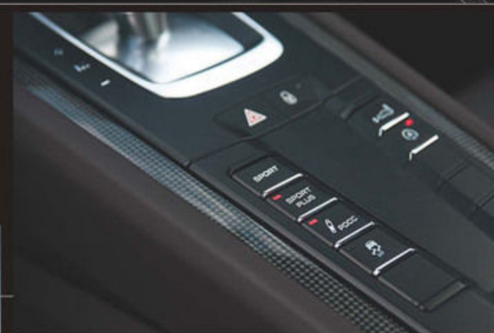
カレラGTに端を発する、新世代ポルシェの象徴とも言えるセンターコンソールには、SPORT/SPORT PLUSのドライブモード・スイッチやダンパーの切り替えスイッチなどが並ぶ。エンジンフードを開けても冷却ファンがあるだけで、エンジン本体は見る事ができない。
