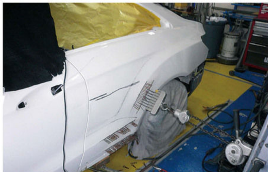
モノコックスタンダードを用いた作業により、フェンダー交換することなく美しく修復されていくメルセデス・ベンツE250。もちろん剛性や強度も心配なし。
