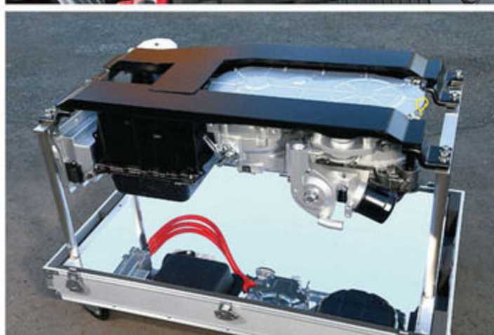
通常ではエンジンがあるボンネット内にフロントアクスルを駆動するモーターと補機類を備える。発電に用いられる1ローター・330ccのロータリーエンジンは水直配置として、リヤのトランク下に収まるように天地長を抑えたコンパクトな設計。最高出力は29.9ps。
