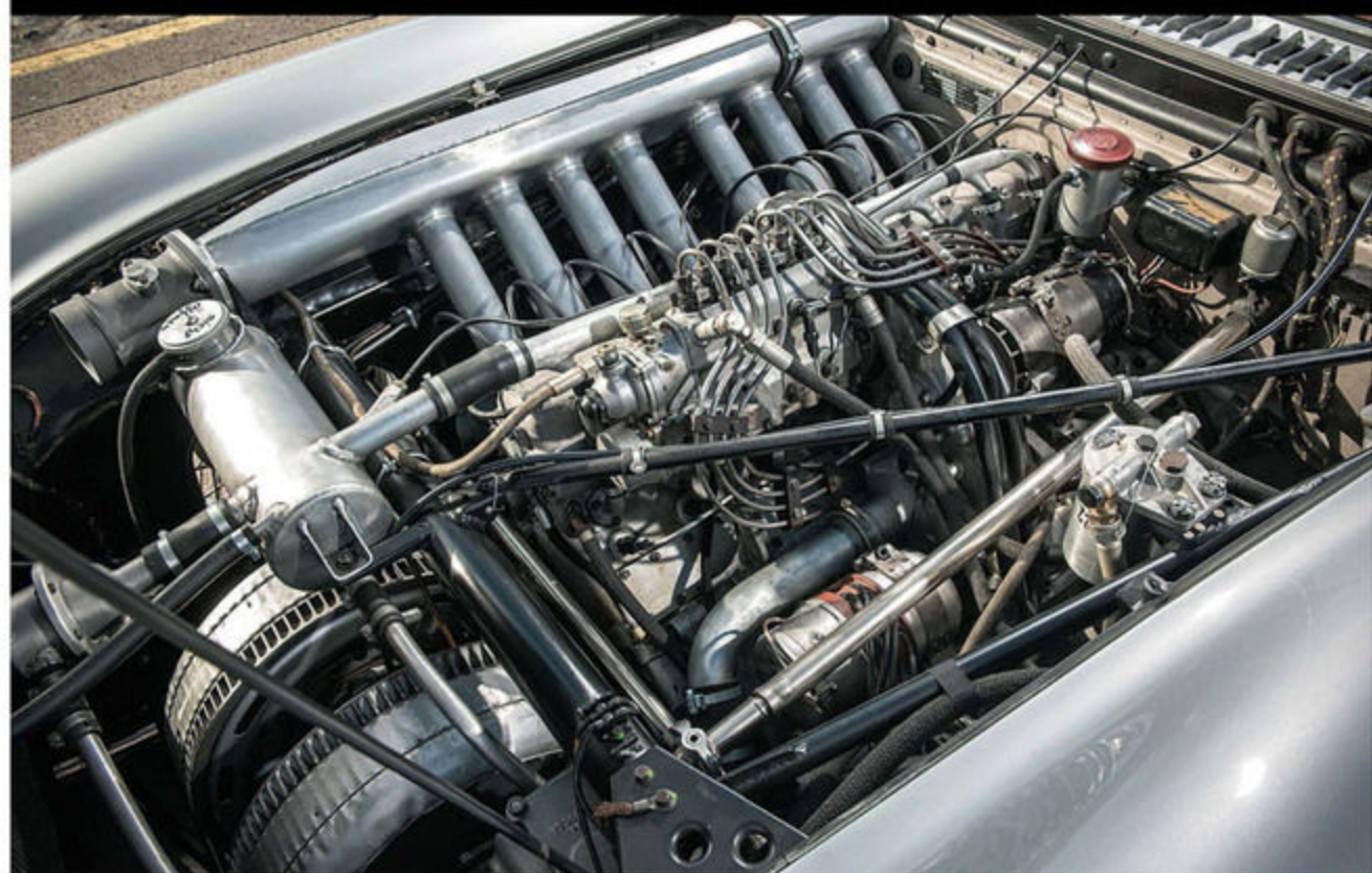
3000rpmを超えると俄然生気を帯びる2982ccDOHC直列8気筒ユニットは33度右に傾けて搭載され、ボンネットを低めるのに役買っている。手前に見えるのはインボードのアルフィン・ドラムブレーキ。
