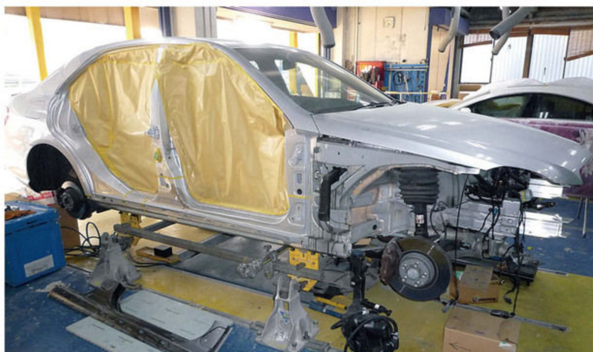
3次元修正器・モノコックスタンダードは、エンジンを降ろさず作業遂行が可能なため、時短やコスト削減のみならず、完璧な仕上がりが期待できる。
