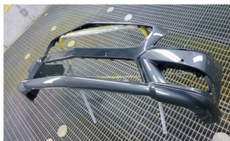
CLSシューティングブレークのフロントバンパーをリペア後、PPG製塗料にて塗装。完璧な修復ぶりと調色ぶりが見て取れる同店自慢の仕上げ。
