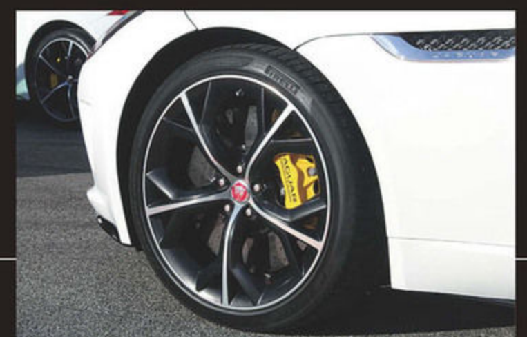
リヤスポイラーは、テーパーの付いたテールゲートの先端部分に隠されているが、70マイル(112km/h)の速度に達すると自動的にせり上がり、50マイル以下(80km/h)になると戻る設定だ。最大で120kgの揚力を低減する。オプション設定のカーボン・セラミック・マトリックスブレーキ(前398mm径/後380mm径)は、絶対的な制動力を発揮し、装備すればバネ下荷重が21kgも軽くなる。
