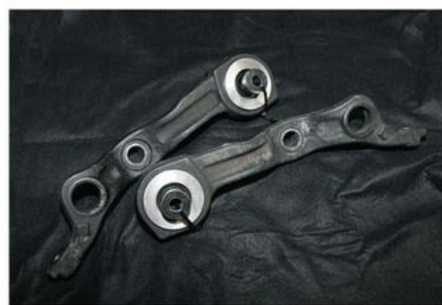
オリジナルパーツとして作成したピロブッシュ。ハイスピードからのブレーキング時に起こるグニャッとした感じを払拭して安定させることに成功している。
