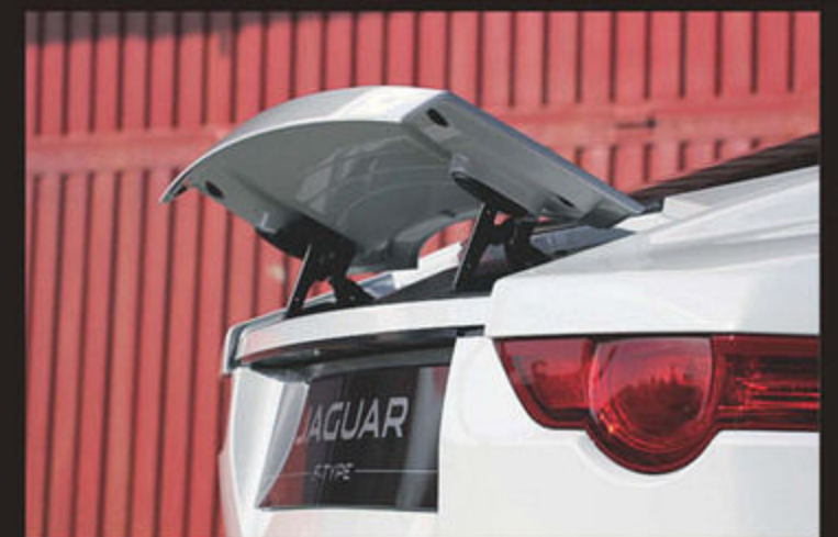
リヤスポイラーは、テーパーの付いたテールゲートの先端部分に隠されているが、70マイル(112km/h)の速度に達すると自動的にせり上がり、50マイル以下(80km/h)になると戻る設定だ。最大で120kgの揚力を低減する。オプション設定のカーボン・セラミック・マトリックスブレーキ(前398mm径/後380mm径)は、絶対的な制動力を発揮し、装備すればバネ下荷重が21kgも軽くなる。
