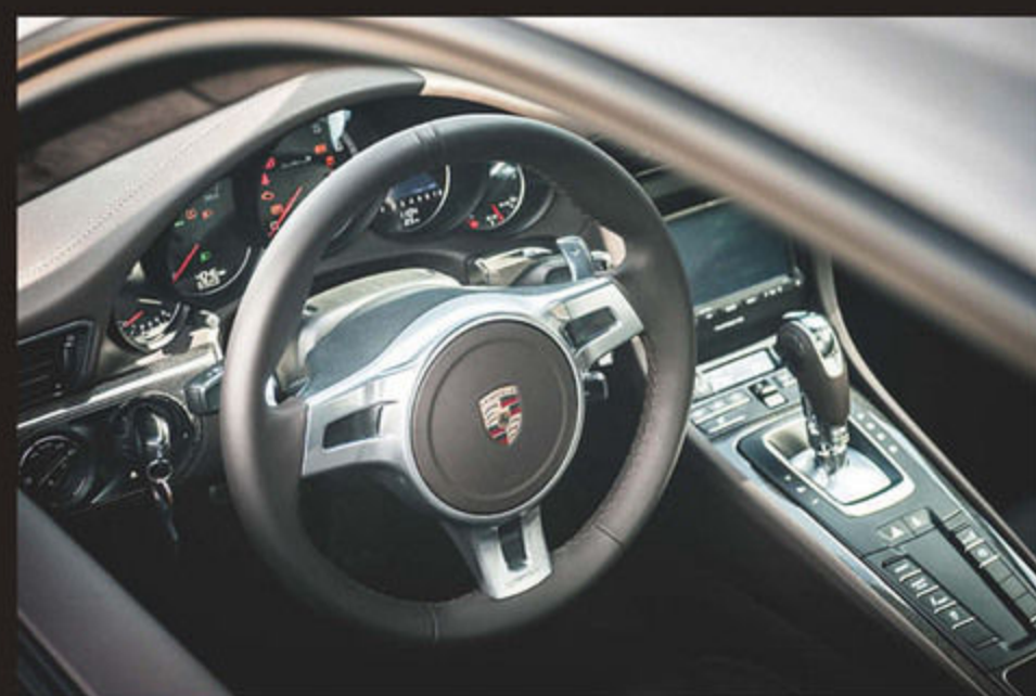
カレラGTに端を発する、新世代ポルシェの象徴とも言えるセンターコンソールには、SPORT/SPORT PLUSのドライブモード・スイッチやダンパーの切り替えスイッチなどが並ぶ。エンジンフードを開けても冷却ファンがあるだけで、エンジン本体は見る事ができない。
