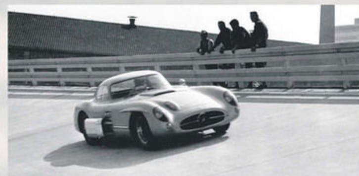
上)0007/55 “ウーレンハウト” クーペ。サイドの巨大なマフラーに注目。下)メルセデスの運命を決定づけた55年ル・マン。スタートするピエール・ルヴェーの300SLR。
