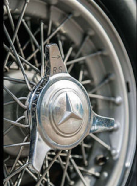
タイヤサイズはフロント6.00×16、リヤ7.00×16。ホイールはこの時代のスタンダードといえるセンターロックのワイヤ一式。ちなみにクーペの重量配分は41:59となっていた。
