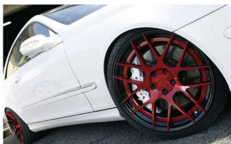
CLKにはBCフォージドの鍛造ホイールをツライチでセット。足まわりやブレーキも強化して、見た目だけではないチューニングが施される。
