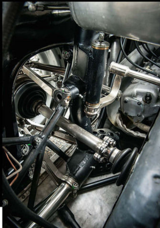
3000rpmを超えると俄然生気を帯びる2982ccDOHC直列8気筒ユニットは33度右に傾けて搭載され、ボンネットを低めるのに役買っている。手前に見えるのはインボードのアルフィン・ドラムブレーキ。
