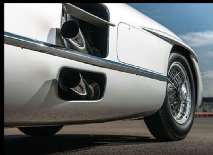
サイド出しのエキゾーストパイプ。しかしこのままの状態で公道を走ることは許されず、ウーレンハウトの0007/55は箱状の大きなマフラーを装着することを余儀なくされた。
