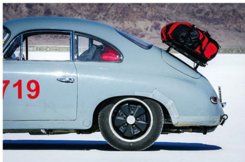
911用の5.5J「フックスホイール」を敢えて356にセレクトするのは、ある意味定番といえるモディファイ。室内に収まりきらない荷物(かなり遊び道具も多いが)は、リヤに取り付けたキャリアに括り付けている。
