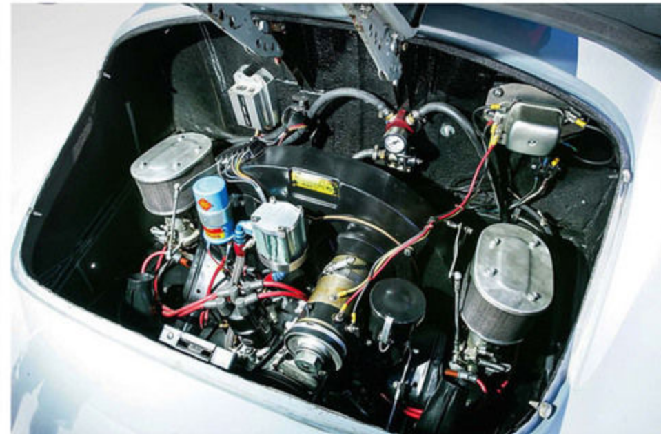
エンジンはレストアの途中で地元のスペシャリストから手に入れた356C用に載せ換えられた。ボアアップなどレース用のチューニングメニューが施されていたこともあり、パワー的にはマットを満足させたのだが……。
