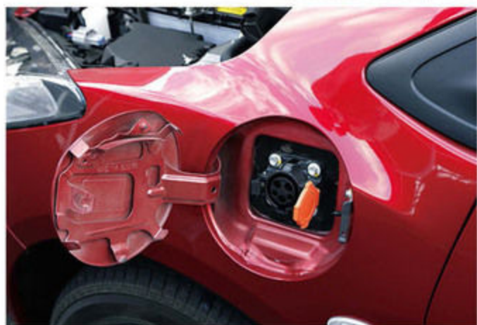
車体構成はベースとなったデミオEVと共通点が多く、インパネにはパワーメーターと航続可能距離を表示する。タンク容量9ℓのガソリンで発電し約400km走行が可能。トランクスペースを犠牲にしない設計であり、僅かにラゲッジルーム左側に制御ユニットを備えるのみ。発電時にエンジンは始動するがその静粛性の高さは特筆すべきポイントだ。
