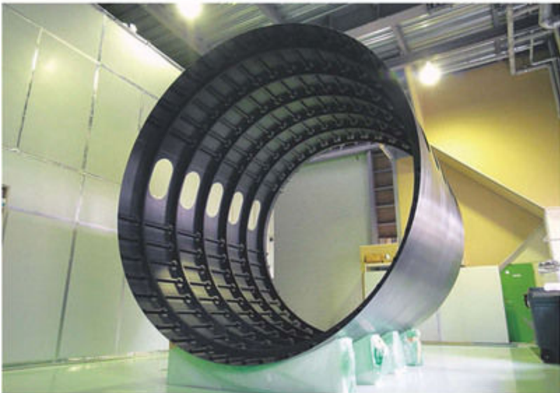
JAXAとの共同研究開発はVaRTMによる主翼一体構造の低コスト成形法の確立にはじまり、構造試験にも合格する実物大の主翼構造を製作するまでに至った。さらに、プリプレグ成形とVaRTM成形を組み合わせたハイブリッド一体成形で、さらに大きな航空機の胴体構造の製作に成功している。写真提供/JAXA
