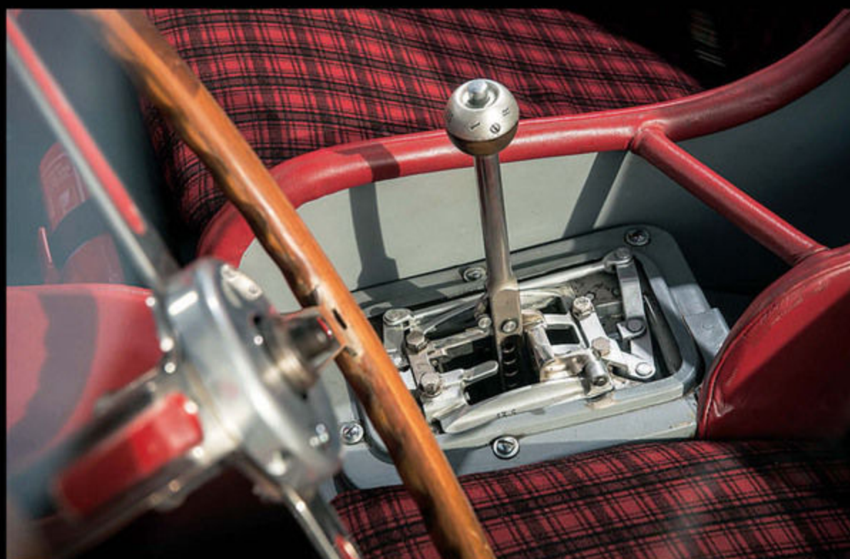
デスターを悩ませたギヤボックス。左奥が1速。そこから右下へと動かすと2速に繋がる。ミッレ・ミリアの練習中に2速から3速ではなく、5速にミスシフトしやすいというモスの忠告で改良が施された。
