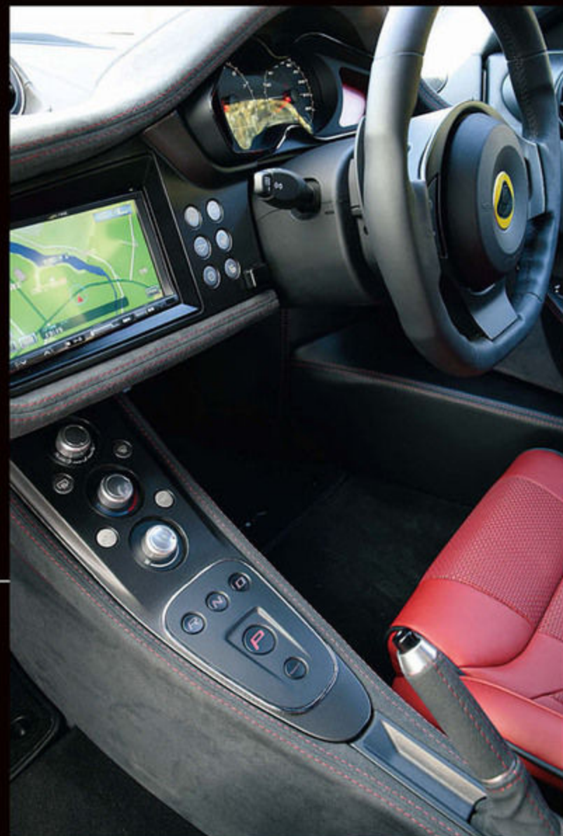
6速ATのIPS（インテリジェント・プレジジョン・シフト）は、ステアリングに備わるパドルでマニュアルシフトが可能。リバース/ニュートラル/ドライブの選択はセンターコンソールに集約されたスイッチで選択し、標準装備のスポーツボタンもここに設置。
