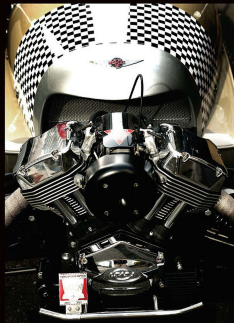
ノーズに剥き出しで搭載する2ℓ空冷V型2気筒OHVはS&S製で、5速マニュアルトランスミッションはマツダ製を採用。Vツインの鼓動感は凄まじく、まるで生き物のようなフィーリングを味わえる。リヤカウル内に僅かなラゲージスペースを用意するが実用性は高くない。駆動はベルトを通じて後輪で行う。
