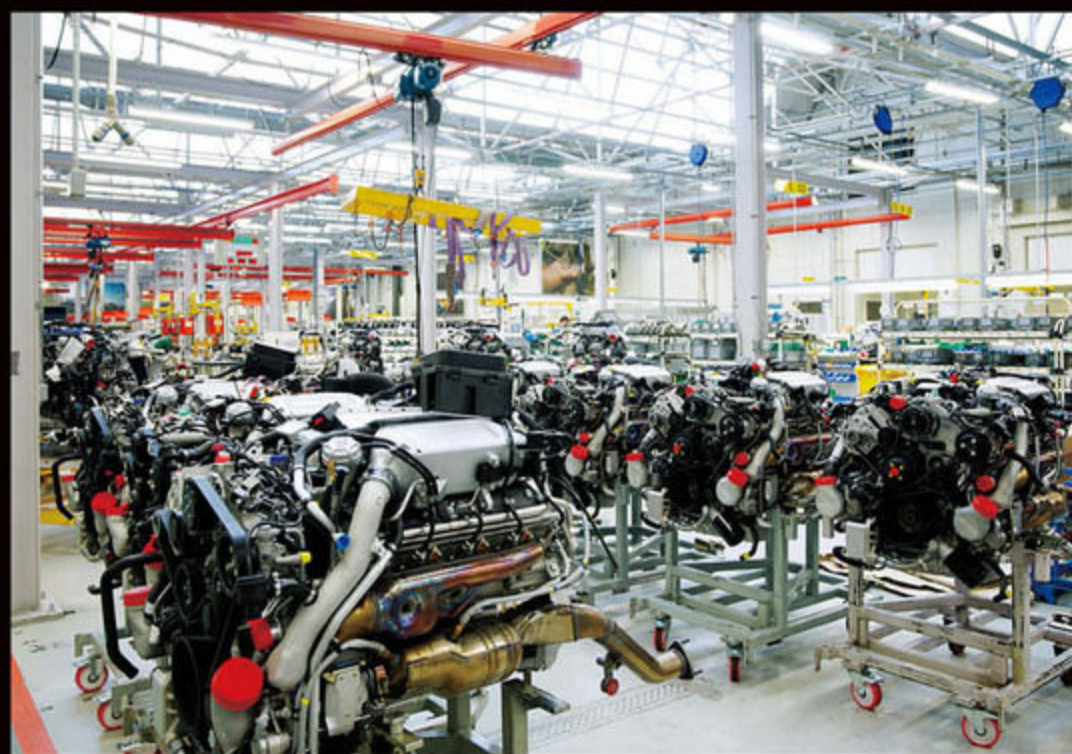
年代を感じるレンガ造りの建物に一步入ると、そこはタイムスリップしたかのように近代的なエンジンの製造ラインだった。マイスターの手によって6.75ℓ V8エンジンが、1基ずつ手作りで組み上げられていく様子はまさに、伝統工芸と呼ぶに相応しいものだ。
