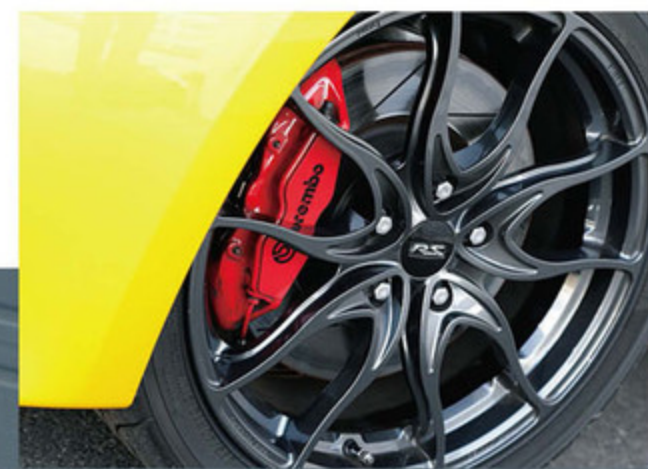
2.0直4ターボが発生する出力は265ps/360Nmで、ニュルの北コースでは市販FFモデル最速タイムを記録している。試乗車はオプションの18インチ鍛造ホイールとアドバン・ネオバを装着していた。
