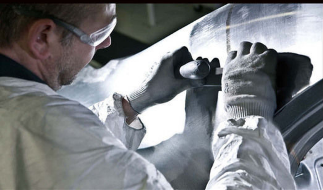
ミュルザンヌの特徴のひとつであるDピラーの滑らかで継ぎ目のないライン。これを再現するのは熟練の钣金職人たちの仕事である。専用の工具を携え、指先で確認しながら丁寧に面を整えていく。
