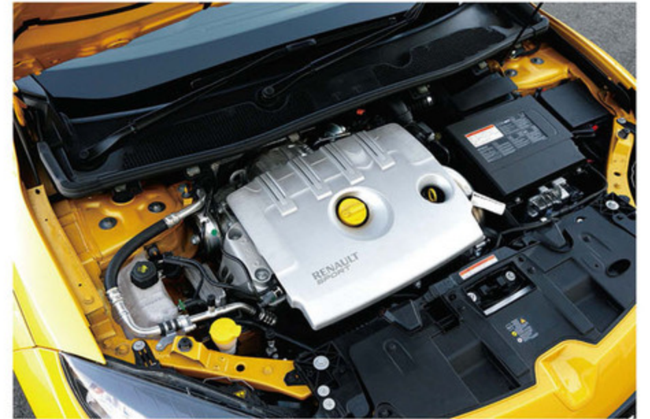
2.0直4ターボが発生する出力は265ps/360Nmで、ニュルの北コースでは市販FFモデル最速タイムを記録している。試乗車はオプションの18インチ鍛造ホイールとアドバン・ネオバを装着していた。
