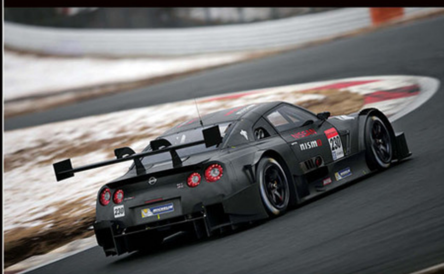
ニッサンはこれまでと変わらないR35型GT-Rを使用するものの、2014年のレギュレーションに合わせた完全なニューマシン。エンジンはトヨタ、ホンダと同様に2.0ℓ直4直噴ターボエンジンを搭載する。
