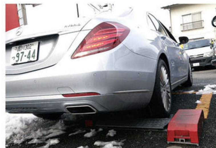
ハイブリッドカーの場合、コインパーキングのフラップを乗り越えるような、ものすごく低速での走行中、モーター駆動からいきなりエンジンに切り替わって速度が出るようなケースもあるのでアクセルの踏み方には注意が必要だ。
