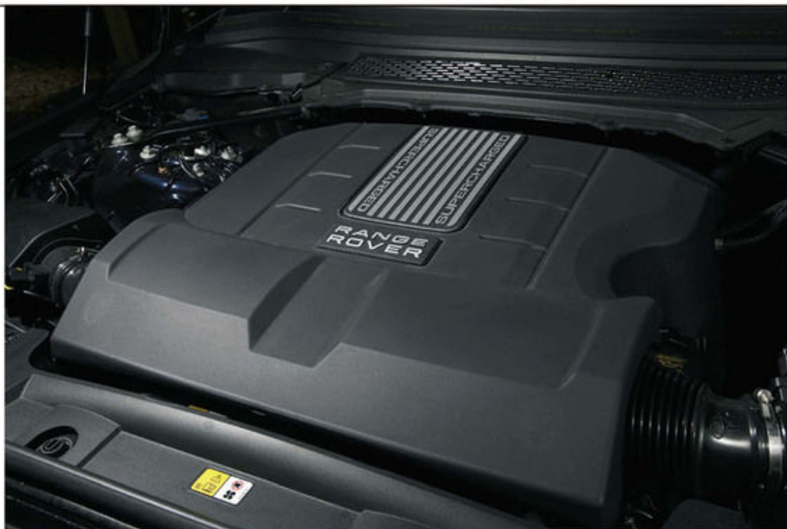
SEが積むV型6気筒3.0直噴スーパーチャージド・ユニットのスペックは最高出力340ps、最大トルク450Nm。2250kgのオールアルミボディには十分な余裕アリ。
