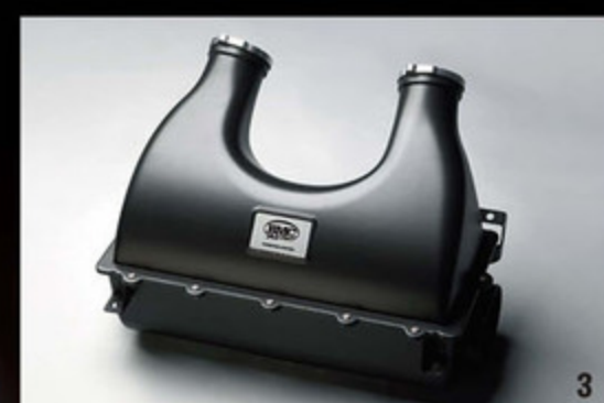
3. ドライカーボン製のエアフィルターボックス。純正から微妙に形状変更され、内部に仕切板を入れるなどして、左右のバンクに均等な空気が流れるよう設計されている。フェラーリ458イタリアの純正との比較値は、重量が15%減、エアボックス容量が7%アップし、フィルター面積は+80%広がっている。
