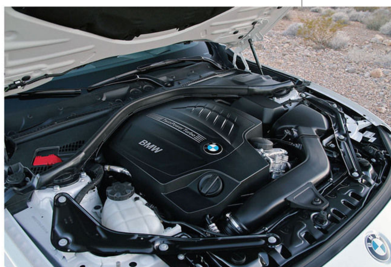
最高速は250km/h、最高出力306psを誇る直列6気筒に組み合わされるのは6速MT。オプションで8速オートマチックも選択可能だ。
