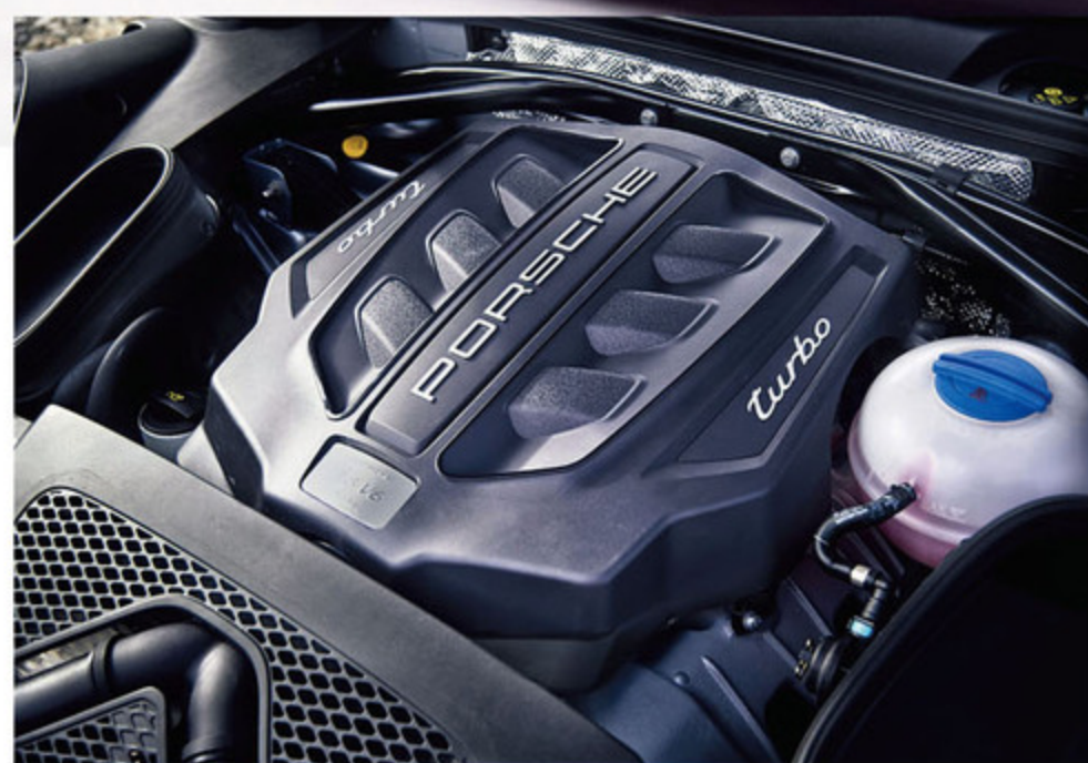
マカン・ターボに搭載される3.6ℓ V6直噴ターボエンジン。マカンSの3.0ℓ V6ターボと比較すると、最大出力で60ps、最大トルクで90Nmものパワーアップを果たしている。ターボには大型ブレーキ、75ℓ容量の燃料タンク、PASMなどが標準で装備される。
