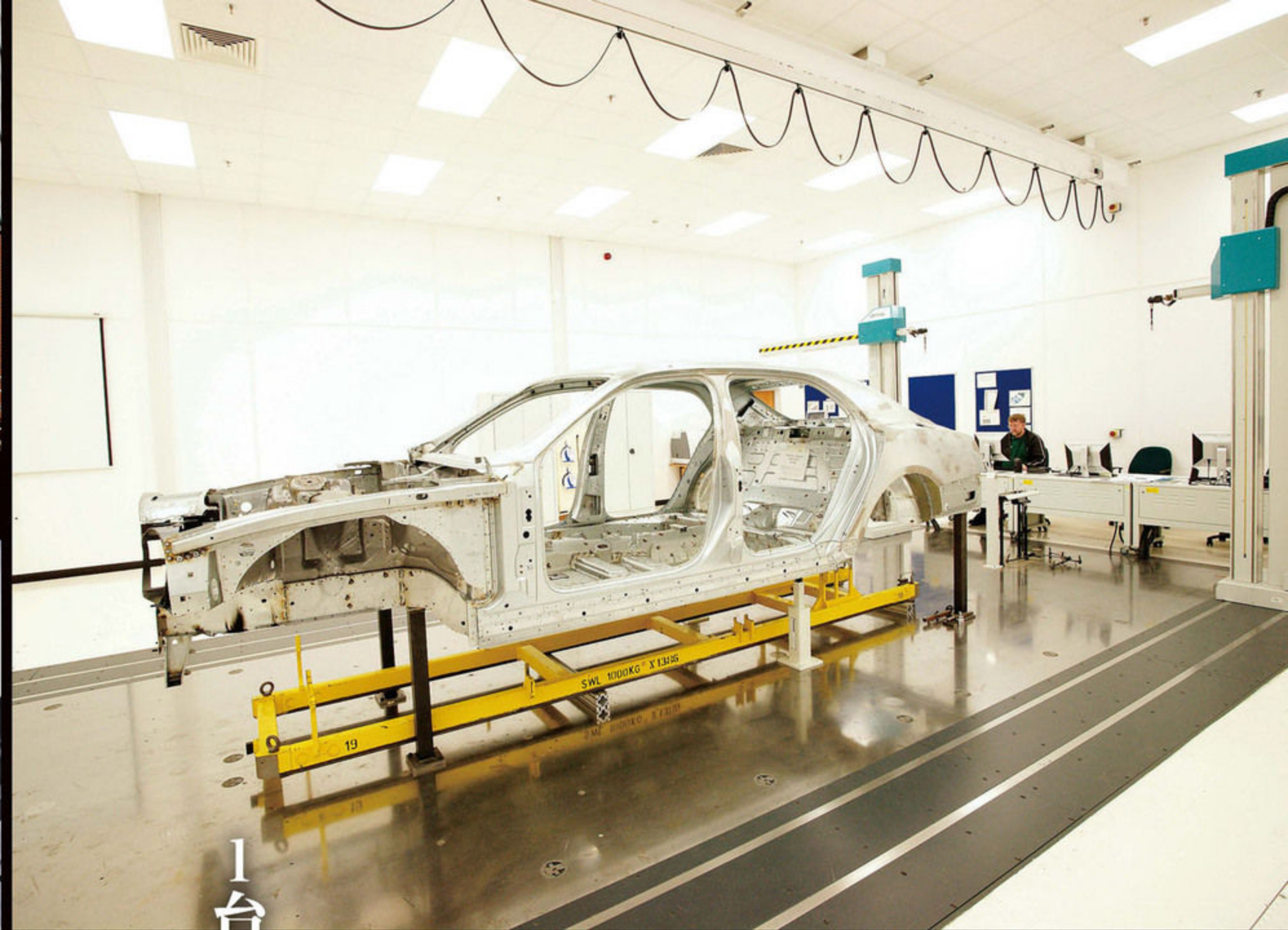
モダンな外観の工場内は明るく清潔。高強度のスチールとアルミニウムからなるミュルザンヌのボディを製造するには、実に125もの工数を必要とするという。もちろん出来上がったボディには1台1台、精度に万全を期すための入念なチェックが施される。
