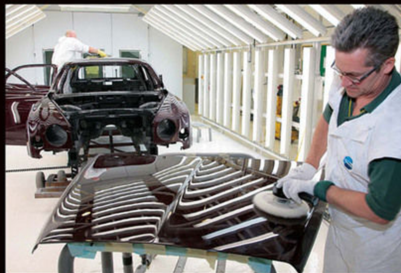
塗装の吹き付けは品質の均一化を図るために完全機械化となっているが、塗装において最も重要な下地処理と仕上げは、すべて人の手に委ねられる。そこに一切の妥協はない。
