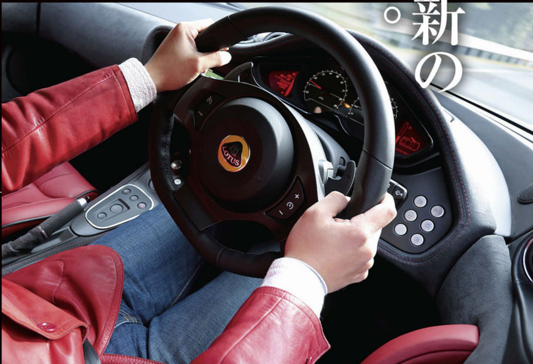
6速ATのIPS（インテリジェント・プレジジョン・シフト）は、ステアリングに備わるパドルでマニュアルシフトが可能。リバース/ニュートラル/ドライブの選択はセンターコンソールに集約されたスイッチで選択し、標準装備のスポーツボタンもここに設置。
