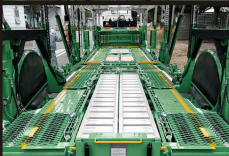
注目の独立懸架式トレッド可変装置。ものの数十秒でタイヤが外へとせり出していく。こうすることで幅広いクルマを楽に積載することができる。またブレーキも独自のディスクブレーキが採用されている。
