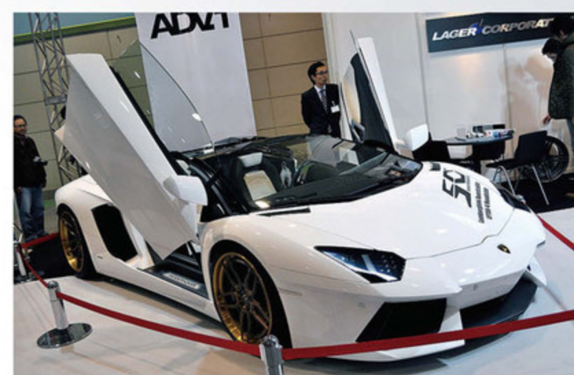
今年のおお阪オートメッセで展示したアヴェンタドールに装着。実用域ではおよそ20mmダウンがベストだが、ショー向けなどでは40mmダウンも可能。調整幅は非常に広い。
