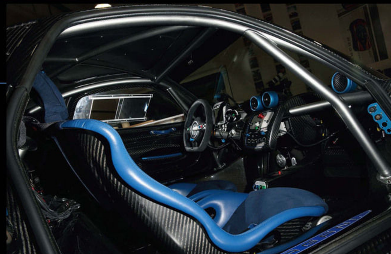
エンジン回転計をハンドルセンターに置く。仰天のアイデアだ。コーナリングGにより、ステアリングの切れ角とほぼ同角で頭が振れるから大丈夫なのかもしれない。トラック専用モデルゆえ、フルバケットシートになるが、サイドにのみ豪華なレザーが張られている。
