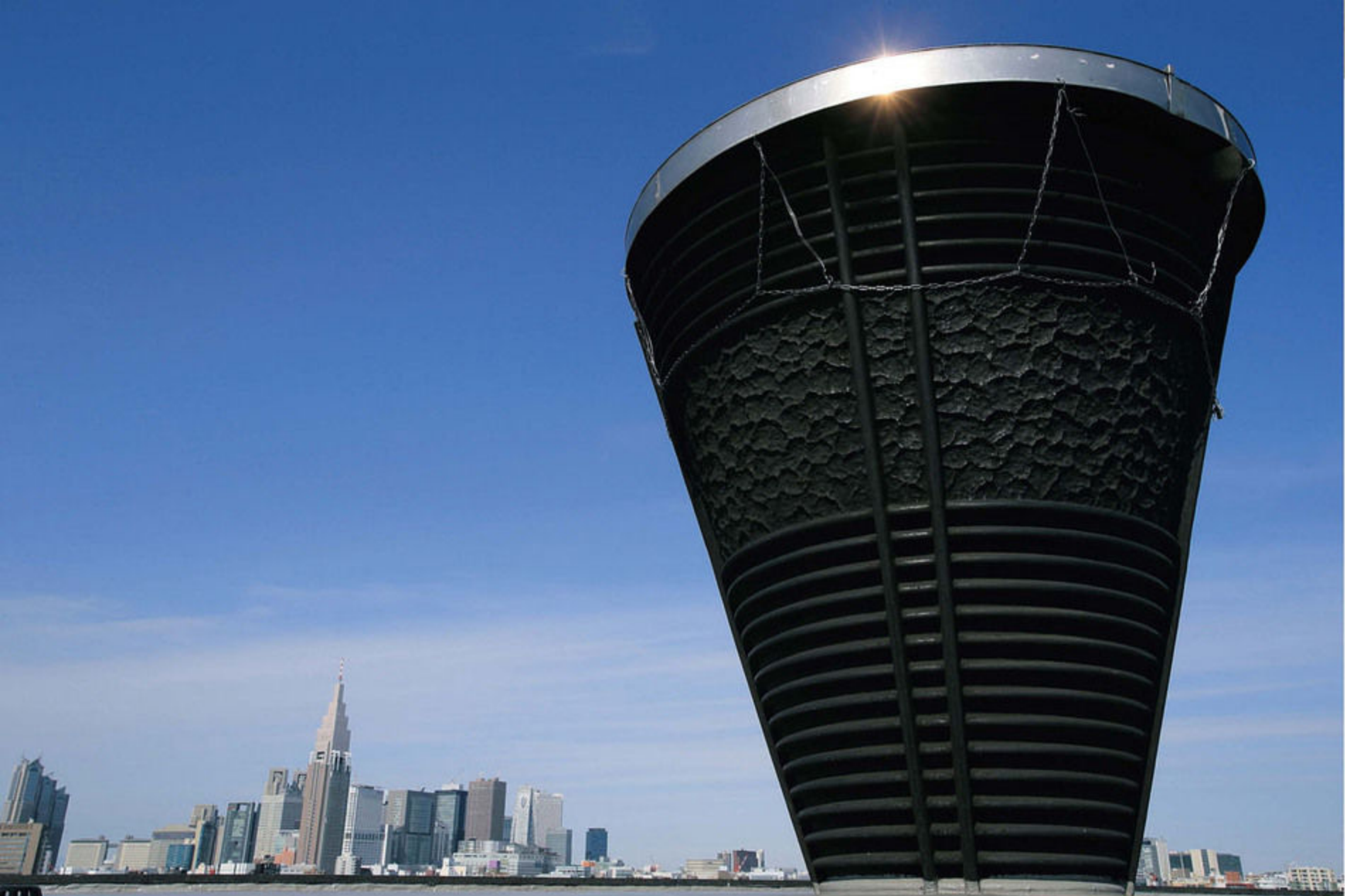
1958年に開催された第3回アジア大会のために作られた炬火(きょか)台。別名聖火台である。上部口径2100mm、下部直径800mm、重量約2600kg。「鎮物の町」として知られる埼玉県川口市の美術鎮物の名工、川口内燃機鋳造所の鈴木万之助が製作に当たった。そのときに起きた悲劇
