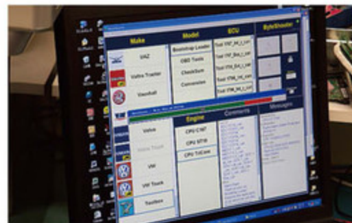
ECUチューニングはエンジンを制御しているデータをPC上に読み出し、データを変更。エンジン制御のデータを変えるため、エンジン特性が変わって加速が鋭くなる。
