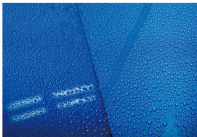
←右がマットペイント、左は光沢のあるペイント部分。コーティングされたボディは、どちらも同じように水を弾いているのがわかる。
