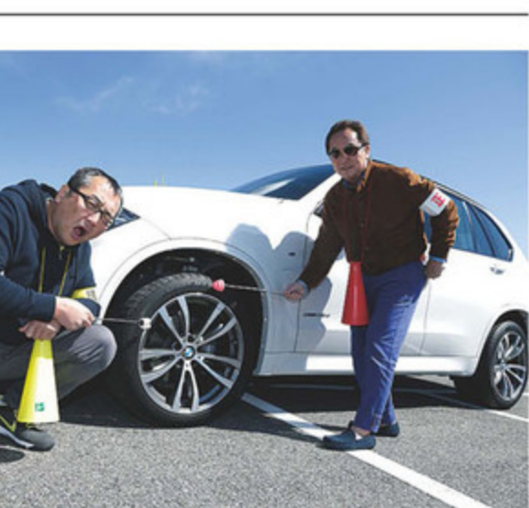
X5はMスポーツモデルのため、フロントに285/45R20、リヤに315/40R20という前後異形サイズのタイヤを履く。パンクして空気が抜けた後でもそのまま100km程度の距離を走ることができるランフラットタイヤなんだけど。これにはふたりともブーイングの嵐。
