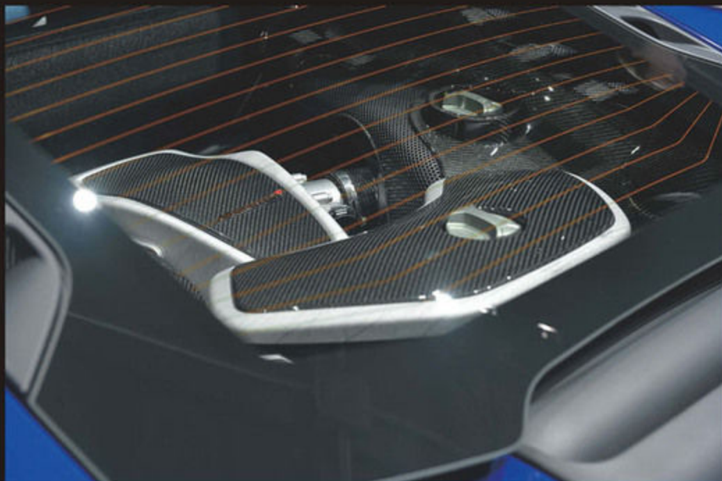
650psの最高出力と678Nmの最大トルクを誇る650S用のパワーユニット。型式名はM838T型でこれまでと変化はない。25psのエクストラは、シリンダーヘッドやピストン、それにエンジンマネージメントの見直しによって得られている。
