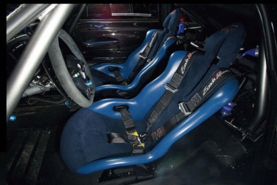
エンジン回転計をハンドルセンターに置く。仰天のアイデアだ。コーナリングGにより、ステアリングの切れ角とほぼ同角で頭が振れるから大丈夫なのかもしれない。トラック専用モデルゆえ、フルバケットシートになるが、サイドにのみ豪華なレザーが張られている。
