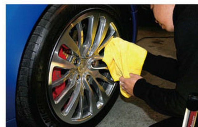
ホイールにもコーティングを施しておけば、ブレーキダストが付きにくく、水洗いだけでも簡単に落とすことが可能。ブレーキダストが出やすいヨーロッパ車にはオススメ。
