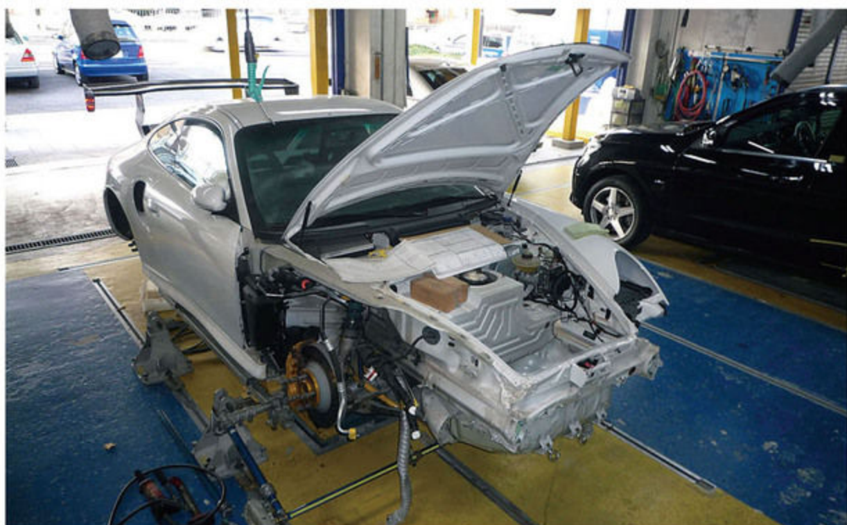
エンジンを降ろさず作業遂行が可能で、時短やコスト削減にも繋がる画期的な3次元修正機・モノコックスタンダード。完璧な仕上がりが期待できる。
