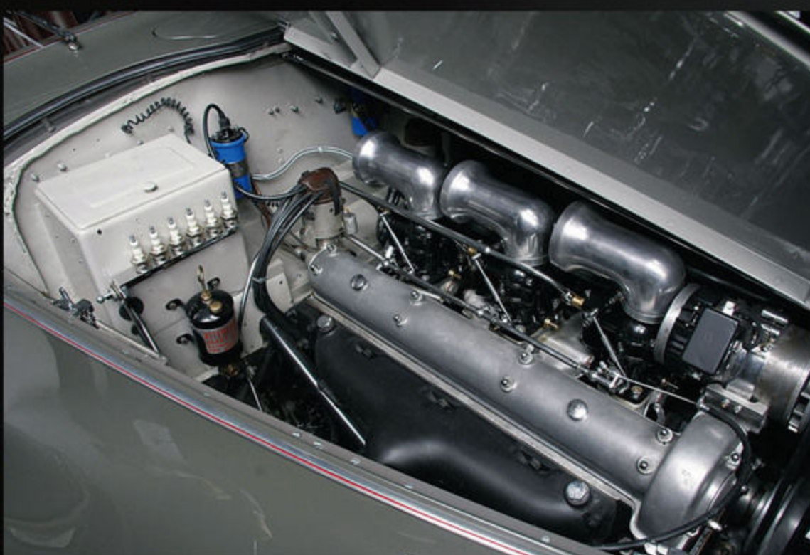
1930年代末に立ち上がったS10/S11プロジェクトのために開発された幻のV12ユニット。当時4基のみが組まれたが、現存するのはこの1基のみ。本来は3.5ℓだが、どこかの時点で3ℓに改造されたようだ。
