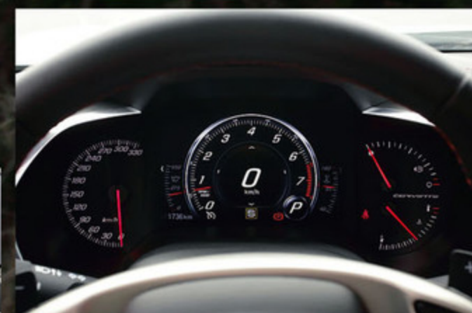
ジェット戦闘機に着想を得たというラップラウンド・コクピット。ハンドメイドで仕上げられるインテリアは、ナバレザーやアルミ、カーボン、マイクロスエードなどを用いる。メーターはフルデジタルで多彩なディスプレイを実現。
