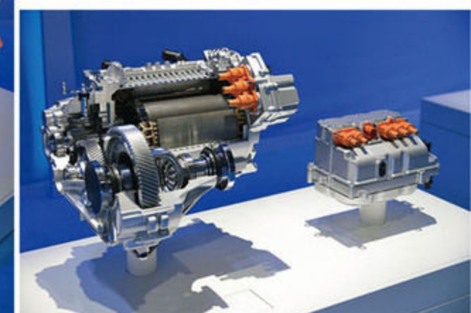
同期型電気モーター(社内呼称:EEM85)は1万2000rpmまで回り、リミッターが作動する140km/hまで車体を引っ張る。24.2kWh容量のリチウムイオン電池は前後シート下とセンタートンネル近くの強化フレーム内に収まり、スペースユーティリティを犠牲にしない。
