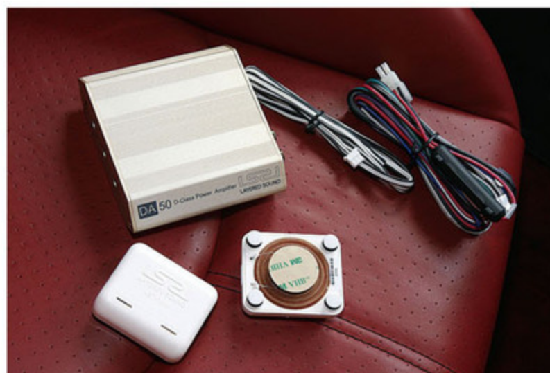
インテリアのパネルを振動させることにより、リアルな音響感を再現する、今注目のレイヤードサウンド。取り付け施工もおまかせだ。
