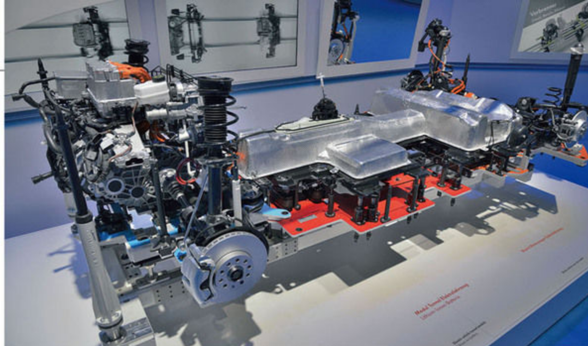
同期型電気モーター(社内呼称:EEM85)は1万2000rpmまで回り、リミッターが作動する140km/hまで車体を引っ張る。24.2kWh容量のリチウムイオン電池は前後シート下とセンタートンネル近くの強化フレーム内に収まり、スペースユーティリティを犠牲にしない。
