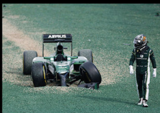
オーストラリアGPのスタート直後、ブレーキの協調制御トラブルからウィリアムズのフェリペ・マッサと絡みマシンを止めた小林可夢偉。ドライバーのミスではなく、リヤブレーキが利かなくなったことが原因だった。
