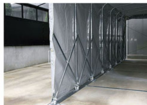
ジャバラ屋根は21mm×21mmのスチール製の支柱にはそれぞれ筋交いが入る強固な構造。自重は約120kgあるが、レールと滑車のおかげで軽い力で開閉が可能。
