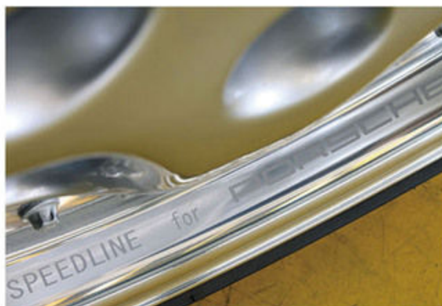
←964RSのスピードライン製ホイールのリムに描かれた、希少価値の高いロゴを消すことなくリペア可能。
