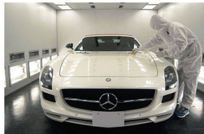
コーティング剤を塗布するときはファイナライズ処理設備内で行い、作業服などのホコリなどが着かないよう、専用の衣装を着用して徹底管理される。
