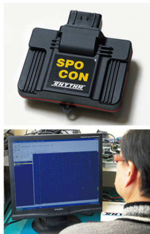
スポコン本体のデータを変更して現車に合った燃調や点火時期にする「モンスターチューニング」。代表の西田氏と同乗走行を行いながらデータを変更していく。
