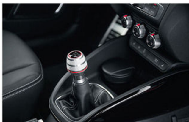
トランスミッションは6速MTのみの設定。6速めがロングレシオとなる高効率タイプで省燃費性能に貢献している。視認性に優れたSモデル専用のダークグレーカラーの2眼アナログメーターは、左が回転計、右が速度計のオーソドックスな構成。
