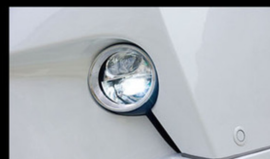
デイライトとフォグランプが一体化したBESTENDAYLIGHT FOG。純正フォグランプとボルトオンで交換できるため、バンパーの加工不要で装着できるアイテムだ。
