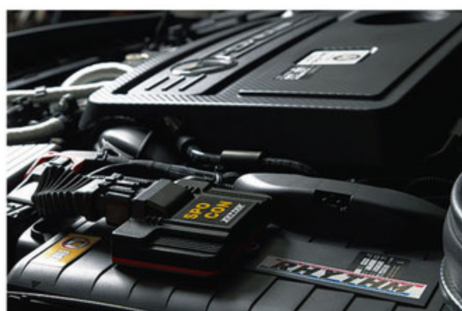
スポコンはカブラーオンで装着できるので、現状復帰が可能。突発的にディーラーで点検を受けることになっても、短時間で純正ECUに戻す簡易的なカブラーもある。
