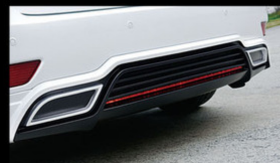
リヤスカートの下部には、LEDライトも取り付け可能。ストップランプなどの連動や、リヤフォグランプとしての使用が考えられる。
