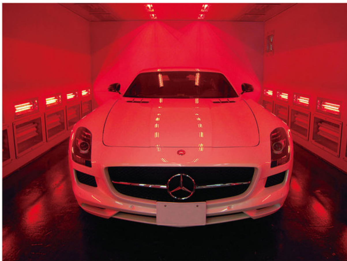
通常は施工後1ヵ月ほどかかって硬化する皮膜を1時間で形成するファイナライズ処理。パネルヒーターでの効果と違い、ムラなく形成できる。
