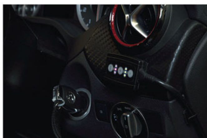
電子制御スロットルのアクセルレスポンスを変更する“ペダルボックス”も人気商品のひとつ。アクセルレスポンスが良くなるので、軽くフケ上がる感覚の商品だ。
