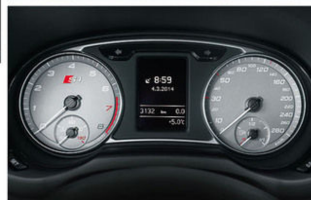
トランスミッションは6速MTのみの設定。6速めがロングレシオとなる高効率タイプで省燃費性能に貢献している。視認性に優れたSモデル専用のダークグレーカラーの2眼アナログメーターは、左が回転計、右が速度計のオーソドックスな構成。
