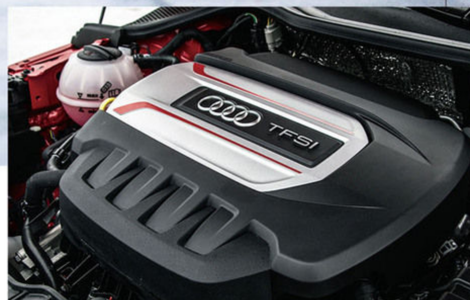
デュアルインジェクション(直噴&マニホールドインジェクション)を採用する2.0直列4気筒ターボのTFSIを搭載。シリンダーヘッド一体型のエキマニによるサーマルマネージメントを行うなどの最適化により、231ps/370Nmのパワースペックを発揮する。
