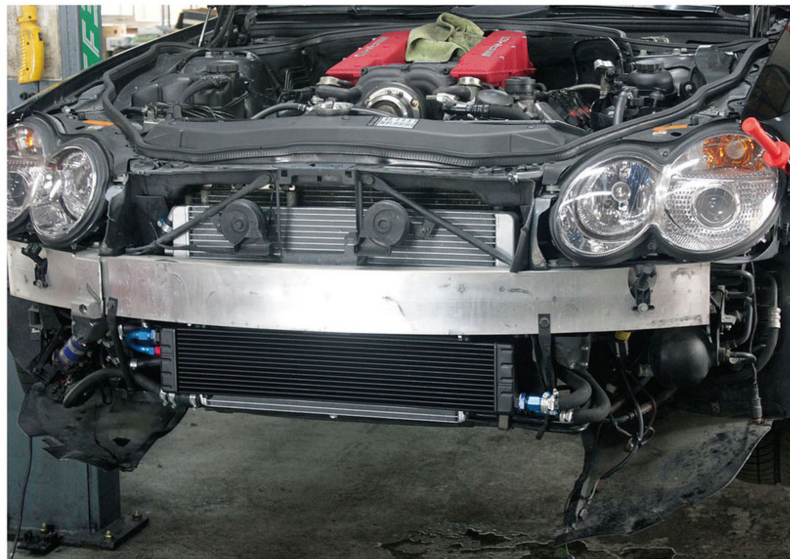
CLS63AMGにはATオイルクーラーを2基設置。パワステオイルクーラーも移設する。チューニング車にはATクーラー追加は必須アイテムだ。
