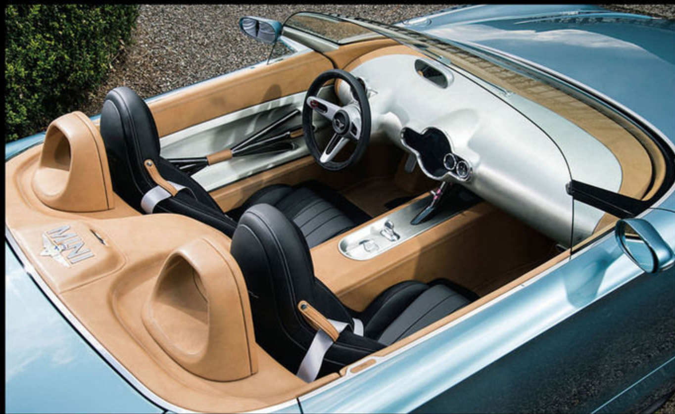
クルマのサイズは全長4162mm、全幅1825mm、全高1209mmで、ホイールベースは2520mm。リヤに小型モーターを搭載し、シングルスピードのATはシートの間に挟まれたクロームメッキのトグルスイッチで作動する。
