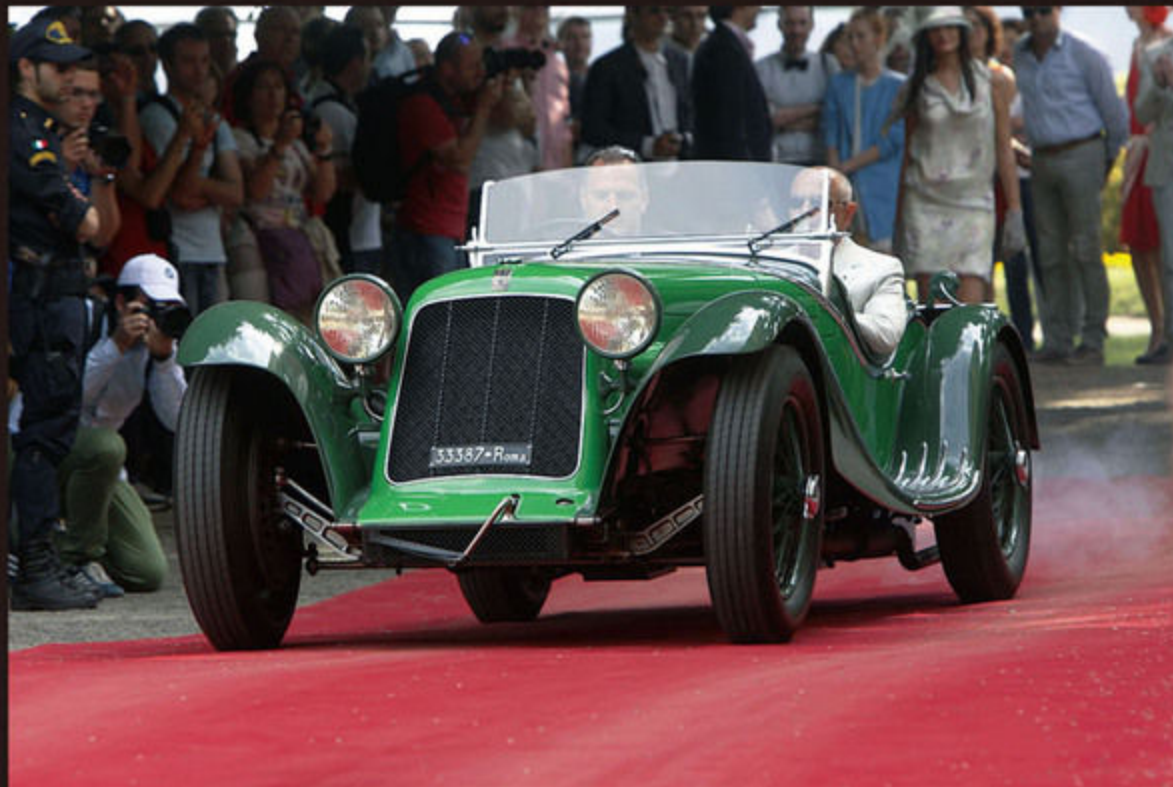
クラスGで優勝した1929年式マセラティ V4 スポルト。2基の直列8気筒「26B」ユニットをV型に繋げた16気筒エンジンをもつ。このシャシーナンバー 4002は、34年のヴィッラ・デステに出展するために緑に彩られたザガート製のボディに換装されたヒストリーをもつ。
