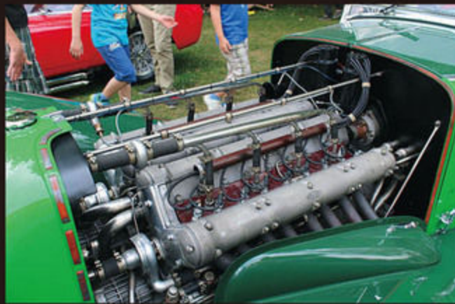
クラスGで優勝した1929年式マセラティ V4 スポルト。2基の直列8気筒「26B」ユニットをV型に繋げた16気筒エンジンをもつ。このシャシーナンバー 4002は、34年のヴィッラ・デステに出展するために緑に彩られたザガート製のボディに換装されたヒストリーをもつ。
