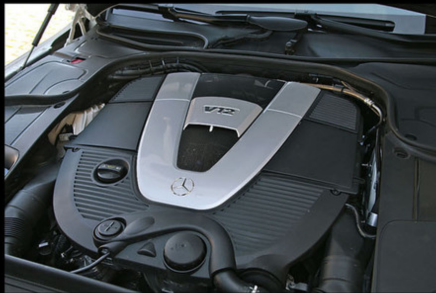
6.0 V12 SOHC ツインターボエンジンは530ps & 84.6kgmを発揮し、圧倒的な推進力を生み出す。電子制御7速ATの7Gトロニックプラスはトルコン、油圧回路、コンピューターが見直され、粘度の低いトランスミッションオイルの使用でフリクションロスを解消。強大なパワーを無駄なく伝達し、燃費性能にも貢献する。
