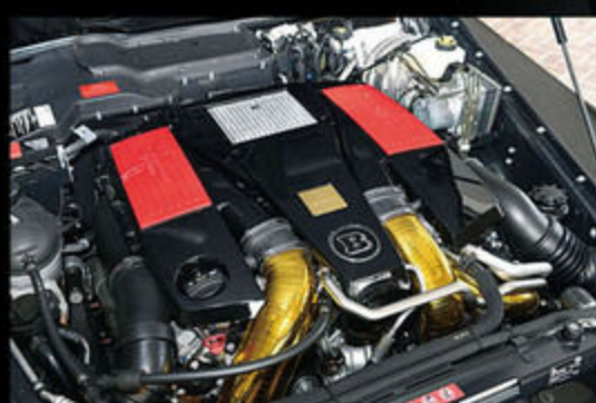
ECUや吸気系のみならずタービンやキャタライザーまで強化することで700ps/97.9kgmまでパワーアップ。ゴールドの吸気パイプは、エンジンが発する熱を効率的に反射させることで、エンジン内部に安定した温度のエアを取り入れるために開発されたスペシャルオーダー品。
