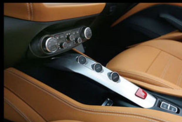
ギヤボックスのセレクターも同様。7速DCTを搭載するとはいえ、GTカーのコンセプトに沿って過激さは抑えられている。とはいえ、ローンチコントロールを装備するところがフェラーリらしい。
