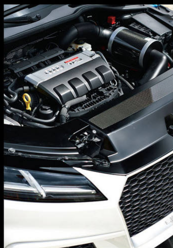
搭載される2.0直列4気筒DOHC+ターボ「TFSI」は、420bhpの最高出力と450Nmの最大トルクを発生。4気筒ターボの量産最強モデルがA45 AMGの360psであることを考えれば、いかにハイパワーかが分かるだろう。
