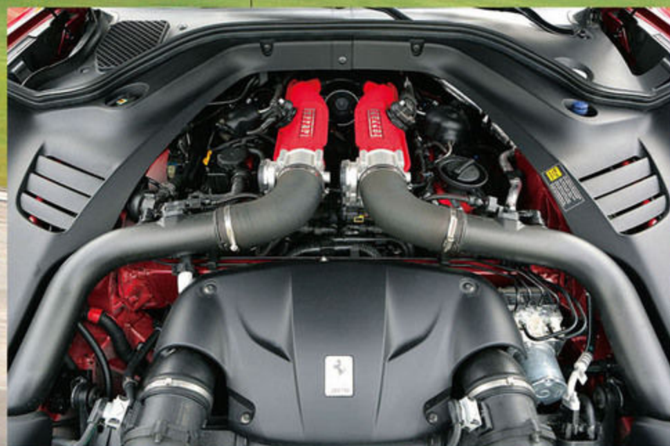
自然吸気ユニット同様にフラットプレーンタイ プのクランクシャフトをも採用した、新型V8タ ーボユニット。3.9ℓとダウンサイジングされて いながらも、パワー&トルク値は、70ps&26.5 kgm増強され、560ps&77kgmを誇る。ツイン スクロールターボによって、NAにも引けをとら ないスロットルレスポンスをもつ。
