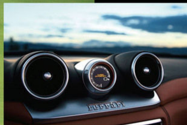
新たに設けられたTPE(ターボ・パフォーマンス・エンジニア)。エアコン吹き出し口の中央にモニターを設置し、ブースト圧など5種類を表示、その変更はタッチパネルによって操作する。
