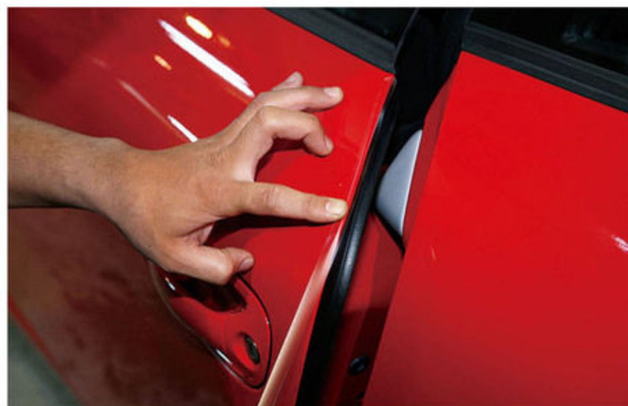
ドアの開閉時に傷付きやすいドアエッジには、専用のフィルムにより施工を行う。施工後、フィルムのあとは目立たない。
