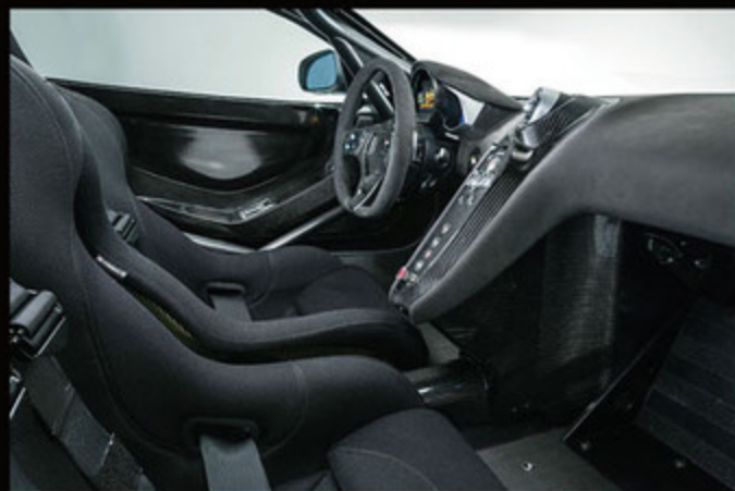
650Sスプリントのコックピットはサーキット専用とはいえ助手席も装備される。もちろん操作系は簡素化され、デバイス類の位置を変更、エアバッグも非装備となっている。
