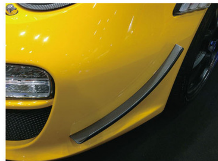
フロントのリフトを抑える空力効果で、高速走行時のフロントの接地性を大幅に向上。装着は両面テープなので一切の加工は不要。
