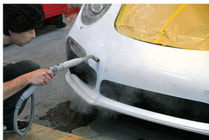
施工前にはパーツの隙間などもスチームクリーナーでクリーニングを施し、小さなホコリも逃さないので美しい仕上がりがとなる。
