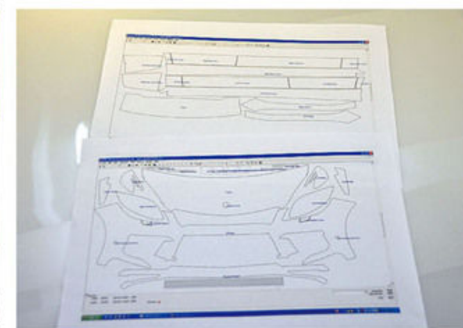
フィルムは車種別にカットされている。幅広い車種に対応し、施工部分もオーナーの好みに合わせて選ぶことができる。
