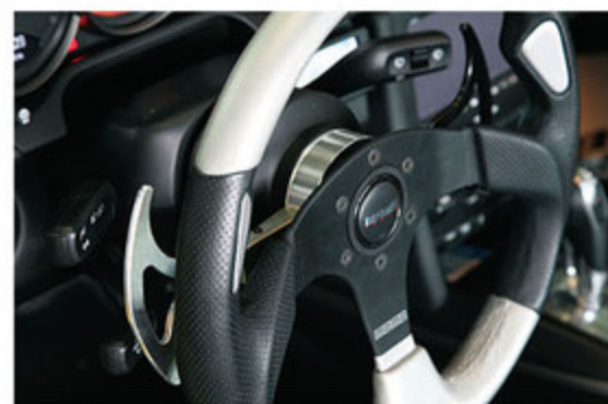
996以降のTIP/PDKに対応するバドルシフター。エアバッグなしのスポーツステアリング専用モデル。アルミ地とブラックあり。4万6000円(税抜き)。
