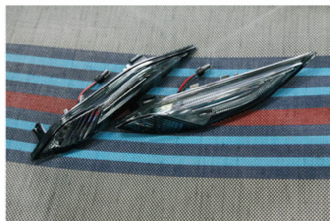
958カイエン用のLEDサイドマーカーも人気のアイテムだ。フロントバンパーサイドのマーカーを本体ごとLEDタイプに交換するタイプ。2万4000円(税抜き)。
