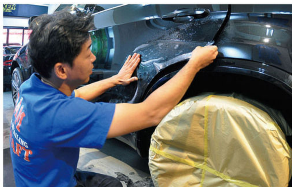
リヤフェンダーの前も飛び石によるキズが付きやすい部分。純正で装着されている車種もあるが、XPEL社のフィルムは目立たずに強力なガード力を発揮する。
