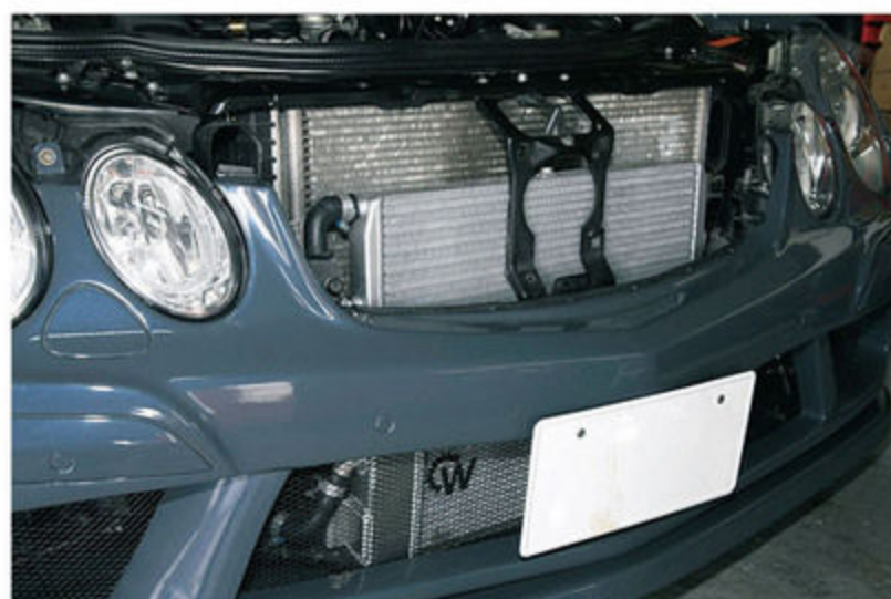
オイルクーラーの追加やラジエーターの変更など、チューニングに合わせて熱対策も抜かりない。特にハイスピード時のATのオーバーヒート対策も施されている。
