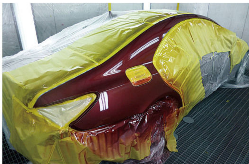
鋳金塗装を終えたCL350。この状態からTPCガラスコーティングを行うと非常に良い仕上がりのガラスコーティングが可能だ。全てを完備している工場の強みである。
