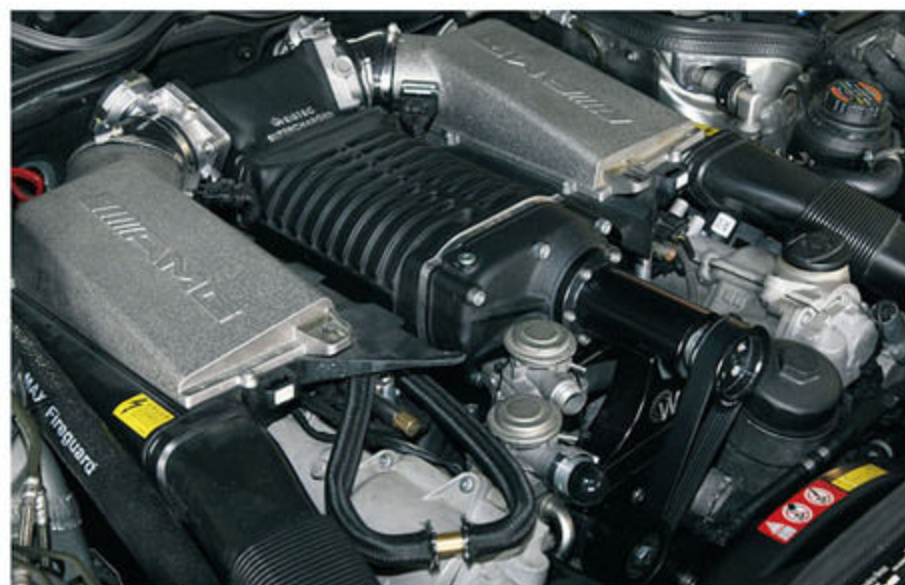
ターボやコンプレッサーなど過給機のチューニングで知られるアメリカブランド、WEISTEC社製のスーパーチャージャーを装着する。
