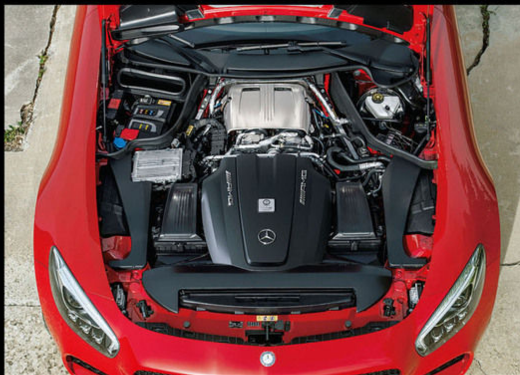
M178と呼ばれる4.0 V8 ツインターボエンジンはAMGの「ワン・マン、ワン・エンジン」と呼ばれる伝統に従い、アフターバッチで手組みされる。ピエゾインジェクターを用いた第3世代ガイドドスプレー式の直接噴射を採用。高性能と省燃費を両立した。
