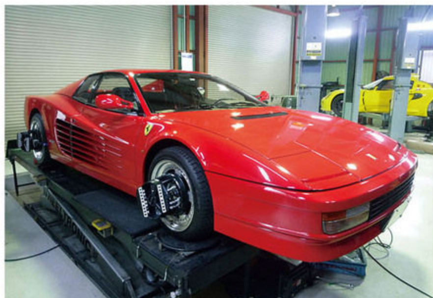
フェラーリ・テストロッサの高速直進安定性を向上させるためのアライメント計測調整シーン。ノウハウがなければできない作業である。
