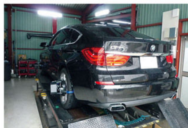
アライメント調整が自慢のテクノプロでは、最新のハンター製4輪テスターを用いたセッティングを行っている。写真は、走行中に左に流れる現象を修正中の様子。
