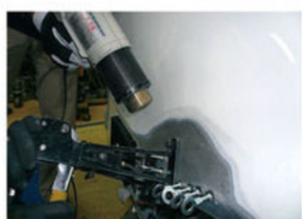
ボディがアルミ製のW126 CL63 AMGの鋳金風景。アルミ素材の特性を考慮し、ヒートガンで暖めながら修復。非常に根気のいる作業である。
