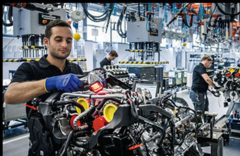
M178と呼ばれる4.0 V8 ツインターボエンジンはAMGの「ワン・マン、ワン・エンジン」と呼ばれる伝統に従い、アフターバッチで手組みされる。ピエゾインジェクターを用いた第3世代ガイドドスプレー式の直接噴射を採用。高性能と省燃費を両立した。
