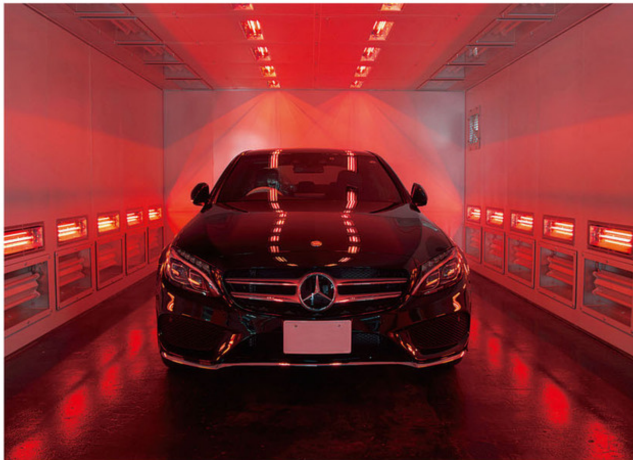
完全硬化まで約1ヵ月かかる皮膜を即時に完成させるファイナライズ処理設備。究極のコーティングを目指すなら必須の設備といえる。
