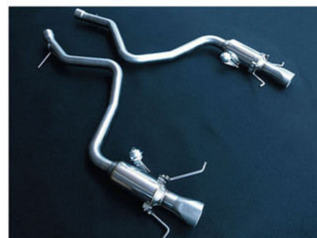
室内からサウンドを変化させることができる、可変タイプのオールステンレスマフラー「MIRACLE REAR EX」。S63AMG、S550用がラインアップする。
