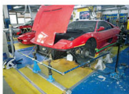
フェラーリF355のフレーム修正作業。モノコックスタンダードは、外板部品を取り外さなくても3D計測が可能なので作業も迅速だ。
