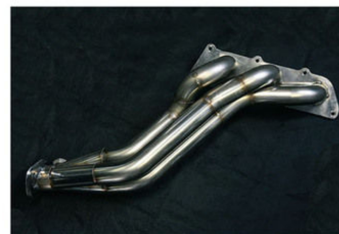
M272 V6エンジン用のステンレス製エキゾーストマニホールドをオリジナルで製作。この他にもV6エンジンを楽しむためのチューニングパーツを開発中だ。
