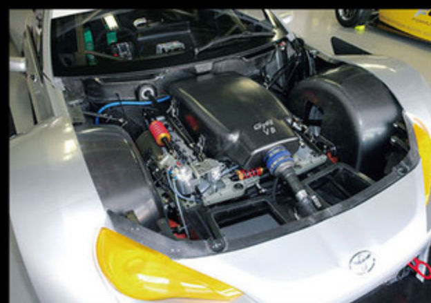
今回トヨタ86のボディで登場したマザーシャシー。エンジンはGTAが販売を計画している4.5L自然吸気V8ユニットが搭載された。既に2015年から参戦を決めたチームが複数ある模様だ。
