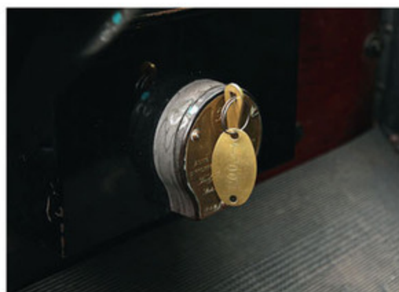
エンジン始動は当時のままの手動クランク。まずは室内のキーを左に回し、ステアリング裏の右レバーを少し下げる。
