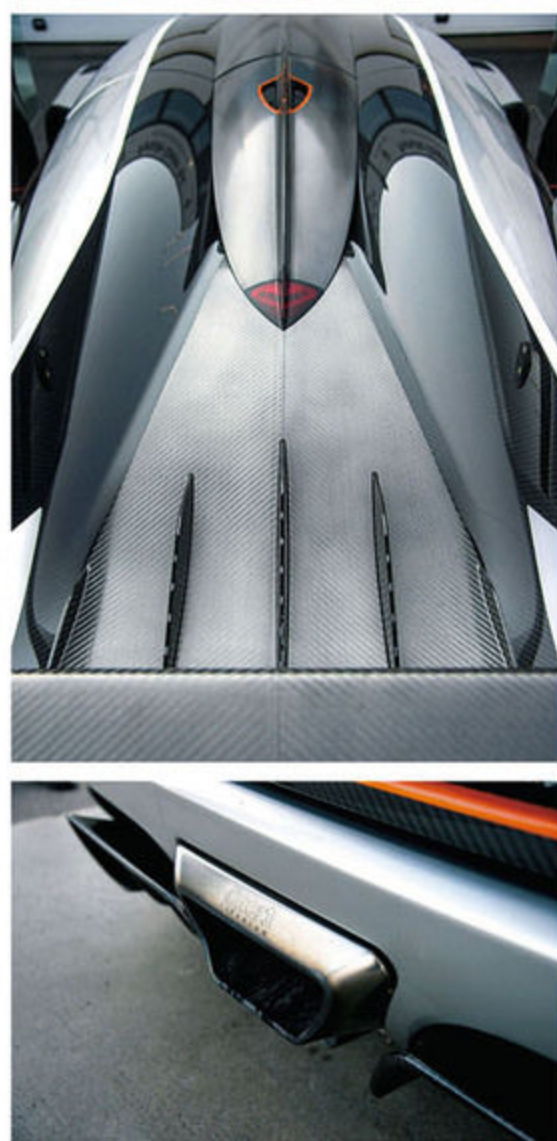
油圧作動のアクティブリアウイングをはじめとしてOne:1は凝った空力デバイスで、280km/h時に610kgものダウンフォースを生む（そのため最高速は439.4km/hに抑えられる）。高速コーナーでの盤石の足取りからも、その効果は実感できた。さらにカーボンファイバーとケブラー、それにチタンが軽量化のカギを握る素材。ドラマチックな外観の空力パーツは巨大なダウンフォースを生む。
