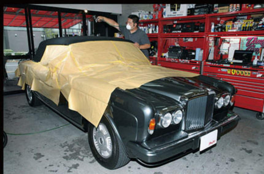
ウインドウやボディへ薬剤の付着を防ぐため、マスキングをしてから施工を行っている。ボディコーティングと同時にこの撥水コーティングを施工するオープンカーユーザーも多い。施工後のメンテナンスも行っている。
