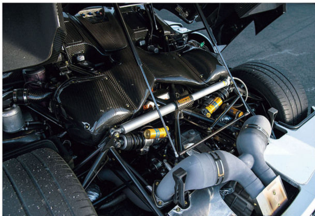
電気モーターによるパワーアシストはなくとも、5.0 V8 ツインターボユニットは、1360ps/1371Nmもの強大な最高出力を発生させ、乗る者に情け容赦ない大音響を炸裂させる。
