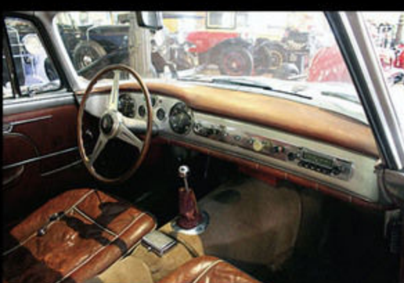
1954年から57年にかけて60台あまりが製造されたA6G/54。エンジンはショートストロークの2.8直列6気筒DOHCユニットを積む。パニーニ・コレクションが所蔵しているのは、アレマーノ製のボディを纏ったクーペ。
