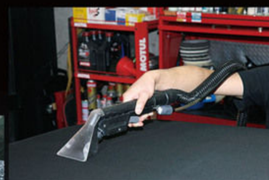
施工前には幌についている汚れを、専用のクリーナーを用いて洗浄を行い、徹底的にクリーニング。ボディコーティングと同様に、下地の処理は重要。汚れたままの幌には撥水加工を行っても効果は低くなってしまふ。
