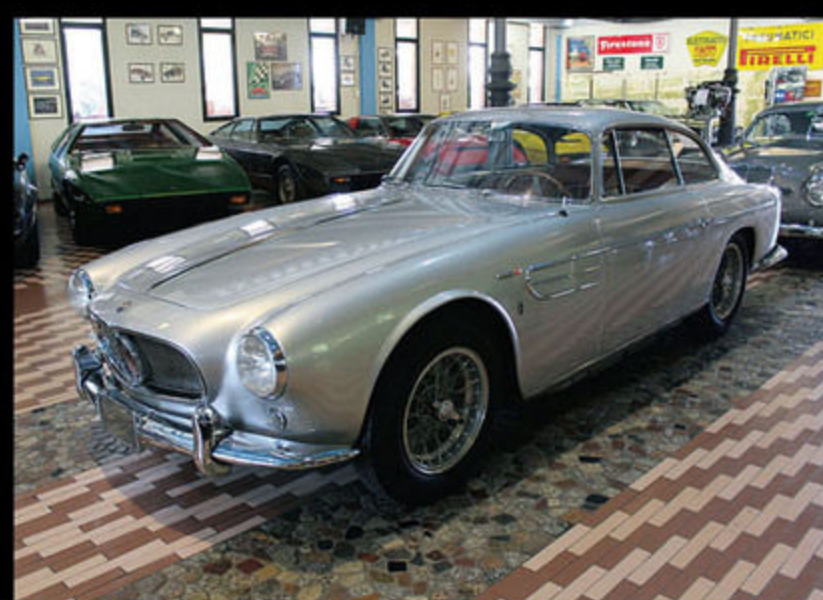
1954年から57年にかけて60台あまりが製造されたA6G/54。エンジンはショートストロークの2.8直列6気筒DOHCユニットを積む。パニーニ・コレクションが所蔵しているのは、アレマーノ製のボディを纏ったクーペ。
