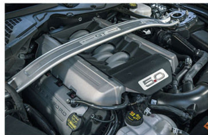
新開発の2.3ℓ直4エコブースト・エンジン(写真上)にはツインスクロールターボチャージャーを採用。排気干渉を防ぎ、高効率な過給を実現している。5.0ℓV8エンジン(写真下)はシリンダーヘッド、バルブ駆動系、吸気系を一新するなど、大幅な改良が施された。
