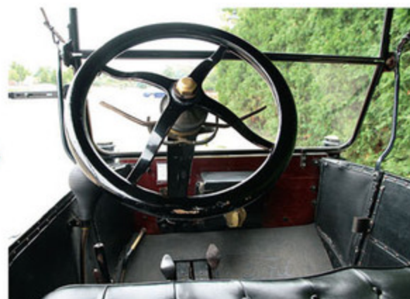
この右レバーがスロットルだ。アイドル回転できるくらいに少し下げしておく。そして左のレバーで点火を調整して着火しやすくする。
