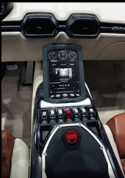
メーターパネルは、昨今のランボルギーニ車と同様に表示の切り替えが可能。その内容もEV走行時やハイブリッドモード、さらに通常のエンジン稼働時など、それぞれに見合った機能的な表示を行う。また、センターコンソール上にはタブレットを配置し、オーディオ再生のほか、ナビゲーションや天気などの情報を表示できるという。
