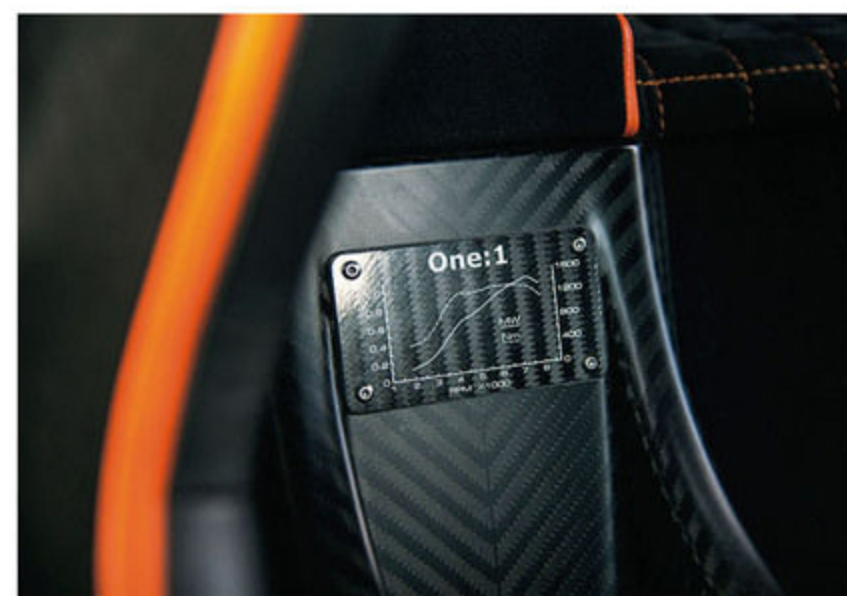
アルミニウム構造を採ったカーボンファイバーモノコックタブ、そのサイドシルには、One:1に積まれたV8ツインターボの性能曲線がカーボンプレートで装着されている。
