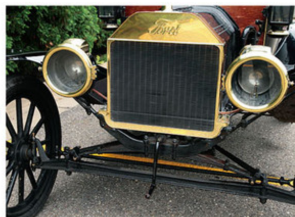
儀式的準備が整ったら車両前方にまわり、フロントのラジエーター左下にあるチョークを引き、クランクレバーを9時から12時に勢よく回転させる。レバーは親指以外の指でひっかけのように回す。親指もかけるとバックファイヤなどでクランクが逆回りしたときに親指があらぬ方向に曲がる可能性があるのだ。
