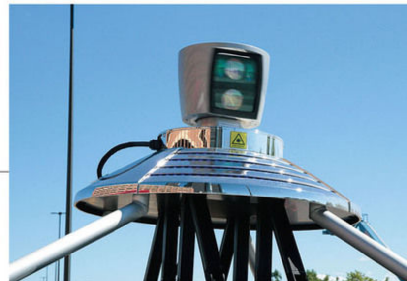
RLXのルーフで高速回転するレーザーライダー。グーグルの自動運転車にも乗っていたアレである。
