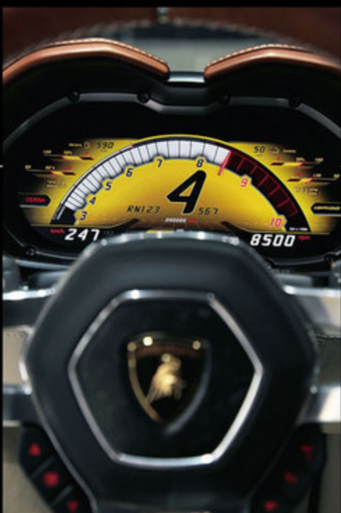
メーターパネルは、昨今のランボルギーニ車と同様に表示の切り替えが可能。その内容もEV走行時やハイブリッドモード、さらに通常のエンジン稼働時など、それぞれに見合った機能的な表示を行う。また、センターコンソール上にはタブレットを配置し、オーディオ再生のほか、ナビゲーションや天気などの情報を表示できるという。
