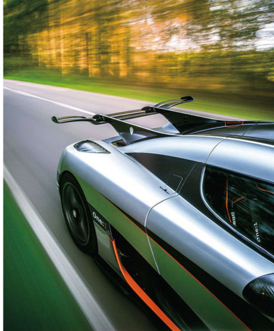
油圧作動のアクティブリアウイングをはじめとしてOne:1は凝った空力デバイスで、280km/h時に610kgものダウンフォースを生む（そのため最高速は439.4km/hに抑えられる）。高速コーナーでの盤石の足取りからも、その効果は実感できた。さらにカーボンファイバーとケブラー、それにチタンが軽量化のカギを握る素材。ドラマチックな外観の空力パーツは巨大なダウンフォースを生む。
