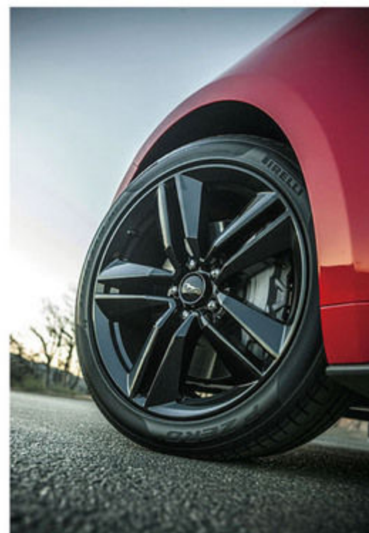
試乗車の大半はビレリPゼロを装着。これも国際化の表れ？ フロントサスペンションの形式を改めることで大径ブレーキディスクの装着を実現、ペダルフィールの改善を図った。
