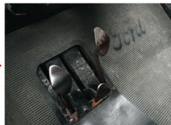
3ペダルは右からブレーキ、リバース、クラッチ。なぜこのレイアウトになったのか……。自由な発想でクルマを作る時代である。
