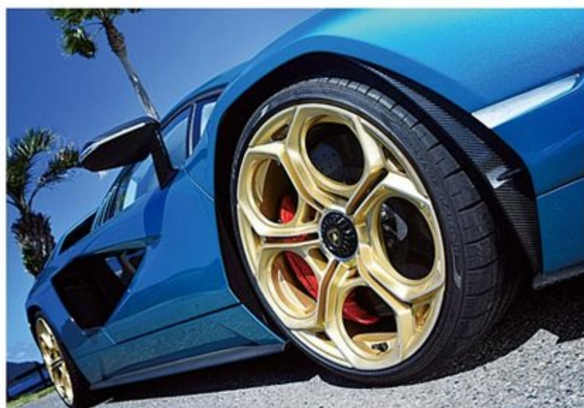
LP400Sで初採用されたダイヤルデザインをイメージしたホイールはセンターロック式。ブレーキはカーボンセラミックが備わる。
