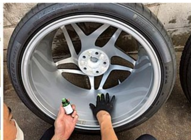
TPCガラスコーティングは高温化するブレーキキャリパーや清掃が困難なホイールの裏側にも施工が可能。ブレーキダストが付きにくくなるので後々のメンテナンスが楽になるメリットを持つ。
