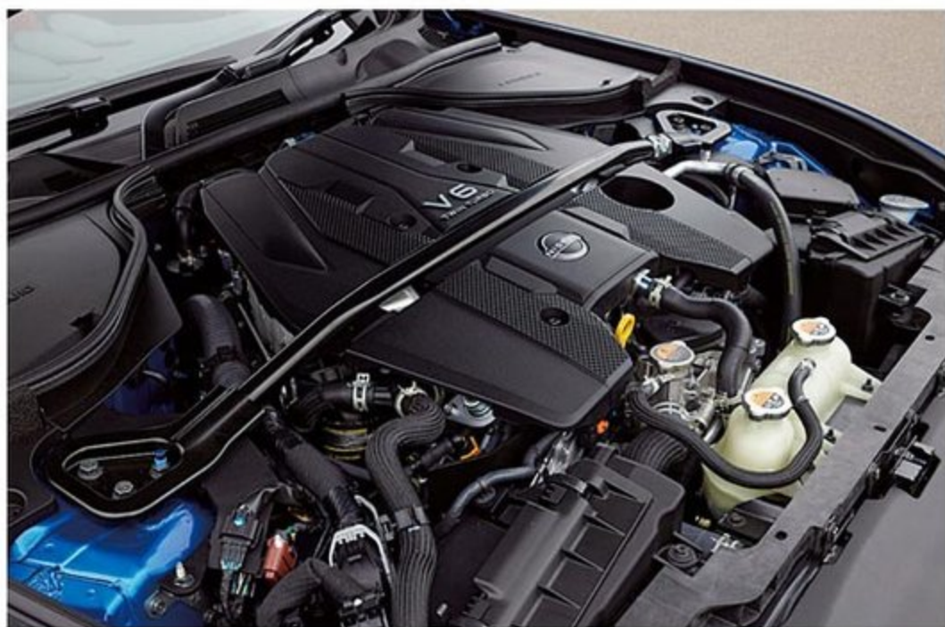
新開発の3.0ℓ V6ツインターボ (VR30DDTT) は最高出力405PS / 最大トルク475Nmを発生。ダッシュ上には左から電圧計、ターボ回転計、ブースト計の3連メーターを備え、インパネは12.3インチの「アドバンスドドライバアシストディスプレイ」を採用する。
