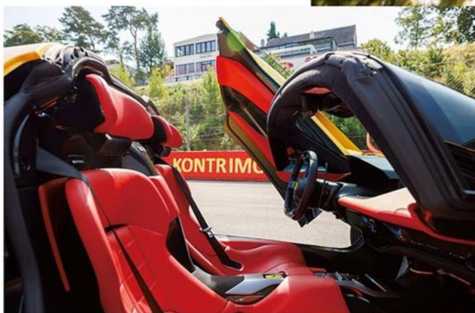
シャシーと一体化したシートを採用。ドラボジはペダルボックスを動かすことで調整する。
