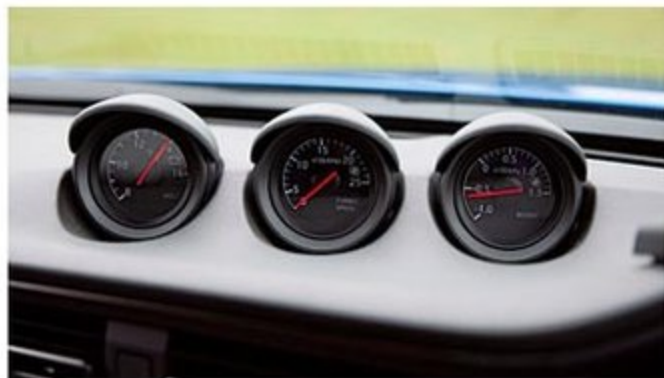
新開発の3.0ℓ V6ツインターボ (VR30DDTT) は最高出力405PS / 最大トルク475Nmを発生。ダッシュ上には左から電圧計、ターボ回転計、ブースト計の3連メーターを備え、インパネは12.3インチの「アドバンスドドライバアシストディスプレイ」を採用する。
