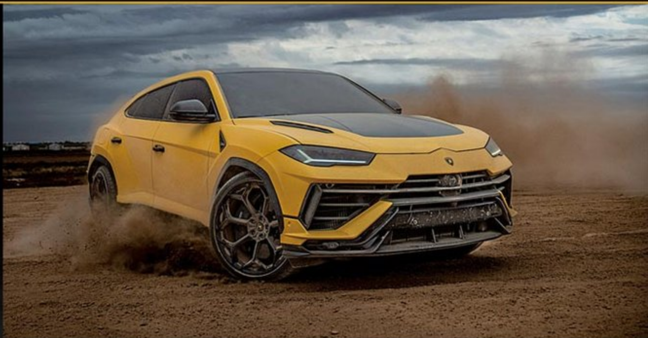
カーボン製のバンパーとボンネットを採用。チタンボルトを採用したホイールも新デザインとなった。ダウンフォースは全体で8%向上している。
