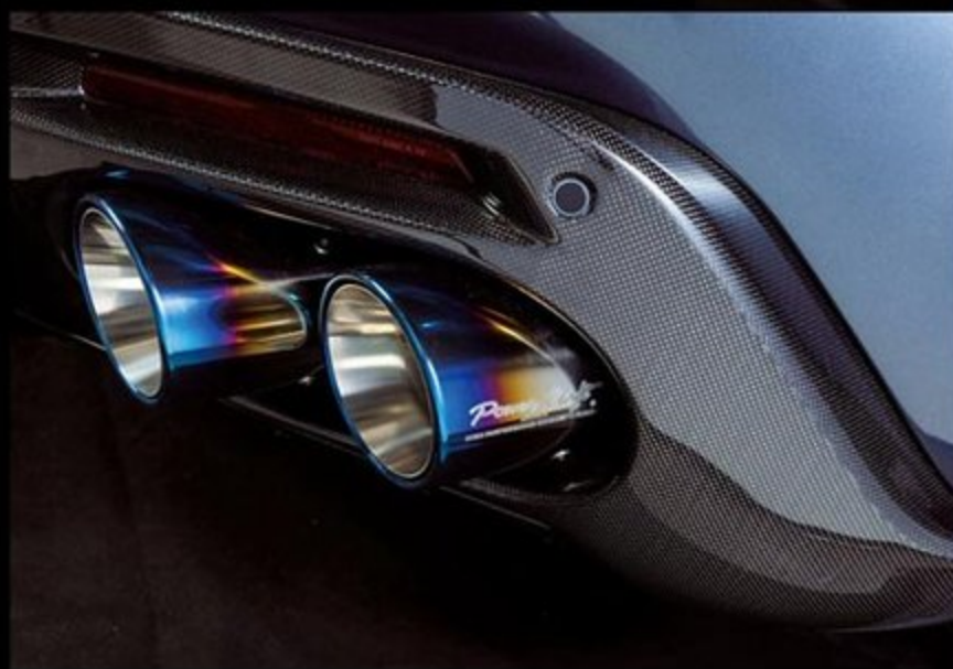
純正バンパーから突き出るテールパイプはチタン製。110φの大径が勇ましく、その存在感を主張する。写真のチタンカラーのほか、焼き入れなし、マットブラックなども選べる。
