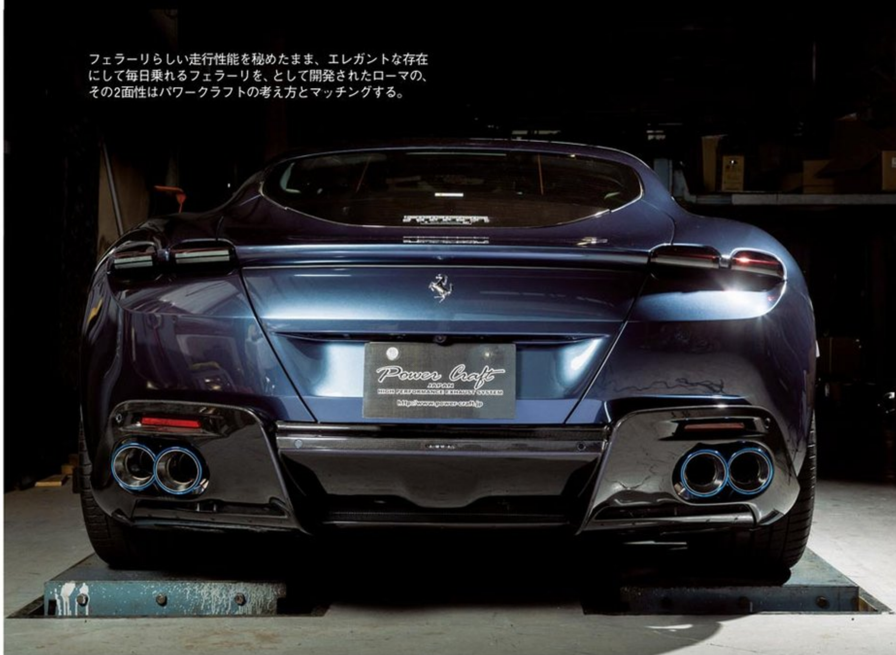
純正バンパーから突き出るテールパイプはチタン製。110φの大径が勇ましく、その存在感を主張する。写真のチタンカラーのほか、焼き入れなし、マットブラックなども選べる。
