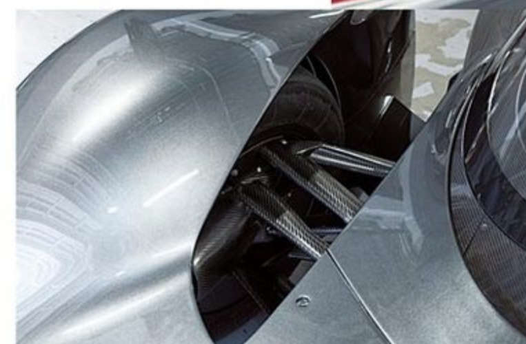
サスペンションアームもすべてカーボン製。エンジン周り以外はほとんどの素材がカーボンとなる。
