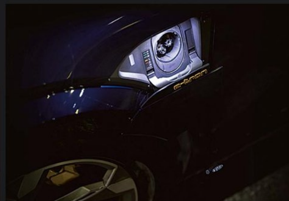
助手席側にCHAdeMO急速充電口、運転席側に普通充電口が用意される。装着タイヤはハンコック・ペンタスS1エボ3。
