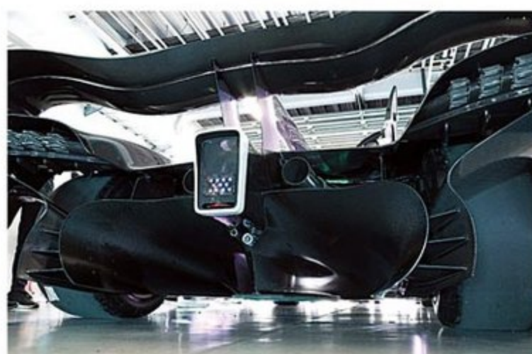
レースレギュレーションや保安基準などの制約を一切受けずに構築されたエアロダイナミクス。フロントノーズはまるでF1マシンのよう、フロアは完全なトンネル構造となっている。リヤウイングにはセバスチャン・ベッテルとランス・ストロールのサインが入る。
