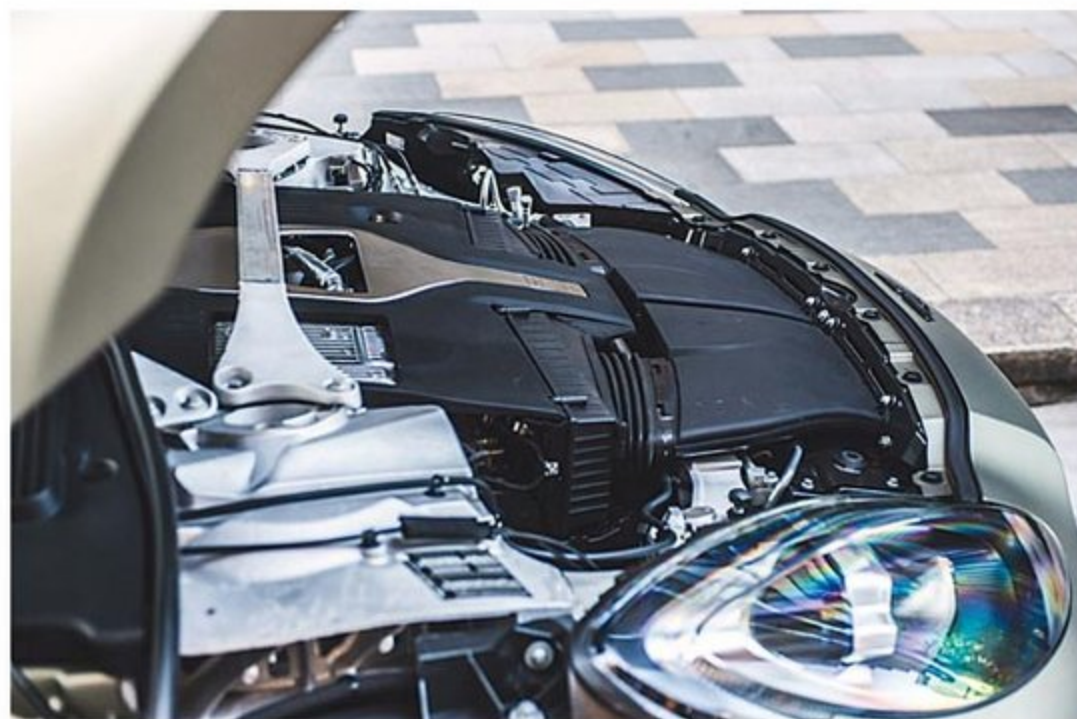
スタンダードのDBXより157PS/200Nmアウトプットが引き上げられたAMG製4.0 V8ツインターボを搭載する。トランスミッションはトルコンレスの湿式多板クラッチ式9速ATが与えられている。
