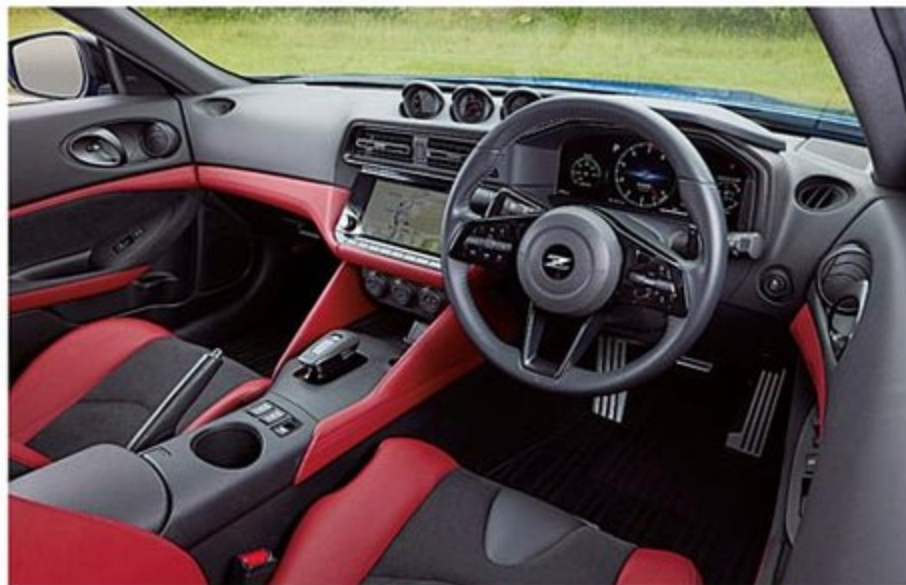
新開発の3.0ℓ V6ツインターボ (VR30DDTT) は最高出力405PS / 最大トルク475Nmを発生。ダッシュ上には左から電圧計、ターボ回転計、ブースト計の3連メーターを備え、インパネは12.3インチの「アドバンスドドライバアシストディスプレイ」を採用する。
