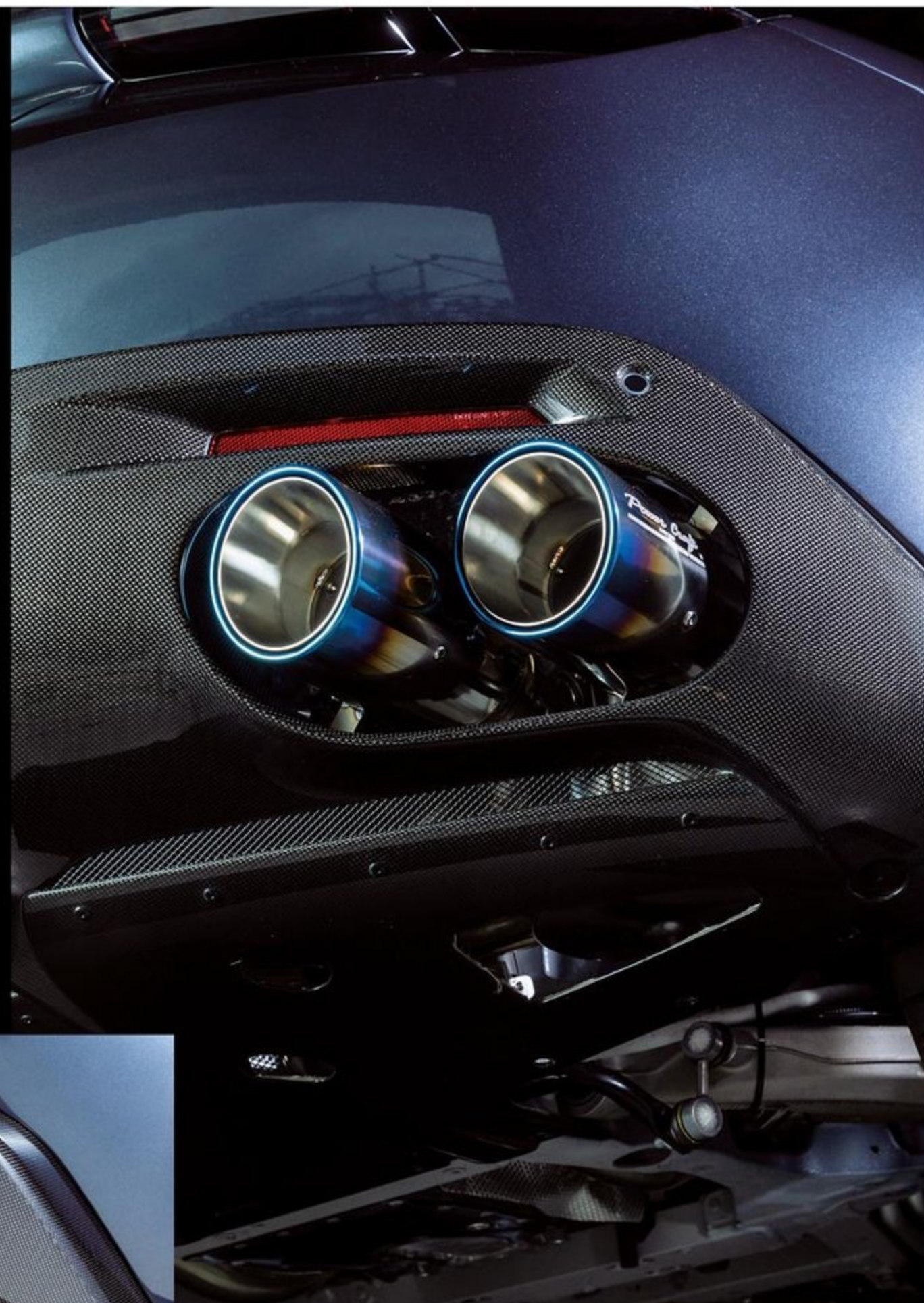
純正バンパーから突き出るテールパイプはチタン製。110φの大径が勇ましく、その存在感を主張する。写真のチタンカラーのほか、焼き入れなし、マットブラックなども選べる。
