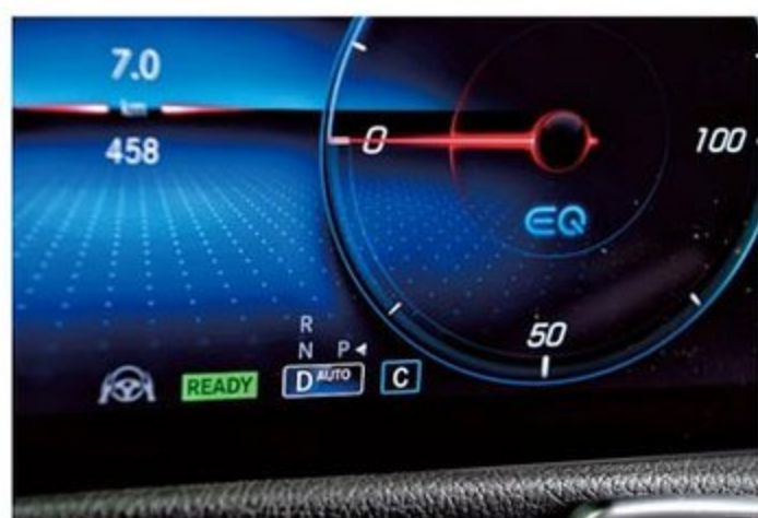
回生ブレーキの強弱を調整可能。フロントセンサーが前車に反応して、回生の強弱を自動的に調整する「D AUTO」も採用される。
