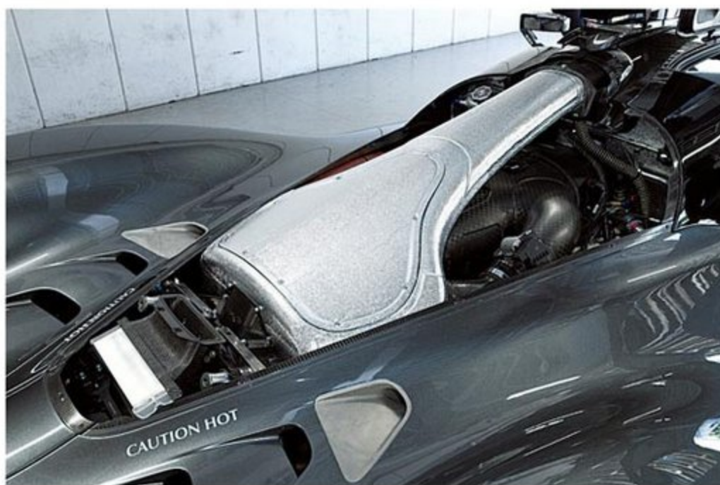
ミッドにマウントされるNAのV12はコスワース製。6.5ℓの排気量から1万1000rpmの最高回転数によって1014PSを発揮する。ヴァルキリーに採用されていたハイブリッドシステムは取り去られているが、発進用のモーターは搭載されている。
