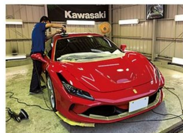
高硬度／高膜厚／高密着のガラス系被膜がボディを覆うTPCガラスコーティング。このフェラーリF8は新車で入庫した個体だが、全体をフルチェックし微細なキズも見逃さず磨き上げてから施工を行っている。
