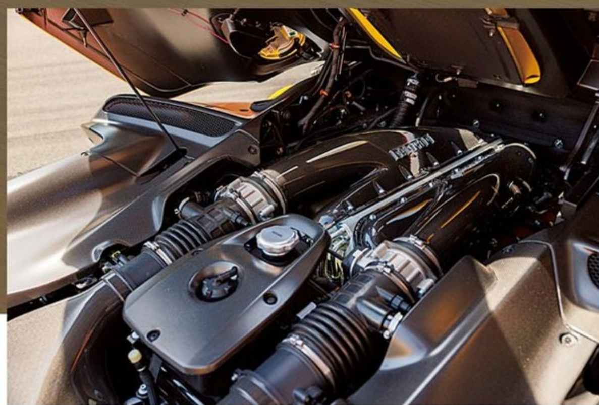
F140HB型をさらにチューンナップしたことで最高出力840PS、最大トルク697Nmを発生する6.5ℓV型12気筒エンジンを積む。
