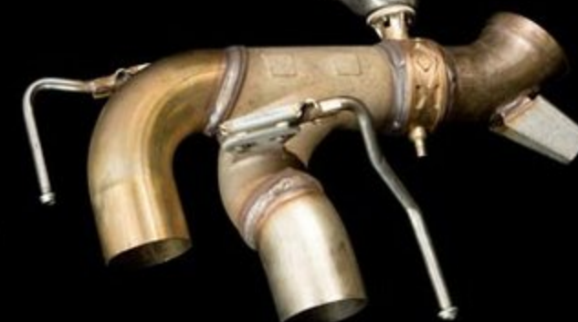
リヤホイールハウス裏側に綺麗に設置される小型サイレンサー。フェラーリ純正のエキゾーストシステム(写真右)は、そのサイレンサーのない特殊な形状を持っているようだ。
