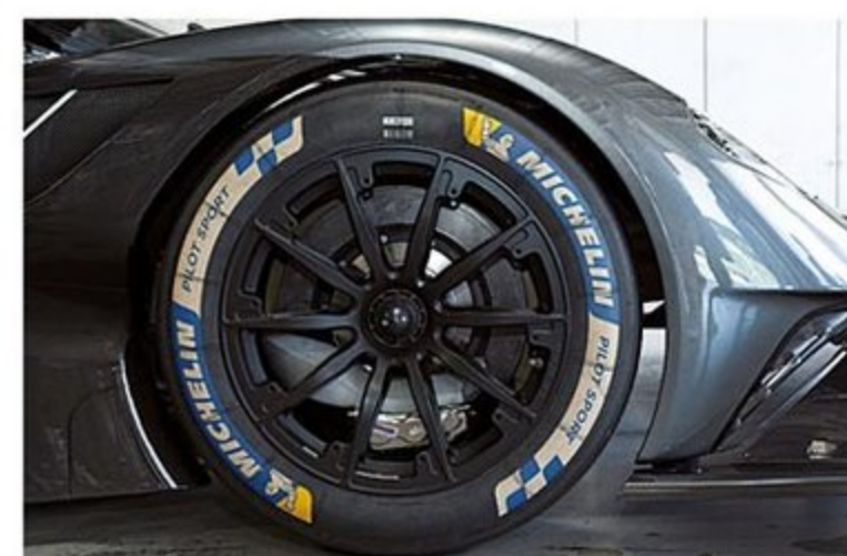
ブレーキはカーボンコンポジットのローターにフロントはアルコン製6ポットキャリパーを組み合わせる。真下に位置するキャリパーには温度計が備わる。
