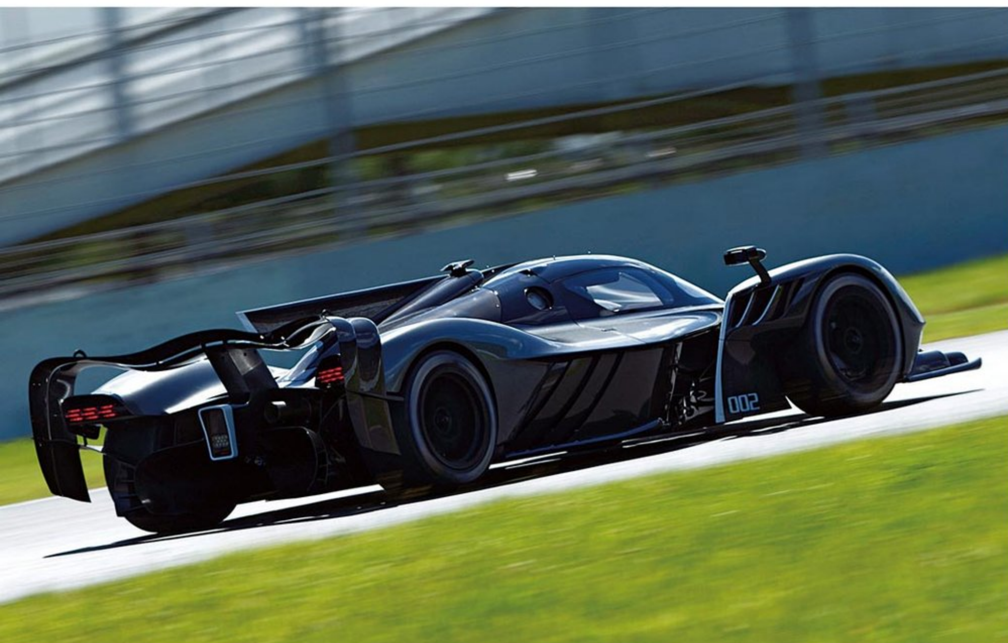
レースレギュレーションや保安基準などの制約を一切受けずに構築されたエアロダイナミクス。フロントノーズはまるでF1マシンのよう、フロアは完全なトンネル構造となっている。リヤウイングにはセバスチャン・ベッテルとランス・ストロールのサインが入る。
