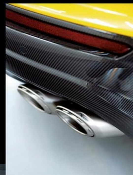
エアカーテン効果を高めた新デザインのバンパーを採用。エアアウトレットが設けられたボンネットはカーボン製だ。
