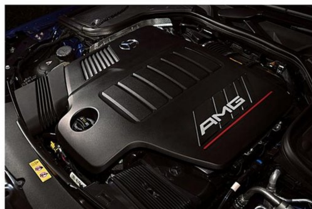
435PS/520Nmを発生する3ℓ直6ツインターボエンジン。装着タイヤはミシュラン・パイロットスポーツ4Sだ。
