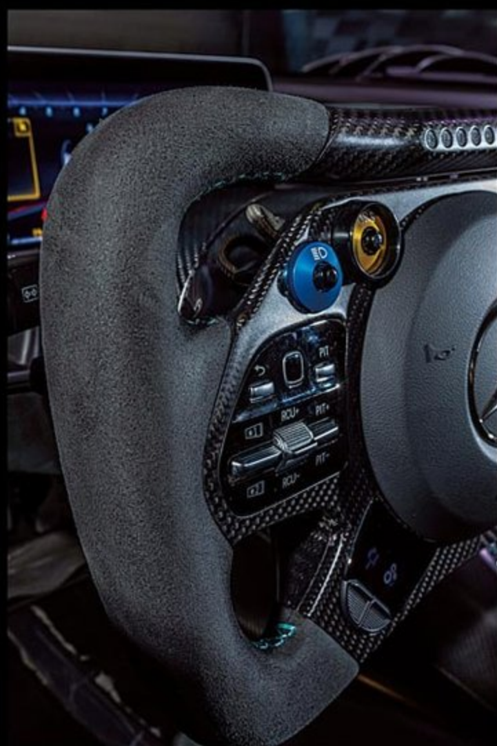
本物のレーシングカーと同様にステアリングに様々な機能が備わる。形状もF1に似ている。センターディスプレイには水温、油温はもちろんバッテリー温度なども表示される。
