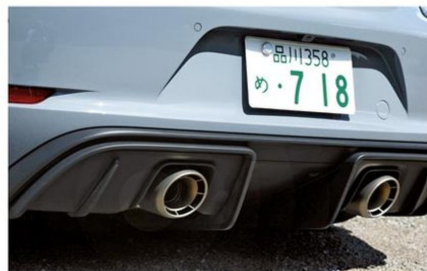
大型リヤディフューザーの下に見えるテールパイプは、ヴァイザッハパッケージを装着するとチタン製となり、刺激的なサウンドをもたらす。
