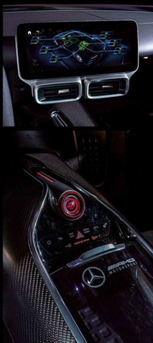
本物のレーシングカーと同様にステアリングに様々な機能が備わる。形状もF1に似ている。センターディスプレイには水温、油温はもちろんバッテリー温度なども表示される。
