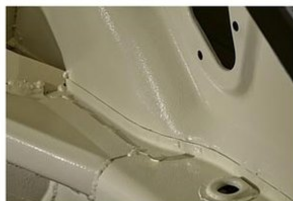
前はサフェーサーが塗られた状態だったが、シーリングし、チッピングコートを吹いた上に、1973年式911の純正色であるライト・アイボリーの塗装が綺麗に施されたエンジンルーム。その光景はまさに新車以上と言っていい。
