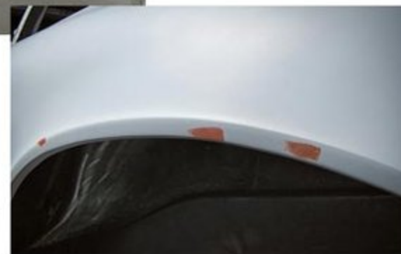
→面出しを行った後、塗装前の仕上げ用サフェーサーが吹かれたボディサイド。まだ塗布されていないルーフやピラーと色が違うのがわかるだろうか。この後、最終的な研ぎとチェックが行われ、塗装に移ることになる。
