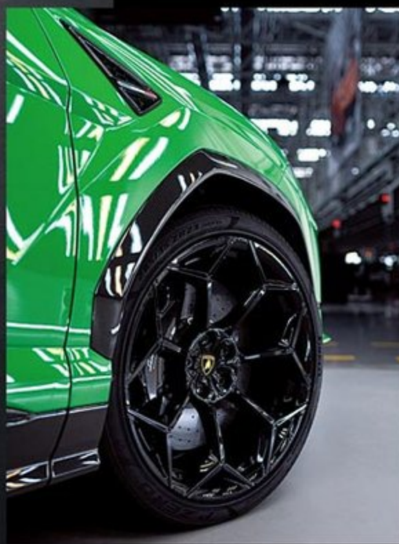
車高は従来より20mm低くなり、トレッドも広げられた。ホイールのボルトはチタン製だ。タイヤはピレリと共同開発したPゼロ。
