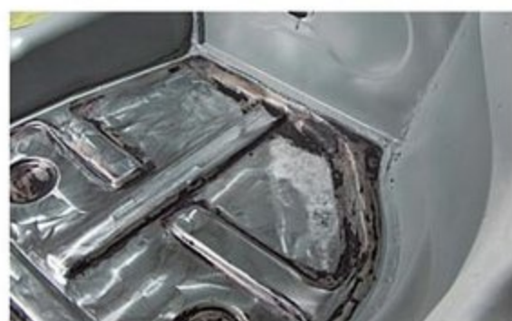
ピカピカになるまで研磨されていても、細かな凹みやアールになっている部分には、このように目に見えない錆や酸化被膜が残っている。
