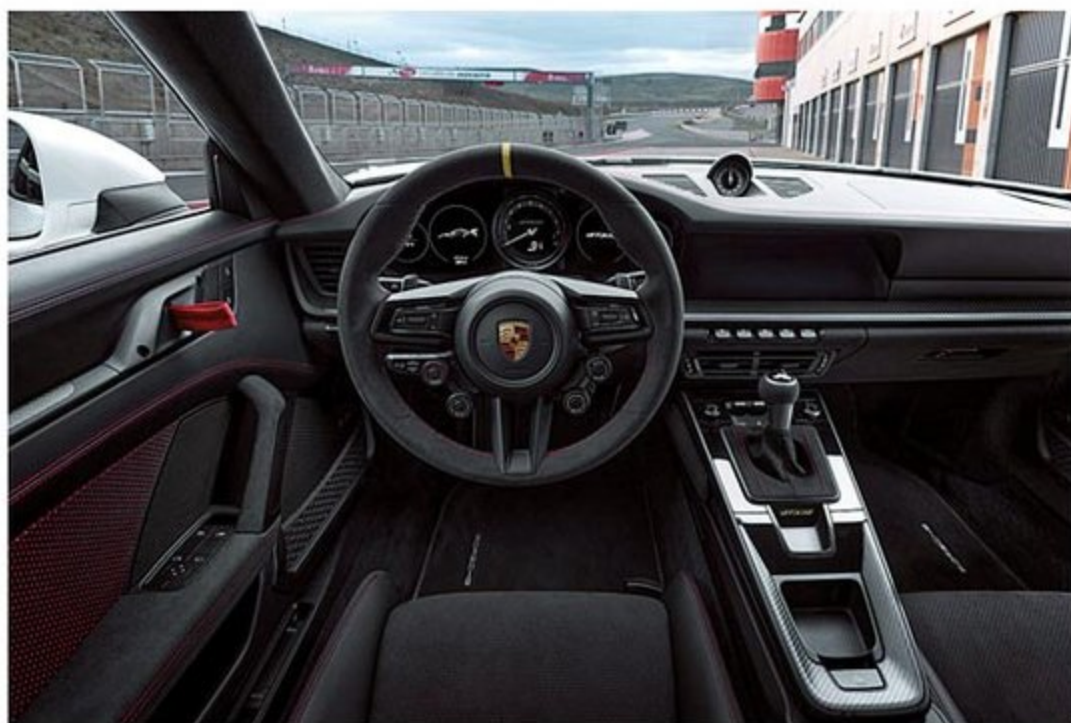
アルカンターラのステアリングにはドライブモードのロータリースイッチに加えて、ESC/TRC、PTV Plus、PASM、さらに左スポークにはDRSの調整ダイヤルが備わる。設定値はメーターに表示される。
