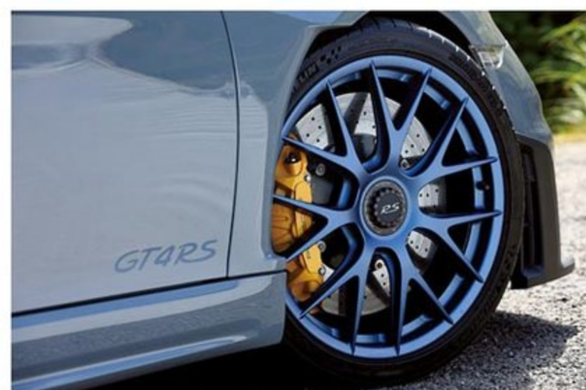
今回の試乗車のオプションリストでもっとも高価な20インチ鍛造マグネシウムホイール(247万5000円)。PCCB(131万7000円)が可愛く見える。
