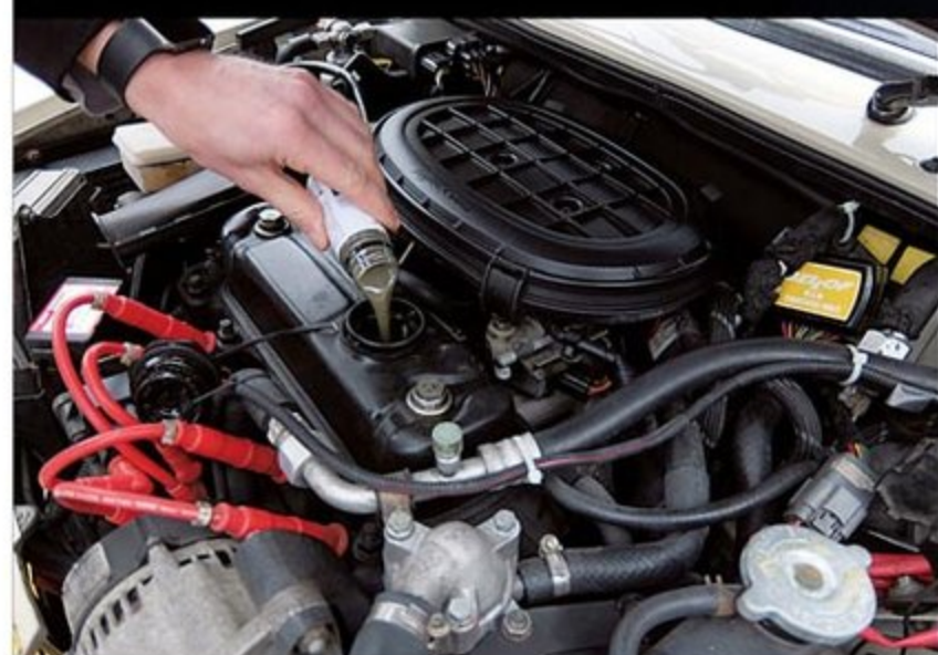
↑パワーショットはフィラーキャップを開けて投入するだけ。G5はオイル粘度が高いので注入器を用いる。4ストロークであれば2輪車や船、飛行機などにも使用できるという。
