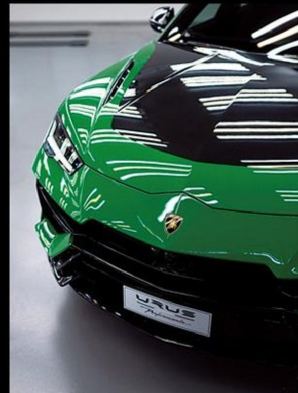
エアカーテン効果を高めた新デザインのバンパーを採用。エアアウトレットが設けられたボンネットはカーボン製だ。
