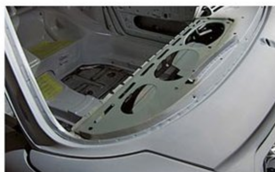
完成したら見えなくなるこんな部分にも濃い色のサフェーサーを捨て吹きして、傷や歪みを可視化する。これもテクニックのひとつ。
