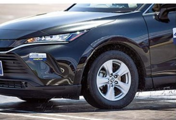
ウェットグリップは先代と比べて8%向上したと謳う。摩耗が進んでも溝幅が広がるトレッド断面を採用しており、ライフ後半も安心だ。
