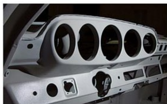
赤錆が浮いていたインパネの給油パネル・オープンナー基部も防錆修復済み。錆が表面に止まり、深く進行していないのが幸いした。
