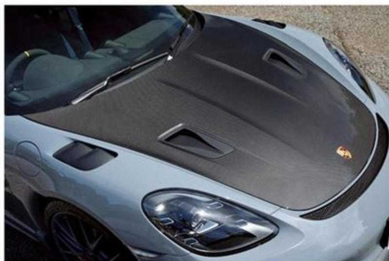
NACAダクトを備えたフロントリッドやフロントフェンダーのフェンダールーバー、サイドエアインテーク、スワンネック型リヤウイングなどはCFRP製となる。
