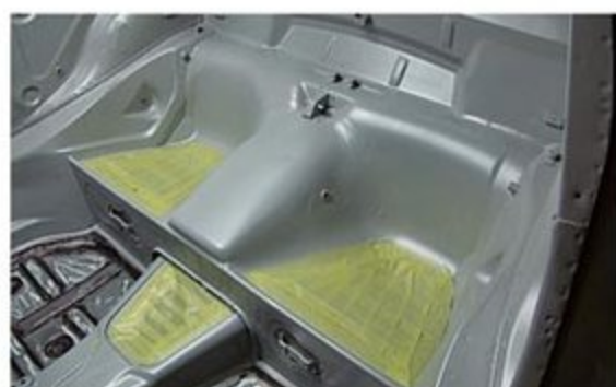
錆転換剤の処理が終わった場所には防錆サフェーサーが吹かれ、念押しされている。リヤシート座面部のマスキングは天井作業のための足場。
