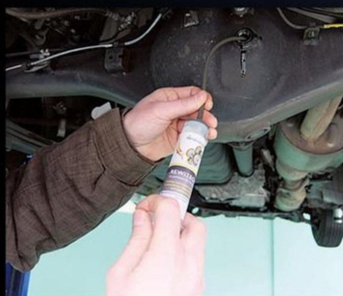
↑パワーショットはフィラーキャップを開けて投入するだけ。G5はオイル粘度が高いので注入器を用いる。4ストロークであれば2輪車や船、飛行機などにも使用できるという。
