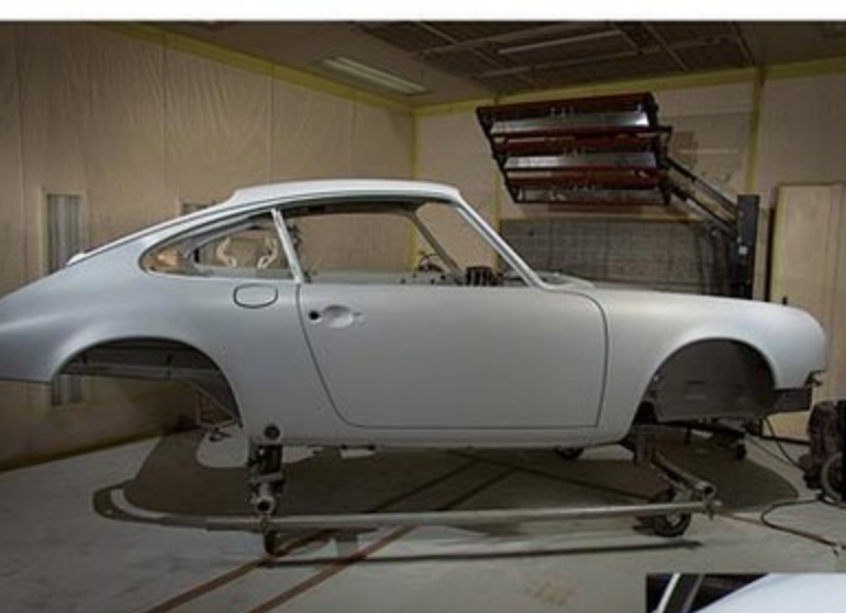
→面出しを行った後、塗装前の仕上げ用サフェーサーが吹かれたボディサイド。まだ塗布されていないルーフやピラーと色が違うのがわかるだろうか。この後、最終的な研ぎとチェックが行われ、塗装に移ることになる。
