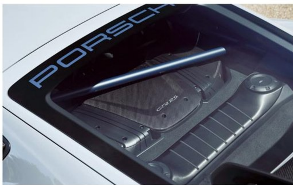
ロールオーバーの下に見える4気筒水平対向6気筒自然吸気エンジン。サイドウィンドウの位置から吸気するエアインテークが激しいサウンドをもたらす。
