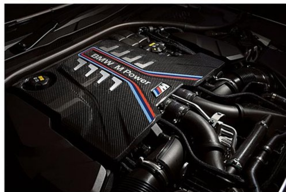
625PS/750Nmを叩き出す4.4ℓ V8ツインターボを搭載。装着タイヤはピレリPゼロとなる。
