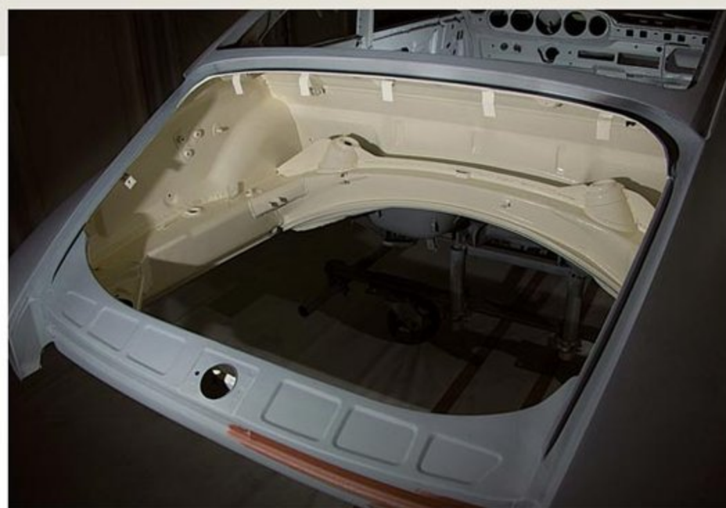
前はサフェーサーが塗られた状態だったが、シーリングし、チッピングコートを吹いた上に、1973年式911の純正色であるライト・アイボリーの塗装が綺麗に施されたエンジンルーム。その光景はまさに新車以上と言っていい。
