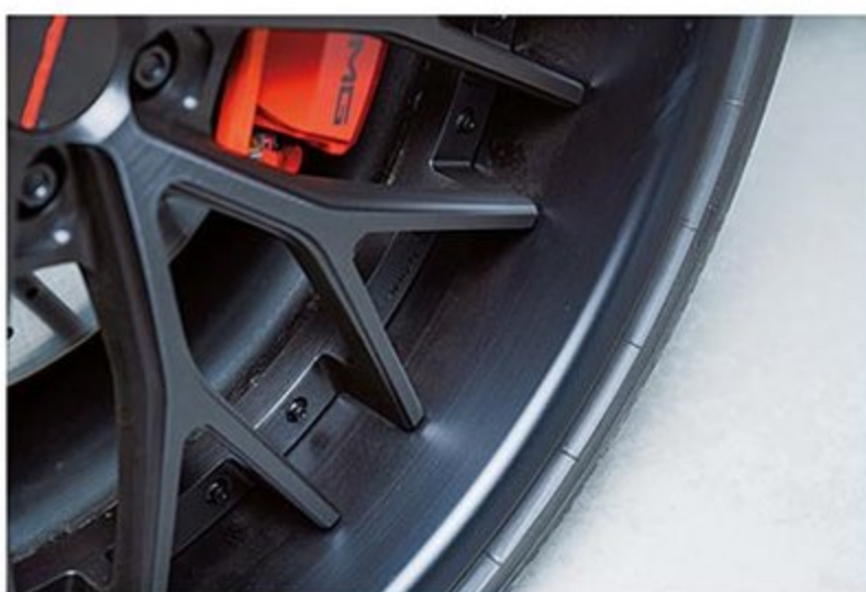
センター付近で二手に分かれ、さらに途中で分岐してリムへと到達するメッシュデザインを持つ。リム裏側にはピアスボルトが存在し、マルチピースホイールであることを訴える。
