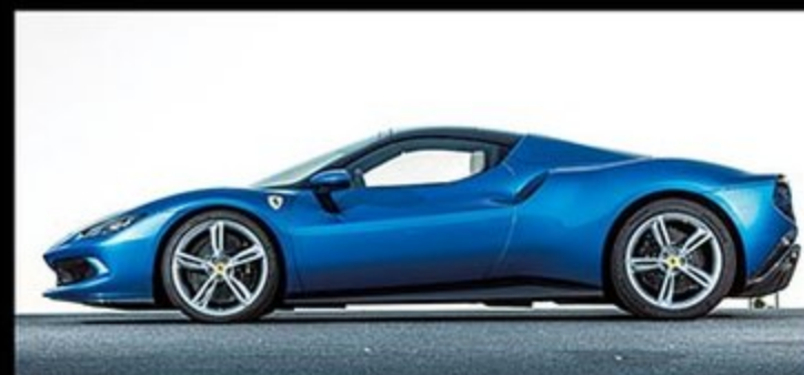
296 GTSはリトラクタブル・ハードトップを採用。ボディとルーフはBピラー上で分離し、格納時には分割されてエンジン前方に折りたたまれる。オープン/クローズド時ともにエンジンベイの放熱特性は変化しない。最高45km/hまで走行中でもリトラクタブル・ハードトップの展開は可能で、わずか14秒で開閉できる。
