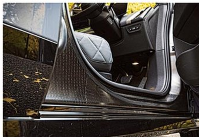
軽量化と高剛性を両立させるためにアルミスペースフレームにCFRPとスチールを随所に使用したボディを採用している。
