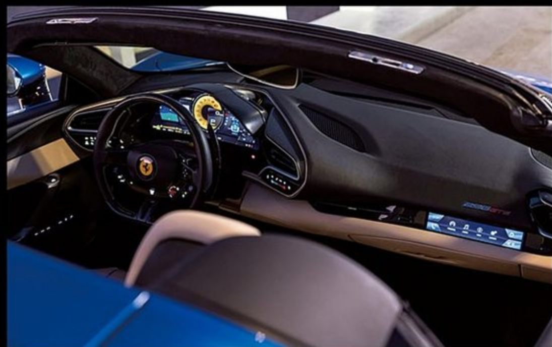
SF90ストラダーレが先鞭をつけた新コンセプトのcockpitデザインを継承。インパネはエンジン停止中にブラックアウトされる。
