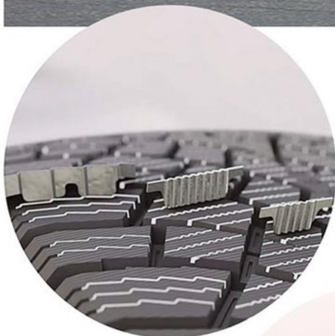
↑3Dロックサイプを新たに採用したことで高いブロック剛性を確保することに成功。氷雪路での高いハンドリング性能に寄与している。
