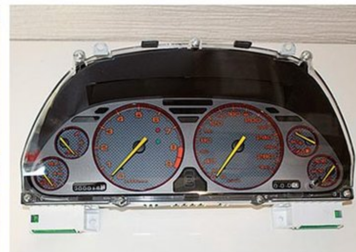
初代NSXは登場から20年以上経過したこともあって相談が増えているモデル。この個体はリフレッシュと同時にカスタマイズも実施。カーボンメーター化&300km/hフルスケールと指針をイエローに変更している。
