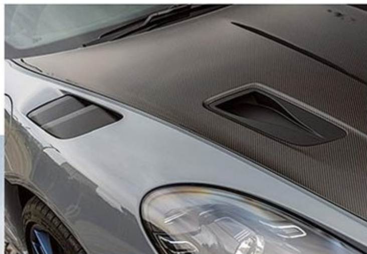
ボンネットはカーボン製となっている、2カ所のNACAダクトから入ったエアはブレーキの冷却へとつながっている。
