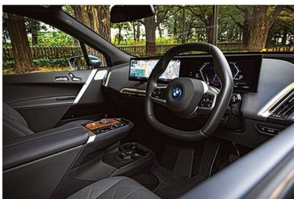
14.9インチのコントロールディスプレイと12.3インチのインフォメーションディスプレイで構成された最新のBMWライブコックピット。
