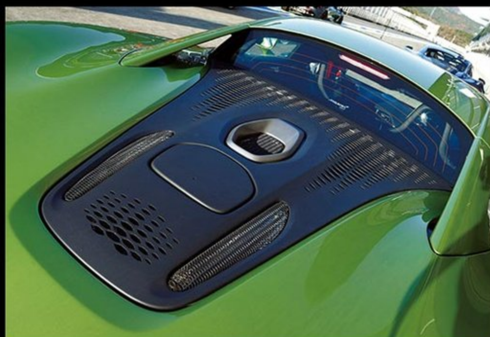
新開発のV6ツインターボの真上にレイアウトされるチムニー。ホットVレイアウトの排熱を900℃から240℃にまで下げる効果があるという。
