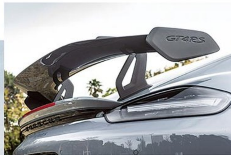
GT3と同じくスワンネックタイプのリヤウイングは角度は可変できない。リヤハッチ後端のウイングは固定式となる。
