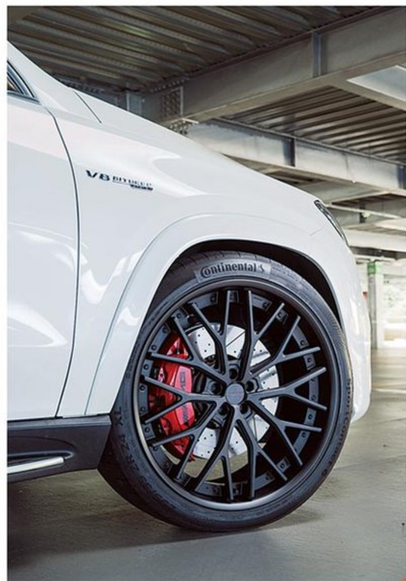
フロント10.5J、リヤ12.5Jの24インチがGLS 63の巨体にすっぽりと収まる。タイヤはそれぞれ295/35R24、335/30R24サイズのコンチネンタル・スポーツコンタクト6だ。
