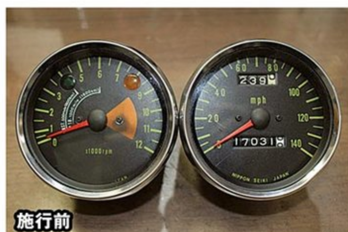
バイクのメーターもお手のもの。このカワサキ750SSのメーターは、マイル表記からキロ表記に変更したほか、ケーブルまわりもフルオーバーホールすることで、新品同然の状態を取り戻している。
