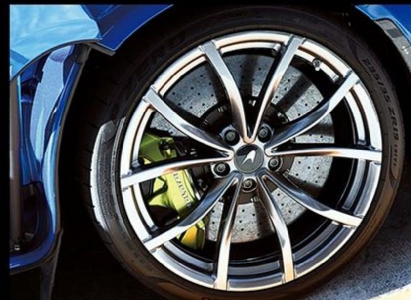
大径カーボンセラミック製ブレーキローターはフロント390mm、リヤ380mm。タイヤは承認タイヤのピレリPゼロを装着していた。
