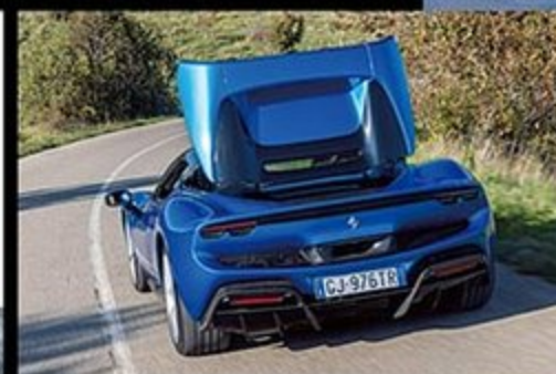
296 GTSはリトラクタブル・ハードトップを採用。ボディとルーフはBピラー上で分離し、格納時には分割されてエンジン前方に折りたたまれる。オープン/クローズド時ともにエンジンベイの放熱特性は変化しない。最高45km/hまで走行中でもリトラクタブル・ハードトップの展開は可能で、わずか14秒で開閉できる。
