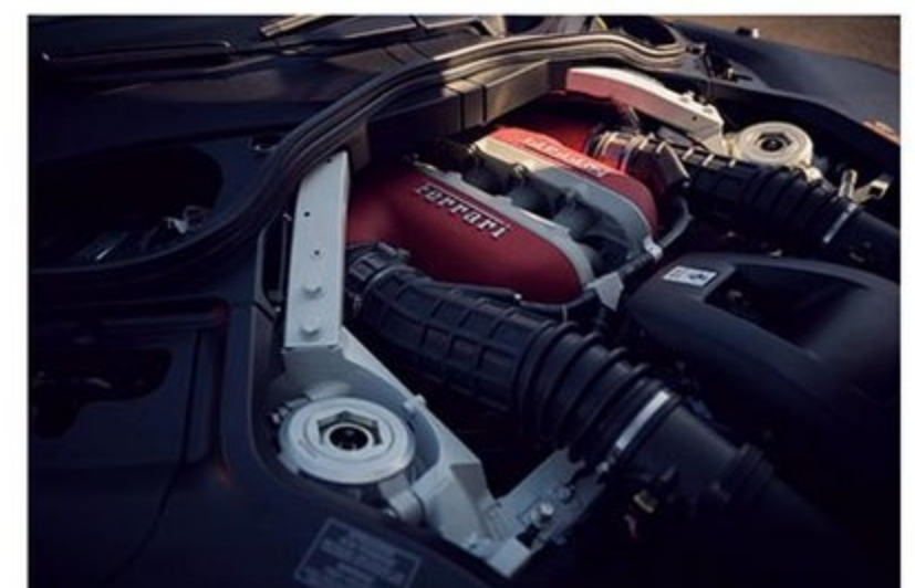
V12気筒の自然吸気エンジンはフロントミッドに搭載される。駆動はもちろんAWDでAWSも備える。
