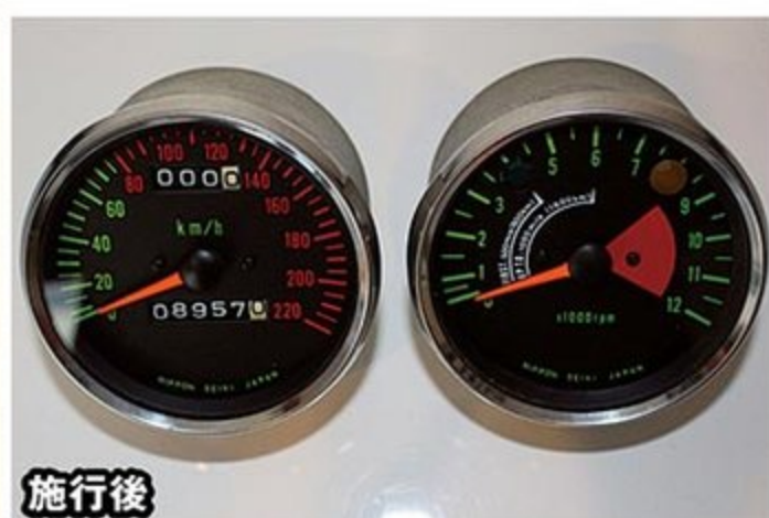
バイクのメーターもお手のもの。このカワサキ750SSのメーターは、マイル表記からキロ表記に変更したほか、ケーブルまわりもフルオーバーホールすることで、新品同然の状態を取り戻している。
