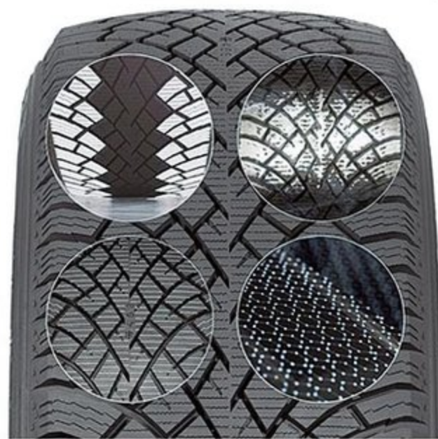
←アーキティックグリップクリスタルをコンパウンドに配することで卓越したアイス性能を発揮する。大きめのブロックが配置されたアウター部がコーナリング時に横方向のグリップを生み出し、先代モデルより約40%増加したトレッドブロック数がエッジ効果を高めている。
