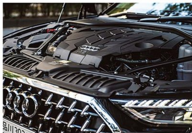
460PS/660Nmを発生する4.0L V8ツインターボに48V電源システムを組み合わせる。トランスミッションは8速ATとなる。
