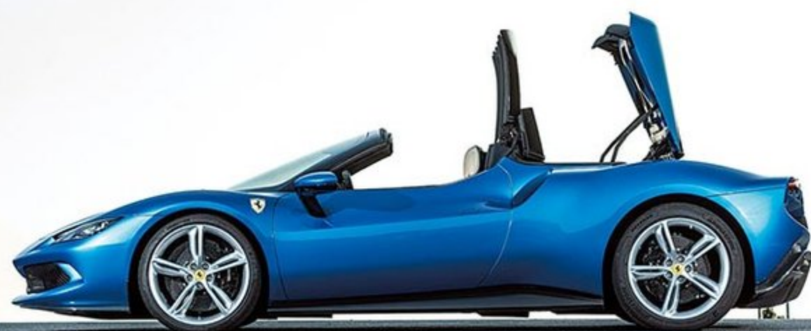
296 GTSはリトラクタブル・ハードトップを採用。ボディとルーフはBピラー上で分離し、格納時には分割されてエンジン前方に折りたたまれる。オープン/クローズド時ともにエンジンベイの放熱特性は変化しない。最高45km/hまで走行中でもリトラクタブル・ハードトップの展開は可能で、わずか14秒で開閉できる。
