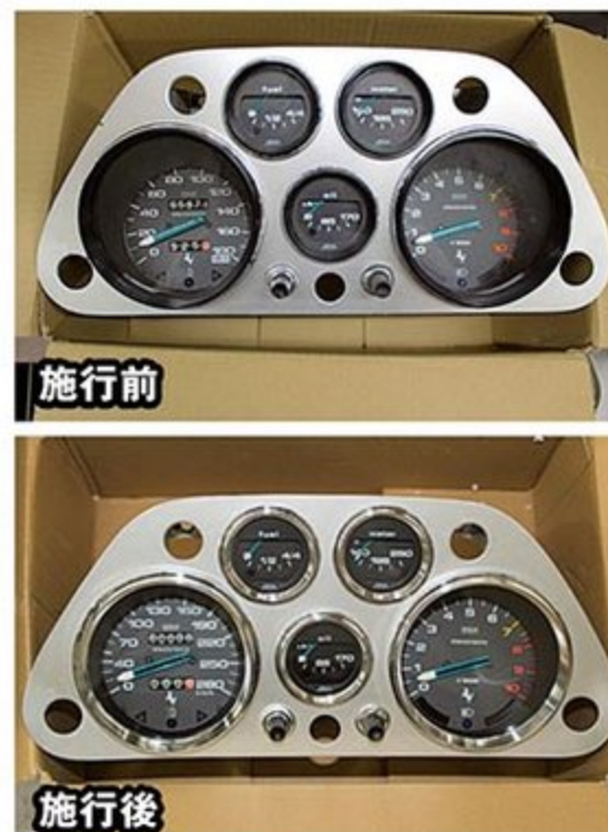
フェラーリ308GTBのメーターは、内部のリフレッシュに加えて、盤面交換と指針を調整でマイル表記をキロ表記に変更。メーターリング周辺の樹脂もメッキ加工で美しく仕上げています。
