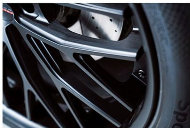
24インチの場合、P.C.Dは5-112～150まで対応する。どのサイズもボルトホール間をスポークが通り、スタイリングを犠牲にしない。
