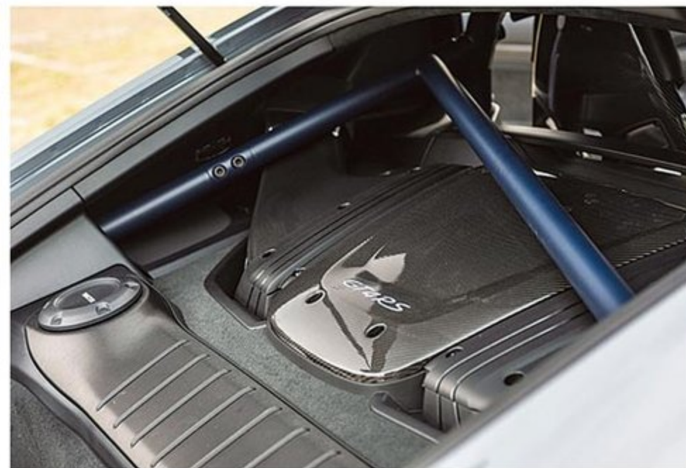
4.0 L 水平対向6気筒NAエンジンは911 GT3より10 PS低い500 PS、20 Nm低い450 Nm。インテーク周りが室内にあるため、走行中はかなり賑やかだ。
