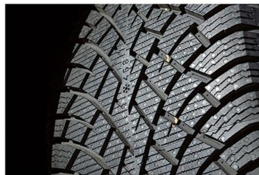
最近のスタッドレスタイヤのトレンドは非対称デザインだが、R5は回転方向指定の対称トレッドデザインを採用する。北欧の厳しい冬を乗り越えてきたタイヤメーカーが選んだ誇りに満ちたトレッドパターンである。
