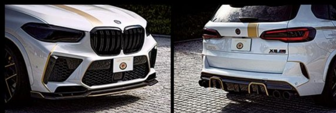
軽量高剛性のカーボン素材をふんだんに用いるボディキットを装着することで、スタイリングに唯一無二の個性が宿る。エキゾーストシステムはバルブ制御機構付きのステンレス製。TP0に合わせてオン/オフを切り替えることも可能。
