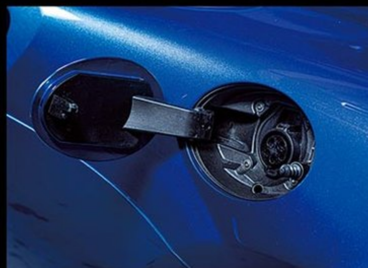
左リヤに備わる充電口。バッテリー容量は7.4kWhでEV走行可能距離は最大30km。2時間30分で80%の容量まで充電できるという。
