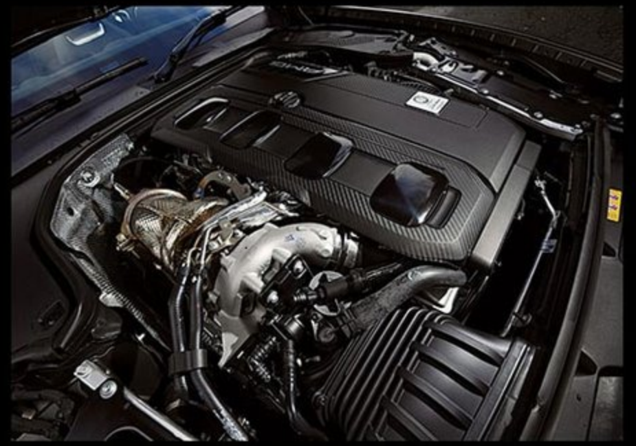
F1由来の電気リク・エキゾーストガス・ターボチャージャーを採用したM139型2.0直4を搭載。低回転時から電動モーターがタービンを回すことで、ターボラグのない鋭いレスポンスを味わえる。
