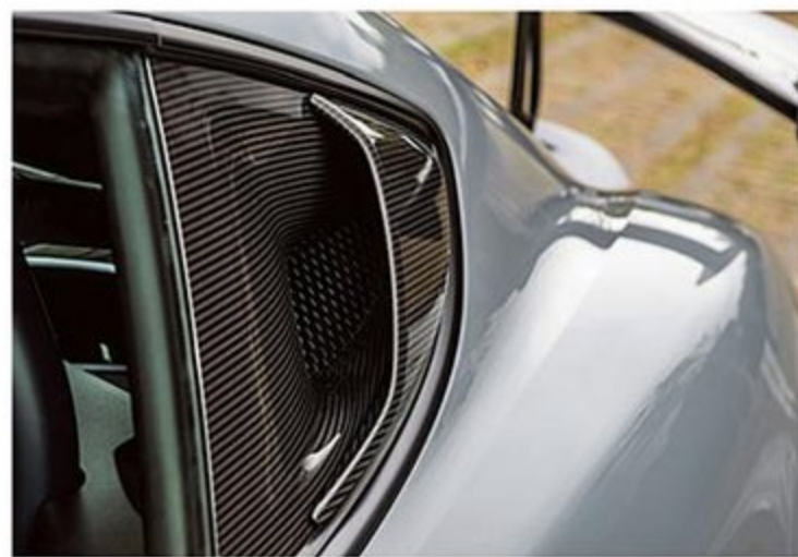
リヤクォーターウィンドウはカーボン製のエアインテークに変更されている。ここから採り入れたエアはダクトを通してエンジンに送られる。
