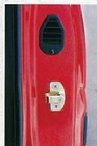
▲ドア開口部後端には、ベンチレーション用のエアダクトが設けられている。室内の換気を促進させるのだ。
