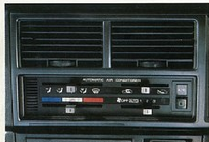
▲オートマチック・エアコンディショナーはOPT設定。A/Cスイッチを入れ、ブロースイッチをAUTOにしておけば、室内は常にセットした温度に保たれる。わずらわしい温度調節とはサヨナラだ。
