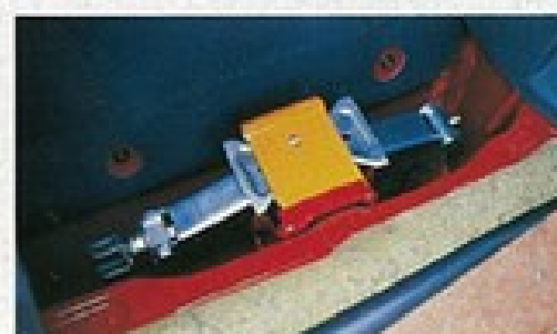
▲トランクリッド・ストライカー下部のレバーで、室内からのトランクリッド・オープナーをキャンセルできる。ジャッキはゆるめて外す。
