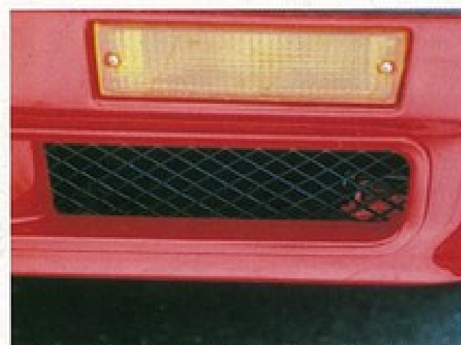
▲高い冷却効果が得られるように、空冷インタークーラーの冷却ダクトは、バンパー左下にある。
