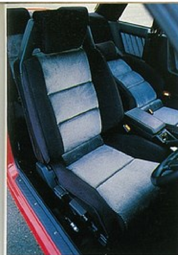
▲フロントシートはバケット形状のヘッド性の高い、ハイサポートシートを採用。ヘッドレストも前後に調整できる。
