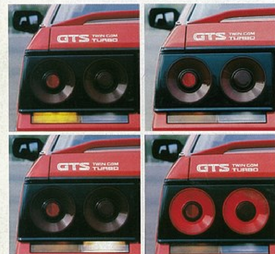
▲リヤコンビネーションランプ4景。普通の状態(右上)、ブレーキを踏んだ状態(右下)、方向指示器を出した状態(左上)、バックの状態。
