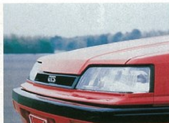
▲新しいデザインの薄型異形4灯式ハロゲンヘッドランプ。フロントビューを大幅に引き締める。
