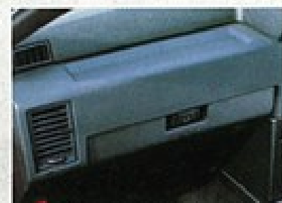
▲助手席側にあるグローブボックス。その上は小物を置けるようにトレー形状となっている。
