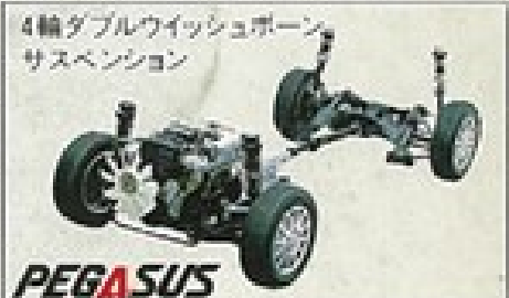
4輪ダブルウィッシュボーンサスペンション
