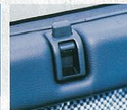
▲GTS-Xには一定速度で自動ロックする車速感知式集中ドアロックが装備される。
