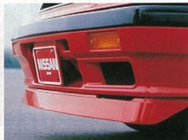
▲室内のスイッチにより、停車中でもフロントスポイラーをスイングダウンできる。かなり大型だ。
