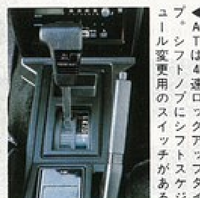
▲ATは4速ロックアップタイプ。シフトノブにシフトスケジュール変更のスイッチがある。
