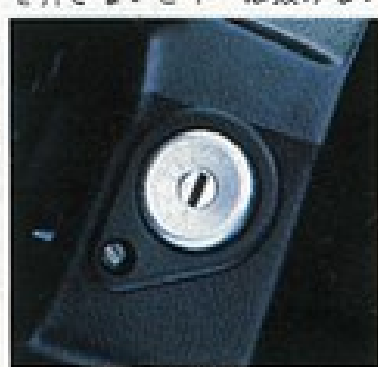
▼GTS-Xには、サテライトスイッチ内側にメーター類のイルミネーションコントロールスイッチが配されている。
