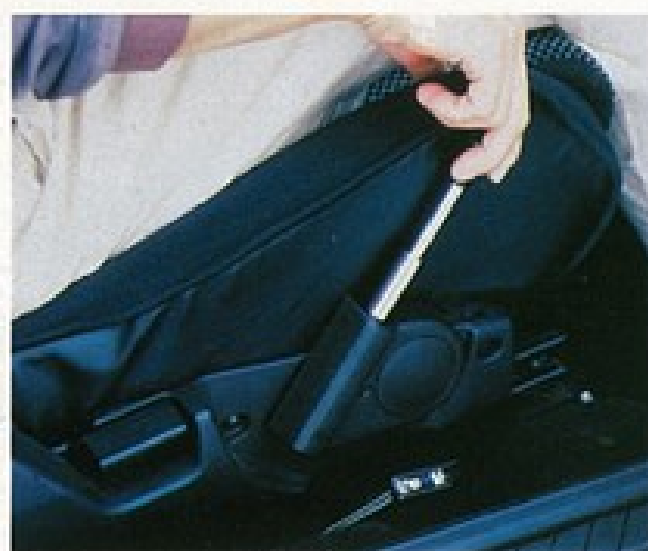
▲ドライバーの座高に合わせて、シートの高さを調節できるフリーシートセッターを装備。レバーを引いて操作を行なう。
