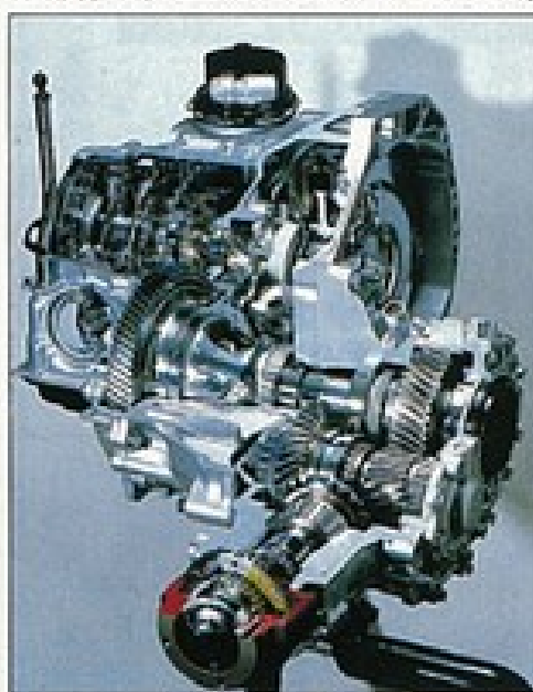
▼ミッションの手前の赤く塗ってある部分が、ビスカスカップリングだ。
