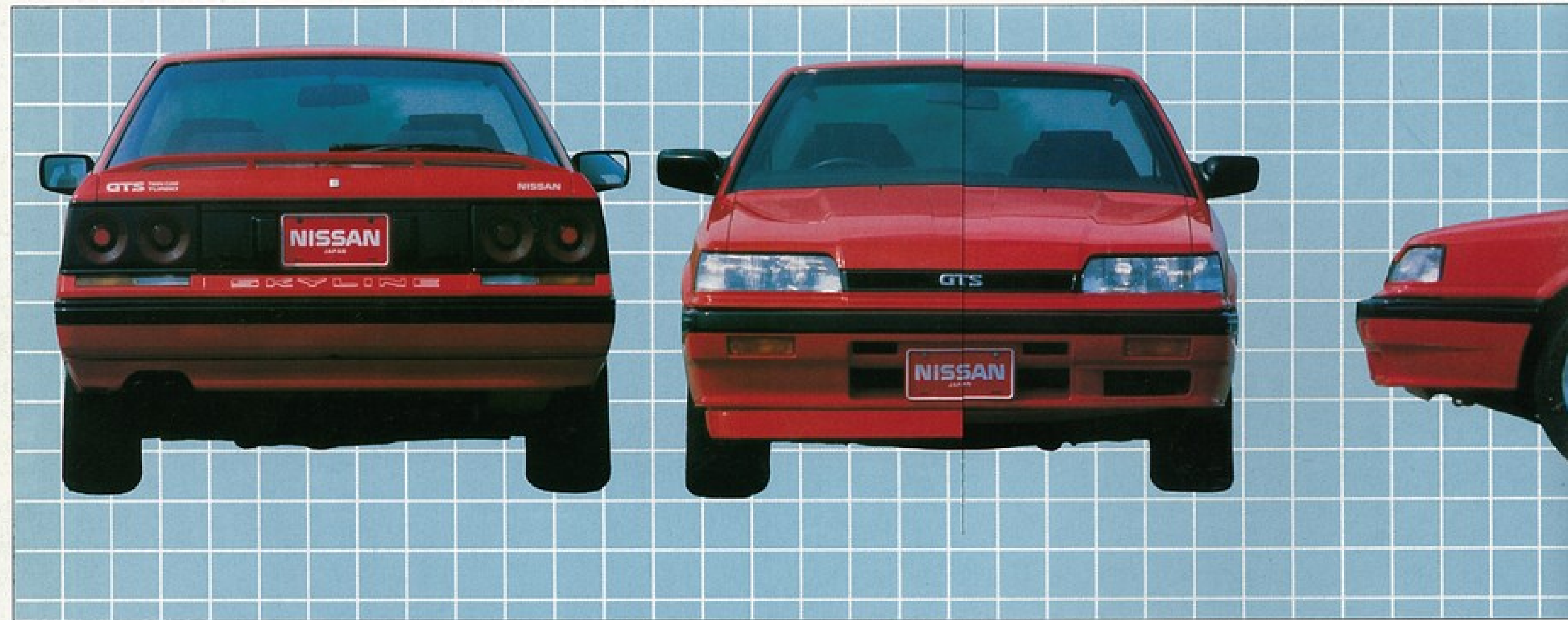
▲高い冷却効果が得られるように、空冷インタークーラーの冷却ダクトは、バンパー左下にある。
