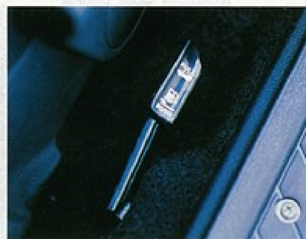
▲トランクリッドとフューエルリッドオープナーは1本のレバーで共用している。引くとトランクリッドが、押すとフューエルリッドが開く。
