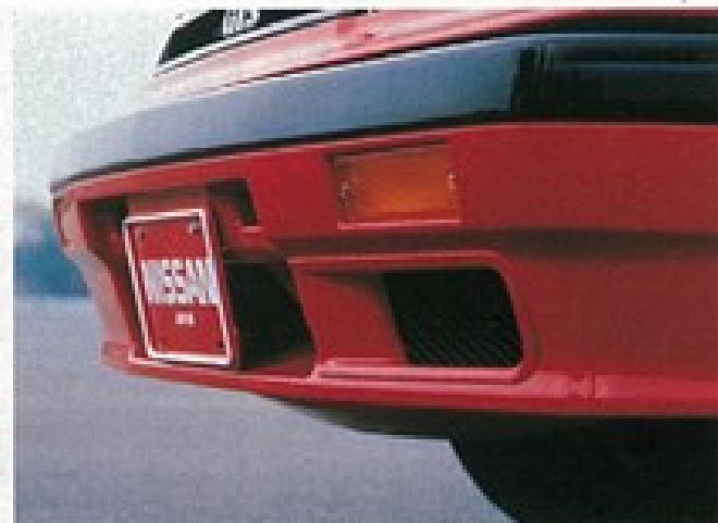
▲時速70km/hで自動的にスイングダウンする世界初のGTオートスポイラーがOPT装着できる。
