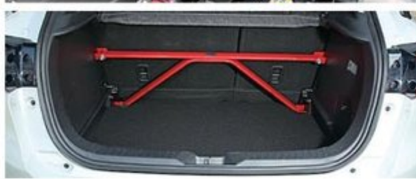
タワーブレースセット：5万8000円 センターフロアバー：2万8000円 機能最優先のデザインでボディ剛性を高めるタワーブレースセットはフロント1、リア5の全6ピース構成。室内に装着するセンターフロアバーのほか、メンバーブレースセットなど剛性アップパーツを豊富にラインアップしている。
