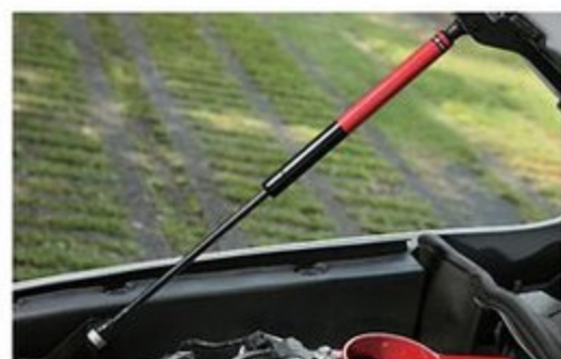
ボンネットダンパー：2万円 ボンネットの開閉を高圧ガス封入式ダンパーでアシストして、利便性と車格感のアップが図れるボンネットダンパー。車種別専用ブラケットによりボルトオン装着が可能だ。
