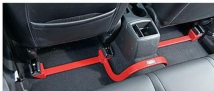
タワーブレースセット：5万8000円 センターフロアバー：2万8000円 機能最優先のデザインでボディ剛性を高めるタワーブレースセットはフロント1、リア5の全6ピース構成。室内に装着するセンターフロアバーのほか、メンバーブレースセットなど剛性アップパーツを豊富にラインアップしている。
