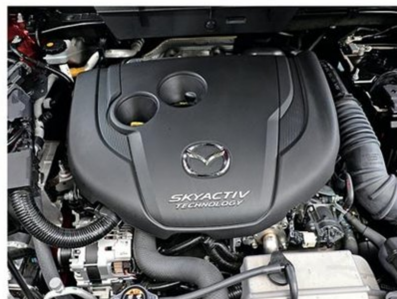
力強いトルクと高回転まで軽快に吹け上がるフィーリングを示す“SKYACTIV-D”搭載のCX-5。緻密な燃料噴射を行うマルチホールピエゾインジェクターや理想的な燃焼を促すエッグシャイプピストンを採用。低圧縮比14.0を実現したクリーンディーゼルエンジンである。
