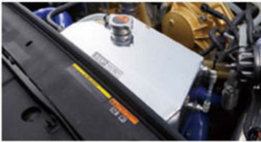
リザーバタンク
