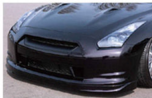
ノーマルバンパーをベースに、エンブレムやナンバーベース、フェンダーのサイドマーカ-をスムージング。開口部自体は拡大していないのだが、片側40mmのワイド化と相まって重厚感のあるフェイスへと仕上がった。
