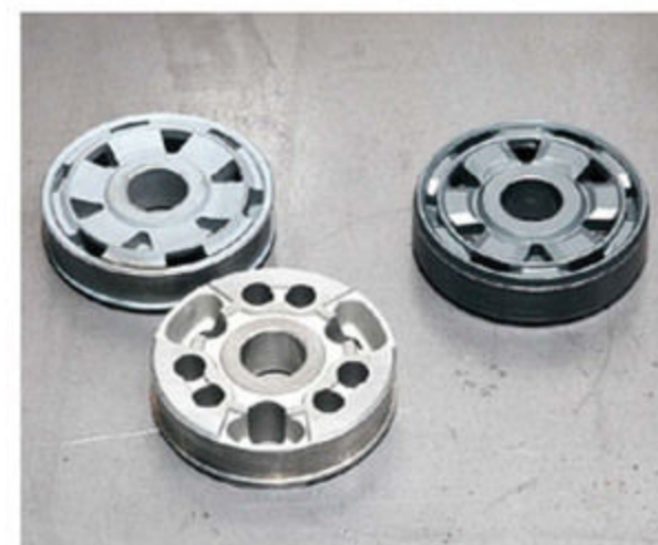
ピストンの形状でも減衰力の出かたは変わってくる。デッキでは形状の異なるピストンをいくつも持っていて、仕様変更をオーダーした際には、必要に応じてピストンを選択し、組み込む。(右がノーマル)
