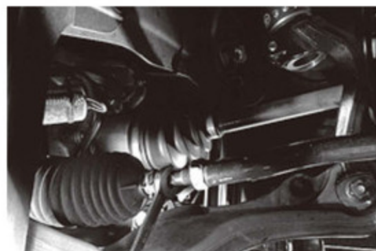
トーインはステアリングタイロッドで調整。インにつればシャープに。アウトにすればマイルドに。基本、R35でアウトはNGとされている。偏摩耗だけでなくタイヤバーストの原因になるからだ。
