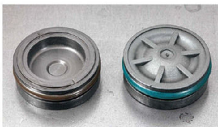
純正のフリーピストン(右)は樹脂製だが、これも仕様変更すれば、アルミ鍛造材を使った剛性の高いフリーピストンに交換してくれる。軽くなって動きやすく、かつ伸縮の切り替わりでは止まりやすくなる。また圧力がかかってもフリーピストンが変形しないので、確実に減衰力が発生するようになるという。また、フリーピストンのオイルシールも硬いものに変更し、減衰力の発生を確実にする。
