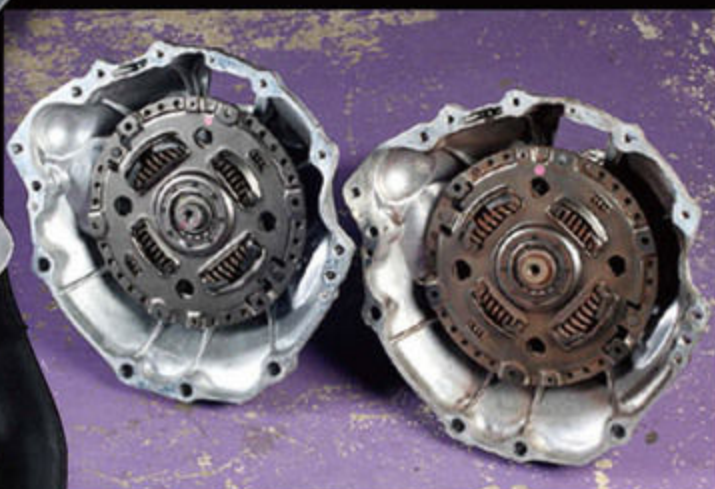
左が対策品(KB50A)で、右がMY2007～MY2009に実装されているフライホイールハウジング。対策品はベアリング部にスナップリングが追加され、スラスト方向への動きを規制するよう改善されている。
