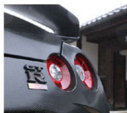
ドライカーボンを15層も積み重ねて製作されるという圧巻のオリジナルエンブレム。ダイヤモンドカットによりソリッドなイメージを演出する。
