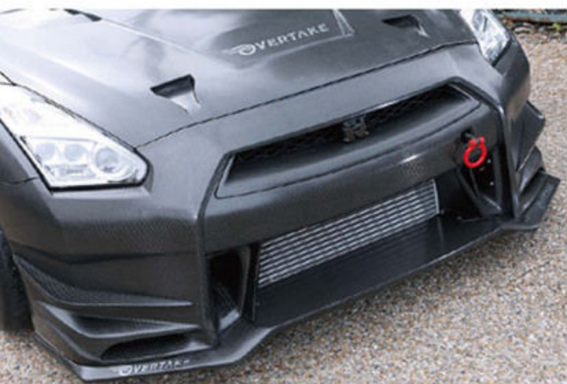
主要パーツのみならず、ルーフパネルやピラー、リヤフェンダーまでドライカーボンで再構築したボディ。トータルで140kg以上の軽量化が可能になる最高級マテリアルの魔力にばかりにと目を奪われてしまうが、細部フィニッシュがメーカー品質と言いつけるほどハイクオリティだったことも印象的。なお、これらは全てオリジナルパーツとして販売されている。
