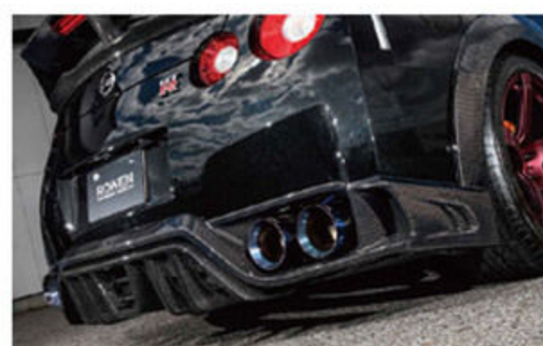
リアセクションはアンダースポイラーとレーシングディフューザーを設定。マフラーが発生させた熱を効率よく放出するため、流速を高めてアンダーフロアの空気層を素早く後方へと排出できる形状を追求。ディフューザー形状を積極的に取り入れ、ダウンフォース効果も大幅に向上させている。
