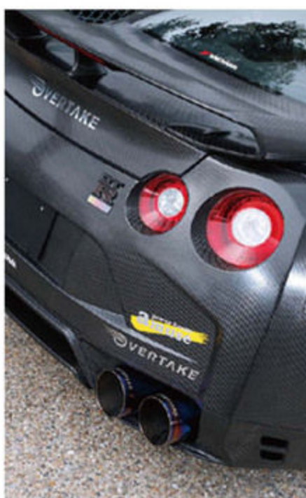
アミューズとのコラボレーションで誕生したエキゾーストな、オーバートイク1000psへの対応を命題にメイン100mmのストレート構造とし、さらに実用域への配慮で可変バルブ機構も搭載。素材は高耐熱性を誇るチタン合金（STT）だ。
