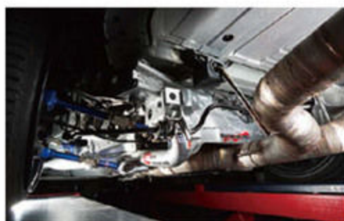
スタイリングだけでなく、中身にも拘わるのがラッシュモータースポーツの提唱するネオスタンダード。チューブ構造内部の充填とスポット増しで強化するリアメンバー、スピードマスターと共同開発したスペシャルMTオイルなどを与える。
