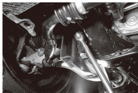
キャンバーはロアアームの前側取付けボルトで調整。キャンバーを多くするとサーキットでは良いが、一般走行ではタイヤの内減りを促進する。使用用途によって調整する。
