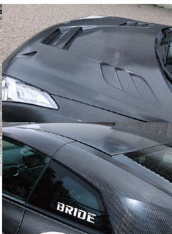
主要パーツのみならず、ルーフパネルやピラー、リヤフェンダーまでドライカーボンで再構築したボディ。トータルで140kg以上の軽量化が可能になる最高級マテリアルの魔力にばかりにと目を奪われてしまうが、細部フィニッシュがメーカー品質と言いつけるほどハイクオリティだったことも印象的。なお、これらは全てオリジナルパーツとして販売されている。
