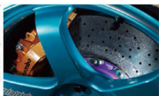
ブレーキはブレンボ製カーボンローターを軸にしたオリジナルのシステムだ。ストッピングパワーの増強はもちろん、純正比マイナス20.5kgという超軽量化が可能になる。
