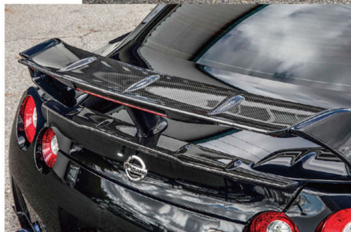
リアウイングも純正部品の一部を利用しながらハイマウント化が図れるバージョンIIへと発展。フィン形状をデザインに取り込んだカーボンフラップを採用し、その意匠に合わせて設計されたトランクスポイラーもバージョンIIがラインナップされる。
