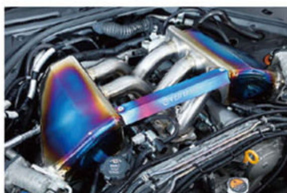
ヒートグラデーションが美しい唯一無二のフルチタン製サージタンクもオーバートイクの製品だ。内部はファンネル形状を採用し、1000psターゲットで吸気管長も最適化されている。
