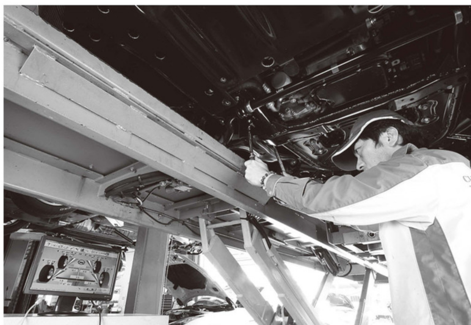
トーインはステアリングタイロッドで調整。インにつればシャープに。アウトにすればマイルドに。基本、R35でアウトはNGとされている。偏摩耗だけでなくタイヤバーストの原因になるからだ。
