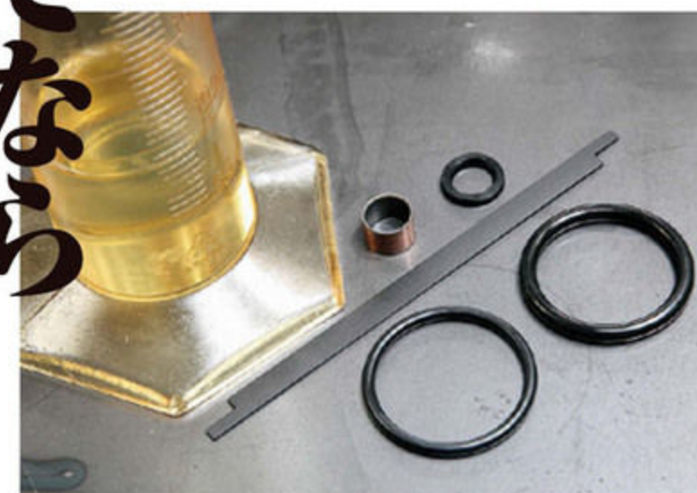
オーバーホール時に必須となる交換部品。摩耗、劣化しやすいフリーピストンやロッドガイドのオイルシール、ベアリング、ピストンのバンド、リップシール、そしてフルードだ。
