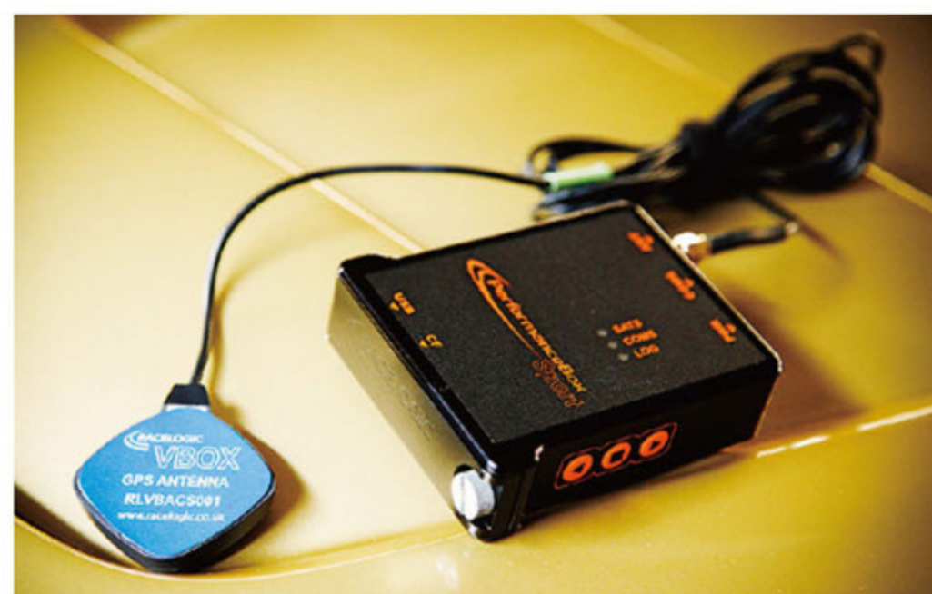
速度計測には世界最高峰の精度を誇るGPS型の速度計測器「V-BOX」を投入した。
