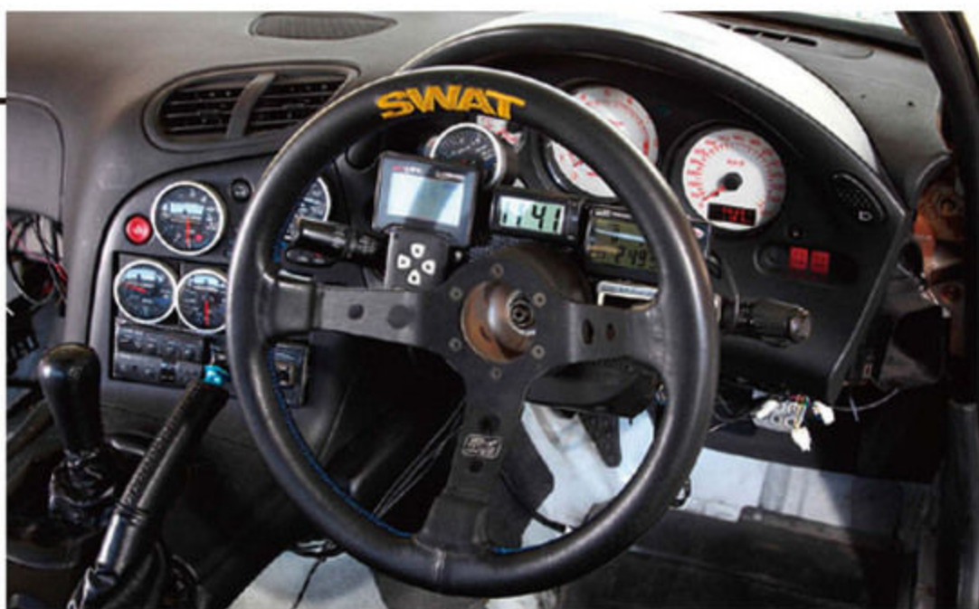
FCコマンダーや各メーター類が集約され、車両情報収集機能が高められたコックピット。さらなるステップアップを図るため、現在は残されているヒーターやダッシュボードの撤去も考えている。
