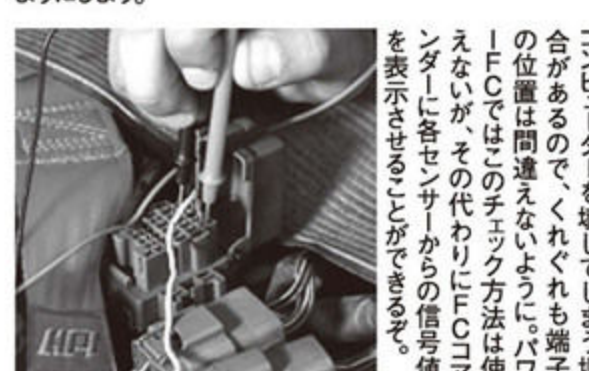
ダイアグノシスコネクターはヒンジがついていてフタを開けることができる。作業が終わったあとは必ず閉めておくようにしよう。
