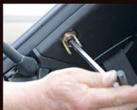
アンカーボルトの取り付け穴を利用して、ミラクルクロスバーのエンドパーツを固定する。締め込みには3/8インチの六角レンチが必要だ。
