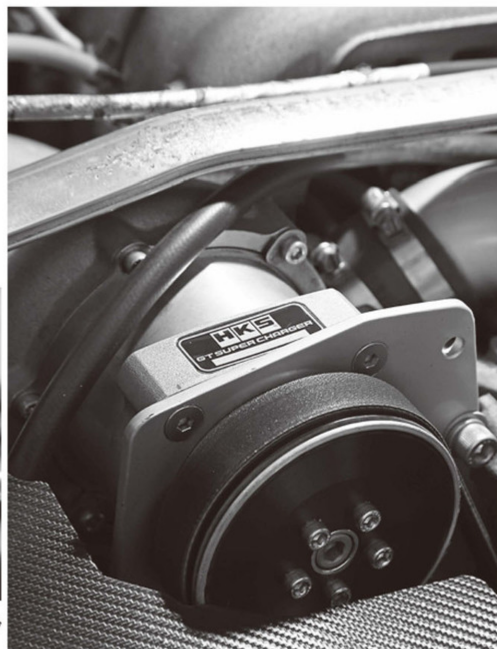
最大ブースト圧は1.0kg/cm 2 近辺。2500rpmあたりから過給され、 3000rpmでは30kgf-mのトルクを発生する。低回転側にパワーゾ ーンを広げることで、全域での加速が可能となる。
