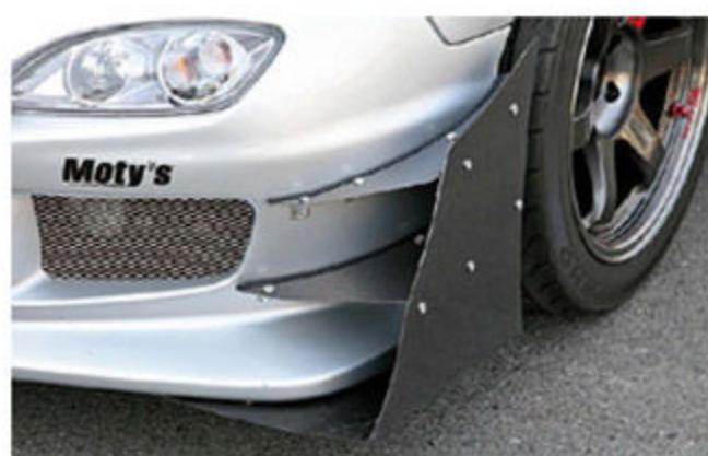
フロントリフトを抑え、フロントの接地性を高めて推進力へと変換するため、3段タイプのカナードを導入。強大なダウンフォースを獲得している。
