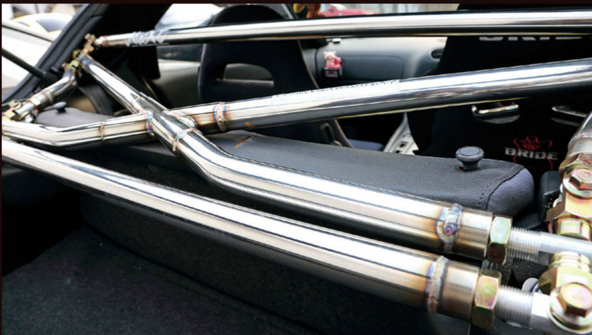
アップグレードキットの取り付けも基本的にボルトオンで行う。まずはブラケットの角度を決定し、パイプの長さを調整していく。
