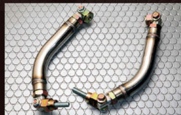
接合部は経年変化が少なく、ピロボールプッシュにも使われる45C鋼材を使用。さらに大きな負担がかかるボルトはSCM(クロムモリブデン鋼)製を用いるこだわりぶり。
