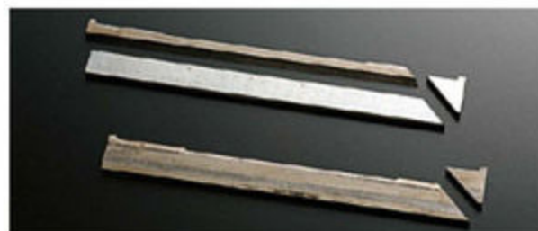
アベックスシールは3分割タイプを使用。装着されていたアベックスシールに応じて、削りタイプとワイヤーカットタイプを使い分けている。
