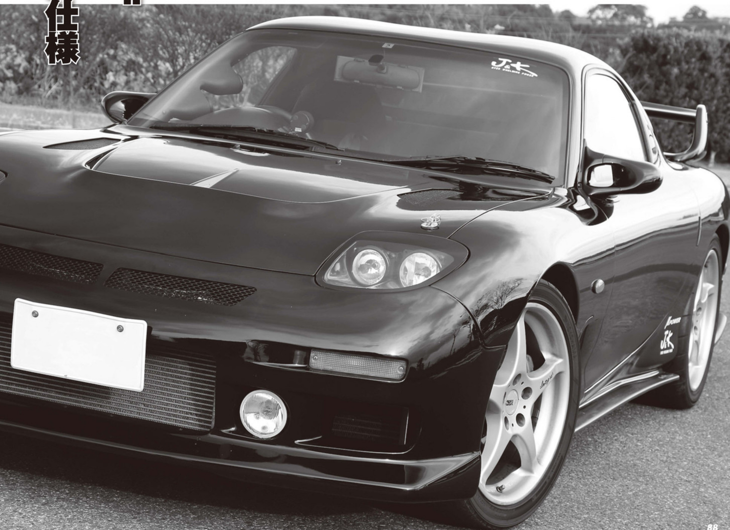
最大ブースト圧は1.0kg/cm 2 近辺。2500rpmあたりから過給され、 3000rpmでは30kgf-mのトルクを発生する。低回転側にパワーゾ ーンを広げることで、全域での加速が可能となる。
