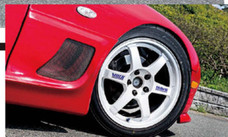
ホイールはレイズの定番軽量モデル、TE37。サイズは17インチ。ブレーキパッドはドリームファクトリーのオリジナル品に変更。
