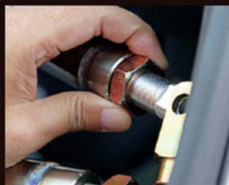
アップグレードキットの取り付けも基本的にボルトオンで行う。まずはブラケットの角度を決定し、パイプの長さを調整していく。
