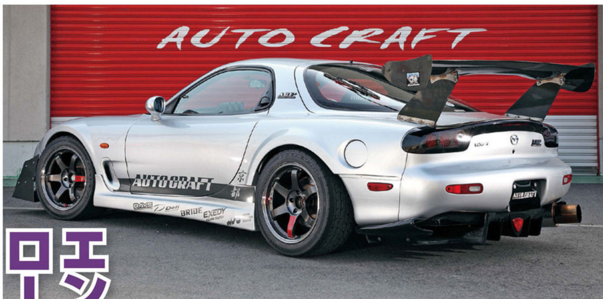
カナードやGTウイングで空力のバランスを調整。コーナーでの安定性を高め、旋回スピードを引き上げていく方向でセットアップ。
