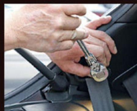
ピラーに接合されているシートベルトアンカーを取り外す。アンカーボルトの取り外しには17mmのボックスを使う。
