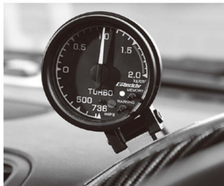
最大ブースト圧は1.0kg/cm 2 近辺。2500rpmあたりから過給され、 3000rpmでは30kgf-mのトルクを発生する。低回転側にパワーゾ ーンを広げることで、全域での加速が可能となる。
