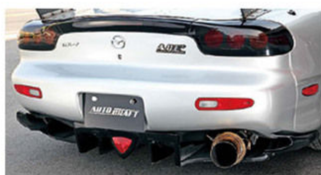
専用設計のリヤディフューザーのほか、RX-8純正フォグの流用に対応したフォグケースをラインアップ。両サイドに装着するポーテックシュラウドも発売。
