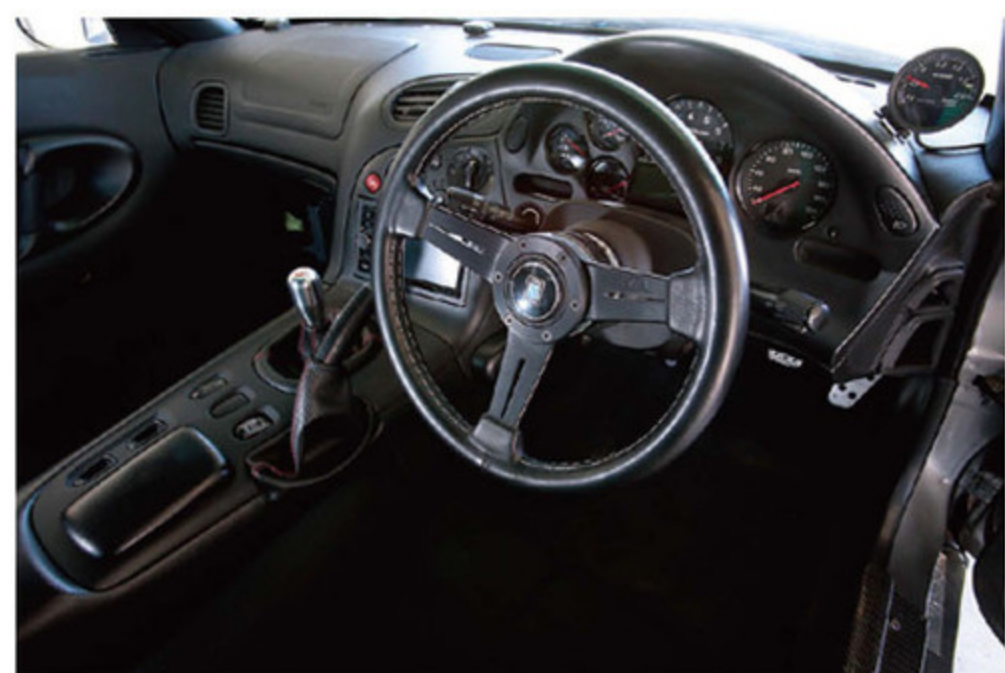
追加メーターは最小限に抑え、さらにはエアコンやカーナビも備えるなど、驚愕タイムを叩き出すタイムアタック仕様とは思えないコックピット。Hパターンミッションでのアタックを貫くのもフジタの強いこだわり。
