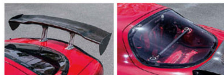
内装を取り去った他、リアハッチをアクリル製に変更するなど、軽量化を徹底。GTウイングは実走を通じ、必要性が感じられたため装着。
