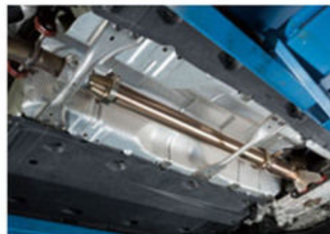
ライトユーザーでもチョイスしておきたいのがダウンパイプ。メタルキャタライザーによる排気効率改善で、タービンにかかるストレスが解放できる。
