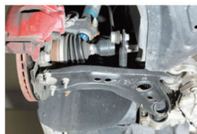
フロントロアアームは鉄板をプレスして成型したものだが、肉厚で見た目からして剛性が高そう。ナックル側支持部もがっちり固定されているのがわかる。
