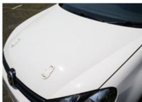
ボンネットのピンのみが外装で唯一変更されているもの。これはFRP製のボンネットが高速域でばたかないように、あくまで機能面での配慮から。
