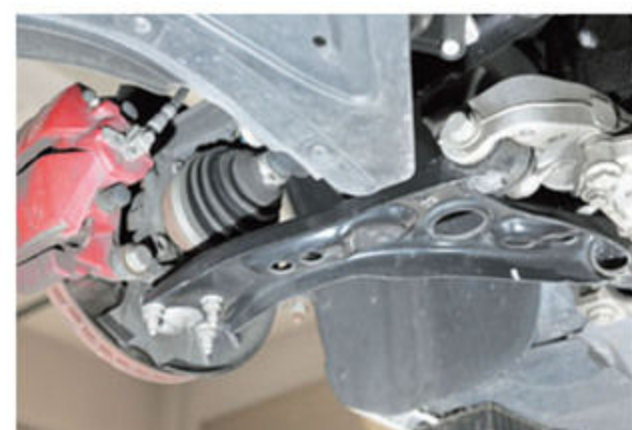
フロントロアアームの長さも十分すぎるもの。同サイズの国産車と比べると、その長さは際立っている。これもサスの動きがもっともよい状態を考えてのもの。
