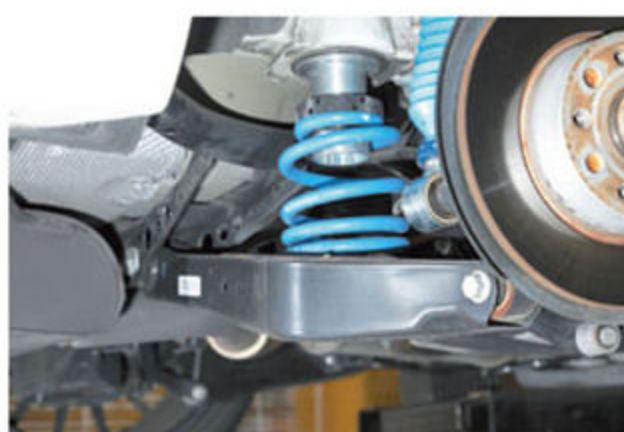
リアスプリングはロアアームによって支えられている。こういう形のサスペンションとしてはスプリングの自由調は長い。ビルシュタインの車高調整は上側で実現。
