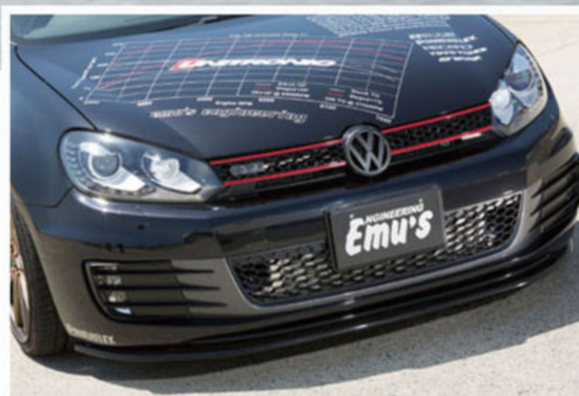
フロント開口部でアピールするワンオフインタークーラー。リップスポイラーとのマッチングで精悍なフェイスをアピールする。
