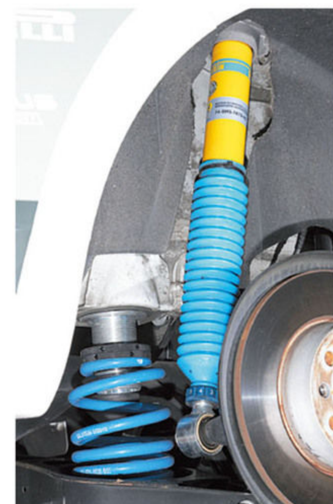
リアサスペンションはスプリングとショックアブソーバー別体式。ショックは長く、その下側取り付け位置はレバー比も考慮してボディ内側にオフセットされる。
