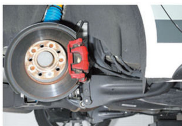
ロアアームだけではなく、前側からアームを引っ張っているトレーリングアームや、その上にあるトーコントロールアームも長く、タイヤの角度変化が小さい。
