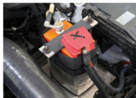
バッテリーも小型化のリチウムイオン製に交換。小さすぎて不安になるぐらいだが十分な電圧を確保できるという。
