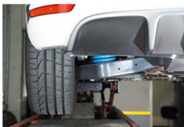
リアのロアアームは4モーションのデフが入るギリギリのスペースを残し、限界まで長くとられている。そんな当たり前のことを当たり前にしているところがすごい。
