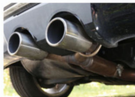
ターボバックマフラーに交換されているが出口をあえてノーマル風に加工している。音量は迫力あるが見た目は普通。
