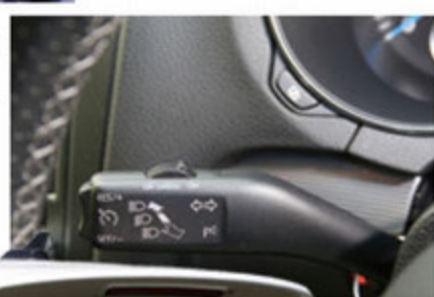
室内にも手を加えられていない。マッピングの切り替えは、純正のクルーズコントロールレバーで行えるようになっている。
