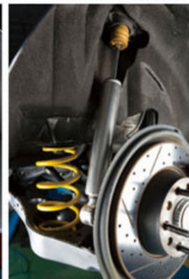
ノーマル状態でもロアアームプッシュを強化するだけで走りの質は一気に向上。パワーフレックスの強化プッシュは硬度95と80が用意される。
