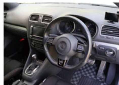
室内にも手を加えられていない。マッピングの切り替えは、純正のクルーズコントロールレバーで行えるようになっている。
