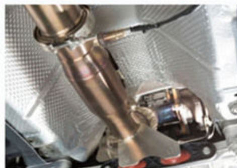
後方排気レイアウトであるためタービン交換時は重作業となるが、その投入効果は上々。モアパワーを求めるユーザーはK04タービンを要チェックだ。
