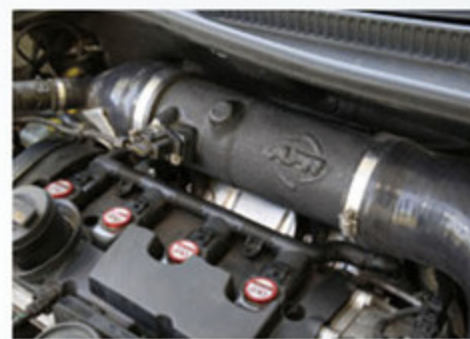
APRのパイピングがタービンに向かう。ビッグパワーを生み出すには、まずは吸気効率を高めていく必要がある。
