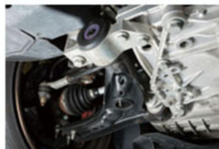
ノーマル状態でもロアアームプッシュを強化するだけで走りの質は一気に向上。パワーフレックスの強化プッシュは硬度95と80が用意される。
