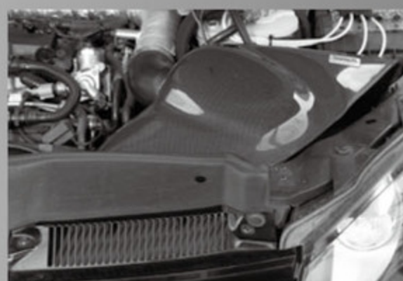
ダイレクトタイプは全方向から空気を吸うことができるが熱気も吸い込みやすい。熱気を防ぎ走行風の圧力を利用できるラムエアシステムはオススメ。
