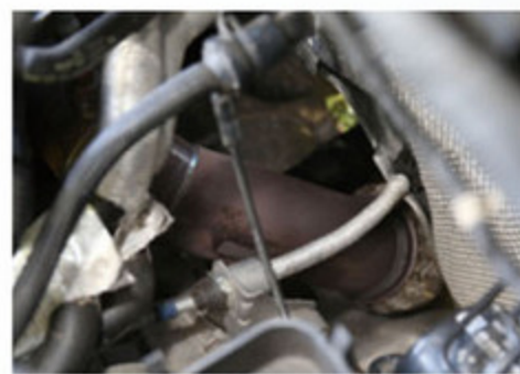
インマニの奥にある過給器は、APRのGTXタービンをチョイス。473馬力というハイパワーを絞り出す原動力となっている。
