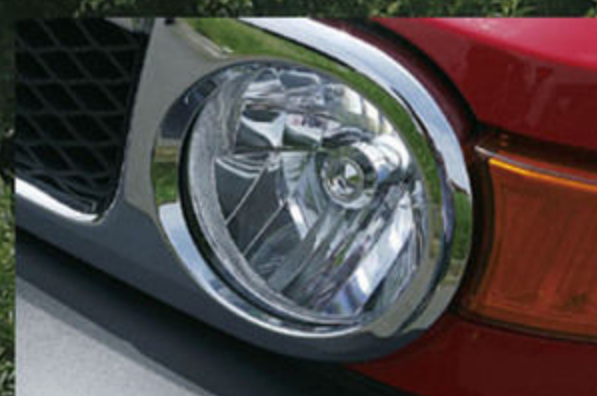
ヘッドライトはLEDランプを装着。ノーマル然としたルックスながら、優れた照射性と耐久性で、夜間の視界確保に貢献する。
