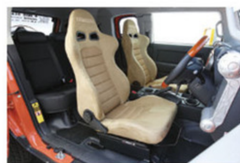
シートはブリッドのユーロスター。専用のレールにより、ポジションが純正位置より下がらないように設計されている。
