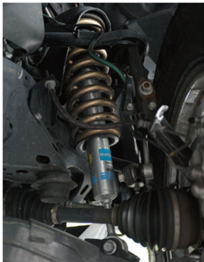
サスペンションはオーバー3インチのオリジナルマウントキット。ビルシュタインダンパー、ラテラルロッド、ラチェットの組み合わせだ。
