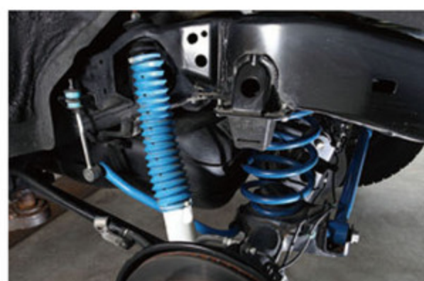
リアは、定評のあるビッグカンントリーエキップの8段調整。「エキップ」は高性能版の証だ。純正でありながら段差を越える際のコツコツとした嫌な感じが解消できるセッティングとしている。試乗の報告はP89に。
