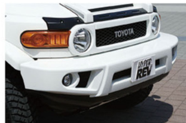
バンパーは剛性面に優れるRTM製法を採用。ルックスだけではなく、機能もしっかり確保するのがJAOS流。フォグランプは別売りだ。
