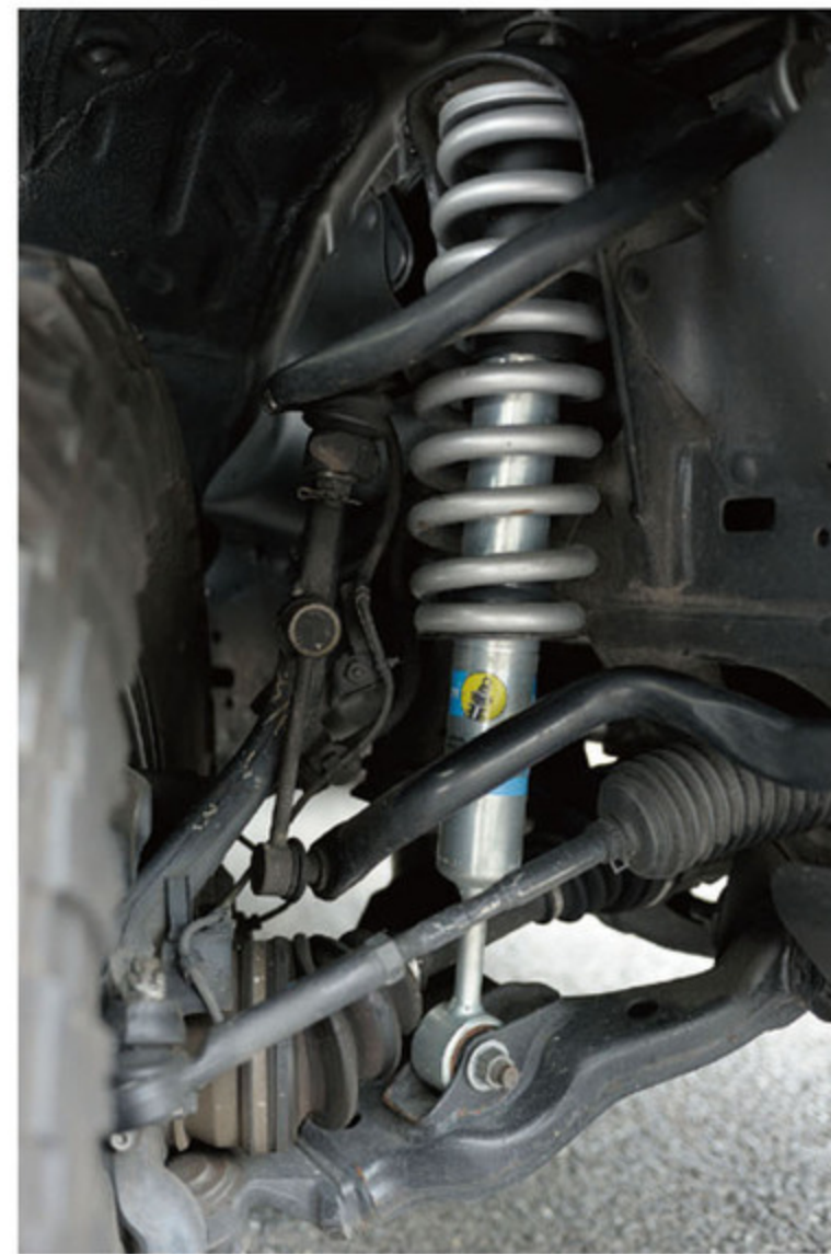
リフトアップは「ノーマルパーツを活かした限界点」と言われる2.5インチアップ。ビルシュタインダンパーとの組み合わせでロールを抑え、クイックな操作感を実現。
