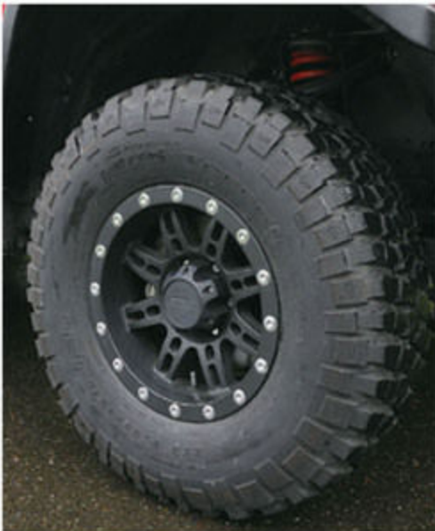
フロント3インチ、リア2インチのリフトアップが図られ、泥濘地だけでなくターマックをも快適に駆け抜ける。フラットブラックが印象的なプロコンプ7031ホイールとBFグッドリッチ・マッドテレレン305/70R16のコンビ。
