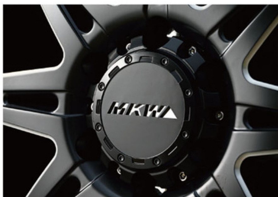
センターキャップは留めビスで固定。中央のMKWのロゴは、中をくり抜いて、裏側からメッキを貼っている。ミリング部分との統一感を意識。
