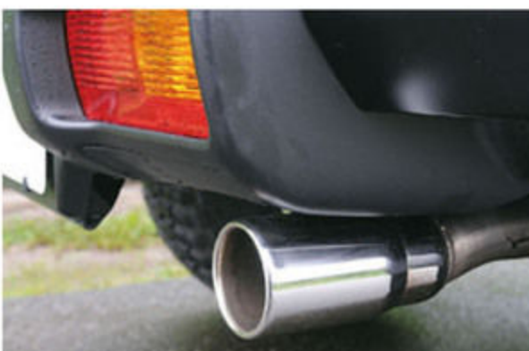
基本的にエキゾーストはノーマルの状態を保っているが、エンドには89.1φのマフラーフィニッシャーがワンポイントとして与えられている。
