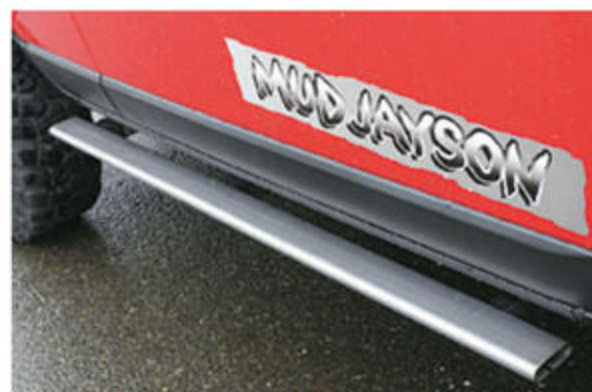
スチール製のサイドステップは試作品となるが、このデザインをベースに製品化が決定。質実剛健なオフロードの達人らしいアイテム。
