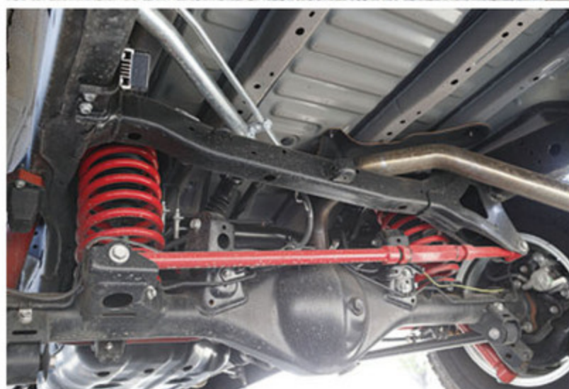
サスペンションはKONIのHEVY TRACKとJAOSのBATTLEZ×SUS type DT140スプリングの組み合わせ。ラテラルロッドやスタビライザーも交換済み。
