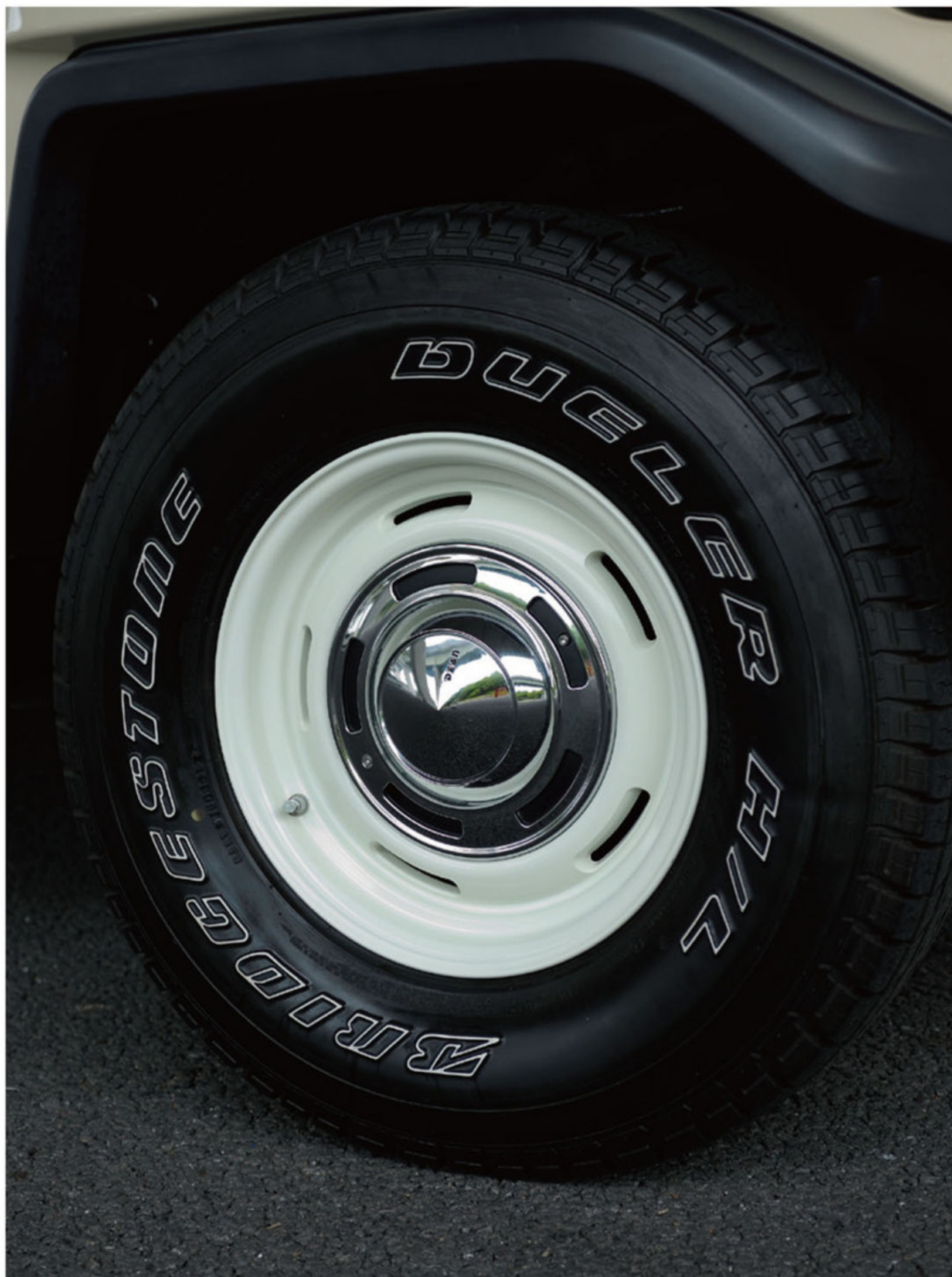
パッと見はレトロ感溢れる『テッチン』だが、アルミ製。タイヤはブリヂストンのDUELER H/L LT265/75/R16。
