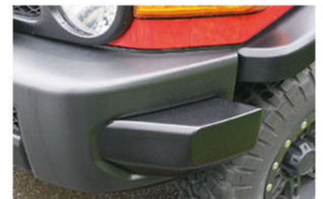
フロント、リア共に北米仕様のサイドバンパーに交換されている。細かな部分だが、カスタムへのこだわりが表現される部分だ。
