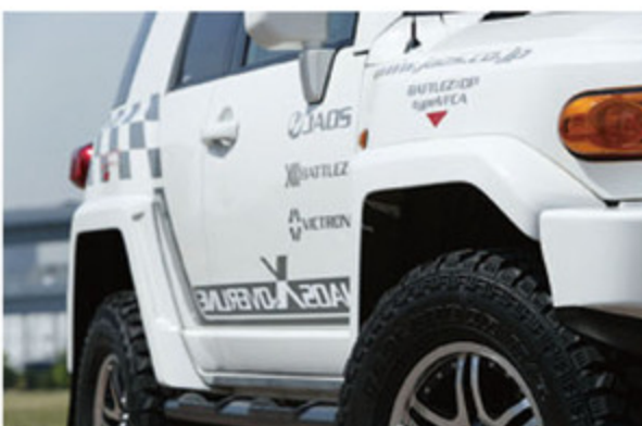
保安基準（20mm以内）に収まるよう、片側9mmずつワイドになった前後フェンダー。ダクト風のデザインも、ボリュームアップに役買っている。
