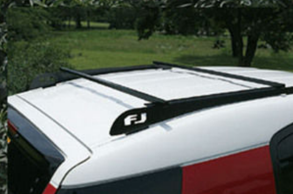
FJクルーザーのルーフラインにマッチする専用デザインのルーフラック。一般的なシステムキャリアが使用できるように、約32×23mmのバーを標準装備する。取り付け高が標準ルーフから+70mm以内という点も嬉しい。
