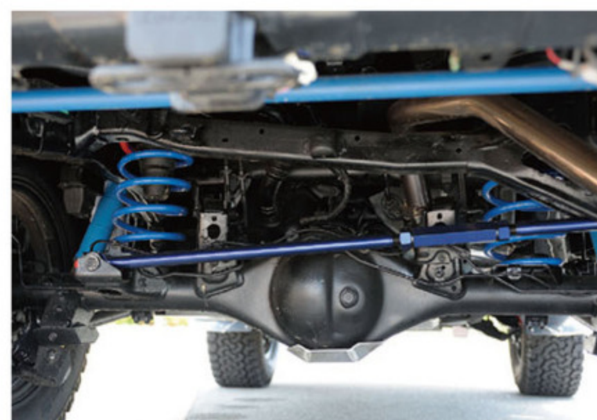
リフトアップした下面から覗くブルーのセミハードコイルスプリングは、性能はもとより見た目のインパクトも強くカスタム要素も強い。
