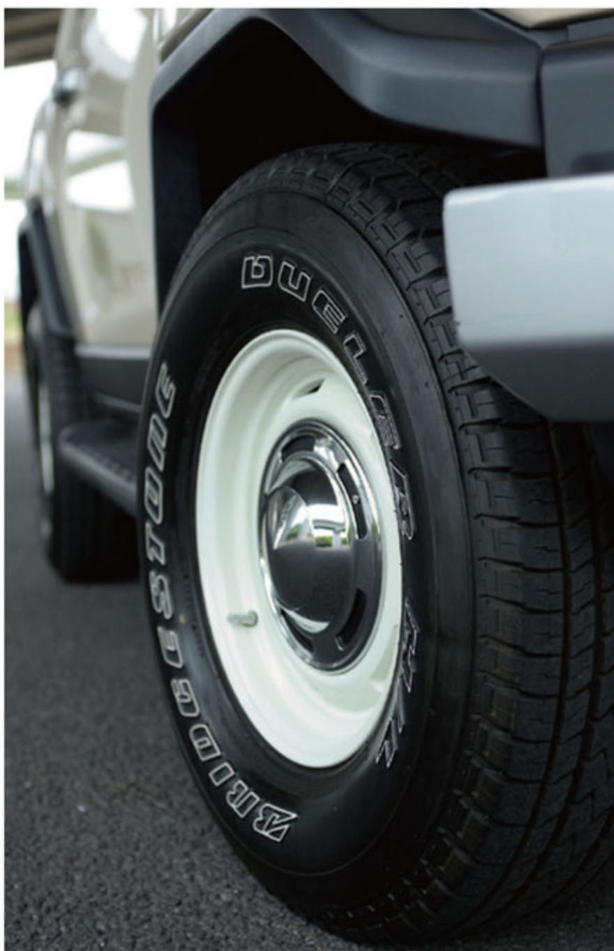
パッと見はレトロ感溢れる『テッチン』だが、アルミ製。タイヤはブリヂストンのDUELER H/L LT265/75/R16。
