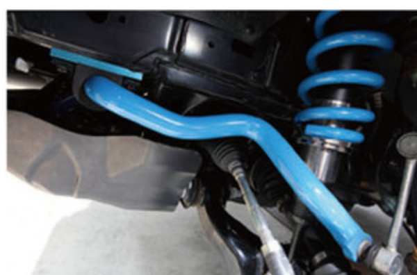
右端が新開発の車高調。現在、耐久テストも大詰めを迎えている。リフトアップ量はマイナス15mmからプラス25mmの範囲。クルージングスタビライザー（フロントは31φ）がしっかりとロールを抑え込んでくれる。
