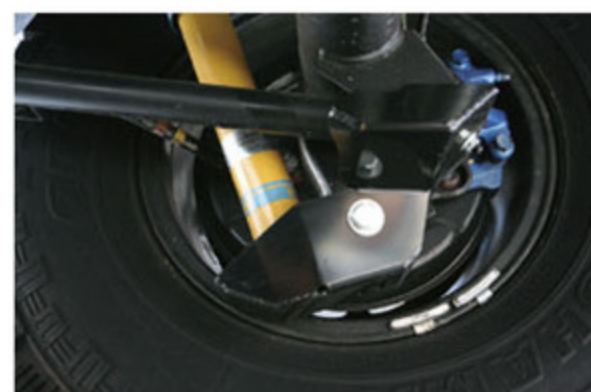
サスペンションを保護するモトレージリアショック&ロアリンクガード。コース走行を想定しているなら、万が一に備えてサスペンションと一緒にこのパーツも手に入れておきたい。
