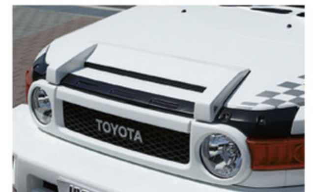
イカつさを強調するボンネットガーニッシュ。14年春発売になったばかりの新商品だ。中のメッシュ部はダミー。本体の一部を黒で塗装している。
