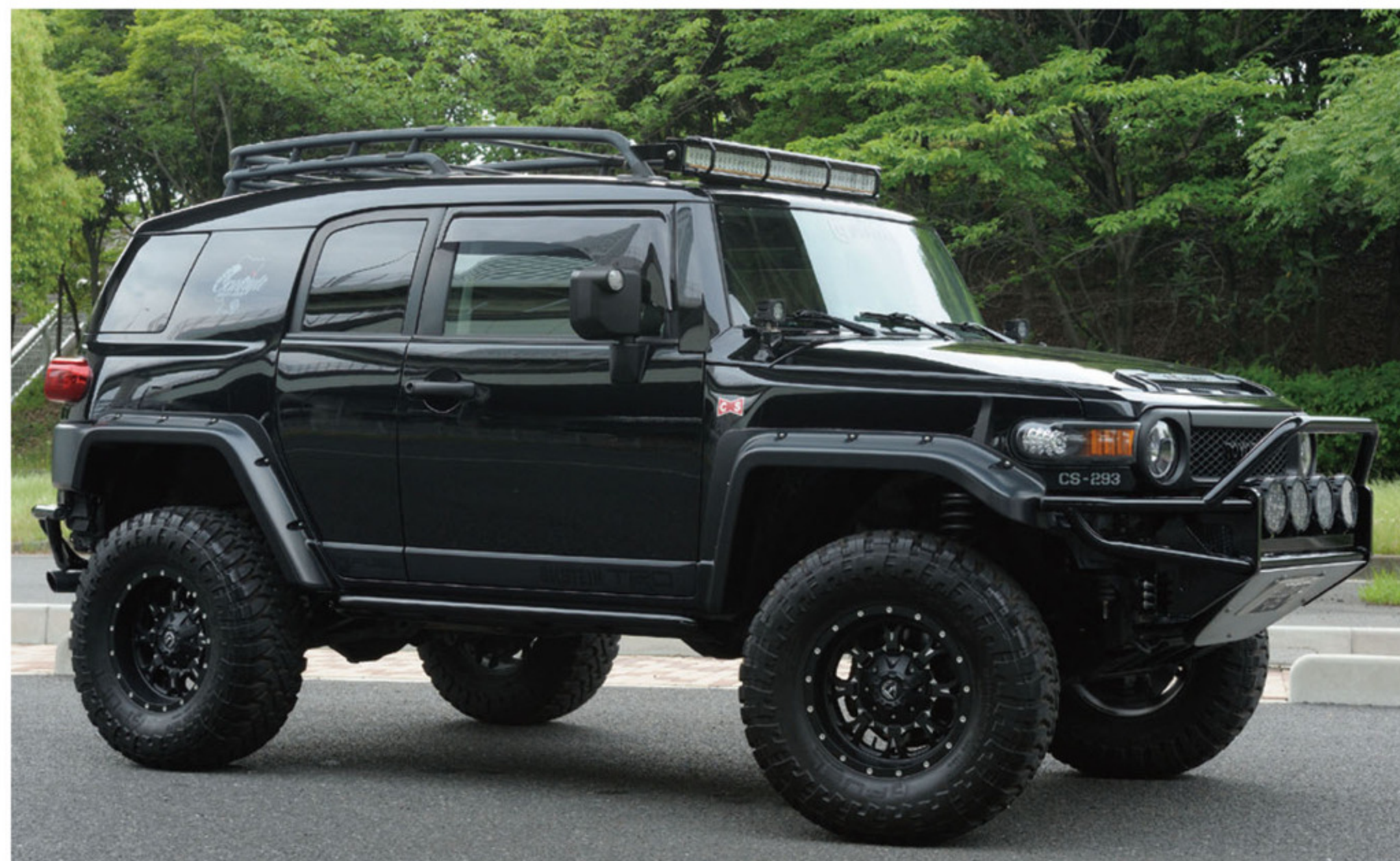
リフトアップは「ノーマルパーツを活かした限界点」と言われる2.5インチアップ。ビルシュタインダンパーとの組み合わせでロールを抑え、クイックな操作感を実現。
