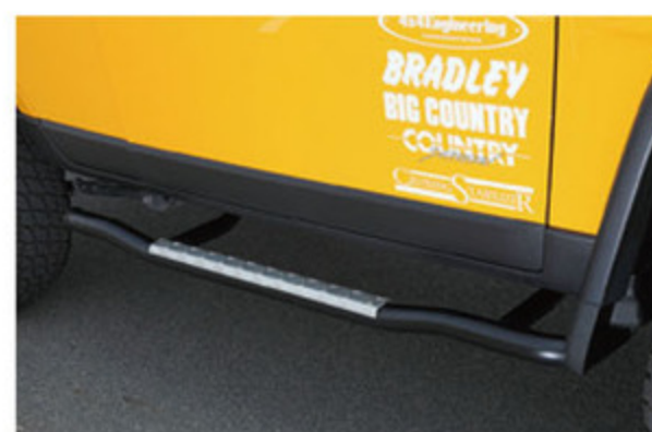
サイドにワンポイントを加えるサイドステップは試作品。とはいえ、手を抜くことなく、フレームにボルトオンする本格派。縞鋼板が雰囲気アップに貢献している。サイドのデカールも上品なレイアウト。
