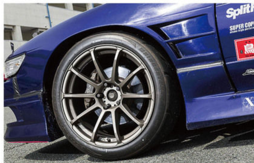
CTSのホイールにポテンザのRE55Sを履き、セクションのRM/A8車高調と、クスコ・フロントスタビライザーでフロントを制御。また、フロントにのみアシストスプリングを入れたところ、足が動きすぎない好結果につながった。
