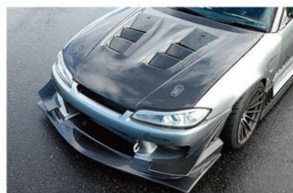
カーボン仕上げとなるエアロパーツやボンネットは、機能面まで考え抜かれたレーシーなデザイン。強力なダウンフォースを生み出すほか、冷却性アップにも貢献する。
