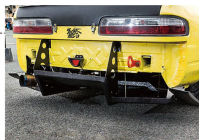
前後にはオリジナルの空力パーツを装備。FRP製作を得意とするだけに、軽量化と空力改善に細かく対策できるのが強み。「リヤより効きすぎた感があるので、フロントを見直してバランスを取りたいですね」と、データ収集にも余念はない。
