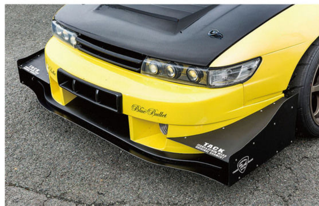
前後にはオリジナルの空力パーツを装備。FRP製作を得意とするだけに、軽量化と空力改善に細かく対策できるのが強み。「リヤより効きすぎた感があるので、フロントを見直してバランスを取りたいですね」と、データ収集にも余念はない。
