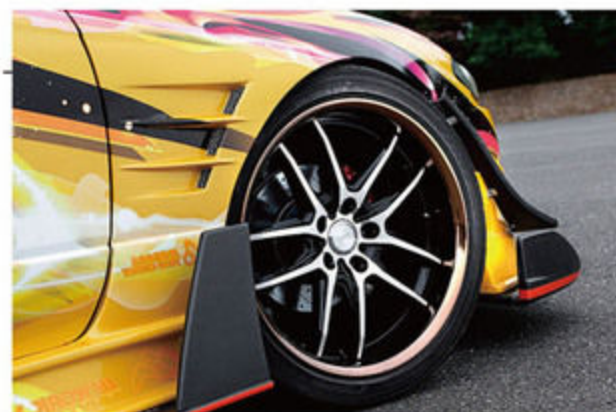
ホイールはワークXSA04C。リム内部がブラックアウトされ、リムはボディに合わせたゴールドとなっている。装着サイズは前後とも9.5J×18 +12。タイヤはアドバンネオバAD08Rの255/35を組み合わせる。
