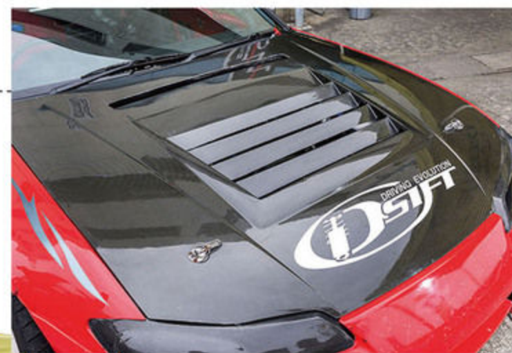
もともとあったダクトの上位に、さらに新たな通風口を設けたカーボンボンネット。軽量化策のひとつでもあるが、エンジンルームの熱を排出する役割も担っている。
