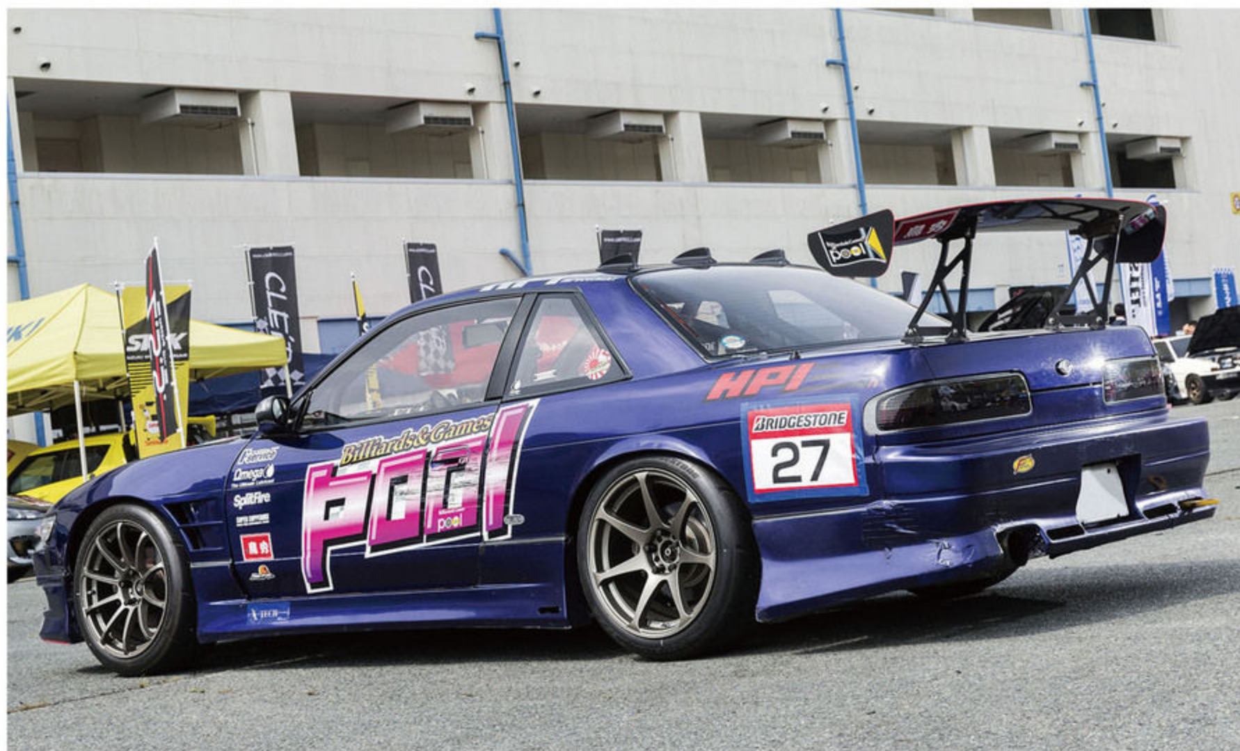
CTSのホイールにポテンザのRE55Sを履き、セクションのRM/A8車高調と、クスコ・フロントスタビライザーでフロントを制御。また、フロントにのみアシストスプリングを入れたところ、足が動きすぎない好結果につながった。
