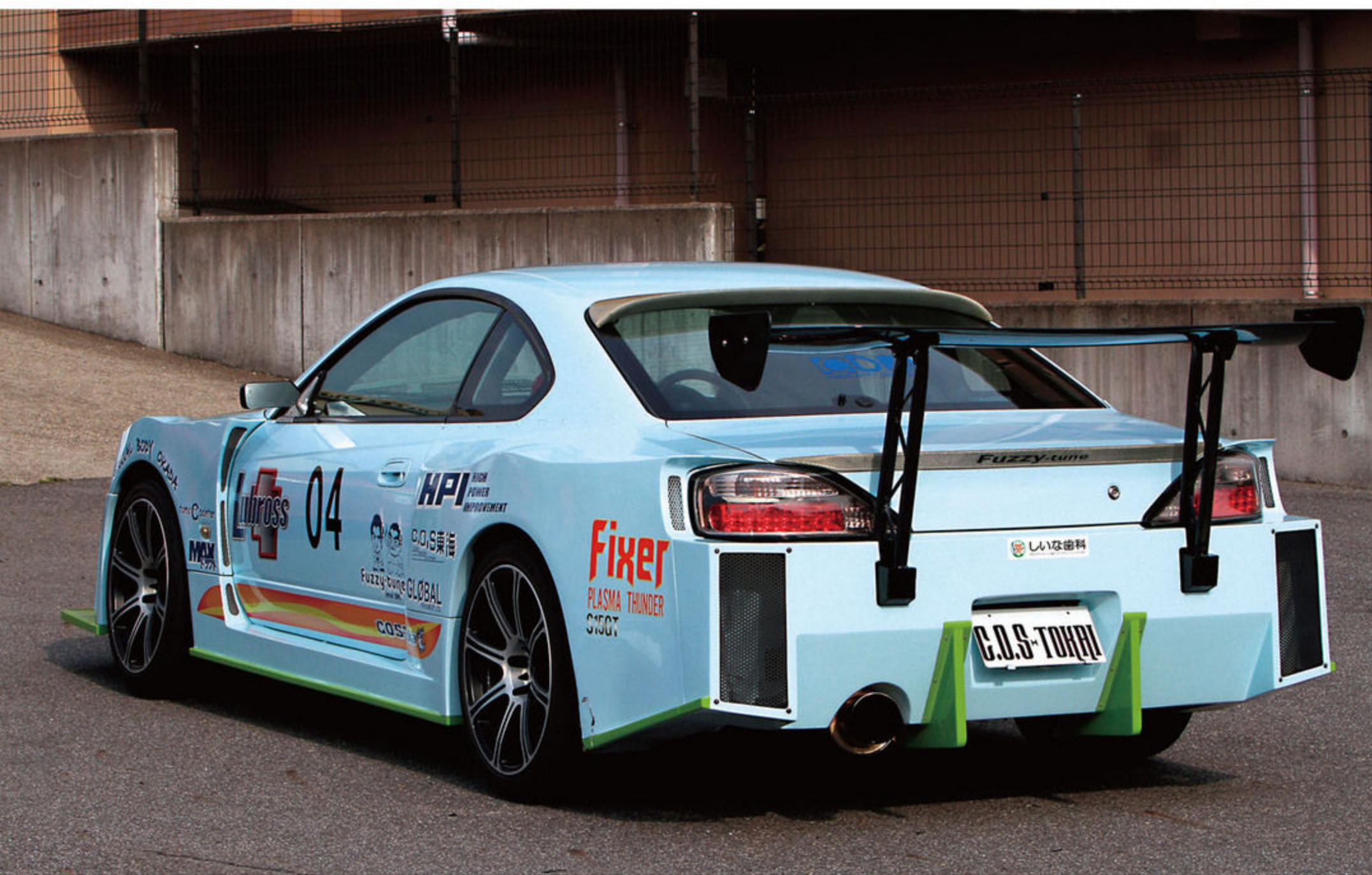
片側50mmワイドのエアロキットはFixer製を使用。スクエアな造形を持つ派手なスタイリングはもちろん、ほとんど加工することなく取り付けられるフィッティングもポイント。
