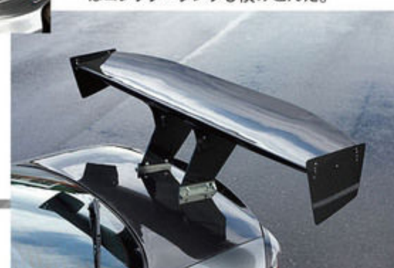
トランクやGTウイングもオリジナルのカーボン仕立て。3D形状になっており強力なダウンフォースを生み出す。また、トランク内にはコレクタータンクも積みこんだ。
