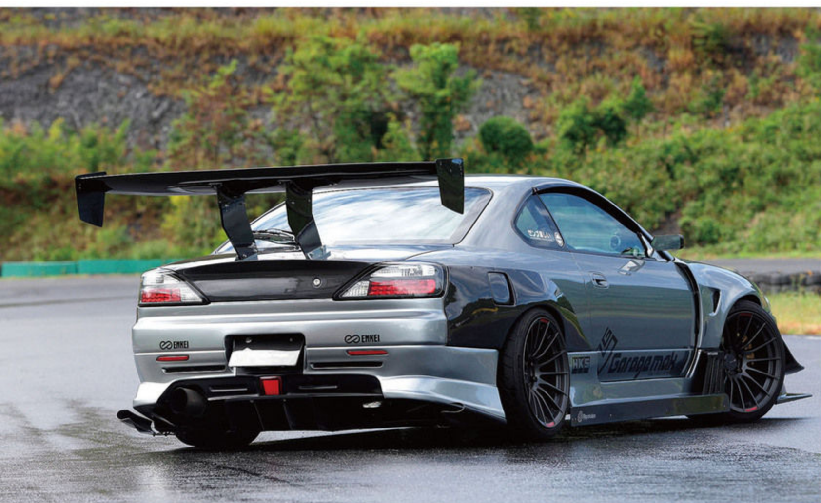
カーボン仕上げとなるエアロパーツやボンネットは、機能面まで考え抜かれたレーシーなデザイン。強力なダウンフォースを生み出すほか、冷却性アップにも貢献する。
