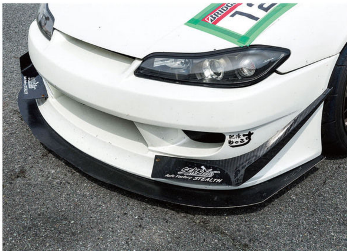
サーキット仕様車では定番と言えるカーボンボンネットも、コストパフォーマンスの面からあえて装着していない。カナードも、できるだけ手ごろな価格の製品をチョイスした。ディフューザーにいたっては樹脂板を切り出したオリジナル。
