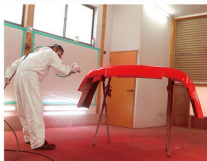
透明感の高いペイントはクリア塗料へのこだわりがポイント。高価な2:1タイプのクリア塗料をSATA製のガンを使って作業している。塗装後年数が経っても、鮮やかさが持続するのが自慢だ。
