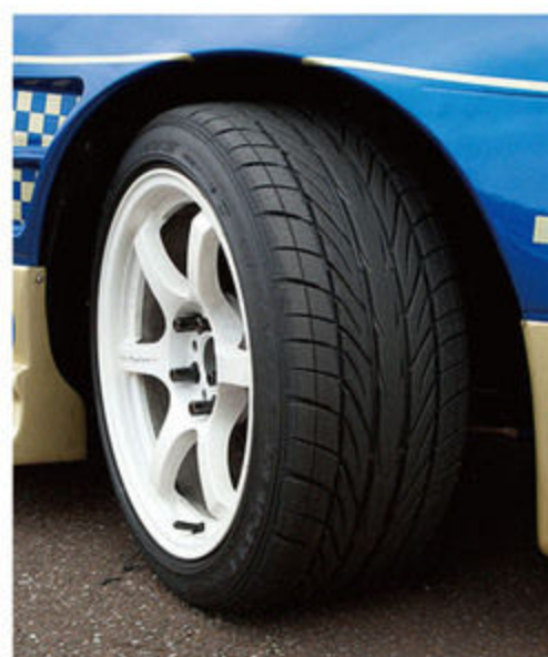
ホイールはレイズのグラムライツ57D。タイヤはレブスベック。ドリフトでの激しい消耗に対応して17インチをチョイス。今回はグリップ走行での試乗に合わせて、スペーサーの追加とアライメント変更を行っている。
