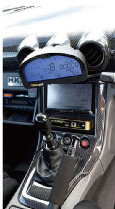
元々はAT仕様だったが、ハイパワー化に伴い、HKSシーケンシャルドグMTに換装した。エンジン制御はFコンVプロで、レースバックiQ3も導入する。
