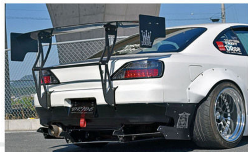
ウイング本体はオリジナルだが、ステーや翼端版はディライドオリジナル。フレームに直接マウントしていて、ルックスはもちろん、ウイングの機能も最大限活かせる。また、フェンダーをカットするのではなく、給油口をカットして見栄えを優先している。
