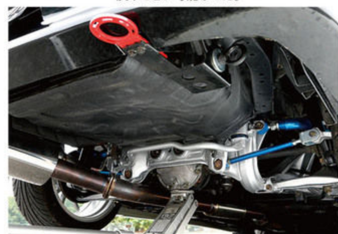
サスやメンバーの各ブッシュは、ニスモ製の強化品にすべて交換している。意外とおろそかにされがちだが、非常に重要なポイント。サスペンションの性能を発揮できるだけでなく、新車同様のフィーリングを取り戻すことが可能なのだ。
