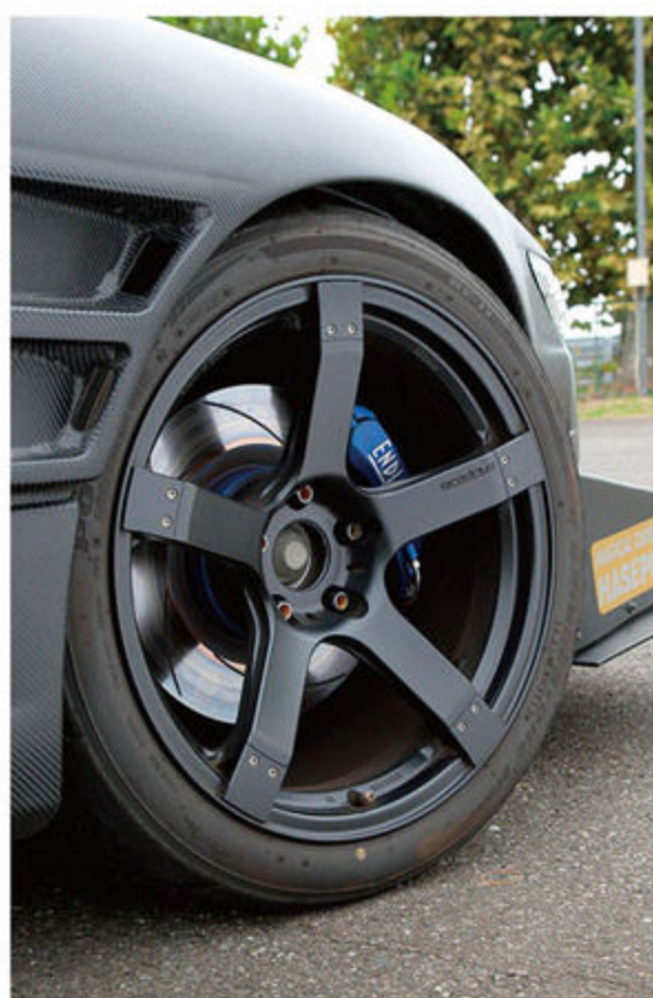
ホイールはプロドライブの鍛造ワンピース5本スポークのGC-05N。ワイド化されたボディに収まるのは、前後とも10J×18+15という迫力のサイズだ。タイヤはスタイヤのボテンザRE-11Sをチョイスしている。
