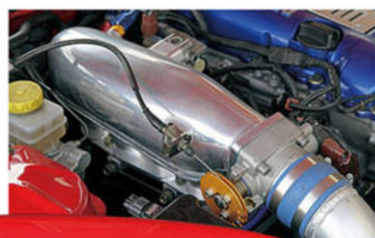
東名パワードの2.2Lコンプリートエンジンに、ナブレックのハイレブンスキットを組み合わせる。アベックスのパワーFCでマネージメントし、エアフロレス化も実施した。
