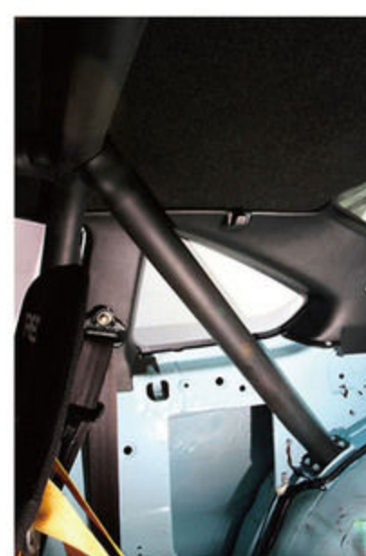
ロールオーバーは30mmほどかさ上げて装着。ルーフィングなど内張りとのクリアランスを確保しつつ、ある程度の乗降性を持たせるなどストリートマシンとして必要な性能も確保している。
