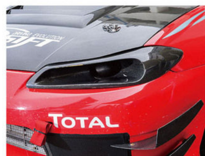
エアクリナーに効率的に外気を供給するヘッドライトインテーク。これによりフレッシュエアをダイレクトに引き込むことが可能となり、吸気効率を格段にアップさせている。
