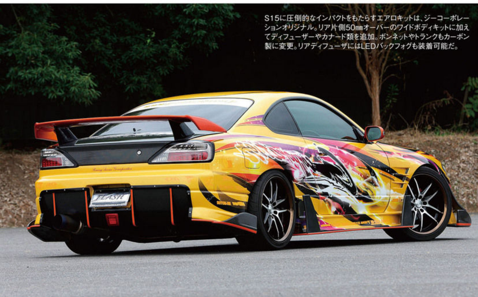
ホイールはワークXSA04C。リム内部がブラックアウトされ、リムはボディに合わせたゴールドとなっている。装着サイズは前後とも9.5J×18 +12。タイヤはアドバンネオバAD08Rの255/35を組み合わせる。
