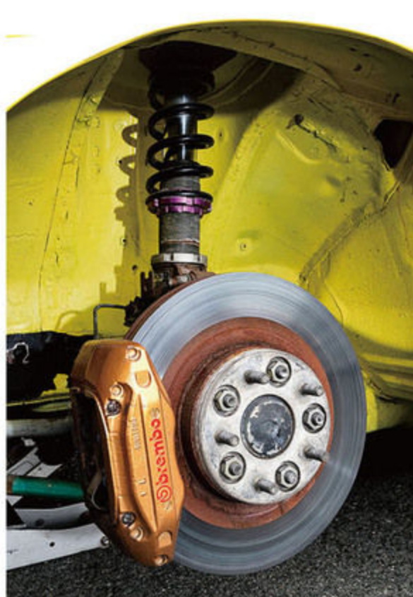
サスペンションはグリップ仕様にするためにリヤキャンバーを立て、トーアウトからゼロに戻した。スタビは中空構造となっているS15純正を選択。ブレーキは前後ともR33純正ブレンボを装着。ブレーキローターはディスクセル。
