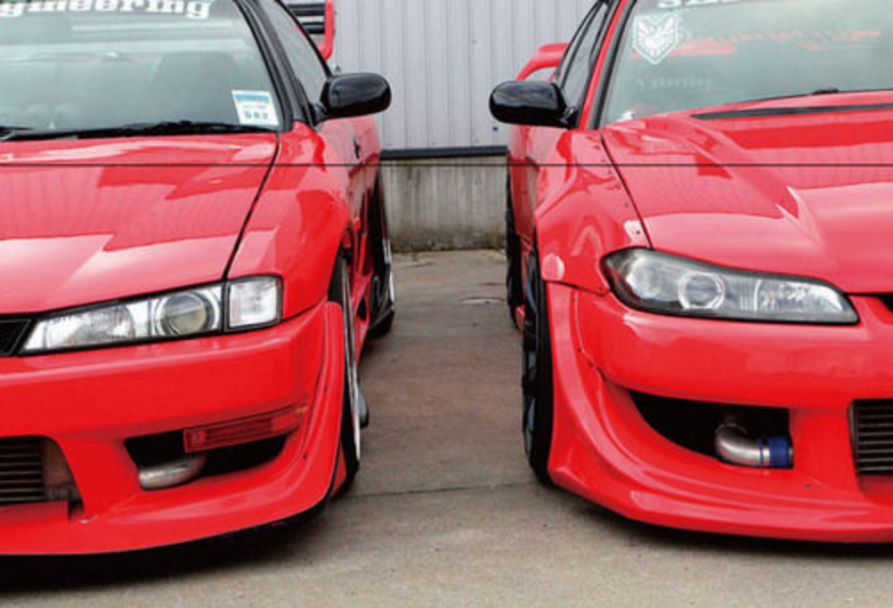
左のS15、右のS13とも、装着されているフロンツスポイラーはS15用。SHPエンジニアリングでは、エアロの幅変更や形状変更などもお手のもの。高い技術でばっちりフィットさせてくれる。
