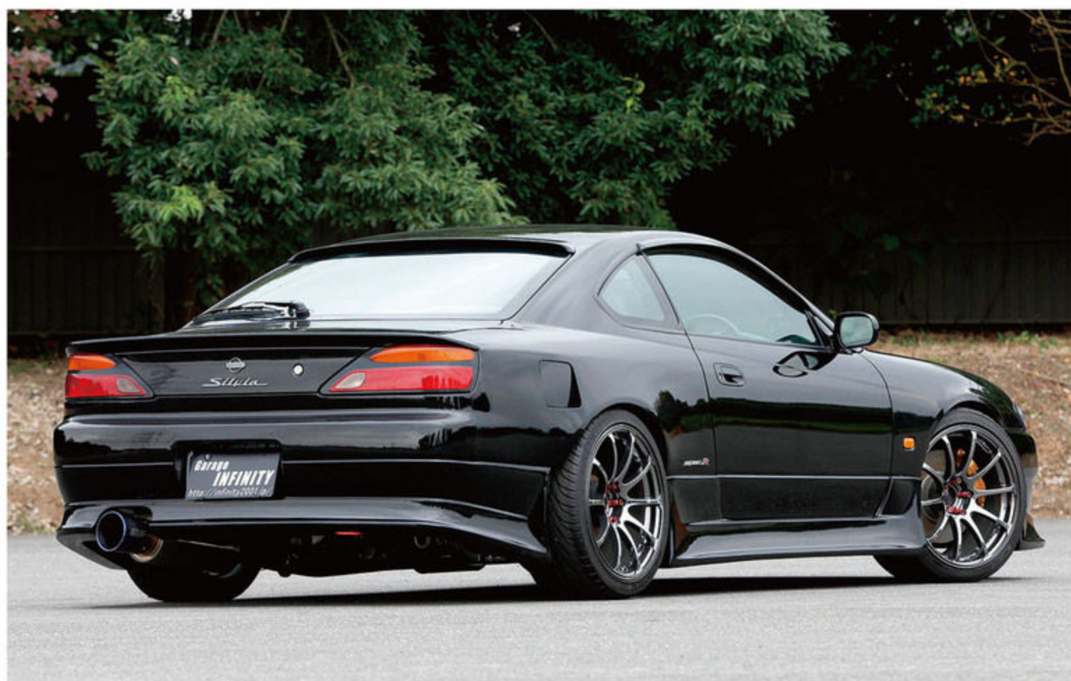
ウイングレスのオールブラック外装は、シンプルながら迫力十分な仕上がり。エアロはT&EのVERTEX LANG(フロント、サイド、リア)を装着。パテ埋め処理でボディとの一体感を追求した片側12mmワイドフェンダーと合わせて、ワイド&ロー感を演出している。
