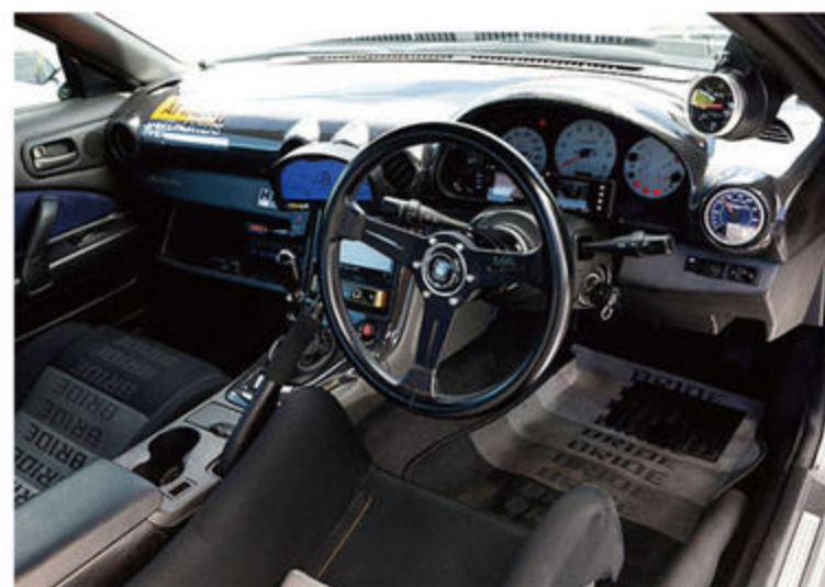
エアコンやナビはもちろん、内張りなどもそのままの快適スベックで、補強はロールバーを入れた程度。カーボンのダッシュボードカバー&センターコンソールはガレージマックのオリジナルだ。
