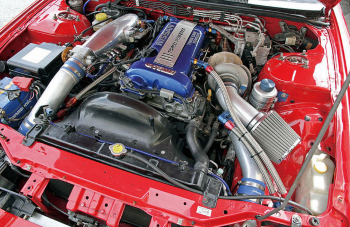
東名パワードの2.2Lコンプリートエンジンに、ナブレックのハイレブンスキットを組み合わせる。アベックスのパワーFCでマネージメントし、エアフロレス化も実施した。
