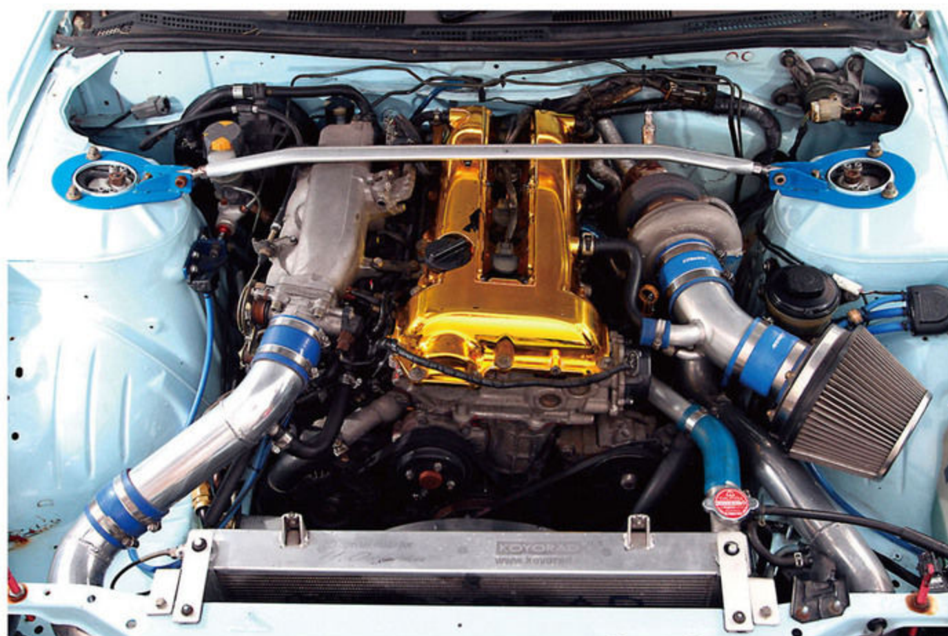
カムやピストンは既製品を使用しつつ、クランクやコンロッドは純正品を厳密なバランス取り&重量合わせのうえで使用。必要なスペックと照らし合わせて最善の選択を行うノウハウもユーザーに近い立場でチューニングを行っている証。
