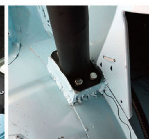
ロールオーバーは30mmほどかさ上げて装着。ルーフィングなど内張りとのクリアランスを確保しつつ、ある程度の乗降性を持たせるなどストリートマシンとして必要な性能も確保している。
