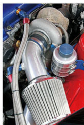
東名パワードの2.2Lコンプリートエンジンに、ナブレックのハイレブンスキットを組み合わせる。アベックスのパワーFCでマネージメントし、エアフロレス化も実施した。
