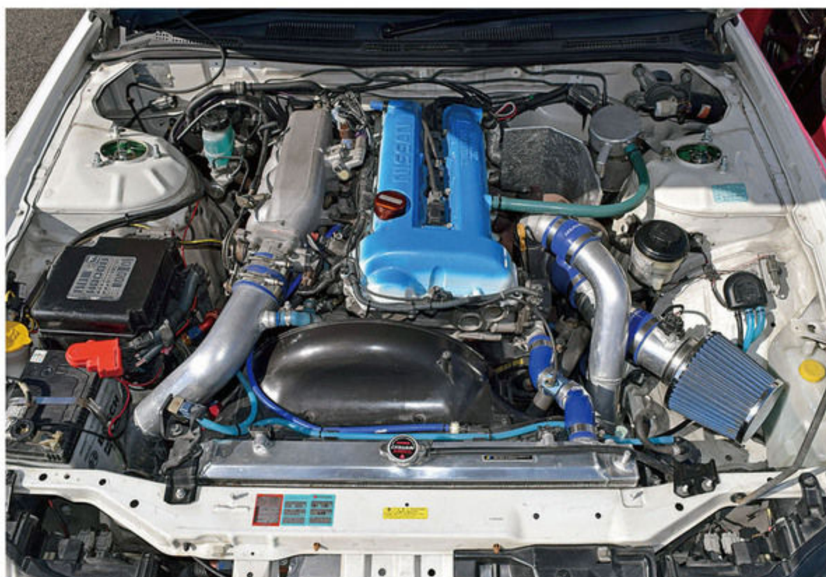
R35エアフロはレスポンスがよくなるので、ビッグタービンとの相性がいい。カムとタービンで高回転寄りの特性となっているが、備北サーキットの単走にはピッタリ。D1SLなど追走のある大会で勝つならセットアップも変わってくるそう。また、純正ミッションで耐えられるのは、独自に取り扱っているアッシュのオイルが効いているという。
