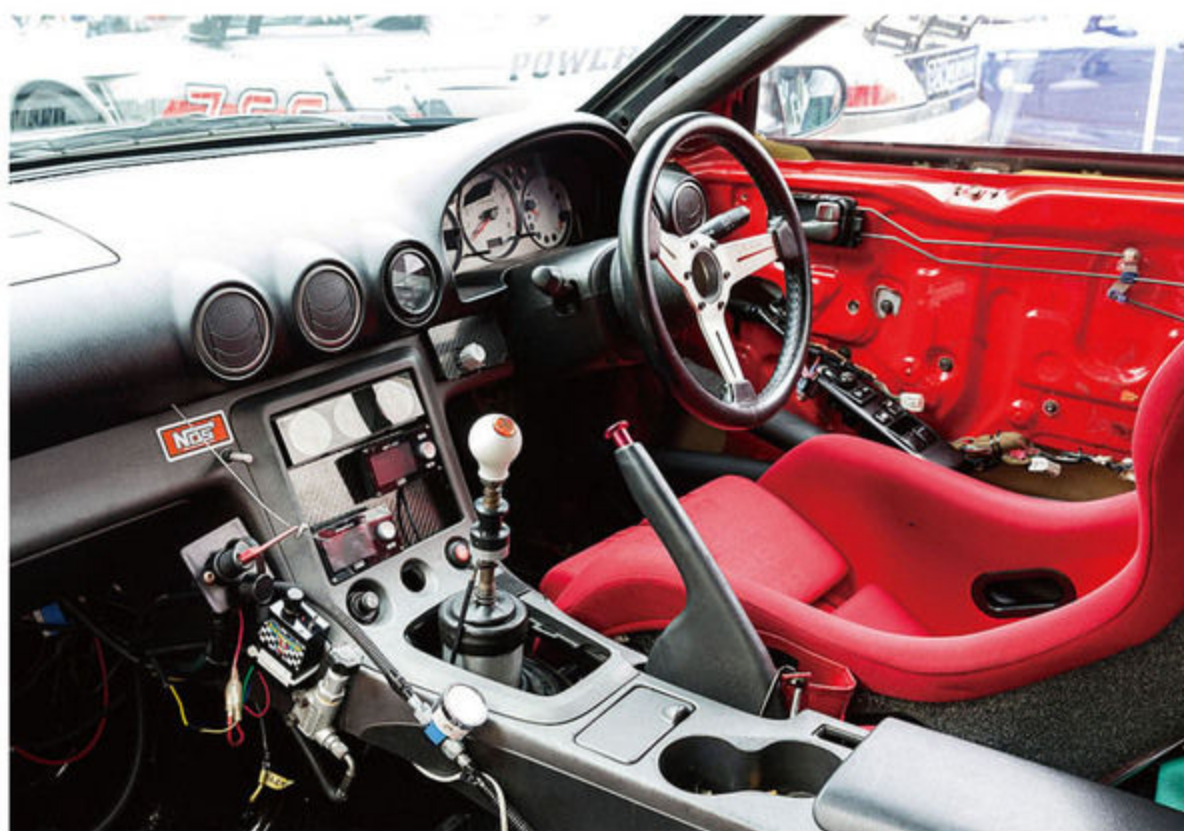
軽量化策として、一切の内張類を剥がした車室内。ロールバーも、軽量のクロモリ鋼12点式を装着。追加メーター類とブーストコントローラー、ノッキングメーター、NOSスイッチなどが、姿勢を崩さずに操作できる位置に配置されている。
