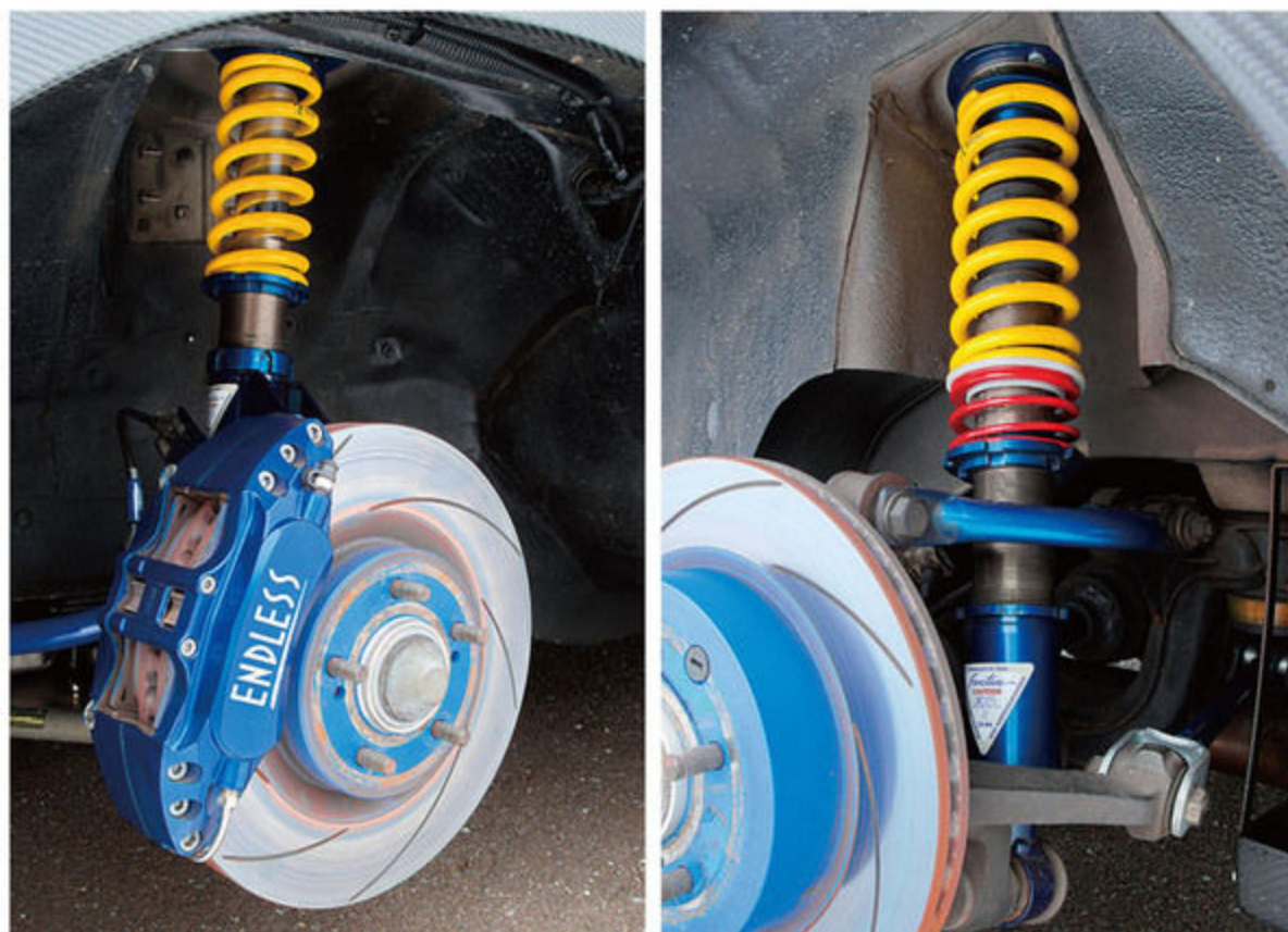
しっかり動く方向の減衰力設定でオーダーしたエンドレスのジール車高調。当初は赤いレース用のXコイルを組み合わせていたが、テストの結果黄色のストリート用スプリングへと変更している。
