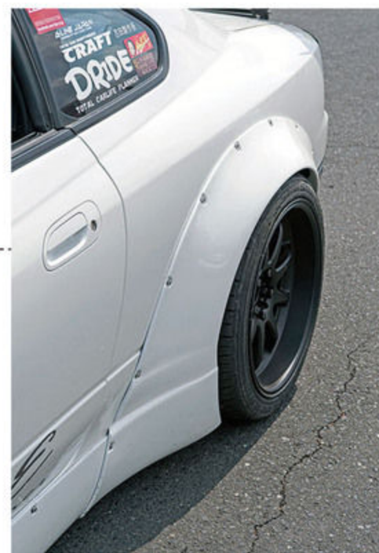
リアフェンダーは大掛かりな加工が必要で、上下の高さがまったく合わないで短縮している。クォーターに合わせて整形しているが、細かいプレスラインはそのまま。プリスターフェンダーではなくオーバーフェンダーのノリだ。固定はリベットではなくボルトなので破損時の修理も容易なのとか。
