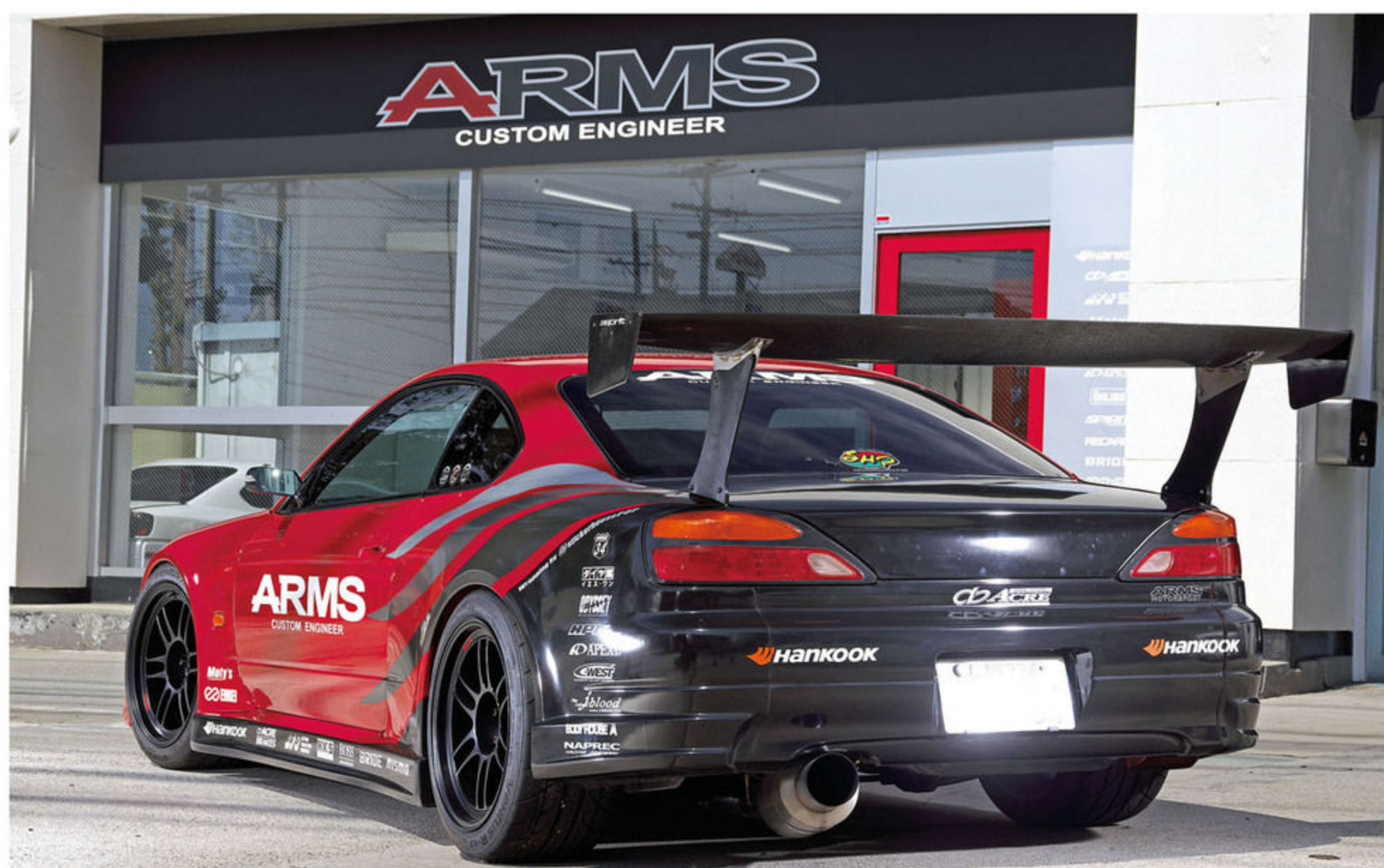
さすがにこのGTウイングだけは車検時に外さなければいけないものの、その他の部分はすべて車検対応で作られているところも特徴のひとつ。お金と時間があれば確実に同じものが作れるコンセプトもお手本にしやすい。
