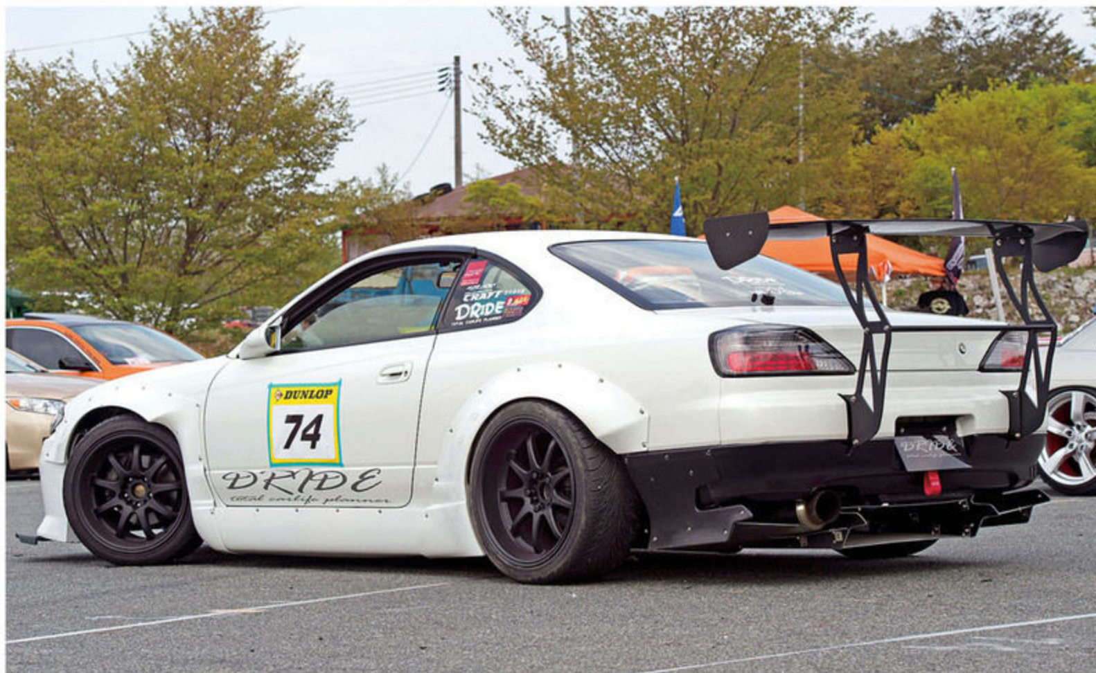
リアフェンダーは大掛かりな加工が必要で、上下の高さがまったく合わないで短縮している。クォーターに合わせて整形しているが、細かいプレスラインはそのまま。プリスターフェンダーではなくオーバーフェンダーのノリだ。固定はリベットではなくボルトなので破損時の修理も容易なのとか。
