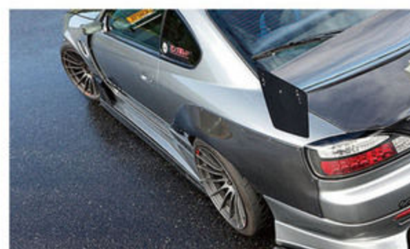
前後ともプリスターフェンダー化することで、グラマラスなルックスを構築する。タイヤをワイドトレッド化することで、安定した走りを手に入れることができる。
