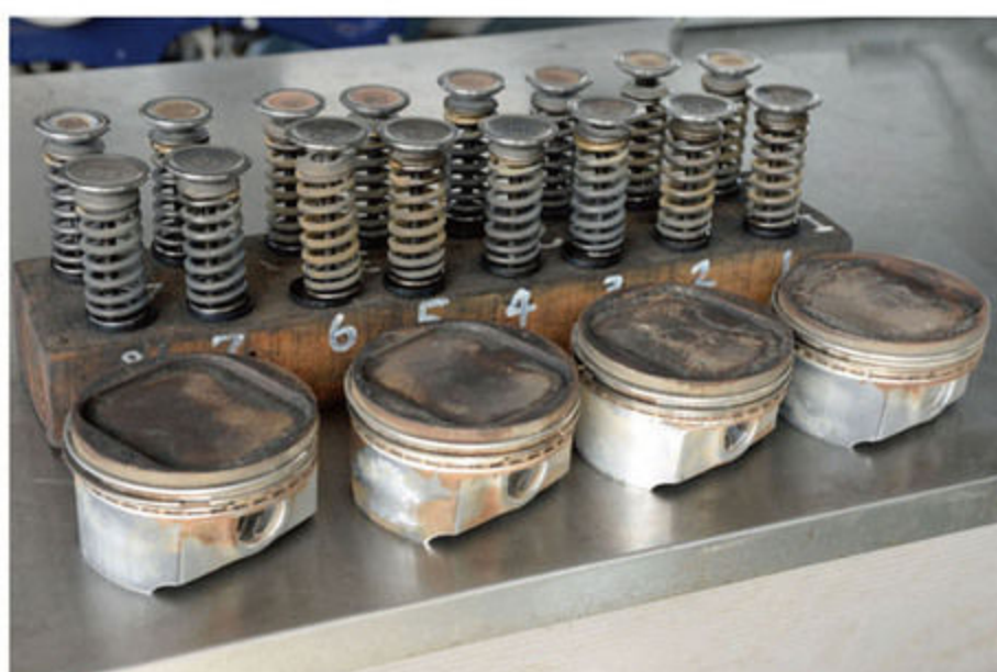
オーバーホール作業に入っていたEJは、目立った不具合はなさそうだった。基本的に破損がなければ部品は流用するが、メタルとピストンリングは新品を用いる。
