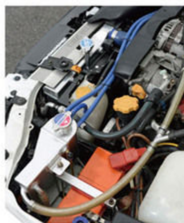
バッテリーは純正よりもはるかに軽い、レースストックのスーパーBバッテリーを装備。オーバーハング部の軽量化も気持ちのいい走りに効くメニューだ。
