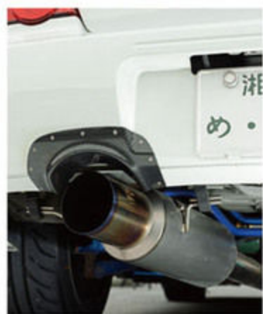
排気系はシムス製エキマニとアンリミテッドワークスのフルチタンマフラーの組み合わせ。排気効率もそうだが、軽量化とストリートでの音の静かさも特徴。
