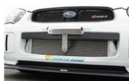
吸気系はK&NのエアシステムとHKS製前置きインタークーラーキット。純正ECUはこの吸排気系に合わせて現車セッティングされているため、ストレスなくきれいにまわる。
