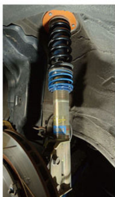
スタビ交換も含めてストリートでの気持ちいい走りをコンセプトにセッティング。とくに伸び側が締めすぎずフラフラせずという絶妙なので、4輪をきちんと使って走れる。
