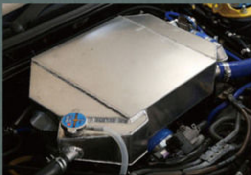
専用ラジエーターや電動ポンプなどを使ったシステムは、車両に合わせたワンオフ製作で、40万円前後になるという。
