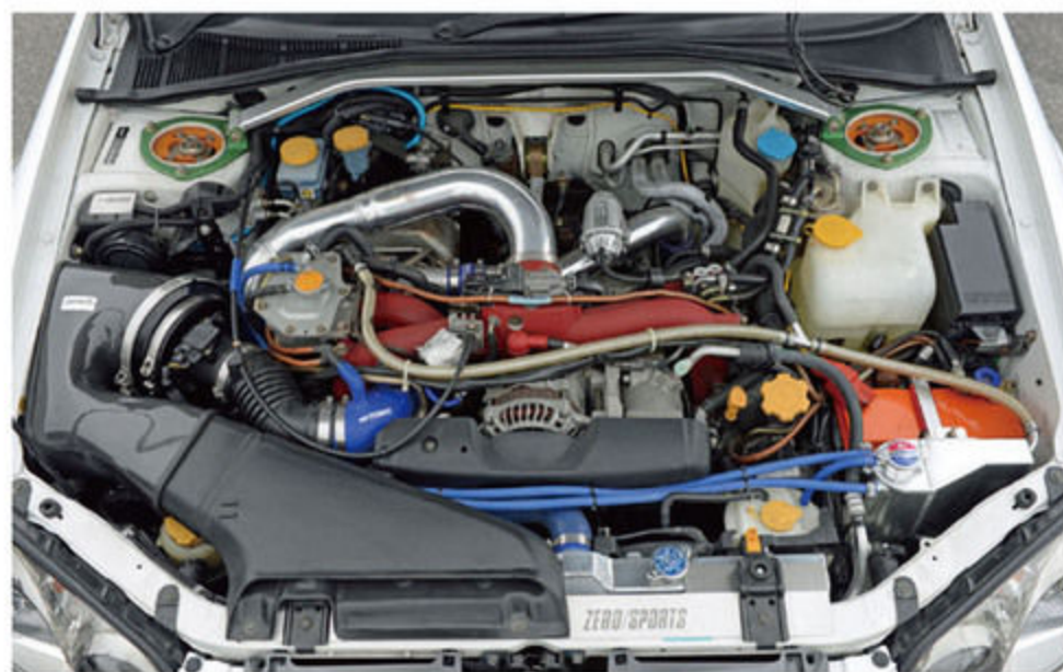
バッテリーは純正よりもはるかに軽い、レースストックのスーパーBバッテリーを装備。オーバーハング部の軽量化も気持ちのいい走りに効くメニューだ。
