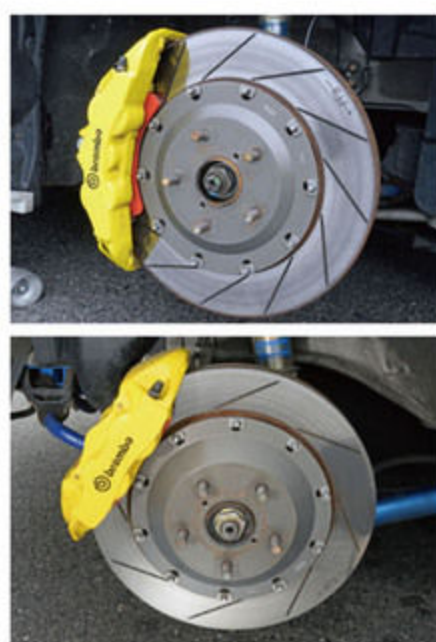
前後ともにローター径を拡大。とくにリアをフロントと同じ355φとしたことで、ハードブレーキでも姿勢が安定している。キャパがあるので連続走行も大丈夫。
