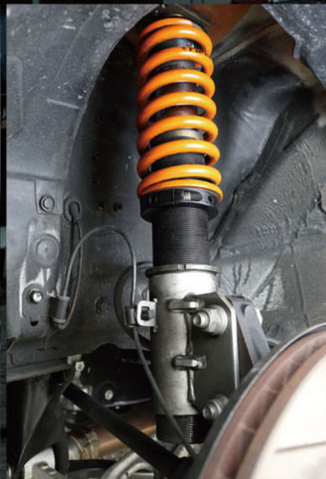
車高調はアラゴスタベースのオリジナル。バネレートはフロント9kg/mm、リア7kg/mmに設定し、幅広いステージをカバーする。
