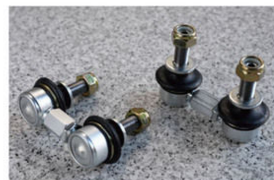
フロントのスタビリンク。ピロボールジョイントでロアアームとスタビリンクを直接結び、スタビライザーの作用をより鮮明にしてくれる。
