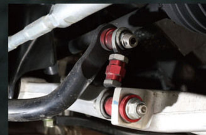
重荷重に対応したピロボールを採用するオリジナルピロスタビリンク。ターンバックル部もA7075超超ジュラルミンを用いる。
