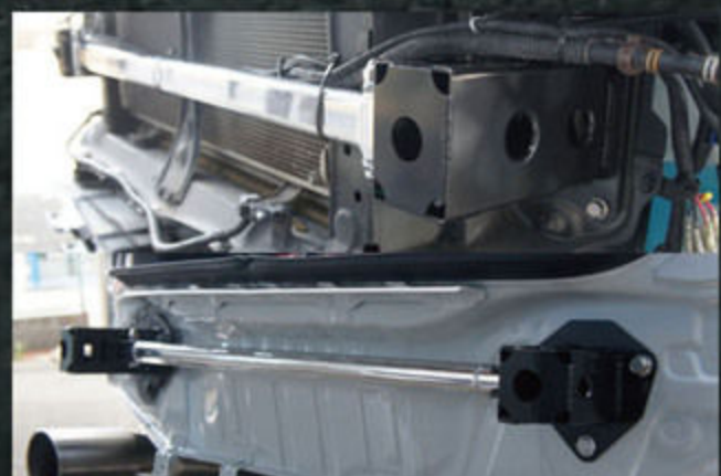
車体を補強するパーツとして、リアフレームエンドバー(RFEB・写真下)とフロントフレームトップバー(FFT・写真上)をラインアップ。
