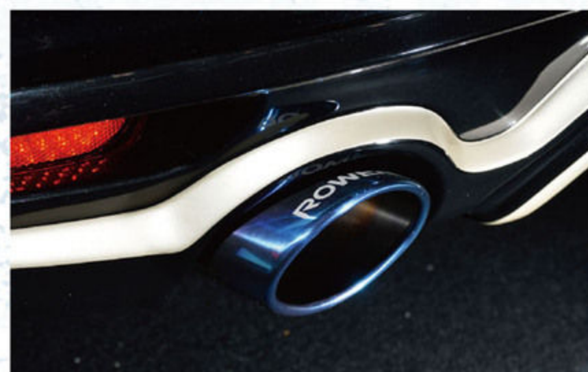
マフラーは試作品。チタンの115φテールが採用されていたが、真円のテールでリリースされる可能性もあるとのこと。車検対応で、春ごろの発売を予定。
