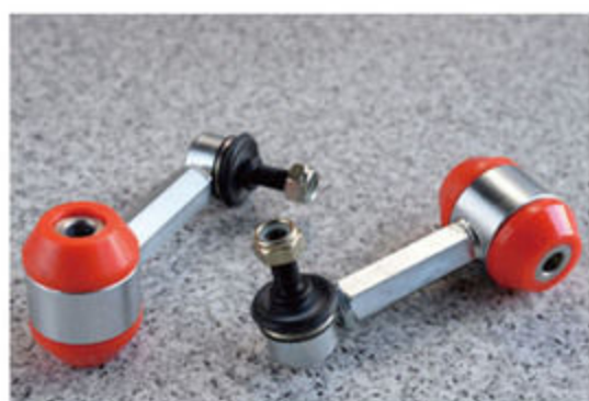
ねじれ剛性を研究して作り上げたリアのスタビリンクは既存タイプが使える。純正品より短めに設定、ノーマル車高、ちょいダウンに対応。
