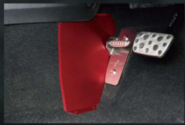
機能性とアクセント効果を備えたフットレストガイド。1.2mm厚のアルミを使用し、レッドとブラックのアルマイト仕上げを用意。
