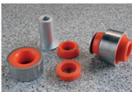
後部側の純正ゴムブッシュをポリウレタンブッシュに交換することによって、スタビリングレスポンスを向上させるフロントロアアームブッシュ。
