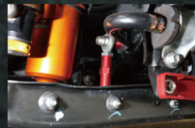
車体を補強するパーツとして、リアフレームエンドバー(RFEB・写真下)とフロントフレームトップバー(FFT・写真上)をラインアップ。
