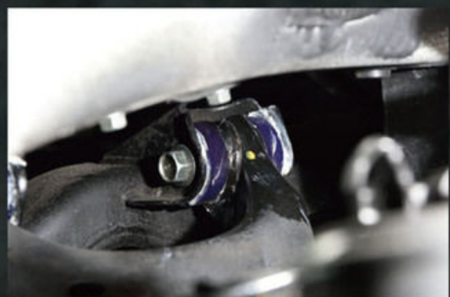
ヨレなどを抑えてダンパーのスムーズな動きを引き出すため、一部のブッシュを純正ゴムからスーパープロのウレタンに変更する。
