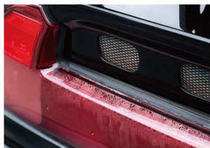
テールライト周辺の劣化による水滴の発生はお決まりのマイナートラブル。バックギン、レンズ共に新品交換可能だが、NA2テールに変更するオーナーも多いらしい。
