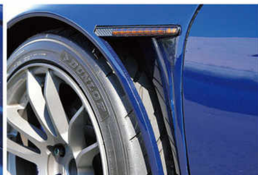
フロントフェンダーはダクト加工しながらBMW用のLEDウインカーをセット。サイドステップもボディパネルとツラが合うように、接合部をスライス加工。これらの作業を筆頭にエクステリア／インテリア各部を自作加工で行っている。
