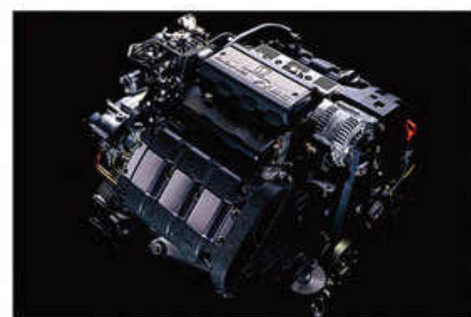
エンジンはレジェンド用をベースにしているが、開発の途中段階でVTEC機構の追加が盛り込まれてパワーアップしている。VTEC搭載によるシリンダーヘッドの大型化に伴い、ホイールベースが延長されたのは有名な話だ。
