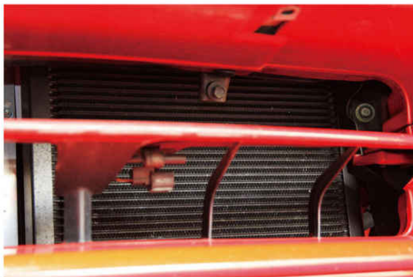
ワンオフで装着されたエンジンオイルクーラーは、フロントのラジエーター前にコアをセット。サーキット走行での油温対策も万全。
