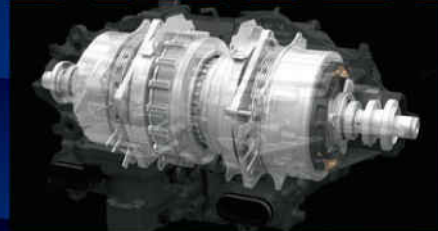
フロントはエンジンの動力が伝わるのではなく、モーターで駆動力を生み出す。左右独立した計2つのモーターを組み込んだユニットは、旋回中に左右のタイヤの回転差を生み出してタイヤ切れ角と以上のヨーモーメントを発生する。レジェンド用のモーターは27kW(37ps)×2だが、NSXでは果たして…。
