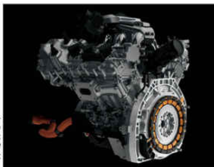
後輪用のモーターはエンジンとトランスミッションの間にサンドイッチして組み込まれる。スペックは明らかになっていないが、35kW(48ps)を発生するレジェンド用と同程度だろうか。
