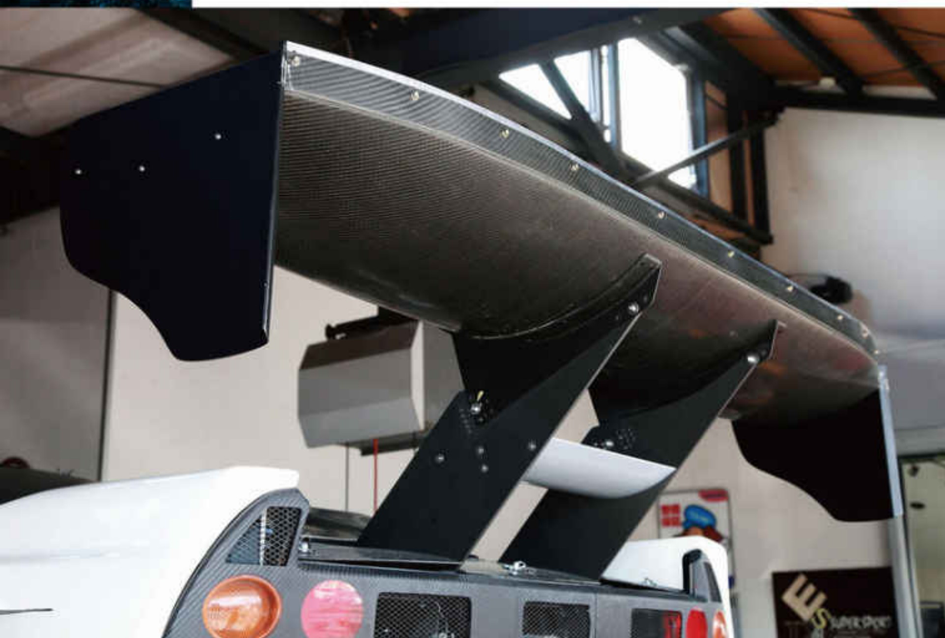
車種を問わずサーキット派から高い支持を集める、オリジナルのGTウイング052-W。断面形状を最適化することに加え、ウイング面を大型化することによってレーシングカーに匹敵するダウンフォースを生み出す逸品。
