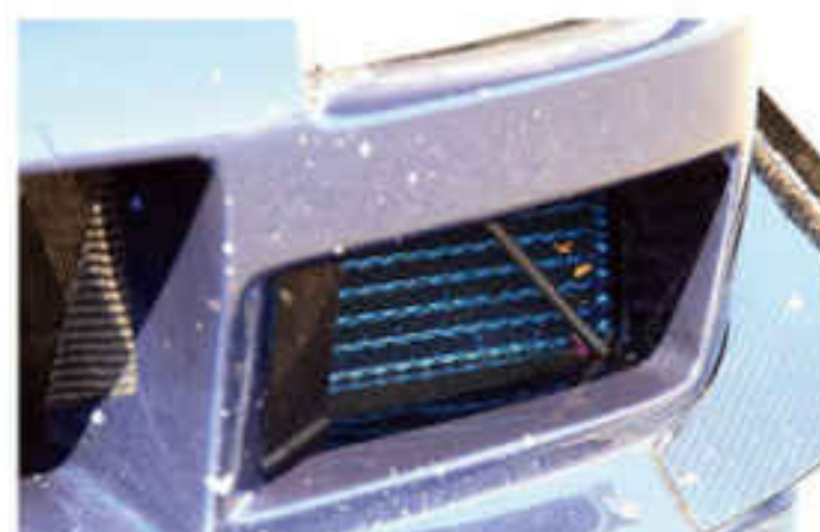
サーキットを走行するには油温管理は必須。フロントバンパー開口部に合わせ、トラストのオイルクーラーをセット。タイムはもちろん信頼性を備えるための装備も抜かりなし。
