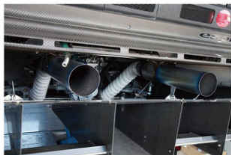
ドライカーボンやチタンなど、チューニング業界ではハイエンドクラスの素材を使ったワンオフアイテムの製作もお手の物。デモカーのマフラーもターボ化やディフューザー装着に合わせて製作されたワンオフ。
