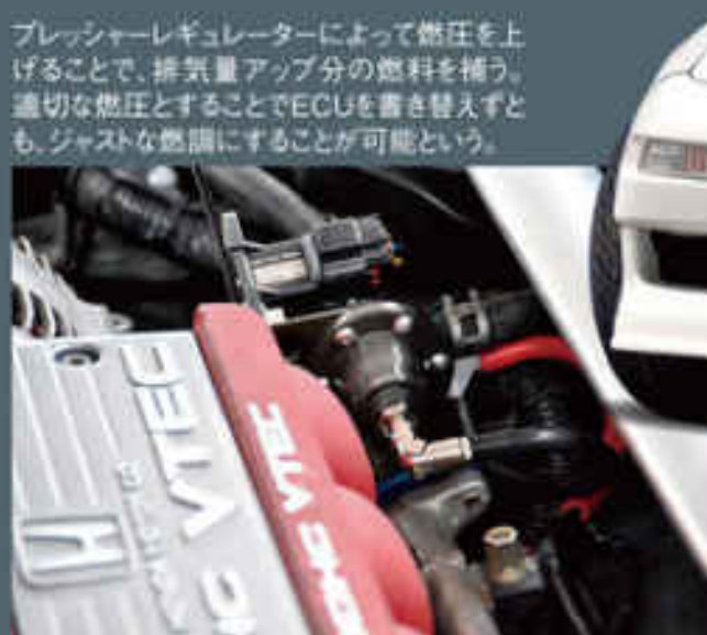
エンジンはハイコンピストンを使った3.0L V6仕様。90psロトルにC32A用のインテークバルブを組み込んだファインチューニングが施される。ストックエンジンと比べて鈴鹿のストレートエンドで車速10km/hの上乗せを達成したとのことだ。
