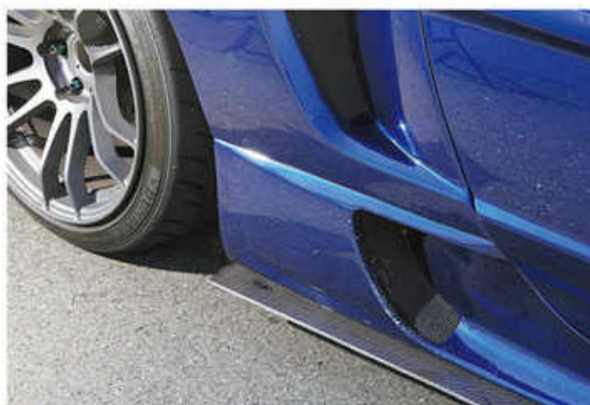
フロントフェンダーはダクト加工しながらBMW用のLEDウインカーをセット。サイドステップもボディパネルとツラが合うように、接合部をスライス加工。これらの作業を筆頭にエクステリア／インテリア各部を自作加工で行っている。
