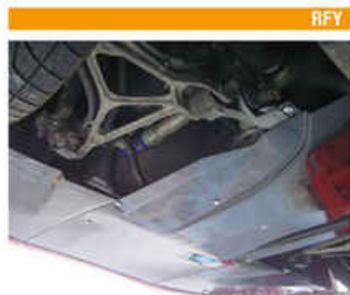
フロントアンダーパネル製作取り付け
