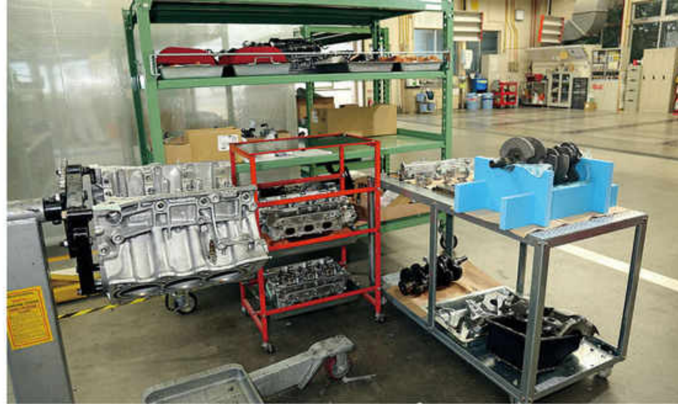
基本メンテナンスに含まれるエンジン調整(バルブクリアランスの調整)に加え、2011年からエンジン関係のメニューが追加されている。エンジンをおろし、交換推奨部品を中心に一般的な定期点検・整備などでは分解されない場所や簡単に交換できない部品まで手を入れる。写真はさらにメニューを追加してエンジン内部まで施工している様子。
