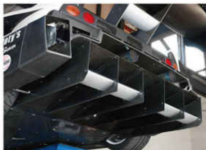
車体前後部分を通る空気を利用して、車体を路面に押し上げるアンダースポイラー。ドライカーボン製となっていて、フロントアンダースポイラーは31万400円、リヤディフューザーは31万3200円となっている。
