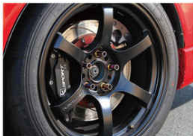
ブレーキは前後共にφ330ローターにKスポーツのキャリパーを組み合わせる。ブレーキのアップグレードはサーキットでの操作性はもちろん、街乗りでの安全性向上にも効果的。
