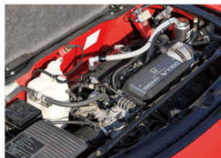
エンジンはオーバーホールを兼ねて戸田レーシング製のピストンを使用し3.1ℓ化。そのほかは純正部品で組み上げられているため、扱いやすさや耐久性も文句なし。
