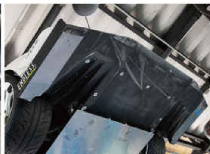
車体前後部分を通る空気を利用して、車体を路面に押し上げるアンダースポイラー。ドライカーボン製となっていて、フロントアンダースポイラーは31万400円、リヤディフューザーは31万3200円となっている。
