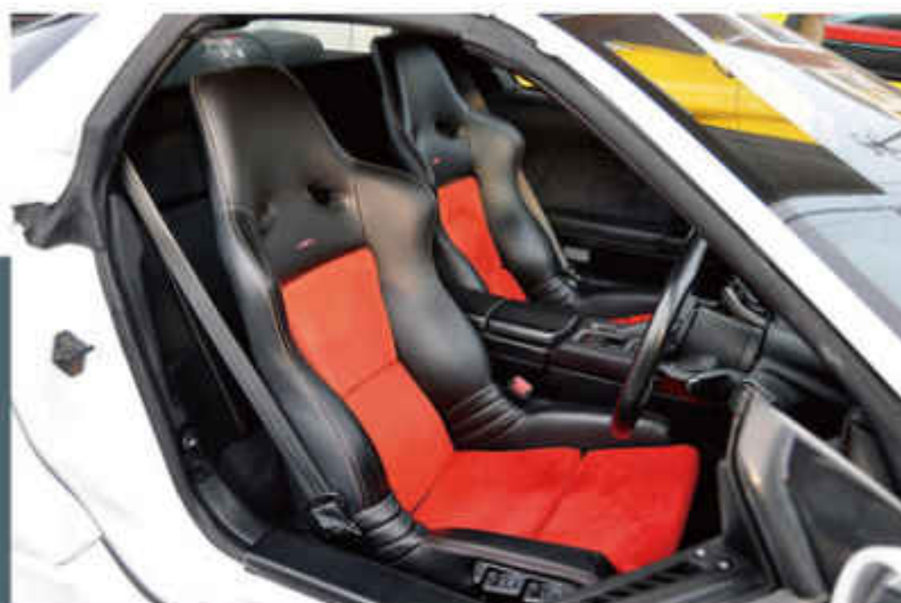
秀逸なフィッティングを誇る「ノーマルシート改セミバケットシート」は11万円(税別)。電動リクライニング機能を残したまま、サーキット走行でも満足のいくホールド性を確保できる。革部や背面、座面のカラーや、表革orエクセース、パンチング加工の有無、ステッチの有無やカラーなど、きめ細やかなオーダーにも応えてくれる。
