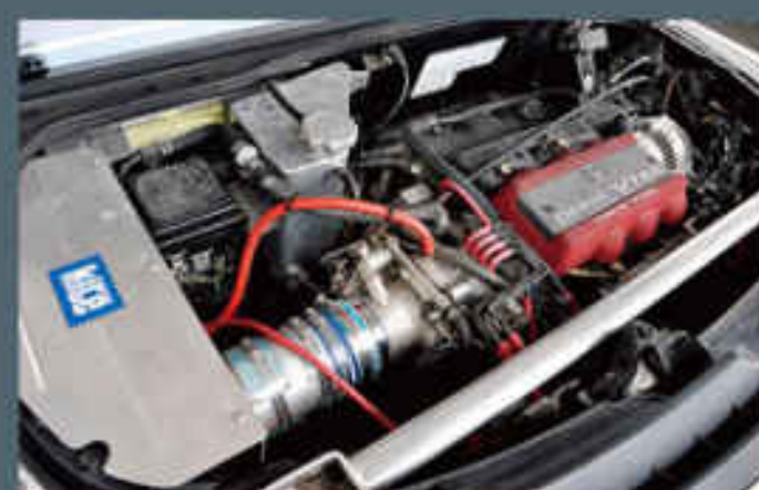
エンジンはハイコンピストンを使った3.0L V6仕様。90psロトルにC32A用のインテークバルブを組み込んだファインチューニングが施される。ストックエンジンと比べて鈴鹿のストレートエンドで車速10km/hの上乗せを達成したとのことだ。
