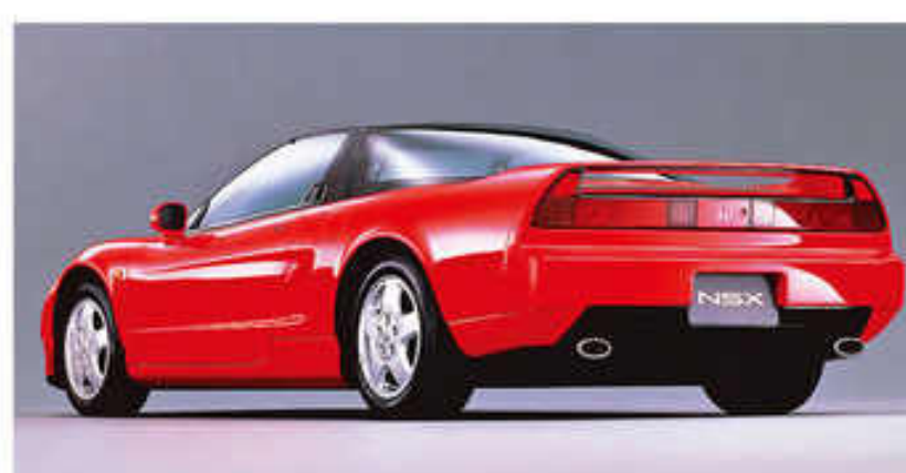
「トランクにゴルフバッグが積めるように開発途中でリヤオーバーハングを延長した」とも囁かれているが、真の理由は冷却性と空力性能向上のため。トランクにゴルフバッグが積載できるのはその副産物である。
