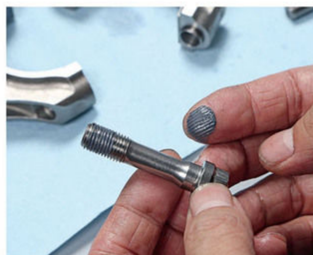
13 コンロッドボルトに専用ペーストを塗布
