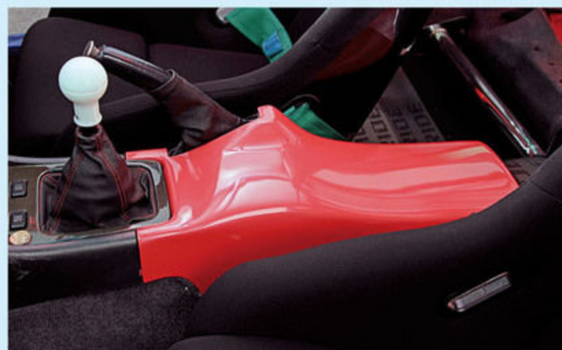
シフトやサイドブレーキの操作時に、コンソールボックスが邪魔だという意見から新たに産まれたローマウントコンソール(1万9800円)。コンソールと置き換えてフラット形状にすることで、操作性もアップする。
