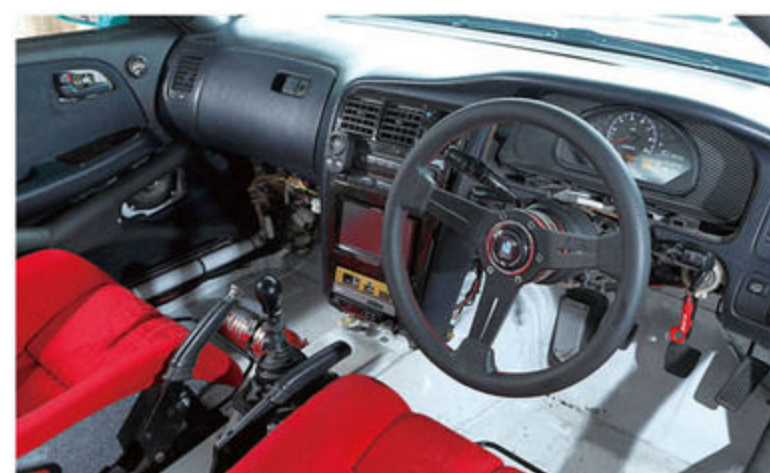
シンプルで機能的にレイアウトされているインパネまわり。多数の追加メーターを付けずに、デフィのスポーツクラスターで集中管理しているのが特徴的。ミッションはゲトラグ6速となっている。
