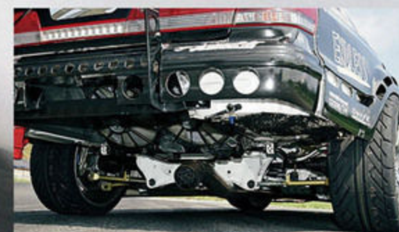
ラジエターはトランクルーム内に移設され、リヤ寄りの重量配分を実現している。
