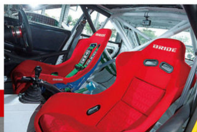
シートは運転席、助手席とも、レッドカラーが鮮やかなブリッドのフルバケットタイプⅢ。剛性確保と乗員保護のために細かく張り巡らされたオリジナルロールケージが多数張り巡らされている。
