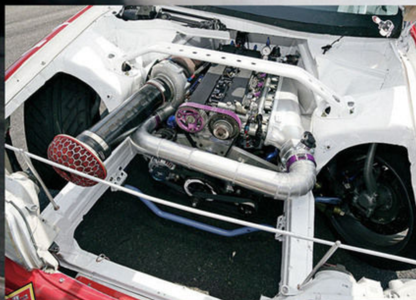
エンジンは、BCのキットで3.4ℓ化された2JZ。高回転化のためにドライサンプになっている。タービンはギャレットのGT4088で、約1000psをマークする。
