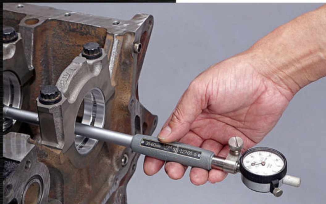
2 ブロック側メインジャーナル内径を計測
