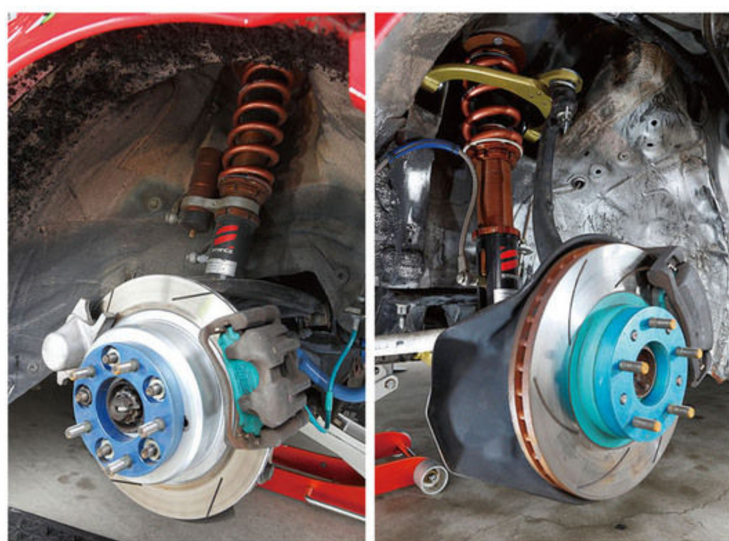
車高調はスタンスのサブタンク付き。切れ味の鋭いドリフトを実現するためのポイントが、自由長が長くて硬めのリヤスプリングだ。油圧サイド用に追加されたJZX110用キャリパーがドリ車ならではの装備だ。
