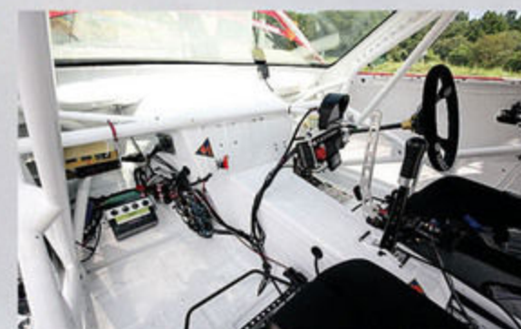
徹底的に軽量化がはかられている室内。着座位置もかなり後退している。
