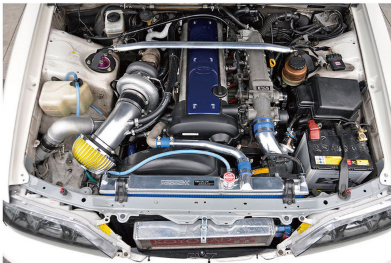
エンジン本体はノーマル。DELTAタービンキットによってブースト圧1.5kg/cm時に500psのパワーと約65kgmものトルクを発生する。これだけのパワーアップでも、エンジン本体側がノーマルで耐えられるというのも1JZの魅力だ。
