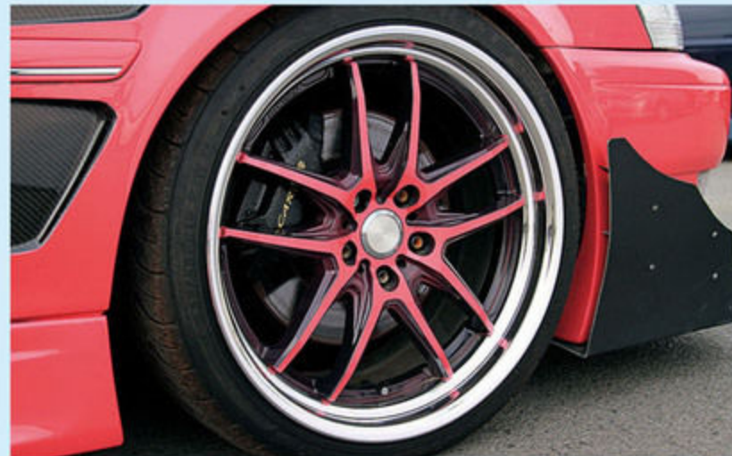
ボディカラーに合わせてスポークにペイントを施すホイールは、ワークXSA OC 4。オリジナルのワイドフェンダーを組み合わせ、フロント9.5J-18、リア10.5J-18のセッティング。
