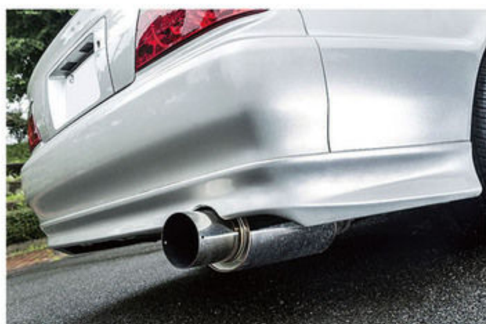
太く響き渡るような2JZサウンドを強調するHKSハイパーマフラー。このクルマにはGT-R用を加工した触媒も備えられている。
