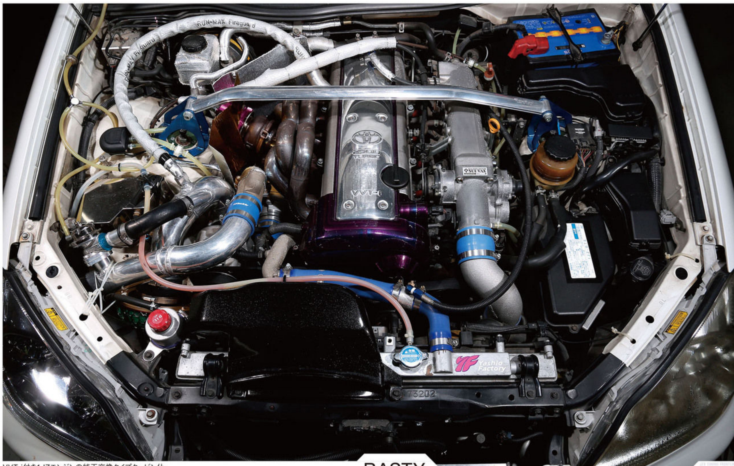
VVT-i付き1JZエンジンの純正交換タイプタービン仕様の、1.5JZ仕様に代わる選択肢として開発されたのがツインチャージャーキット。純正エアクリボックスの位置に、スーパーチャージャーを直列でセットする。
