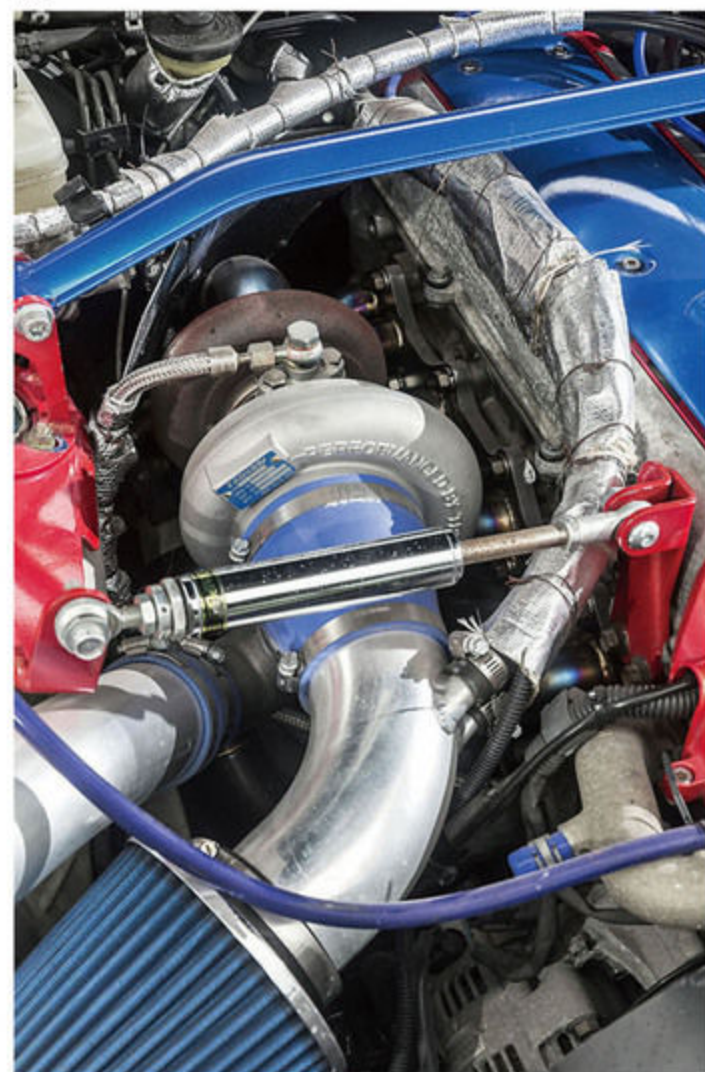
ブルー/レッドにペイントされたヘッドカバーが目を引くエンジンルーム。ラジエーターはトラストのアルミ製、インタークーラーはHPI製に変更。
