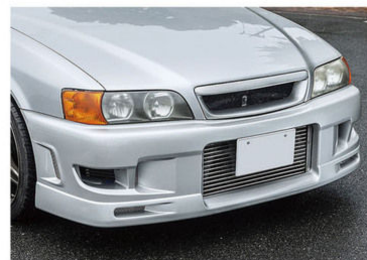
HKS九州サービスオリジナルのJZX100チェイサー用エアロバンパー。前置きインタークーラーをキレイに収める大型開口部や、オイルクーラーの配置に最適な両サイドのダクトなど、冷却性能と見た目のカッコ良さを両立。価格は6万8000円+税となっている。
