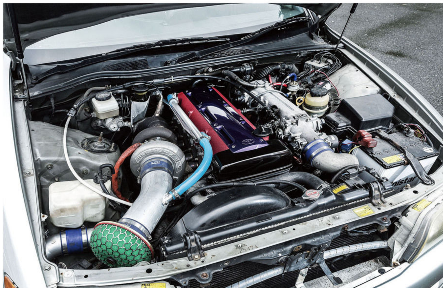
標準ユニットのように美しく収まった2JZエンジン。低、中速の乗り易さをより重視するなら16Aリストやマイナー後のスープラなど搭載されていたVVT-i付きを選んだ方がベターとのこと。
