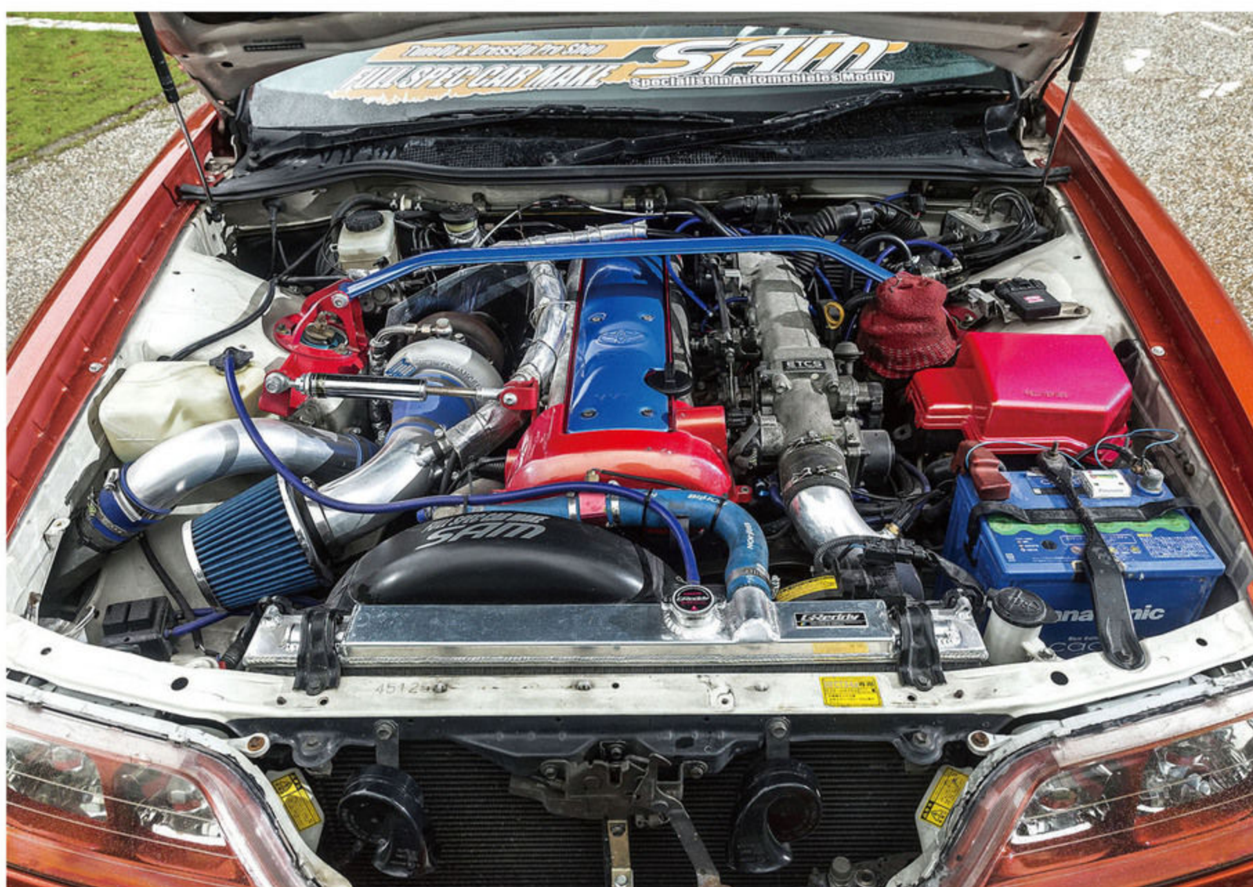
ブルー/レッドにペイントされたヘッドカバーが目を引くエンジンルーム。ラジエーターはトラストのアルミ製、インタークーラーはHPI製に変更。
