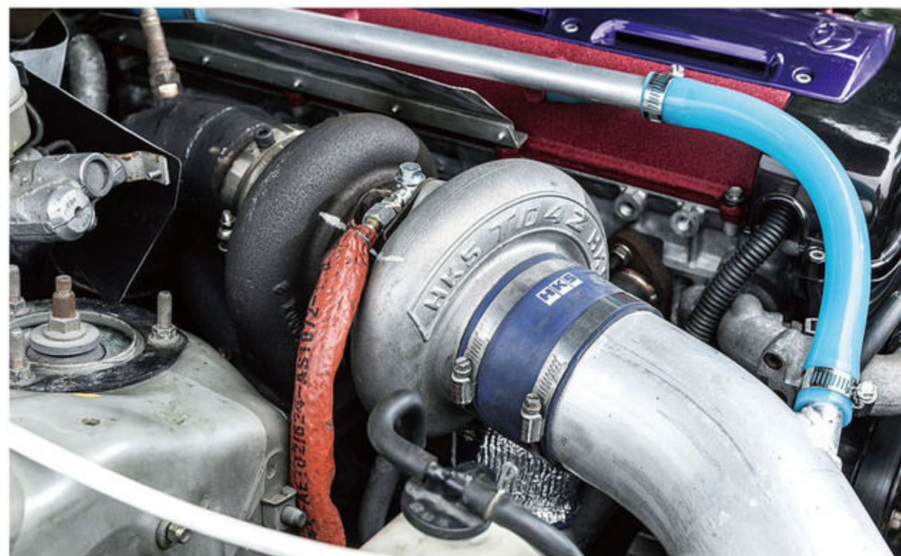
フルパワー仕様対応のキャパシティを持つT04Z。とはいえ、ピーキーさはなく、低回転からもしなやかなレスポンスを示す。これもHKS九州の味付けの成せるワザと言える。
