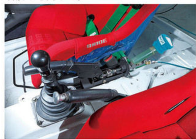
シートは運転席、助手席とも、レッドカラーが鮮やかなブリッドのフルバケットタイプⅢ。剛性確保と乗員保護のために細かく張り巡らされたオリジナルロールケージが多数張り巡らされている。
