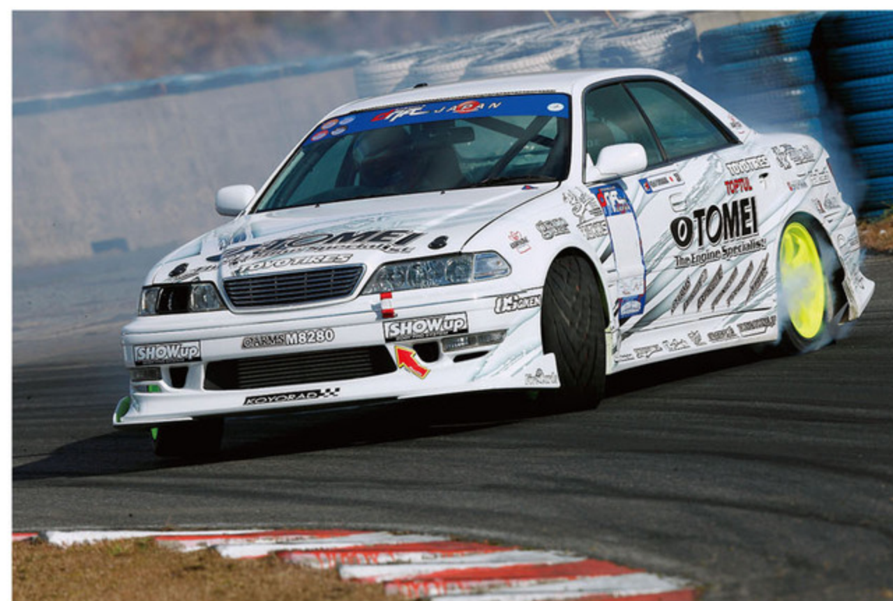
フォーミュラDジャパン参戦中のケンジ山中選手とテストを続けてきた2JZ改3.6ℓ仕様。トップエンドだけでなく低回転域からトルクを発揮する特性は、どんなシチュエーションからもドリフトに持ち込めるフレキシブルさを発揮したという。
