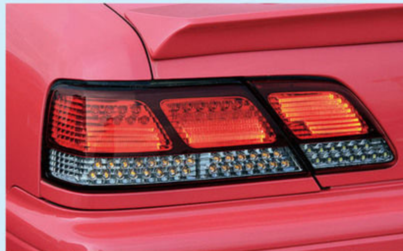
テールランプもオリジナルスタイルでワンオフされたフルLEDタイプに変更。購入後にDIYで作るのもアリだけど、プロが作るクオリティはデザインも視認性も抜群の仕上げ。もちろん車検対応。
