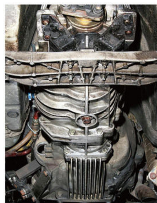
ミッションは80スーパ純正のゲトラグを搭載。ファイナルを4.1に組み換えることで、ホームサーキットの日光から筑波まであらゆるサーキットに対応できるとのこと。
