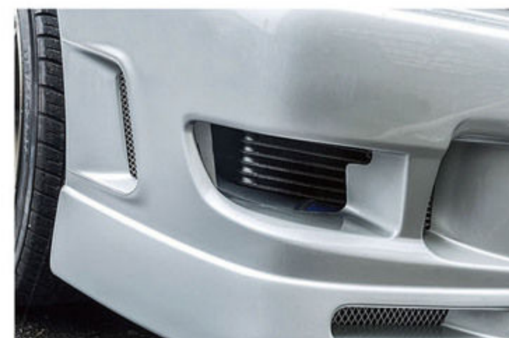
取材車両は両サイドのダクト内にオイルクーラーを一基ずつ装着。バンパー側面には放熱用のエアアウトレットも備わる。
