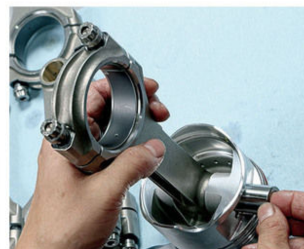
11 ピストンピンを挿入する
