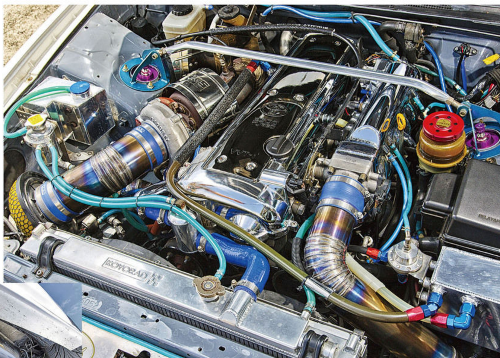
1JZにギャレットの3076Rタービンをドッキング。低回転域から太いトルクを発生させ、高回転域はHKSの264度カムがフォローする。冷却系はラジエーターやオイルクーラーといった定番の他、ドリフト仕様らしくパワステオイル用のクーラーもツインで装着済み。
