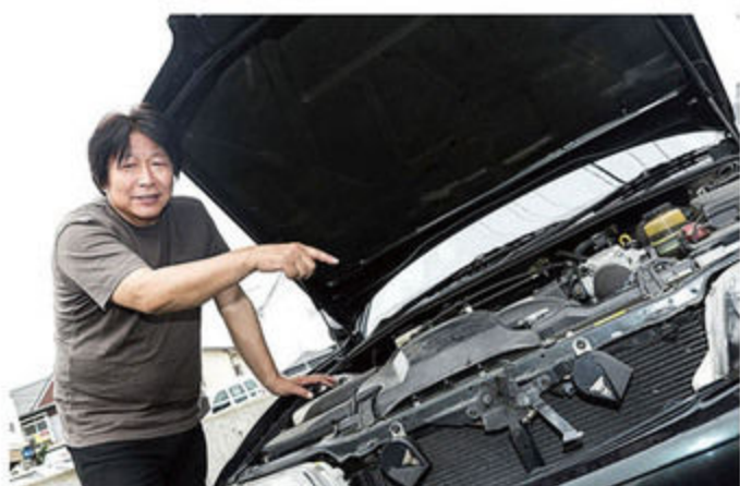
チューニング前のコンディションチェックに入庫して来たチェイサーを前に、1JZ系のウイークポイントを語る竜円さん。「コイル周りの樹脂部品の割れ、VVT-iの油圧低下、圧縮の低下など、まずは基礎体力の点検から始めましょう」。ちなみにHKS九州では各部点検、プラグ交換、シャシダイでのパワーチェックなどを含んだ「基本診断セット」を2万9800円で案内している。
