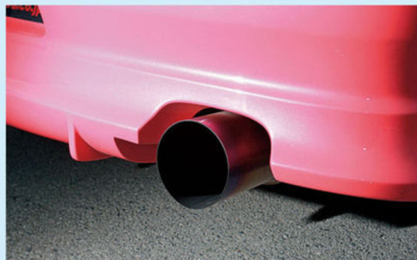
マフラーはカー工房オリジナルのローダウン対応チタンテールタイプ。メインはφ80でJZエンジンのサウンドを楽しめるストレートや中間タイコタイプなど、好みによって選択肢も様々。
