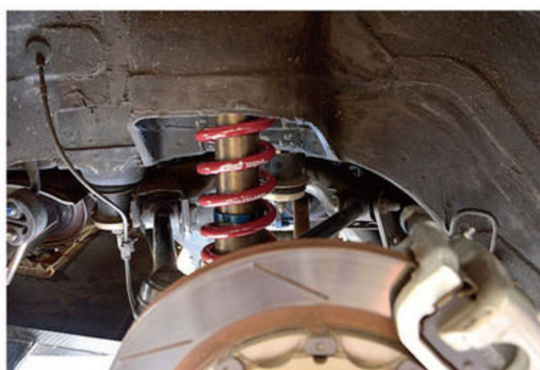
最終テストは鈴鹿サーキットという、エイトで遊ぶためのオリジナル車高調が「カップダンパープラス」。アイバハ製スプリングはフロント14kg/mm、リヤ12kg/mmで、ワイドレッドに合わせてリヤには1.5kg/mmのヘルパーを追加。フロントロアアームとアッパーアームはピロタイプとしている。
