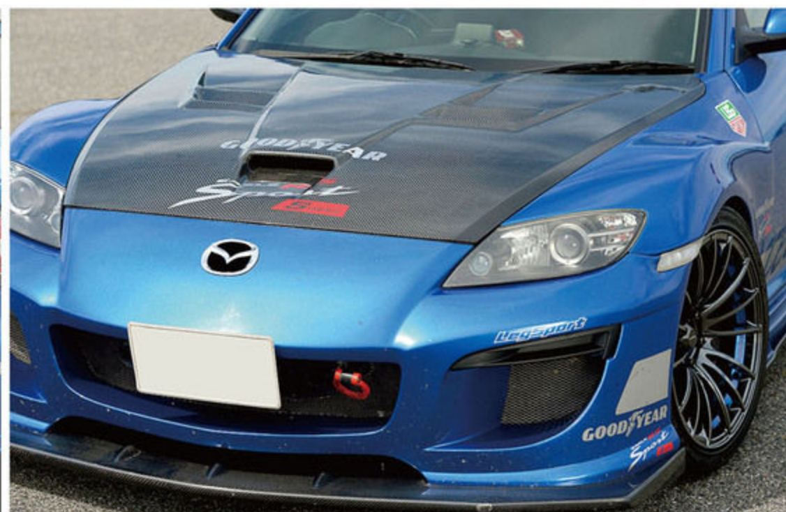
人気のクラブスポーツエアロパーツは、フロントからバンパーとGTカーボンリップ、サイドステップ、リヤディフューザーバンパーの組み合わせ。エアロボンネットに前後フェンダー、カーボンルーフも装着している。GTウイングはスワンネックステータイプの新型だ。
