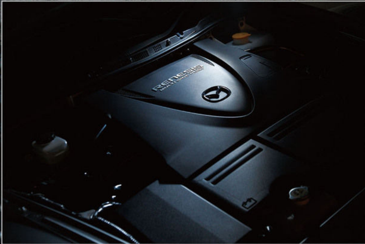
13Bの最終進化形ともいえる13B-MSPはRX-8への搭載にあたって自然吸気を前提に全面的に新設計され、サイド吸気化などさまざまな改良を施して「RENESIS」というサブネームが付いた。重量バランスを最適化するために前輪の車軸より後方へ置かれたフロントミッドシップレイアウトは、スポーツカーの命である運動性能の向上に大きな役割を果たす。エンジンは、RX-7最終型(FD3S)に比べて40mm低く、60mm後方に積まれている。
