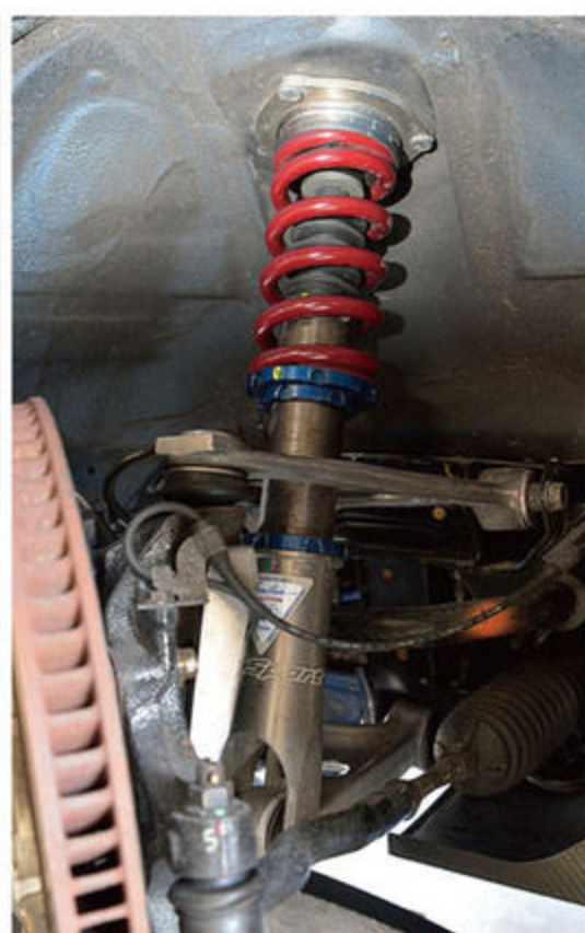
最終テストは鈴鹿サーキットという、エイトで遊ぶためのオリジナル車高調が「カップダンパープラス」。アイバハ製スプリングはフロント14kg/mm、リヤ12kg/mmで、ワイドレッドに合わせてリヤには1.5kg/mmのヘルパーを追加。フロントロアアームとアッパーアームはピロタイプとしている。
