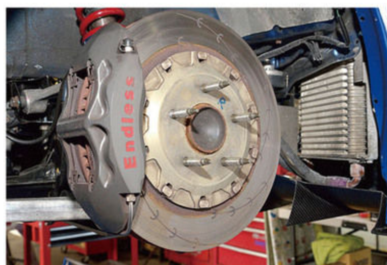
フロントにエンドレスモノブロック4ポットキャリパーを投入し制動力を強化。ブレーキローターは前後ともBiotの2ピースタイプ。パッドは制動屋をチョイスしている。
