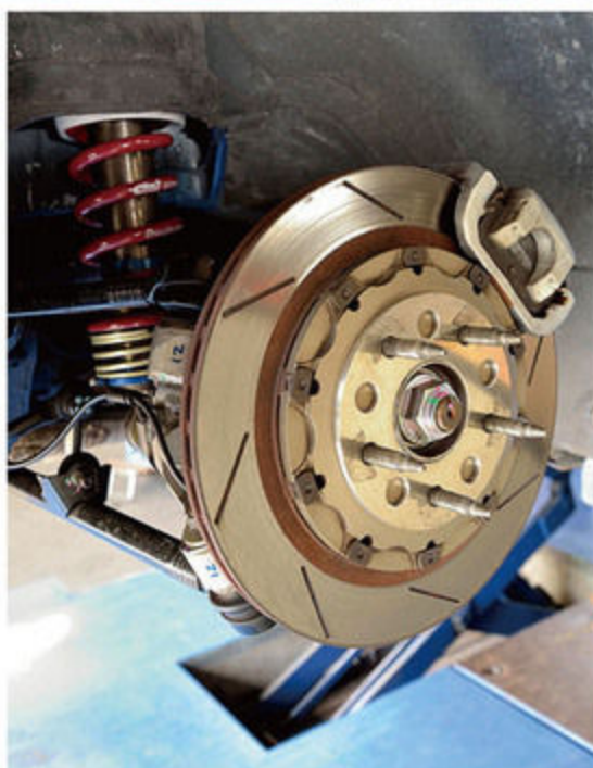
フロントにエンドレスモノブロック4ポットキャリパーを投入し制動力を強化。ブレーキローターは前後ともBiotの2ピースタイプ。パッドは制動屋をチョイスしている。
