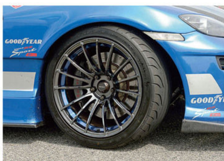
リム内のブルーカラーが目立つ15本スポークのウェッズSA-15と組み合わせているのは、グッドイヤーイーグルRSスポーツ。前後とも265サイズで高いコーナリング性能を生み出している。
