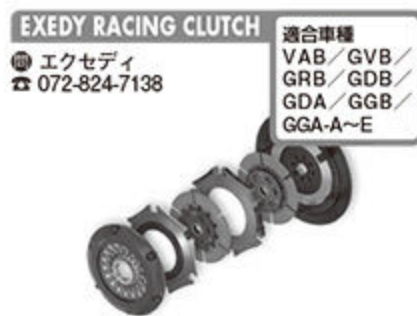
EXEDY RACING CLUTCH 適合車種 VAB/GVB/ GRB/GDB/ GDA/GGB/ GGA-A~E エクセディ 072-824-7138 ハイパーメタル ¥18万9800円 摩擦材:メタル プレート数:ツイン 圧着力:9810N
