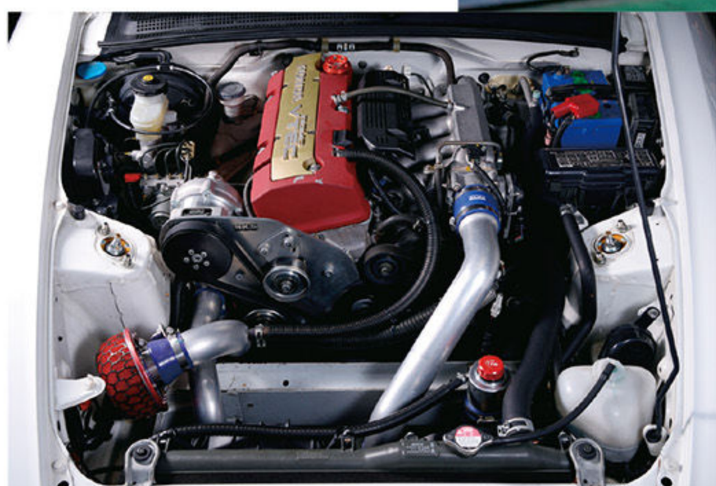
吸気側を見るとターボチャージャーのような形状のGTスーパーチャージャーは「7040」サイズを使用する。標準のリストリクター径は37.5mm、燃料系をアップグレードすることで44mmに対応する。
