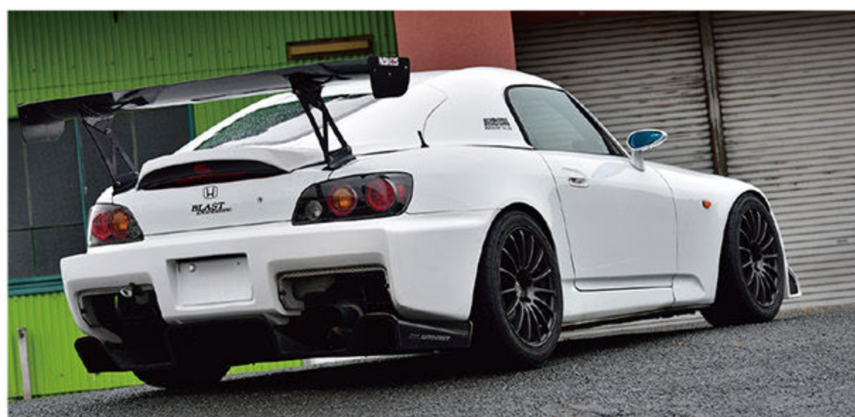
車高はややリア下がりにセット、GTウイングのダウンフォースと合わせトラクションを重視する。
