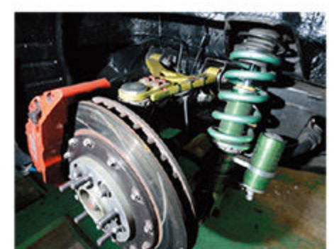
高性能ブレーキシシステムを最大限に生かすため、サスペンションやアライメントなど、細部まで徹底的に手が入れられている。
