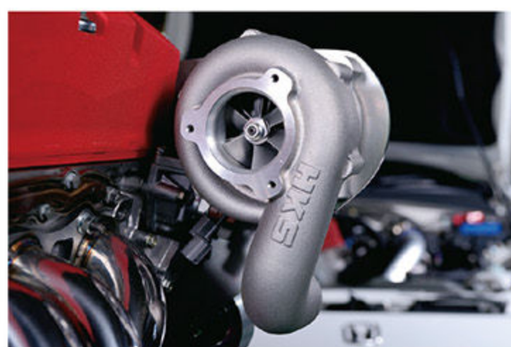
吸気側を見るとターボチャージャーのような形状のGTスーパーチャージャーは「7040」サイズを使用する。標準のリストリクター径は37.5mm、燃料系をアップグレードすることで44mmに対応する。
