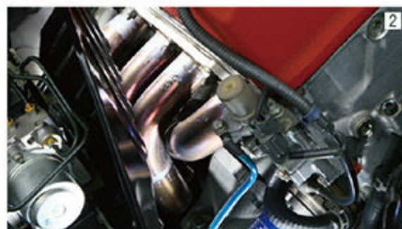
1 ベースは2.2ℓF22Cを搭載するAP2。現在は「未開封のノーマルエンジンでできるトータルチューンの限界」に挑んでいる。なお、ヘッドの熱が吸気温度に影響を及ぼさないように、インマニ断熱ガasketを用意している。2 トルクフルなF22Cとの相性が高いエキマニとして、戸田レーシングのスタンダードをセレクト。低中速域のトルクの豊かさに高回転域での伸びが加わり、全域でストレスのないフラットな加速フィールに仕上がる。
