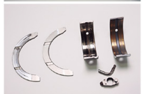
トラブルシューティングで明らかとなった問題のスラストメタル（左）。その影響か、クランクメタル（右上）も傷みやすく、オイルジェット（右下）が折れることもあるという。
