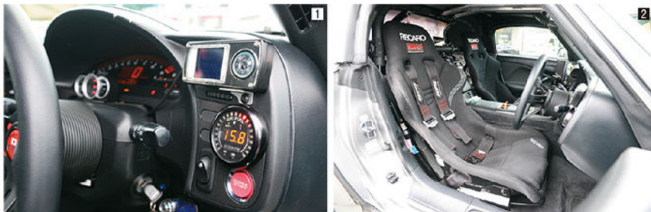
1 室内はストリートユースを重視した純正スタイル。2 ホールド感を向上させるレカロ製バケットシート (TS-GS / RES-GE) に交換され、4点式のシートベルトを採用。ロールオーバーで剛性と安全性を確保。
