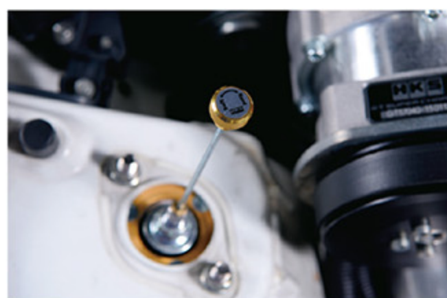
ダンパーの減衰力調整について、フロントはエンジンフードを開ければ簡単だが、リアはトランクルーム内で手が入れづらい。左リアには延長ケーブルが付属する。
