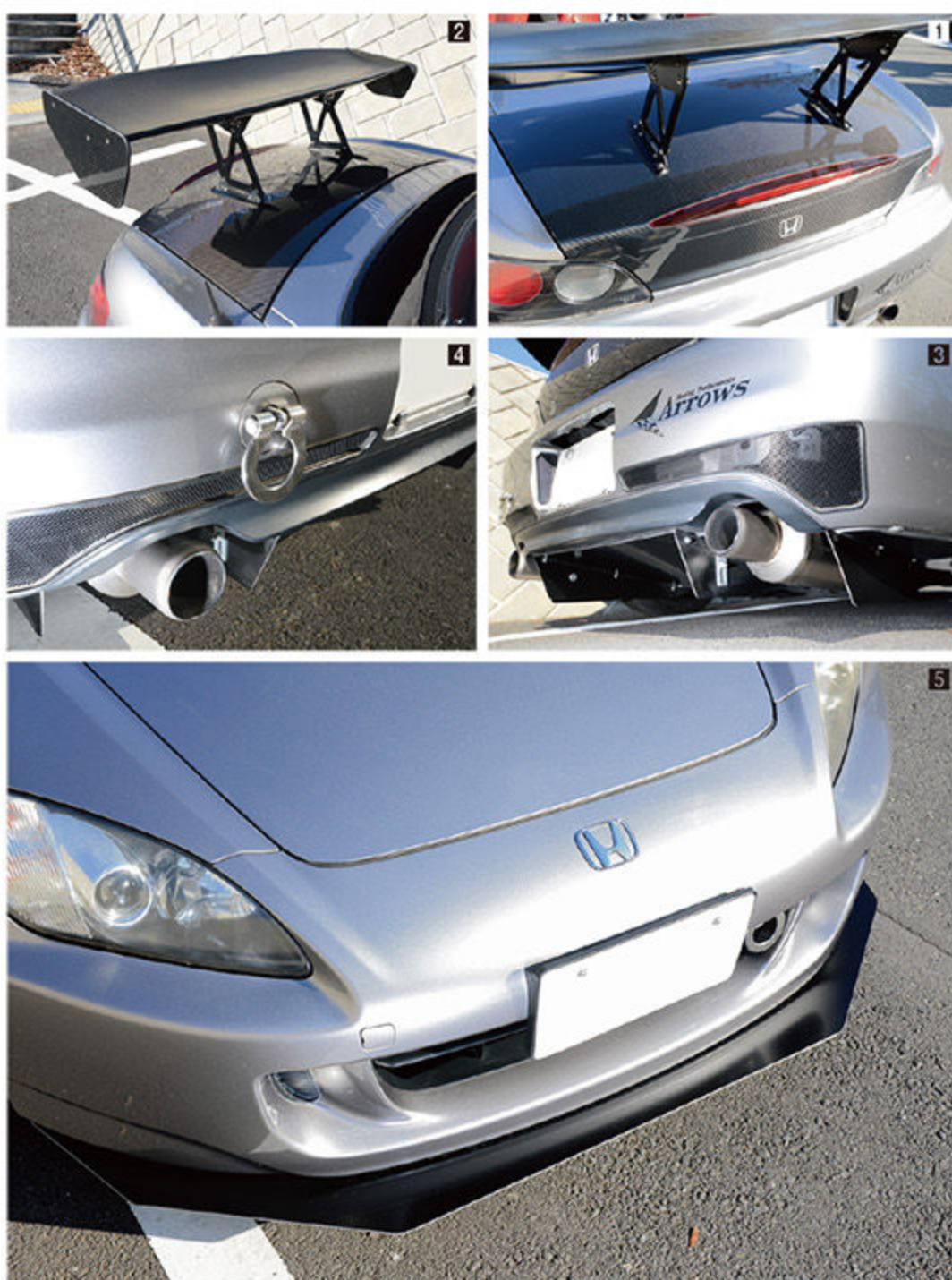
12 外観で存在感を強調するアローズ製GTウイングは、オートリベアー信栄製カーボントランクにマウントされる。13 リアバンパーは純正をベースに穴あけ加工が施され、パラシュート効果を防いでいる。14 フロントバンパーはAP1-130以降のものをベースに、ワイド化されたフェンダーに合わせてヘッドライト外側部分を拡張している。バンパー下に見えるのはアンダーフロアの段差をなくし、整流効果を高めるフラットボトム。路面のホールド性が格段にアップするという。
