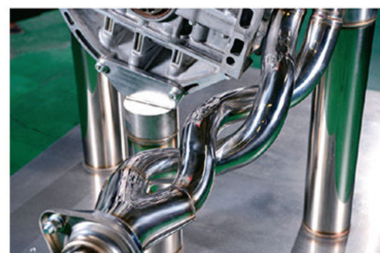
ツイストさせた形状のエキゾーストマニホールドは、パイプ長さを稼ぐためにこだわった結果。ノッキングを防止することもできるので、セッティングの幅も広がるというメリットもある。
