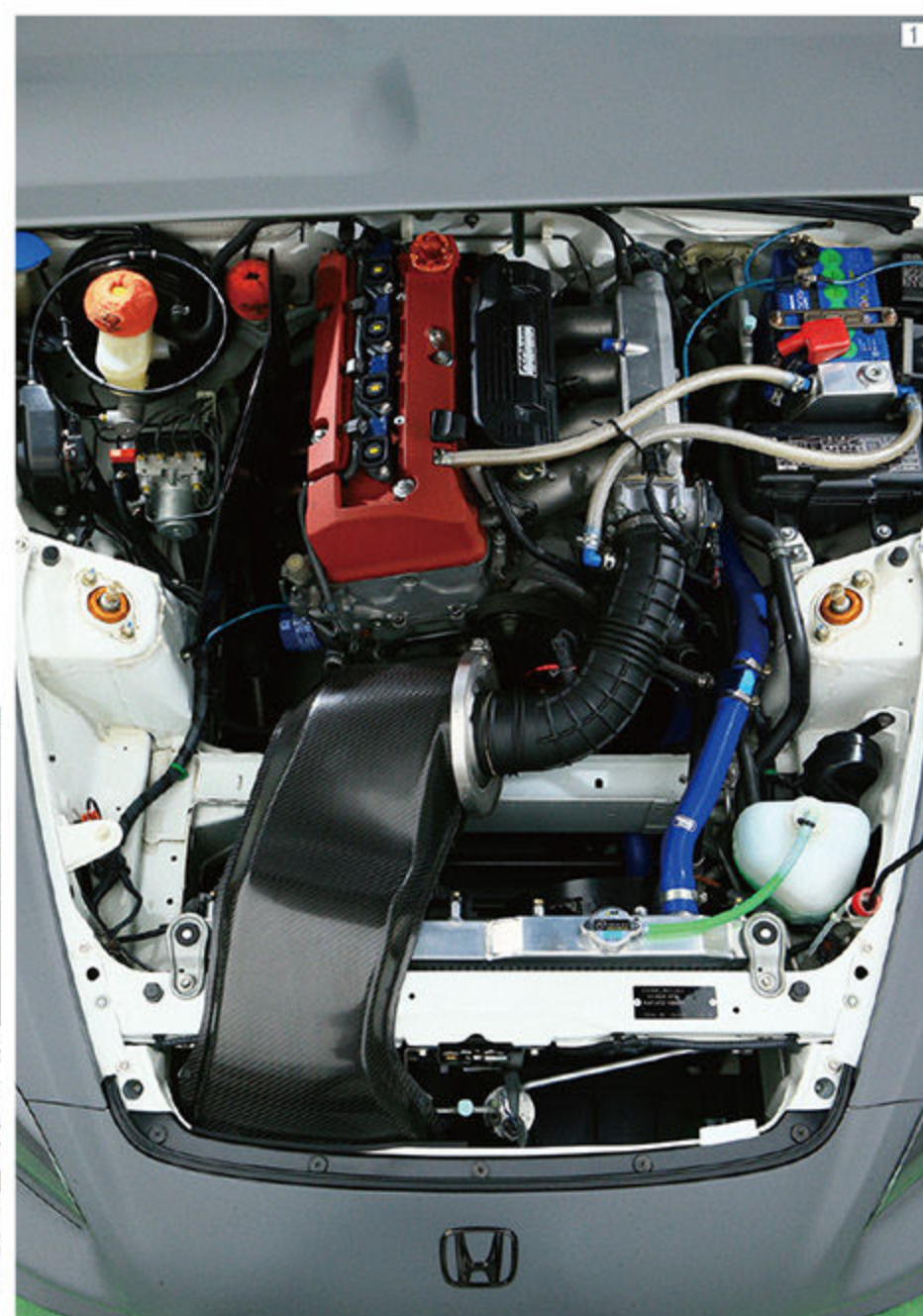
1 ベースは2.2ℓF22Cを搭載するAP2。現在は「未開封のノーマルエンジンでできるトータルチューンの限界」に挑んでいる。なお、ヘッドの熱が吸気温度に影響を及ぼさないように、インマニ断熱ガasketを用意している。2 トルクフルなF22Cとの相性が高いエキマニとして、戸田レーシングのスタンダードをセレクト。低中速域のトルクの豊かさに高回転域での伸びが加わり、全域でストレスのないフラットな加速フィールに仕上がる。
