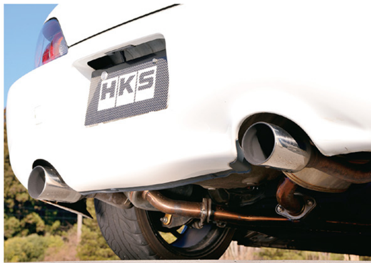
純正バンパーとマッチするシンプルな形状のマフラー「SSM（スーパーサウンド Master）」のテール径は102mmでパイプ径は50～60mm。名前の通り、高回転での官能サウンドにこだわった。
