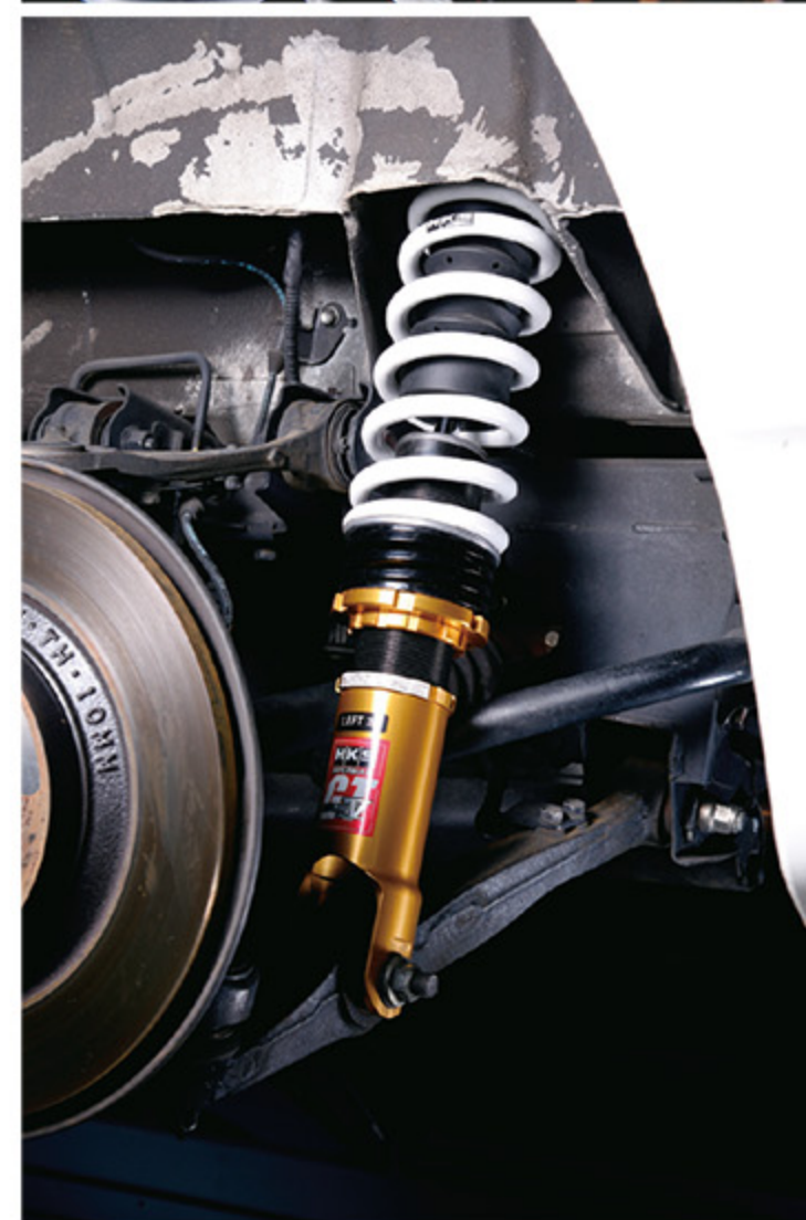
ストリート系のGTキットはフロント8kg/mm、リア7kg/mmのバネレートで、伸び側ストロークを確保するためにヘルパースプリング（黒い部分）を使う。なおバネレートについては出荷時にプラスマイナス2キロの範囲で変更可能だ。
