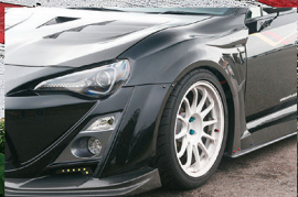
フロントフェンダーは、片側50mmのワイド化ができる。構成するパーツは、フェンダーとエクステンションカバーの3ピースとなる。
