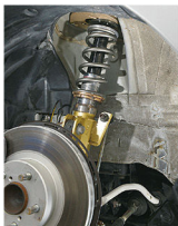
オリジナルのサスペンションは全長調整式で、3段階の減衰力調整が可能。スタビライザーは前後ともノーマルより細いタイプ（F：17φ/R：13φ）
