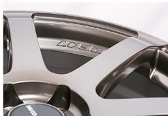
ビッグキャリパーにも対応するようにデザインされ、ブレーキの冷却性能も高めている
