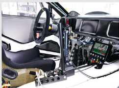
シーケンシャルのシフトレバーとサイドブレーキが自立 twin テリリア。センターディスプレイは下方に設置される
