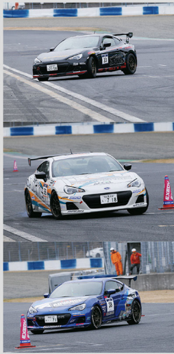
PN3クラスを戦うのは「スピードPN車両規定」に附ったマシン。改造制限は、足まわり、デフ、ブレーキリット程度で、輪軸はエンジンとミッションマウントの強化のみ許されている。ピロボールジョイントなどは使えないが、ロールオーバーも不要。タイヤは純正サイズより1インチアップ＆幅10mmまで拡張可能で、最大サイズは86&BRZの225/45R17となる。
