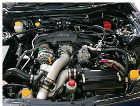
GTS7040Lスーパーチャージャーによるハイパワーを高いコストパフォーマンスで獲得するのをコンセプトに、エンジンノーマルで小径ブリーリーとオリジナル47φリストラクターで300ps強を發揮。
