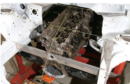
フルチューンの2・3Zエンジンは、バルブヘッドを突き抜ける形で搭載される。すでに数回もカット込みでこれからパイプブローを繰り返していく予定。定ハンドル化も実施する。マフラーもサイド出しになる
