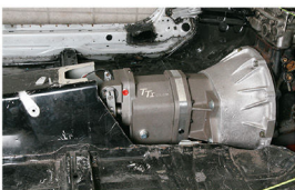
ラストイヤーが代理店契約を結ぶT1は、ニュージーンランド製のシーケンシャルギアボックス。強度はもちろんローコストなのも魅力。2・3Z仕様では富士も走りたいので5速モデルを組み合わせてみる予定とか
