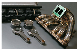
2・3ZにHK33・44キットを組み込む。さらに大容量サージタンクやエキマニも両立されるなど、着々とアップグレードの準備は整ってきた。ラストイヤーが挑む新たな86メイクに期待が高まるばかりだ
