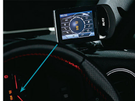
タッチブレインが86/BRZの大きな特徴と書えるVSCカット機能。OFFを落とすことで、完全カットしながら、エンジンを発動したのちも、そのままの安定をキープする。手先の純正VSCスイッチはもう人使用できる
