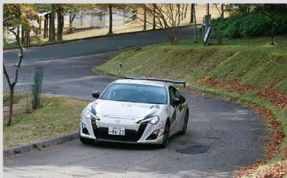
原文なロールオーバーを推察し、エンジンコンピュータやブレーキキャリパー交換まで可能な本格的なラリー車両がRJ車両だ。グラベルラリーではアンダーガードなどを装着し、15インチホイールとグラベルタイヤで戦う。
