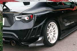
リアフェンダーは片側65mmワイド化される。セット内容は、フェンダー、エクステンションカバー、給油口の5ピースとなっている。
