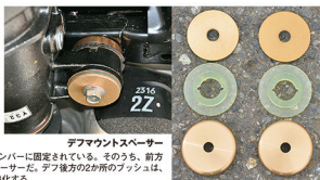
リアメンバースペースーサーは、ボディに固定しているボルトをいったん外し、スペースーサーでメンバーを挟むようにして組み直すという簡単な工程でメンバーマウントを強化できる
