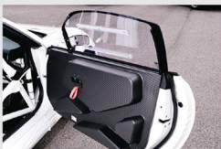
ロールケージを覆うように造られたカーボンのインナーパネルとアクリル製のウィンドで軽量化されている
