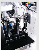
AP Racing製のオルガン式ペダル類。シートを動かすのではなく、ペダルを前後に動かしてポジションを決める
