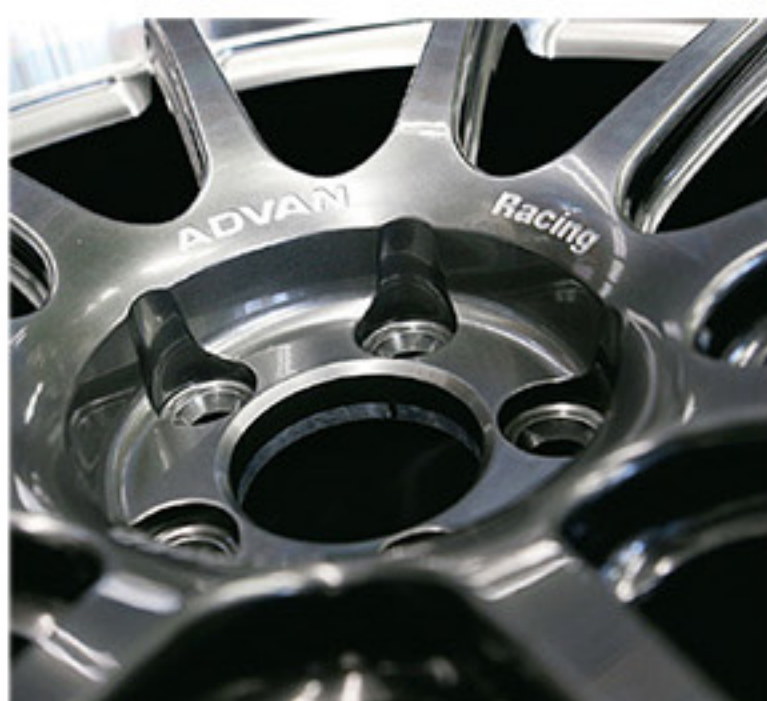
センター部分への落とし込みは4タイプの設定がある。また、マシニング機によって刻印されたADVAN Racingのロゴも魅力のひとつだ
