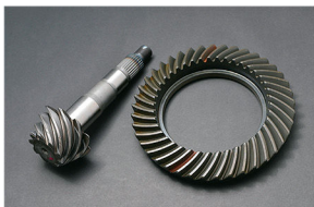
ファイナルギアはデフのリングギアとピニオンシャフトの「ギアセット」で構成される。ギアは変更によってLSDのフィーリングも変化するので、セッティング技術のあるショップに取り付けをオーダーしよう
