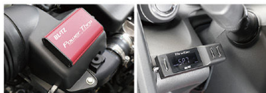
エンジンルームにパワーユニット（写真左）、室内にスロコンユニットとコントローラー（同右）を設置する。燃費重視からハイレスポンスまで計25種類のモードから自分好みの5つを選択できるシンプルモードも用意した
