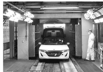
完成車検査において雨漏りチェックは当然のメニューのひとつ。もちろんオープンボディであっても同一条件で検査されているのは言うまでもない
