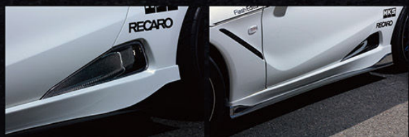
サイドインテークダクトはカーボンに置き換えて質感アップを図り、導入部と開口部の拡大を図る。サイドステップもデザイン性だけでなく、ボトムに張り出しを与えてフロア下への走行風流入を抑制する役割を担う
