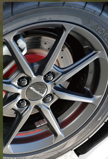
MR-R01ホイールはS660専用品。ホイール剛性をS660 にあわせて最適化しているので乗り味が変わるホイール
