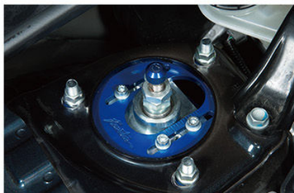
減衰力は前後とも30段調整式となる。リニアすぎず、楽しく走るためのセッティングには減衰力の調整も上手に活かしたい。
