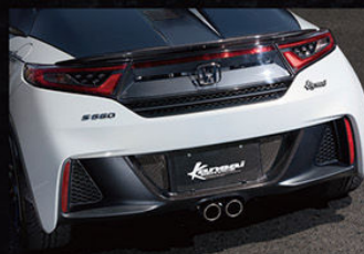
エンジンルーム内の熱を効率よく排出するために企画されたリアバンパーアウトレット。武骨な印象を与えず、スタイリッシュで質感の高いダクトの構築にこだわった
