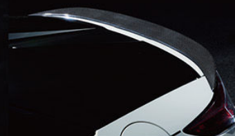
MRのS660はリアが比較的安定しているため、リアリップはダウンフォースよりも整流効果を意識してデザイン。コンパクトかつシンプルな造形で視認性も高い
