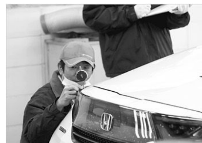
部品同士の隙間にあるチリやスポーツカーの品質感につながる塗装など、チェック項目は軽商用車のアクティ系と比べると倍近いという
