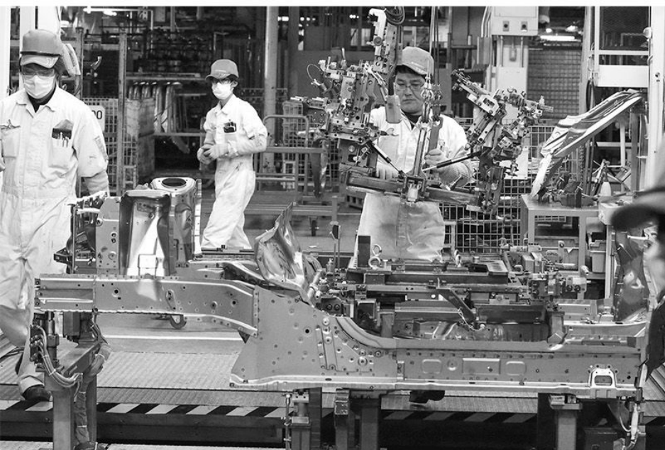
S660の溶接ラインにおけるトピックスが、フロアとサイドパネルの溶接工程。ここでは二分割したJIG（治具。位置決めツール）を室内側に配置、またリベットやボルトによる固定を併用して、ロボット溶接へと送り出している
