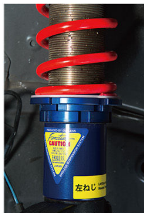
減衰力は前後とも30段調整式となる。リニアすぎず、楽しく走るためのセッティングには減衰力の調整も上手に活かしたい。
