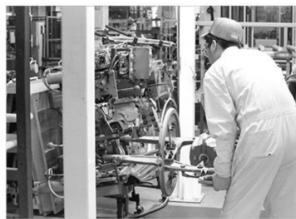
こちらはドアを溶接しているところ。衝突安全性のために複雑な構造となるドア内側は、ポータブルガンと呼ばれる溶接機を使い、ハンドメイドで接合が行われている
