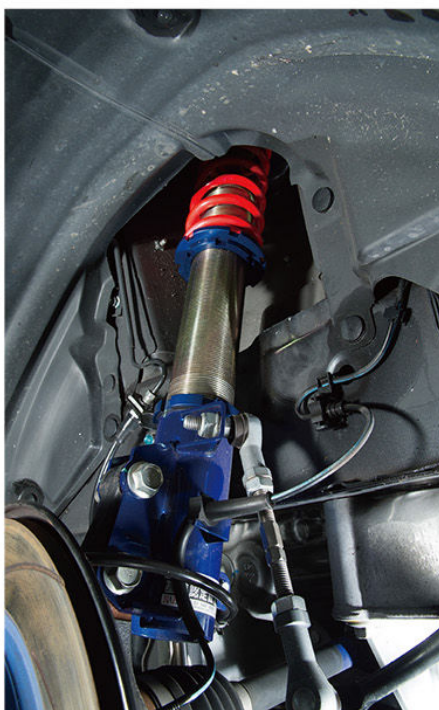
エンドレスと共同開発した車高調。車高を下げながら理想的なストローク量を実現するのが難しく、開発にはかなりの時間がかかったそうだ。リリースは5月上旬。車高調の採用を視野に入れているなら、ぜひ選択肢のひとつに
