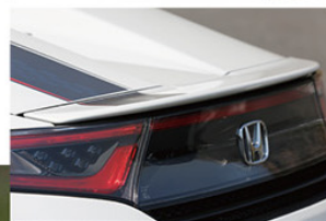
車速連動で上がるアクティブスポイラー。S660のスタイリングを壊さずにリアのダウンフォースを稼ぐため、不要な時は格納できる電動格納式を採用した
