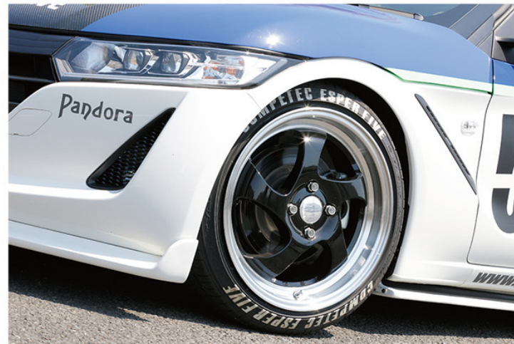
特徴的なスポーク形状を持つオリジナルホイールの「COMPETEC ESPERFIVE」を履く。サイズはフロントが6.5J×16+42、リアは7J×17+45だ
