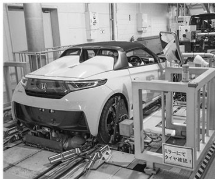
四輪ともストラットサスペンションを採用したS660においては後輪のアライメント調整という作業が増えた。その対応として設備が整えられ、スタッフの技術向上も必要となった。こうした丁寧な工程を経て、一万台以上(2016年4月時)のS660が世に送り出されている。
