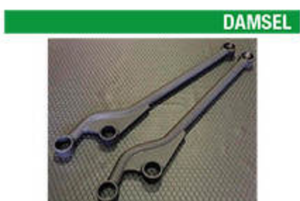
DAMSEL ロイヤルナイフアームリア 23 43 33 クロモリ鋼を使用。レイアウトを工夫し、車高も確保。リフトアップ時のホーシング角度などにも配慮。 ■3万8000円 ■津田レーシング ☎0745-82-7737
