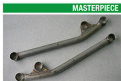
MASTERPIECE トラクションリンクフロント用 23 22 12 43 33 32 純正鋳造アームを上回る断面面積になるように、ステンレス製6mm厚42.7φパイプで製作。キャスター角も補正済み。 ■7万8000円 ■マスターピース ☎078-731-8585
