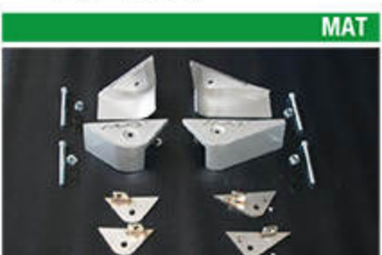
MAT アクティブプレート&アームブラケット 23 サスブラケットを固定プレートとブラケットガードで補強。岩などとのヒットから守る。 ■4万円 ■MAT Service Factory ☎072-890-1221
