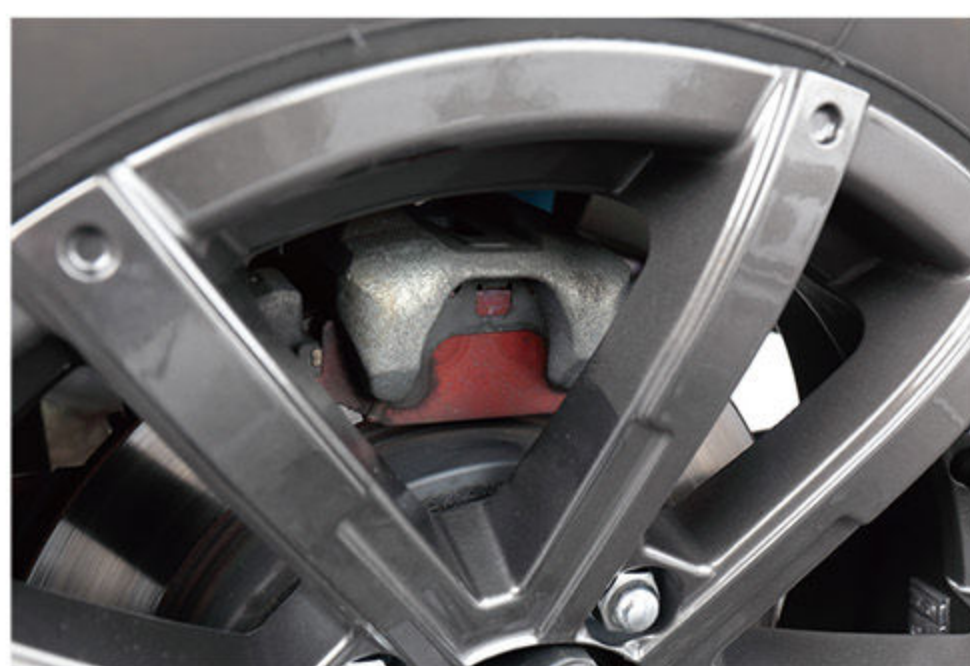
高いストップパワーを発揮する、高メタル配合率の DAMSEL ハイパーブレーキパッド (2万 5000 円)。写真はプロトタイプで、製品版はカラーがブルーになる。
