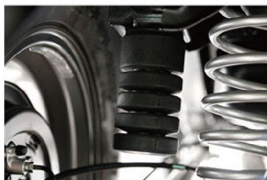
バンブラバーは純正よりも大型化を図り、材質も見直す。全3タイプを用意するが、この車両にはソフトタイプが組み込まれていた。
