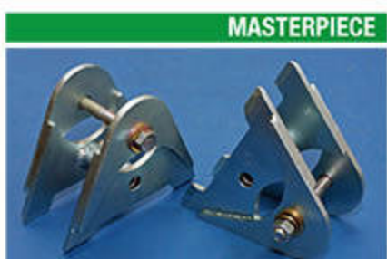
MASTERPIECE リーディングアームダウンブラケット 23 22 12 リーディングアーム取り付けを50mmダウン。アーム角度を適正にし、ステアークスでの跳ね返りを防止できる。 ■2万6000円 ■マスターピース ☎078-731-8585
