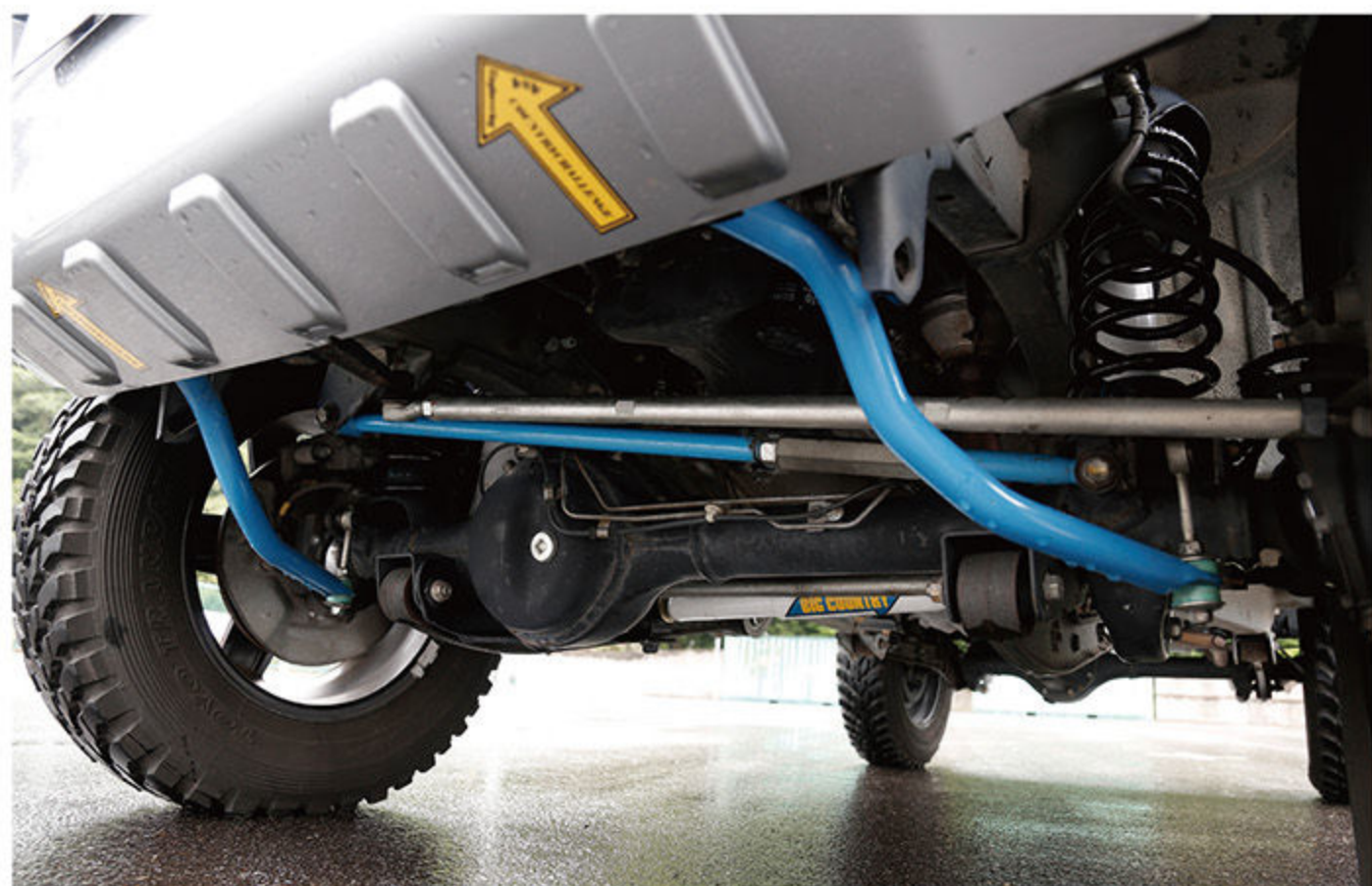
クルージングスタビライザーは中実タイプの採用によって、絶妙な粘り感を演出。適度にロールを抑え、車体を安定させることができるので、とくにオンロードで応答性を高めたい場合のセッティングツールとして有効だ。
