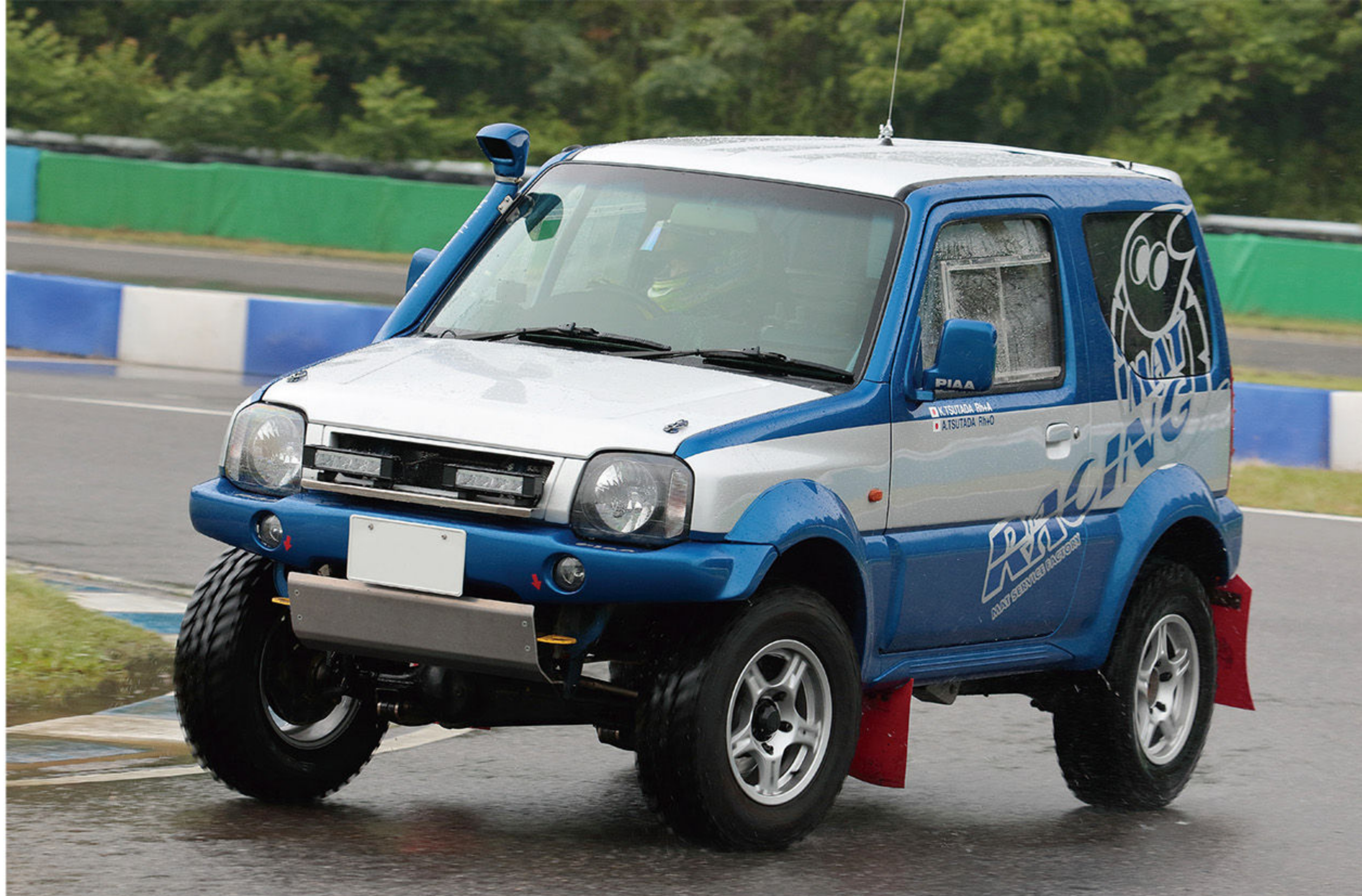
漆黒の闇夜を走破するため、PIAA USAのLED フォグとPIAAのHID ヘッドライトは必需品。また、オルタネーターの負荷を減らすため、テールランプやバックランプなど、LED化を徹底する。
