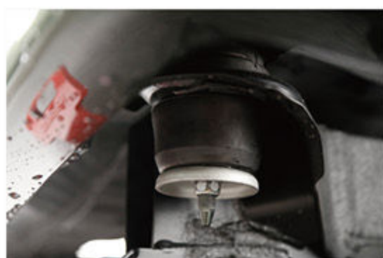
車体とフレームを接合するマウントを強化品に変更。硬度を変えずに形状の見直しでヨレを払拭するので、振動や異音も気にならない。
