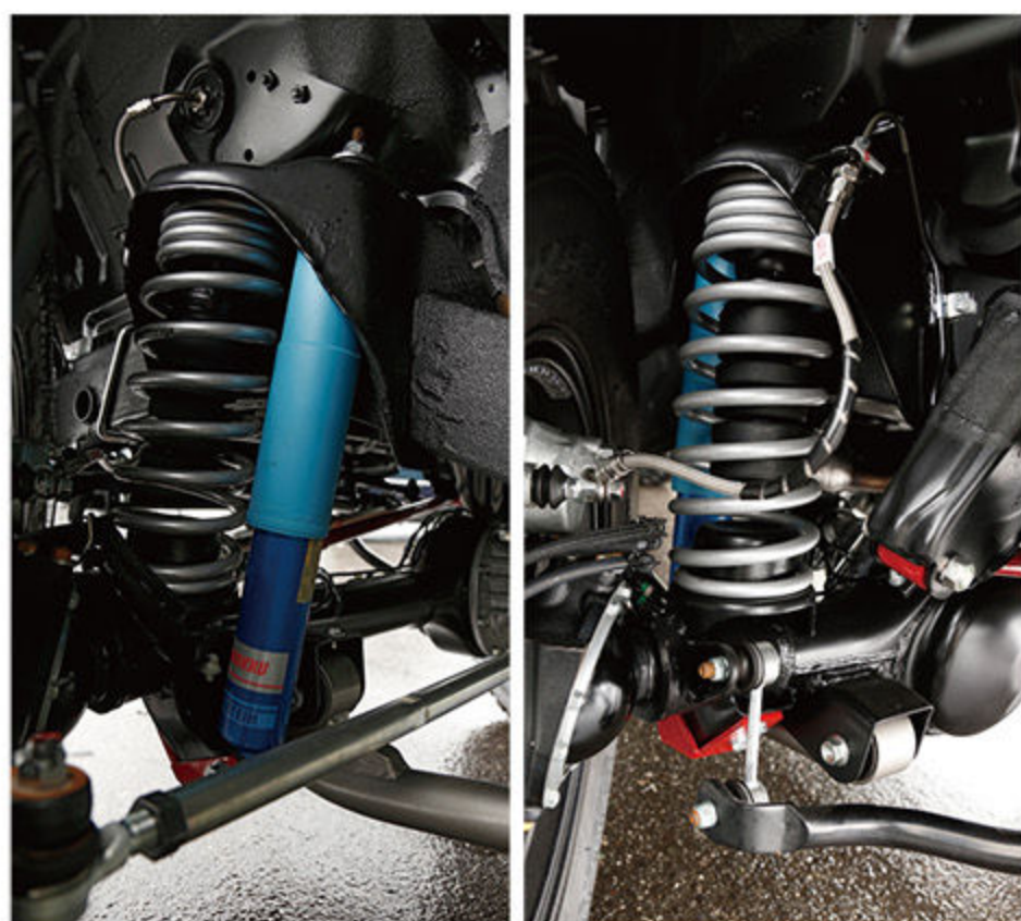
足まわりはオリジナルセッティングのビルシュタインや、60mmアップに設定するSGアジャストコイル、調整式ラテラルロッドなどで構成。基本的に唐突感のない、しなやかな乗り味が特徴で、タウンライドでの快適性を確保しながら、オフロードにも対応できる楽しさを備えた、オールマイティな味付けた。
