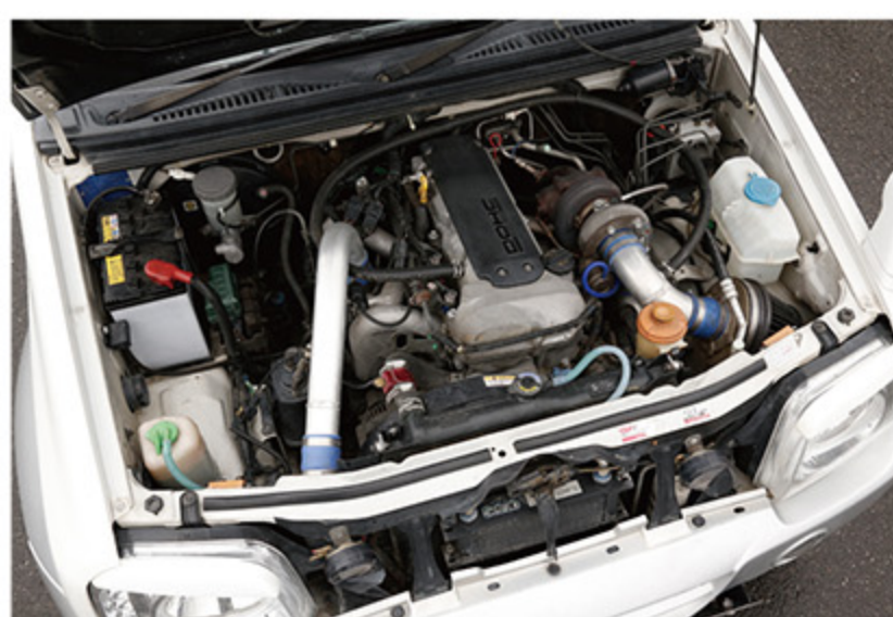
1300ccNAエンジンのトルク不足を補うため、オリジナルターボキットを組み込む。出力はATながら、140psを発生する力持ち。
