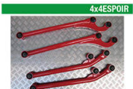
4x4ESPOIR 2〜3インチ補正済み 強化リーディングアーム&リアトレーディングアーム 23 43 33 キャスター補正では補えないハイリフト向け。5〜6インチアップ用も有り。 ■7万9800円 ■4x4エスポワール ☎06-6648-1001
