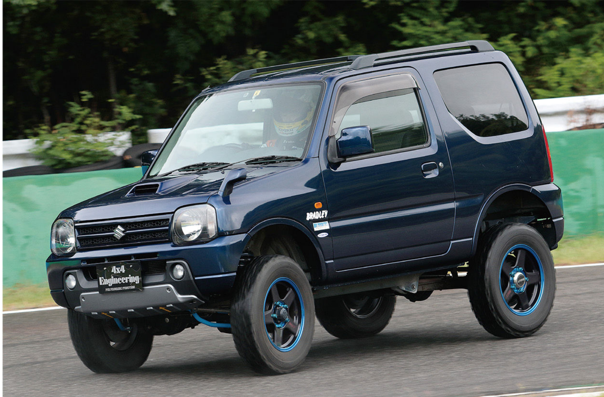
近日発売予定のカントリーサスペンションキットが組み込まれていた JB23W。ダンパー、スプリングともに試作品で、車高は3インチアップに設定されていた。
