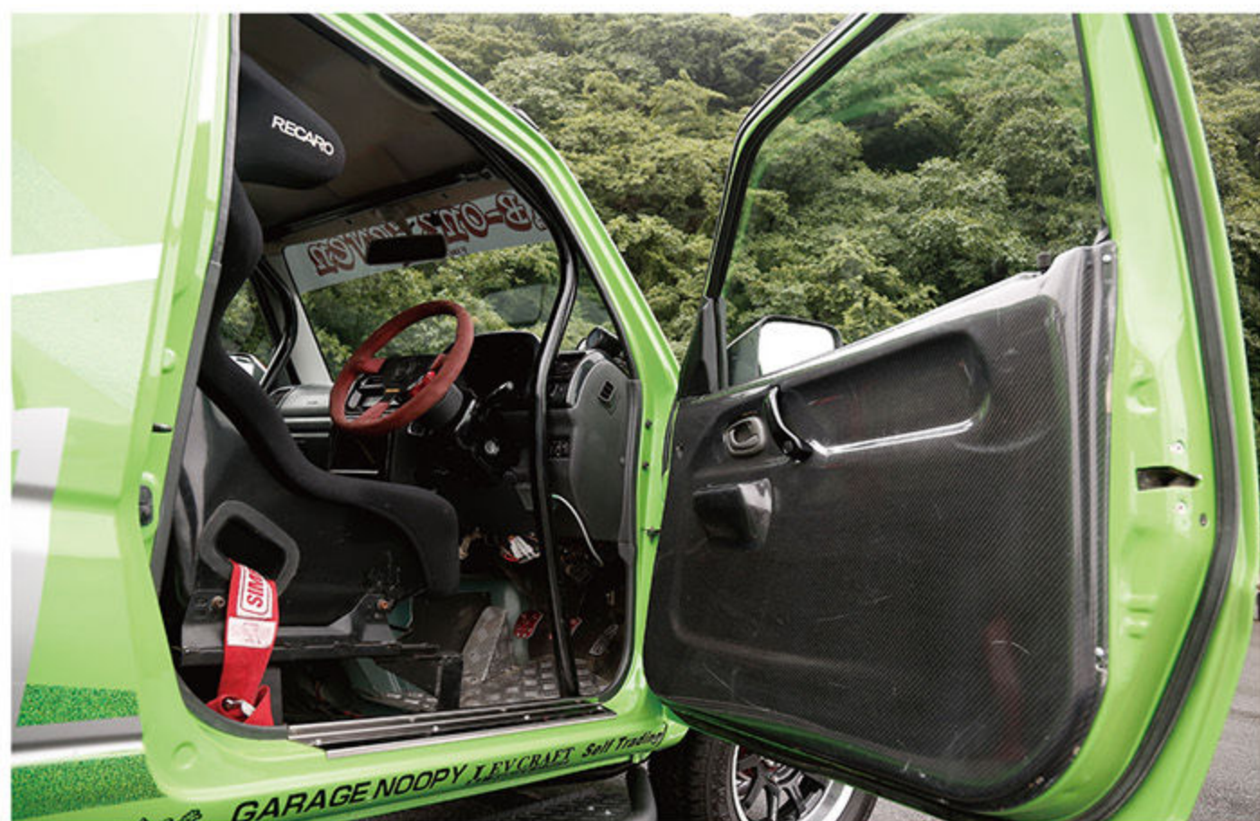
エアロパーツやオーバーフェンダーをオリジナルのFRP仕様とするだけでなく、FRPドアとカーボン内張りまで与え、ボディを軽量化。ロールケージにはハイブリッドファーストの6PタイプFをチョイスした。
