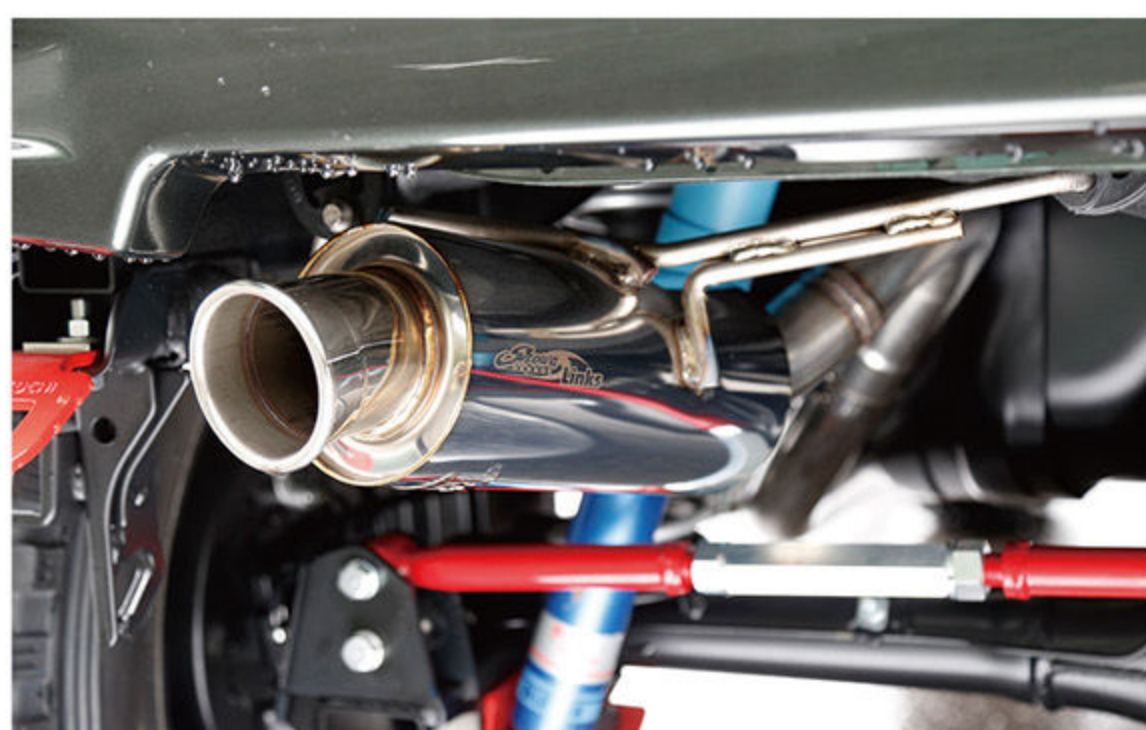
オリジナルマフラーはメインパイプを50φに設定。サイレンサー内部は45-50φのパンチングパイプを使用したストレート構造となっていて、消音材との組み合わせで心地良いサウンドに調整。
