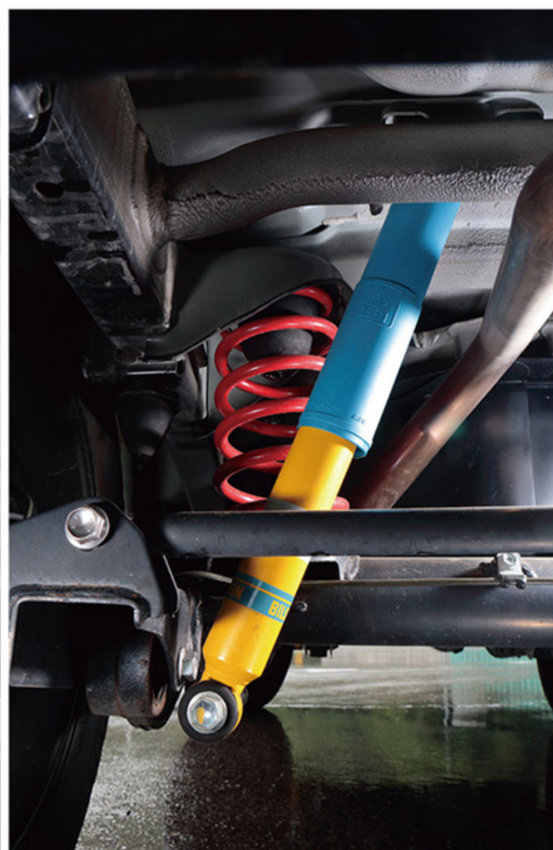
ビルシュタイン製ショックとアイバツハ製コイルスプリングを装着した左がフロント、右がリアのサスペンション。この2アイテムは、それぞれ別々に購入出来るほか、セットにした DAMSEL ユーロサスペンションキットもある（13万5000円（税込）／WEB限定販売）。
