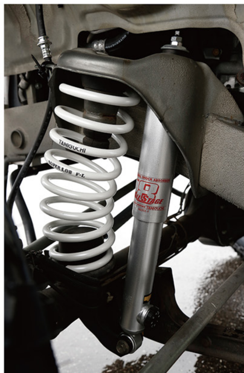
サスペンションには、ショックとスプリングがセットになったオフロードサービス・タニグチ製 JB43 専用スーパーソルブ LOB3 インチアップキットを装着。左がフロントで右がリア。ショックは 8 段階の減衰力調整が可能。抜群の操縦安定性と乗り心地を実現する。
