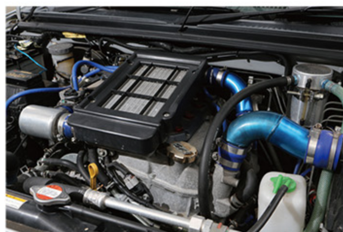
エンジンには、トライフォース製スロットルチャンバーやスズキスポーツ製サクションパイプ、インタークーラーパイプなども装備。パワレスポンスの向上を図っている。
