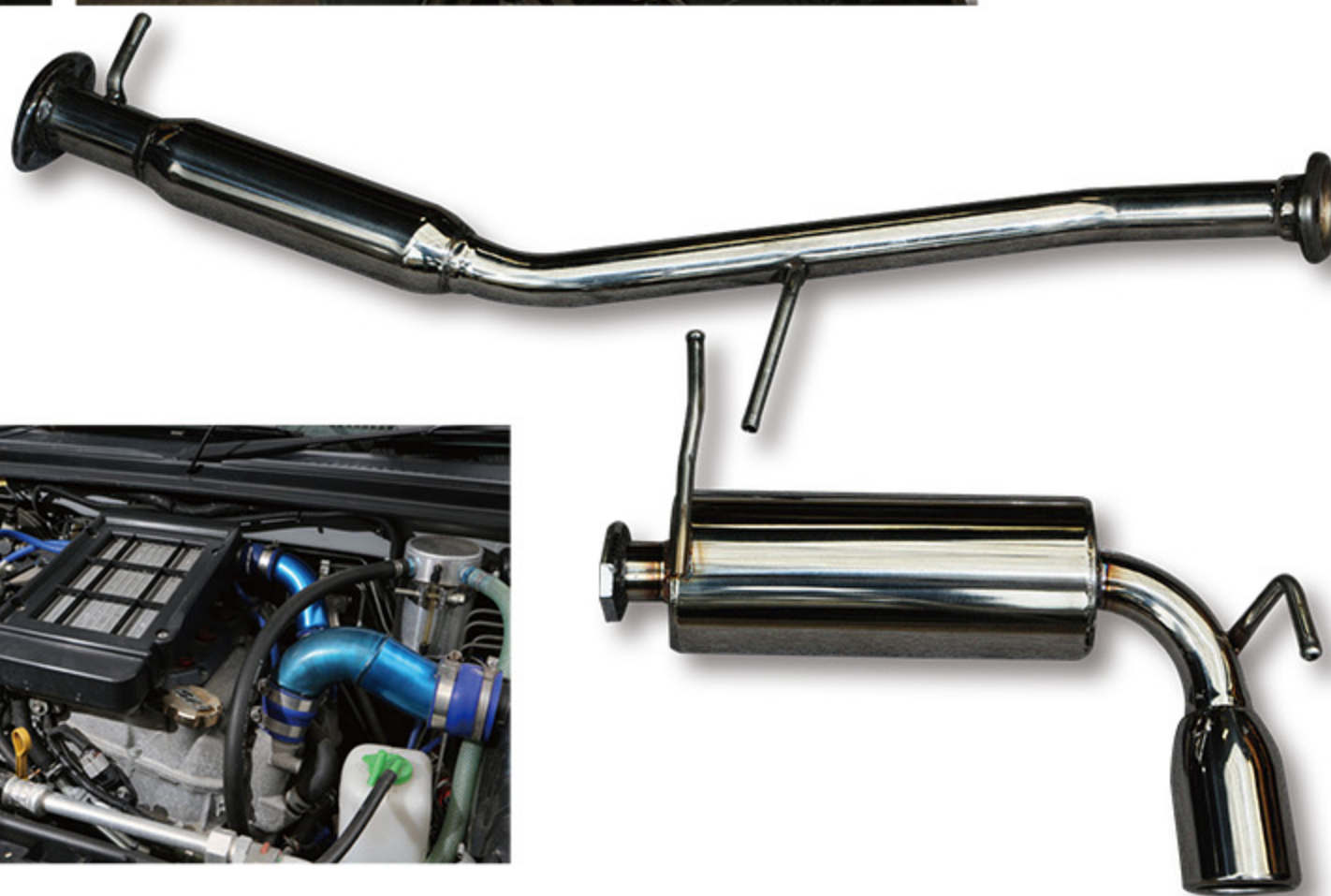
上がフロントマフラーで、下が出口側のフィンマフラー・タイプⅡ(センターパイプは純正流用)。特性は低回転を重視。内部には回転式フィンも装備し、高い排気効率も実現する。
