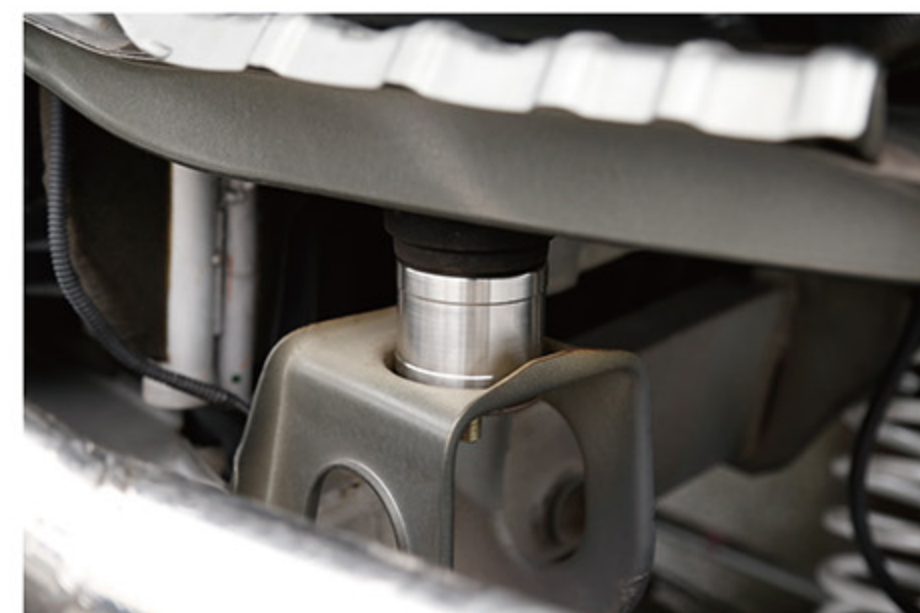
2 インチのボディリフトは、「トップフラッグ」オリジナルのステンレス製ボディブロックを使って行っている。ジムニーシエラの場合は、これを 8 か所にセットする。
