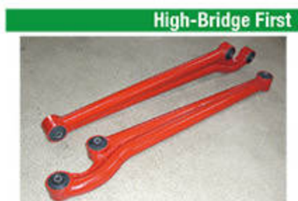
High-Bridge First HB-1stトレーディングアーム 23 22 12 43 33 32 42.7φのダブルパイプで強度に優れる。約2インチ分の角度補正済み。 ■4万4000円 ■ハイブリッジファースト ☎0774-48-1167
