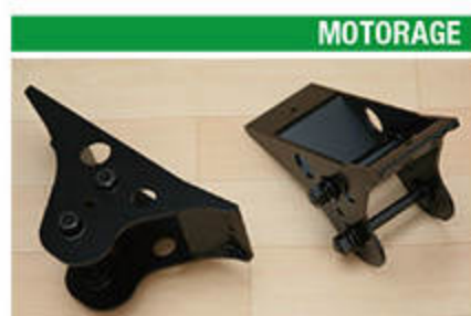
MOTORAGE フロントリーディングアーム オフセットダウンブラケット タイプ2 23 43 33 車体側ピボットを55mmダウン。リフトアップ時のキャスター角を補正。 ■2万8000円 ■モトレージ ☎078-811-2884
