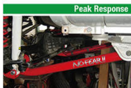
Peak Response リーディングアームJB/JA 23 22 12 43 33 32 フロント用は2インチ〜4インチアップ用各設定あり。リア用はストレート形状でトラクションを向上させる。 ■8万円 ■ピークス ☎059-364-3232
