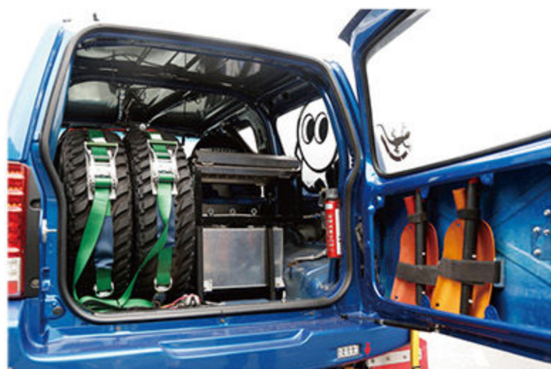
ワンオフのロールバーは車枠に合わせてパイプが構築されている。横転しても車体の形状を維持するのが目的。強固な40φクロモリ鋼パイプが使われ、ルーフにも補強が入っている。
