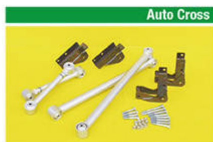
Auto Cross リア5リンクキット 23 22 12 43 33 32 リアの各リンクが自然な動きをし、無理のないストロークを実現。トラクション性能、ショック吸収性が大幅に高まる。 ■11万9000円 ■オートクロス ☎075-972-1522
