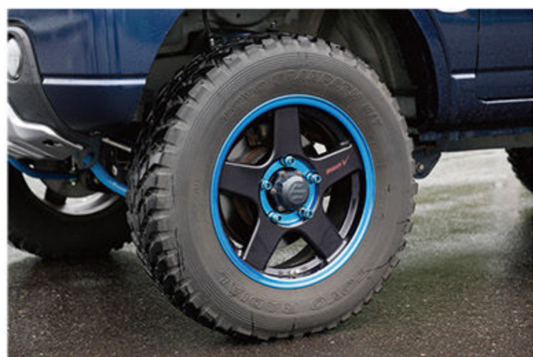
近日発売予定のカントリーサスペンションキットが組み込まれていた JB23W。ダンパー、スプリングともに試作品で、車高は3インチアップに設定されていた。
