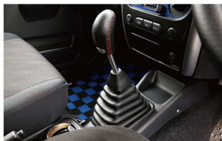
ストロークをノーマルの約半分にしたショートストロークシフト（税込2万520円）。小気味よく正確なシフトチェンジが可能だ。
