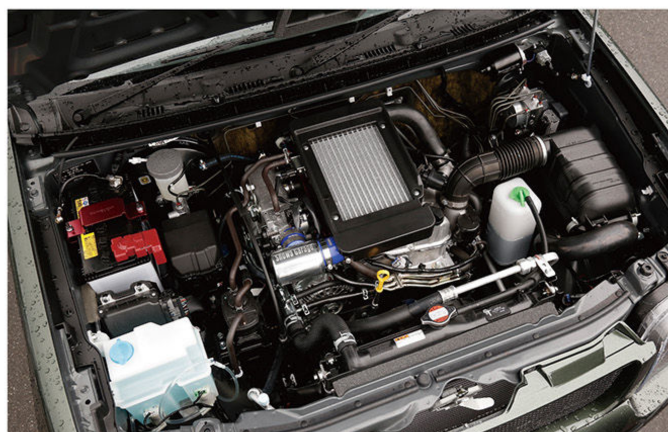
エンジンルーム内ではファンネルスロットルチャンバーの存在が際立つ。大容量のチャンバーを搭載することによってエア溜まりを作り、アクセルオンと同時に大量の空気を送り込む仕組み。レスポンスと瞬発力が格段に向上し、アクセルを踏み込む楽しさを増幅してくれるはず。なお、それ以外は基本的にノーマル。最低限の底上げはなされているので、あとは不満に感じたところを補いながら、じっくり進化と熟成を重ねていくのがいいだろう。
