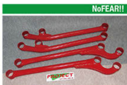
NoFEAR!! リーディングアーム 23 43 33 肉厚5mmで高強度を実現。キャスター角度補正済みで直進安定性も向上。2インチと3インチアップ用あり。 ■3万2400円 ■4WD PROJECT ☎0748-34-7500
