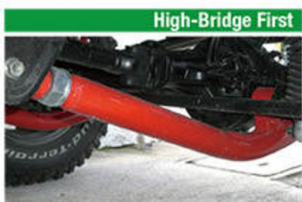
High-Bridge First HB-1st全長調整式リーディングアーム 23 22 12 43 33 32 ホイールベースの調整が可能。 ■5万円 ■ハイブリッジファースト ☎0774-48-1167
