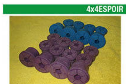
4x4ESPOIR チタン配合カーボンブッシュ 11 硬度60と75の2種類があり、求める性能と部位によって使い分けられる。グリス満つて潤滑性能も確保。 ■6500円 ■4x4エスポワール ☎06-6648-1001
