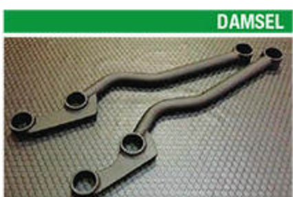
DAMSEL ロイヤルナイフアーム フロント 23 22 12 43 33 リレーロッドの上を通る独自のレイアウトでスキッド性と車高を確保。リフトアップ時のキャスター角も最適化。 ■3万8000円 ■津田レーシング ☎0745-82-7737
