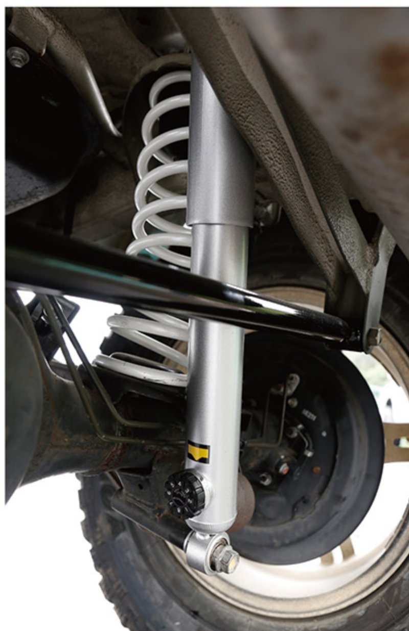
サスペンションには、ショックとスプリングがセットになったオフロードサービス・タニグチ製 JB43 専用スーパーソルブ LOB3 インチアップキットを装着。左がフロントで右がリア。ショックは 8 段階の減衰力調整が可能。抜群の操縦安定性と乗り心地を実現する。
