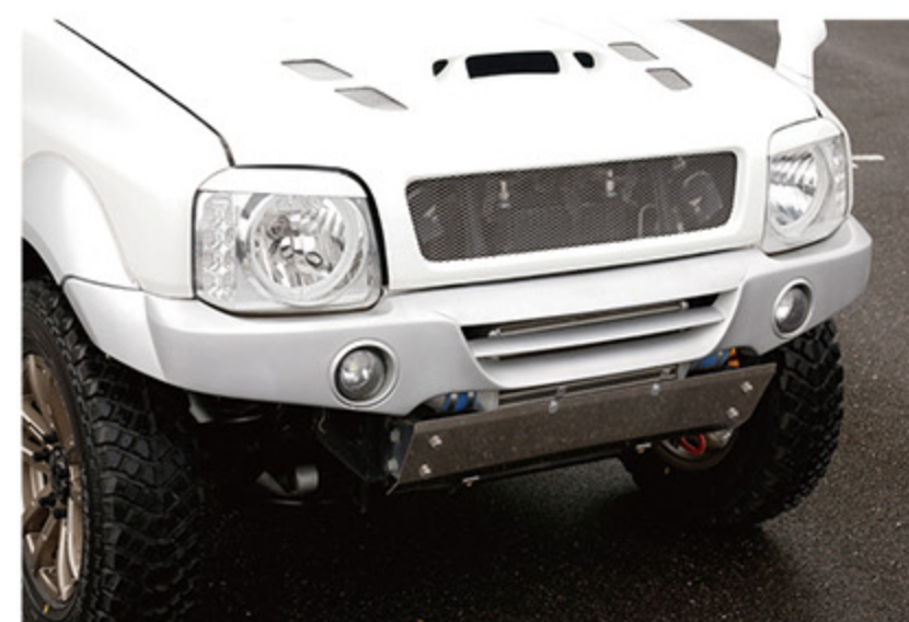
冷却性の向上を狙い、センターに大開口を設けたフロントバンパー。デザイン的にも前方に張り出しが与えられ、アグレッシブだ。
