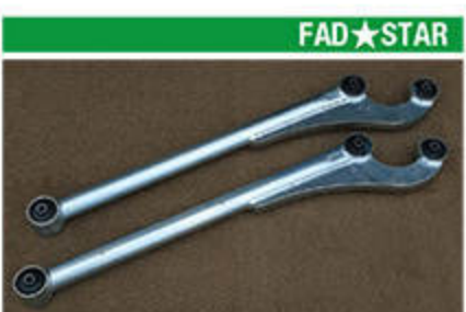
FAD★STAR 強化トレーディングアーム 23 43 33 リフトアップ時にスプリングが弓なりになることを防ぐ角度補正済み。メッキもしくはカラーオーダー可能。 ■4万円 ■ファッドスター ☎0197-66-6996
