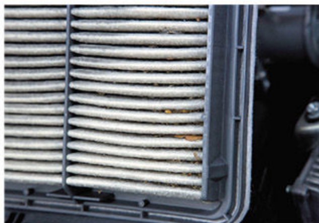
完全ノーマルのクルマに施工しても大きな効果はある。ただ、エアクリナーは新品にしたい。定期的に取り外してはたかという効果的
