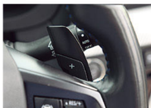
純正にそのまま貼り付けすることができるパドルシフトエクステンション。太く長くなったことで、パドルの操作感が格段にアップする
