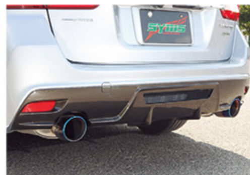
リアタイヤハウス内の空気を抜き、フロア下を流れてきた空気はディフューザー形状で素早く排出。ワゴンボディでの重要な部分だ
