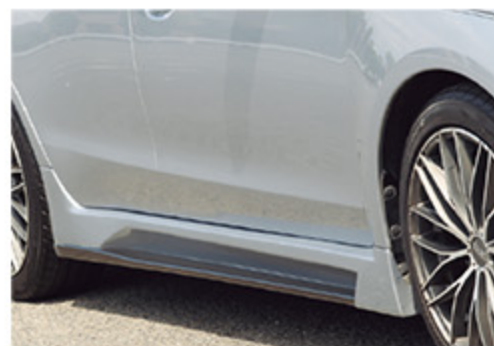
フロア下を流れる空気を乱さないフラットパネルと、タイヤの回転で発生する空気の乱れを整流する造形を組み合わせ。それがレーシーさも実現
