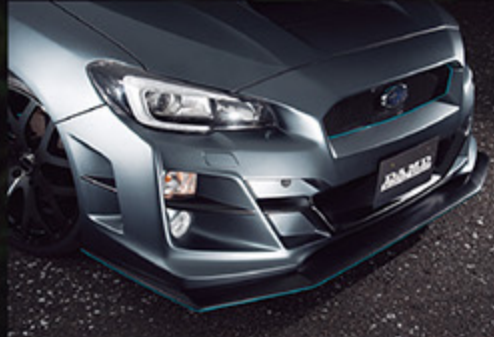
フロントバンパーは、センター左右にウィング形状のフィンを設けた非常に特徴的なデザインが採用されている
