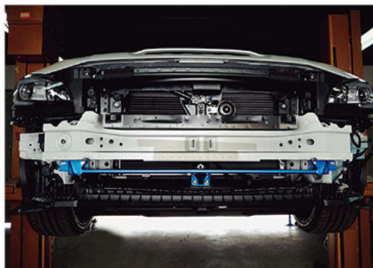
車体先端の左右をつなぐことでボディの歪みを抑制するパワーブレースがフロントメンバー。ハンドリングもよりシャープになる
