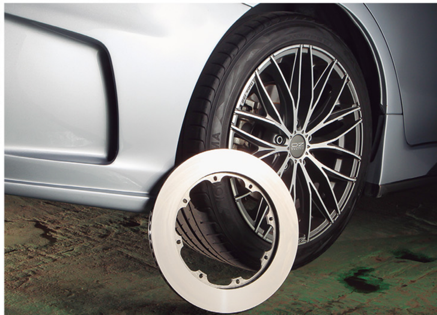
シムスでは現在、レヴォーグ用ブレーキキットを開発中。フロントには対向ピストンキャリパーをセットし、リアはその制動力に合わせてローターを346φへと大径化する予定。リアキャリパーはブラケットを使って移動する
