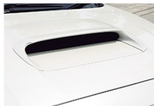
フィッティングや輪郭にこだわって仕上げたエアスクープガイドは、クーリング性能を高めるべく開口角度にも配慮したもの
