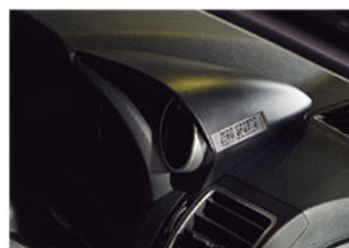
ドライバーの視界を妨げない場所に設置することができる追加メーターフード。60φの追加メーターをビルトインすることが可能
