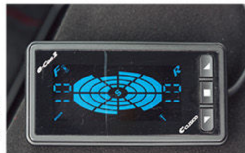
減衰力を車内からボタンひとつで調整できるe-con2。いちいち外に出る煩わしさがなくなり、セッティングがより楽しくなる。メモリー機能も搭載している
