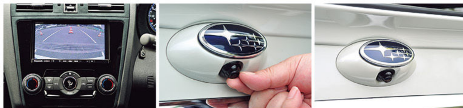
後付けとなるがエンブレムを貼れるスペースがあるエンブレムリアカメラキット。2016年1月に販売が始まったリニューアルモデルは、カメラの角度を手動で調整できるようになった。カメラで映した画像はナビゲーションのモニターに入力している。エンブレムはカメラキットには付属しないので、注意してほしい
