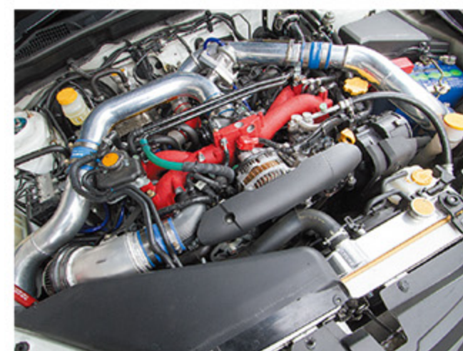
これはオートプロデュースボスが開発、メンテを担当するProdriveのGRBインプレッサ。エンジンは2.5ℓ化してタービンも交換。ワイドボディ込みで公認取得済み。サーキットのタイムアタックで使用していた
