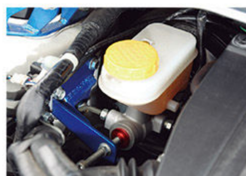
ブレーキをかけたときのバルクヘッドのたわみを抑えるブレーキシリンダー・ストッパー。よりダイレクトなブレーキフィーリングに
