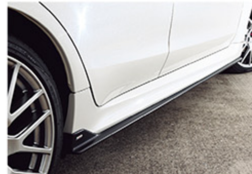
フロントアンダースカートのデザインにマッチするサイドアンダースポイラー。フロントアンダーとの共着で空力性能が向上
