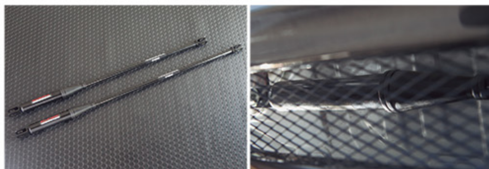
前後バンパー内に装着することで、ボディを適度に締め付け、乗り心地の向上や操縦安定性の向上などを実現。純正サスでも効果大
