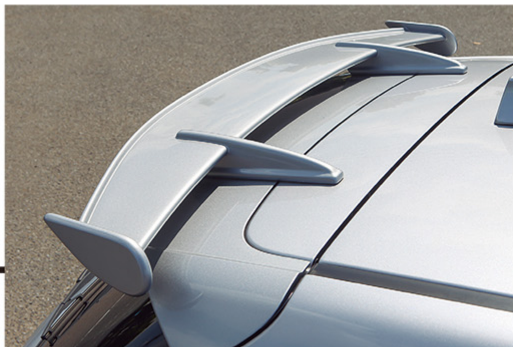
ノーマルボディのウイング部に重ねて装着することで、長いルーフが生み出す揚力を抑えてくれる。控え目なデザインだが装着効果は大
