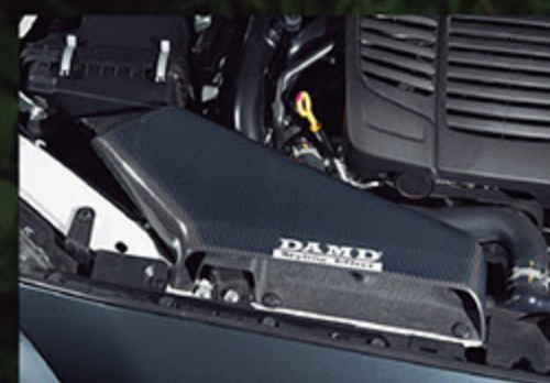
カーボン製のインテークダクトもオリジナルパーツ。純正とリプレイスするだけの設計で、50gの軽量化にも貢献する
