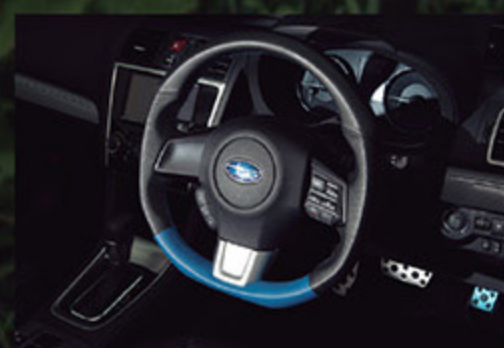
デモカーに装着されたステアリングは、Dシェイプで、高速時のロードインフォメーションを感じられる設計となっている
