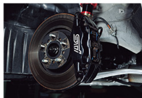
GRBインプレッサのブレンボキット移植で制動力が格段にアップ。EyeSightに影響はないというが、取り付けは要相談
