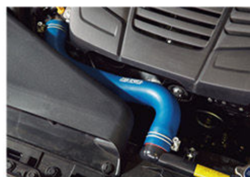
高負荷時や冷却水量増加時でもラジエターホースが変形することなく、冷却水の流れをスムーズに保つことができる
