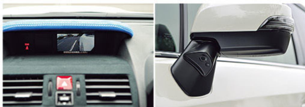
サイドカメラは、ミラーのマウント部分に装着するタイプのカメラになる。カメラは左前輪付近を映し出し、駐車時の死角をなくせる。カメラの画像は、どのモニターにも写せるが、デモカーはマルチファンクションディスプレイに入力している
