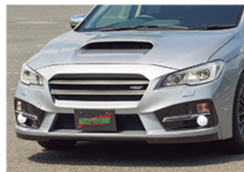
中央下の開口部は鋭く区切られ、冷却風が確実にラジエーターに流れる。グリル部もルーバーとすることで抵抗を減らし風量をアップ
