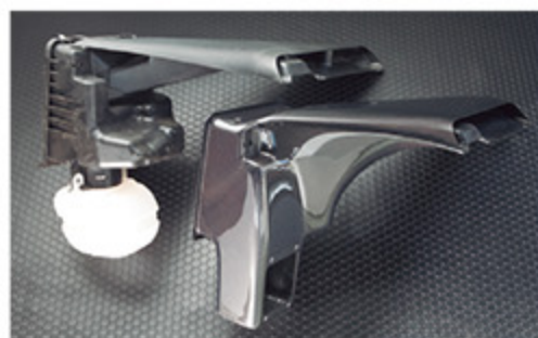
ボンネット直下のダクトのほか、アンダー部のフタを外すことで2方向からの大量吸気が可能に。ベースのボックスは純正を流用する
