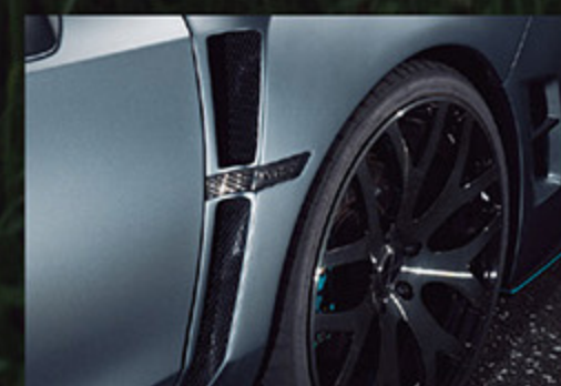
オーバーフェンダー後部にも、排出用のダクトが設けられている。レイズ・WALTZ FORGED S7とのマッチングもいい
