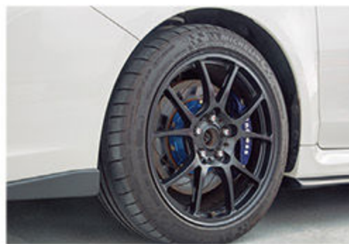
タイヤはミシュランのパイロットスーパースポーツ。サイズは225/45ZR18だ。キャリパーはエンドレスのモノ6スポーツ
