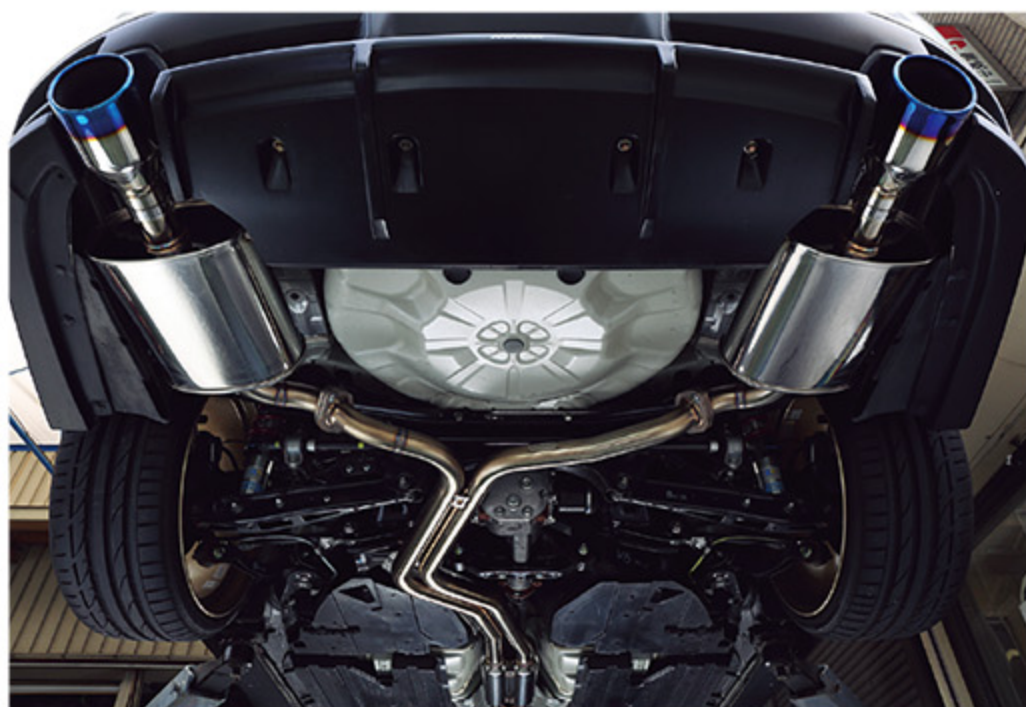
サウンド、ルックス、排気効率にこだわったスベクネオファントムシステムキット。デュアルセンターパイプを採用する
