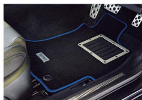
耐摩耗性に優れた特殊化学繊維を採用。純正同様にストッパーホールを設けるほかに、裏面にスパイク加工ラバーマットを使用した
