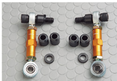
絶対的な強度不足が否めない純正スタビリンク。ピロ圧入式の調整タイプに変更することで、スタビ本来の性能を引き出せる
