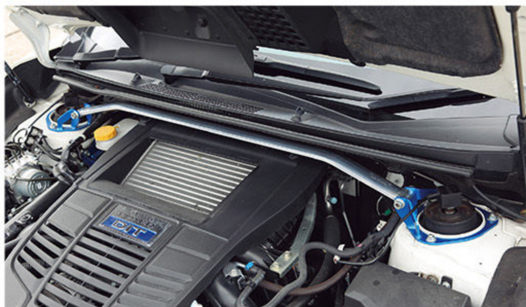
ストラットバーはフロントだけではなくリアにも装着済み。車体のねじれによるサスの機能低下を抑制してくれる。そのほか剛性やハンドリング、車体の一体感など様々な機能向上に寄与する
