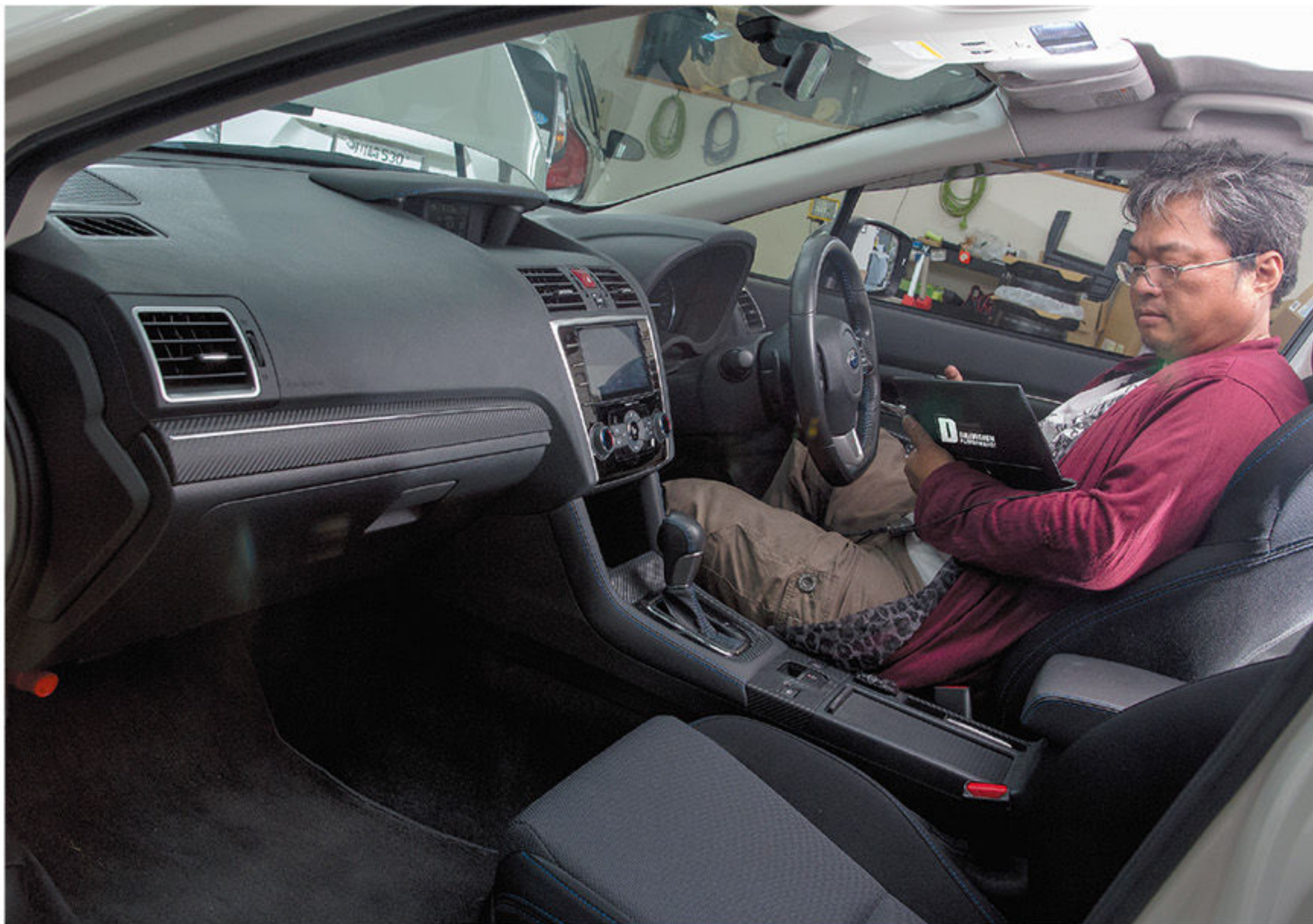
運転席の足元にあるOBDⅡコネクタにPCやタブレットを接続。そこからドライビジョンのデータをECUに書き込む
