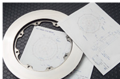
シムスでは現在、レヴォーグ用ブレーキキットを開発中。フロントには対向ピストンキャリパーをセットし、リアはその制動力に合わせてローターを346φへと大径化する予定。リアキャリパーはブラケットを使って移動する
