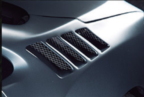
オーバーフェンダーの上部に設けられた4つのダクトはすべて貫通しており、エンジンルームの熱気を排出できる
