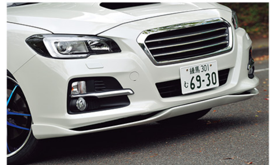
フロント前方とサイドに張り出した形状を持っているフロントリップ。材質はFRP製で、黒ゲルコート仕上げとなっている
