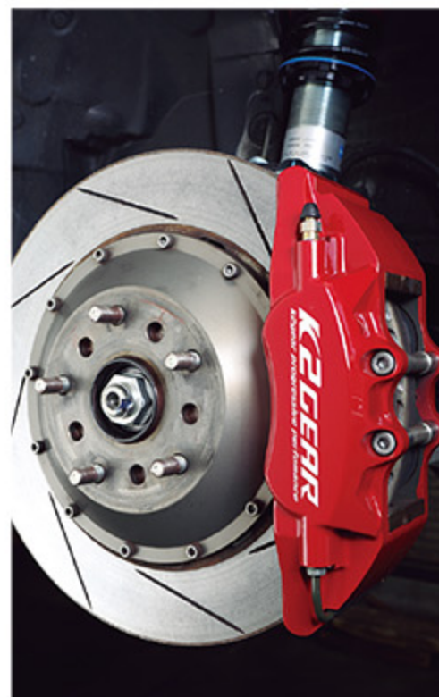
コントロール性と制動力を高めるブレーキシステムはフロントのみの設定。リアとのバランスに配慮してパッドは前後を用意
