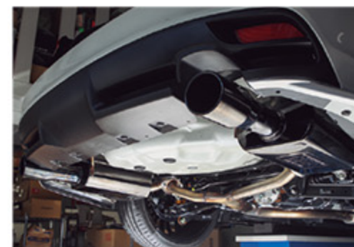
排気効率アップを実現するマフラーは、大型サイレンサー採用によりジェントルなサウンドを奏でる。新保安基準対応品
