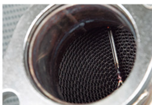
メタルセルを使うことでセルの壁を薄くでき、純正触媒より目を広く作れる。触媒自体も高性能にしている
