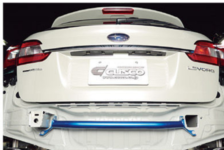
歪みが大きいトランク部分の剛性アップに欠かせないのがリアエンド。経年劣化によるリアまわりのヘタレも防ぐことができる
