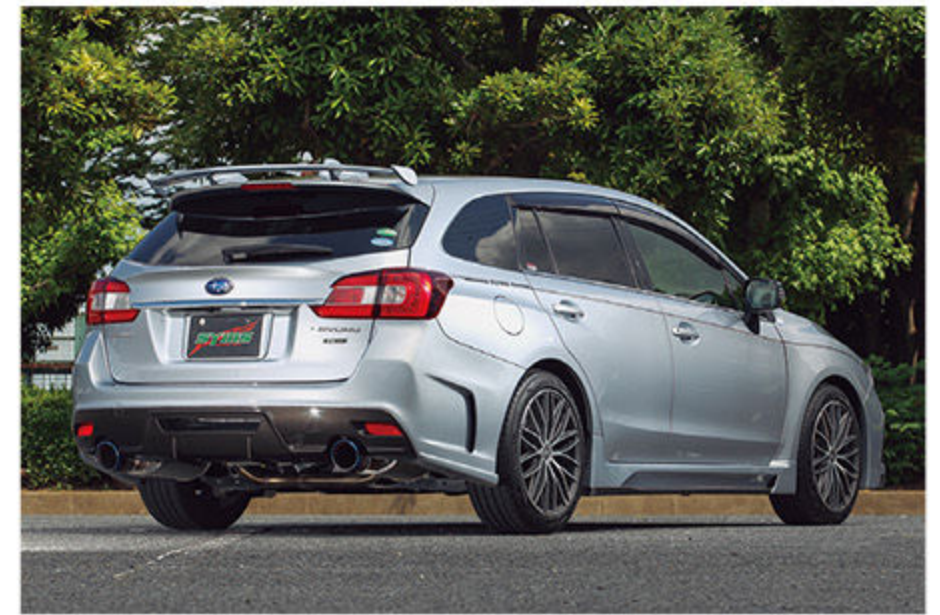
オリジナルのAERO SYSTEMの全パーツを装備することでスポーティさを存分に演出できる。とくにリアまわりの印象が強くなる
