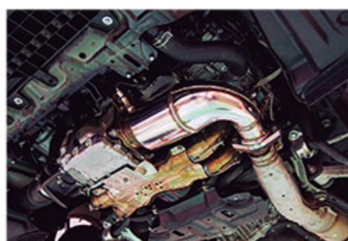
タービン位置的に触媒部は曲がりつきレイアウトになっている。それだけにここでの排気抵抗軽減の効果は大きいものだ
