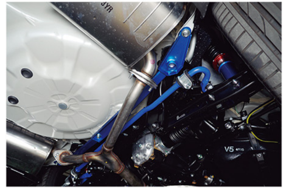
リアスタビライザーの後ろにパワーブレース（リアメンバー）も装着。同時装着で車体のロールを抑えることはもちろん、剛性がアップしていることでトラクションの向上にもつながるアイテムである。なお、すべてのパーツは特別な加工なしにボルトオン装着できるのも優れたポイントだ
