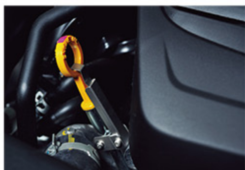
激しい走りをした際に、オイルレベルゲージの抜けを防いでくれるオイルレベルゲージフック。サーキット走行には必需品だ
