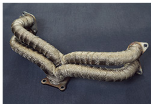
排気効率向上をねらって42.8φで仕立てるEXマニはオーダー時のオプションとしてパッケージ巻き仕様も用意している
