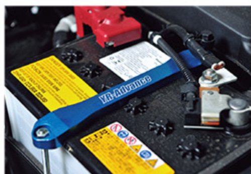
アルミ削り出しのアルマイト加工が施されたバッテリーホルダー。エンジンルームのドレスアップパーツとしてもおすすめ
