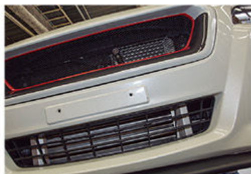
下がエンジンオイルクーラーで、上がCVTクーラー。街乗りでも油温上昇が抑えられるので、低粘度オイルでの安心感も高まる
