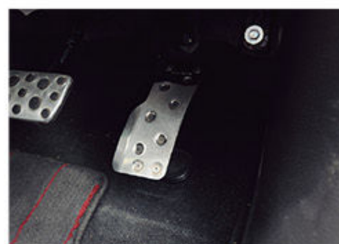
ステンレス鏡面仕上げのスポーツアクセルペダル。手軽なボルトオン装着で、右足のコントロール性が向上。ドレスアップにもなる
