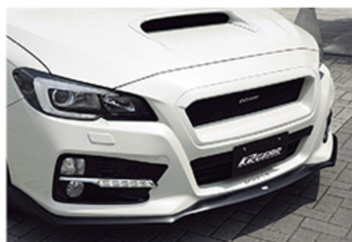
ノーマルをアシストするシンプルデザインで仕上げたフロントリップスポイラー。フロントグリルはタイプⅠが装着されている
