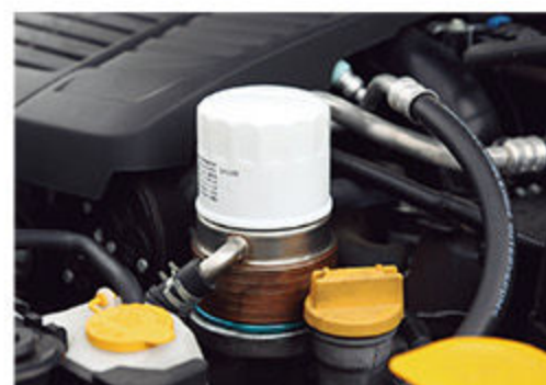
水冷式エンジンオイルクーラーを装備。スポーツ走行や真夏には必須アイテムだ。ラジエーターホースにつないでクーラントを供給する
