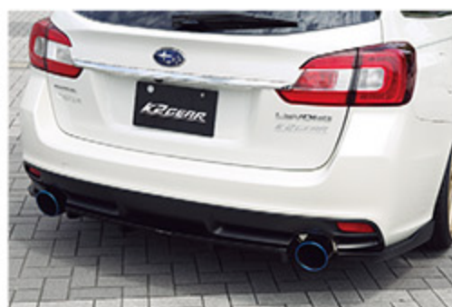
リアビューの印象がスポーティに進化するリアアンダースポイラー。マフラーを避けるように3ピース構成とした
