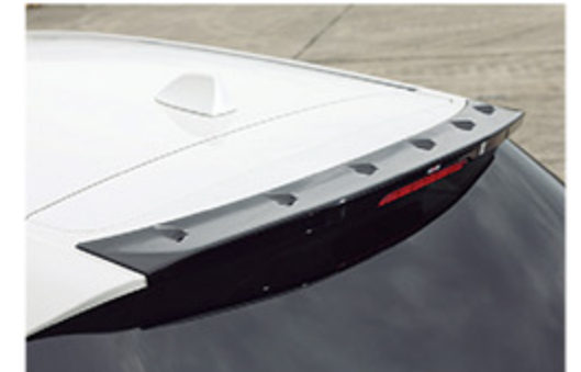
ボルテックスジェネレーターを装備し、ダウンフォースやヨーレート収束の効果が実証されているルーフエンドスポイラー
