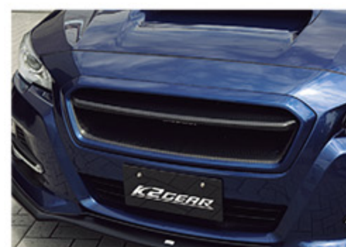
タイプⅠのデザインにルーバーを追加したフロントグリル・タイプⅡ。カーボン&FRPの配置を変えることもできる
