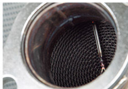
触媒はHKSのメタルキャタライザーを装着している。DELTABOXではこのパーツ装着状態に対応したデータも用意している
