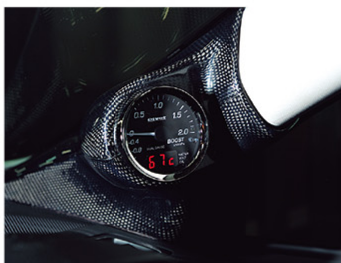
Aピラーカーボンメーターフードにはφ60のメーターを装備できる。今回はPivot製のブースト計と水温がダブルで表示できるタイプの装着する
