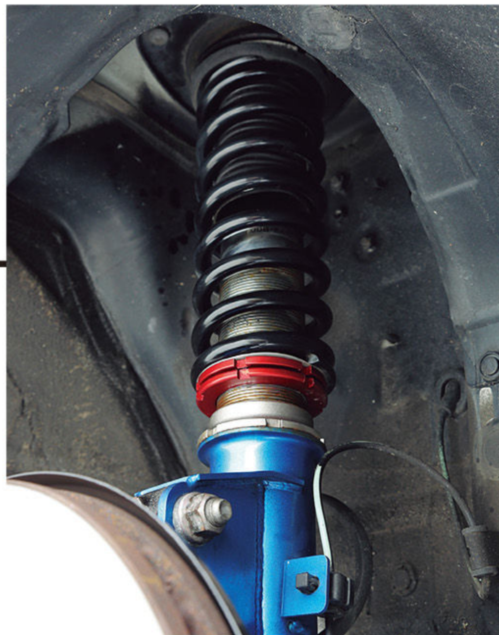
フロントとリアのサスペンションにはSTREET ZERO Aを装着。全長調整式の車高調整キットで減衰力は40段階で調整可能と、幅広いセッティングを試すことができる。ちなみにデモカーはフロントが純正比25mm、リアが30mmダウン。スプリングレートは前後6kg/mmとなっている。減衰力を車内から自動で調整できるe-con2にも対応
