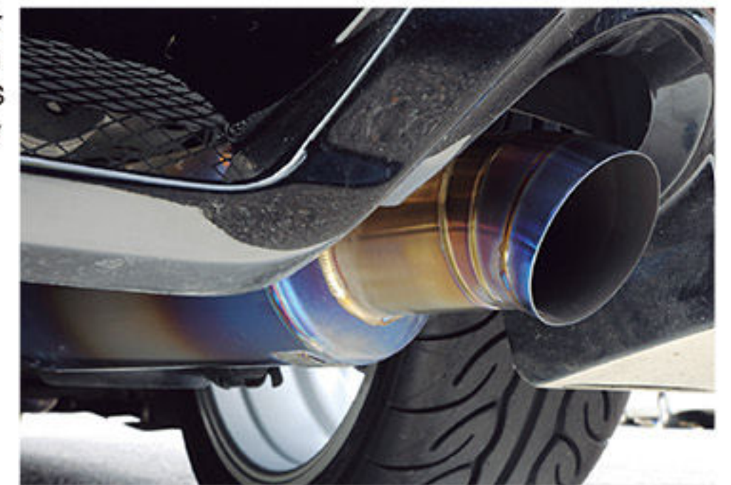
排気系もターボキットに合わせてパイプ径の大きいものをチョイスしている。マフラーはJ'S RACINGのEX-PROで、チタンの見た目のレーシー
