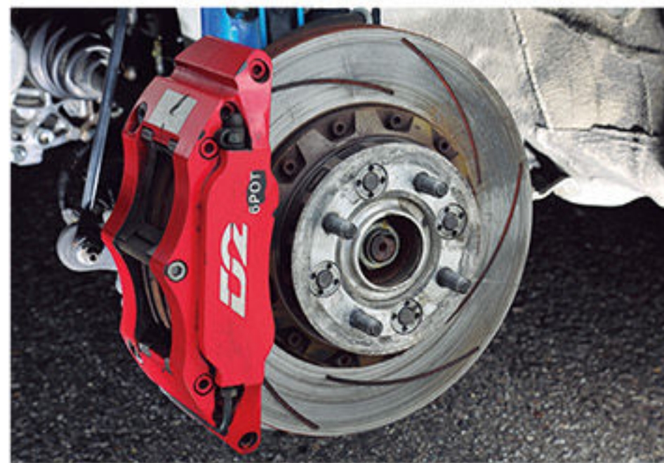
パワーアップに合わせて制動力も引き上げている。フロントキャリパーはD2の6POTを選択。サーキットを連続周回してもタレる心配がないほどの性能
