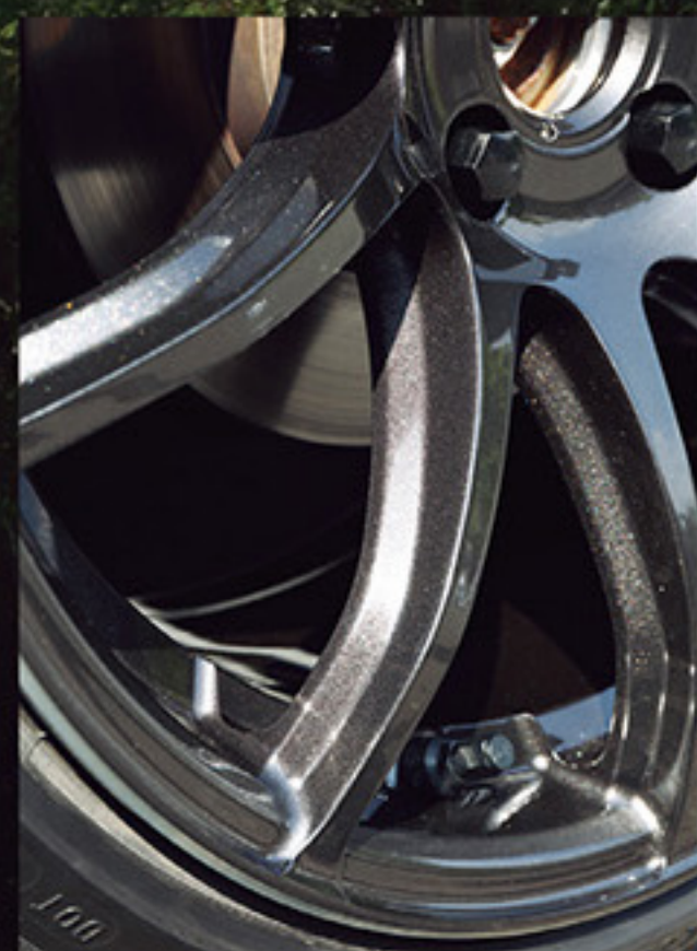
センターへと落とし込んでいくコンケイブライン、スポークとリム接合部裏に設けられたアンダーカットでフィットに不足した奥行き感を演出
