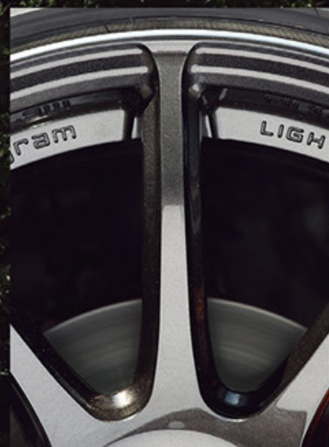
最新の解析技術で生み出されたデルタセクションスポークは足長感をアピールするスリムさを放ちつつ、軽量かつ高剛性を誇る
