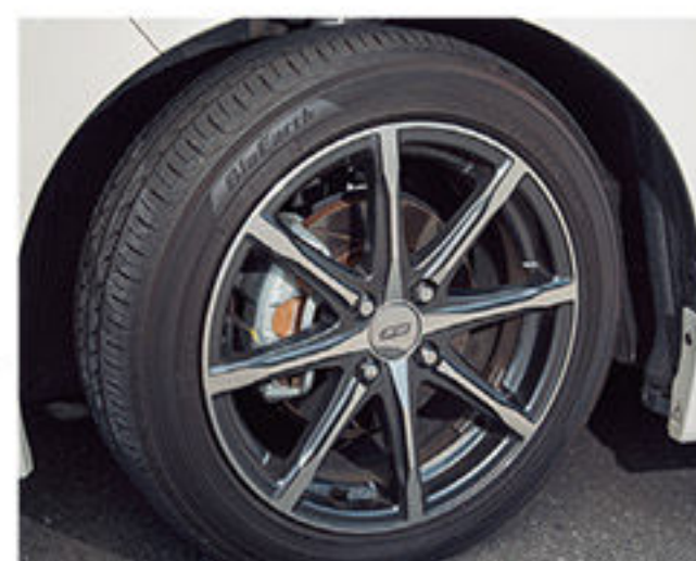
16×6.5J、インセット50のオリジナルホイールを装着。足まわりはHV専用セッティングとなり、乗り心地も上質に。また、ブレーキもパッドとホースを変更し、ペダルタッチを向上
