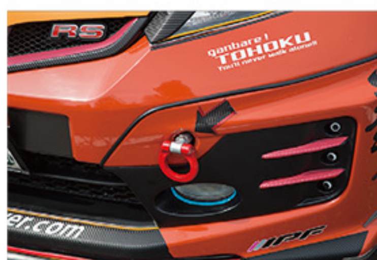
フックも実際に牽引用として使えるものとファッション用がある。付けっぱなしやサーキットに行くなら牽引用を選ぶのが決まり
