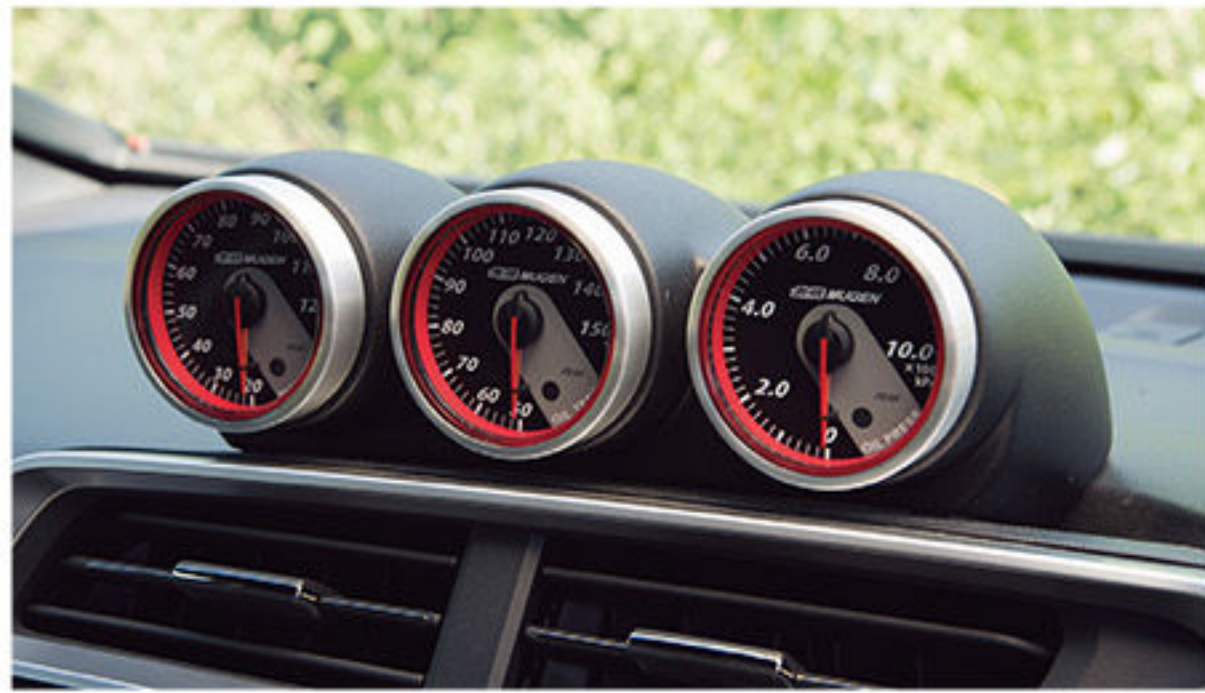
インテリアにもマッチするように、イルミネーションもメインのメーターと合わせられる3連メーター。ピークホールドやワーニング機能も備えている
