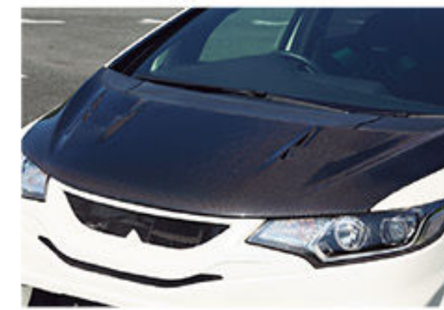
軽量化とドレスアップを両立するカーボンボンネット。サーキット走行でも変形しない強度を確保している。ダクトにはレインレールも設置されている
