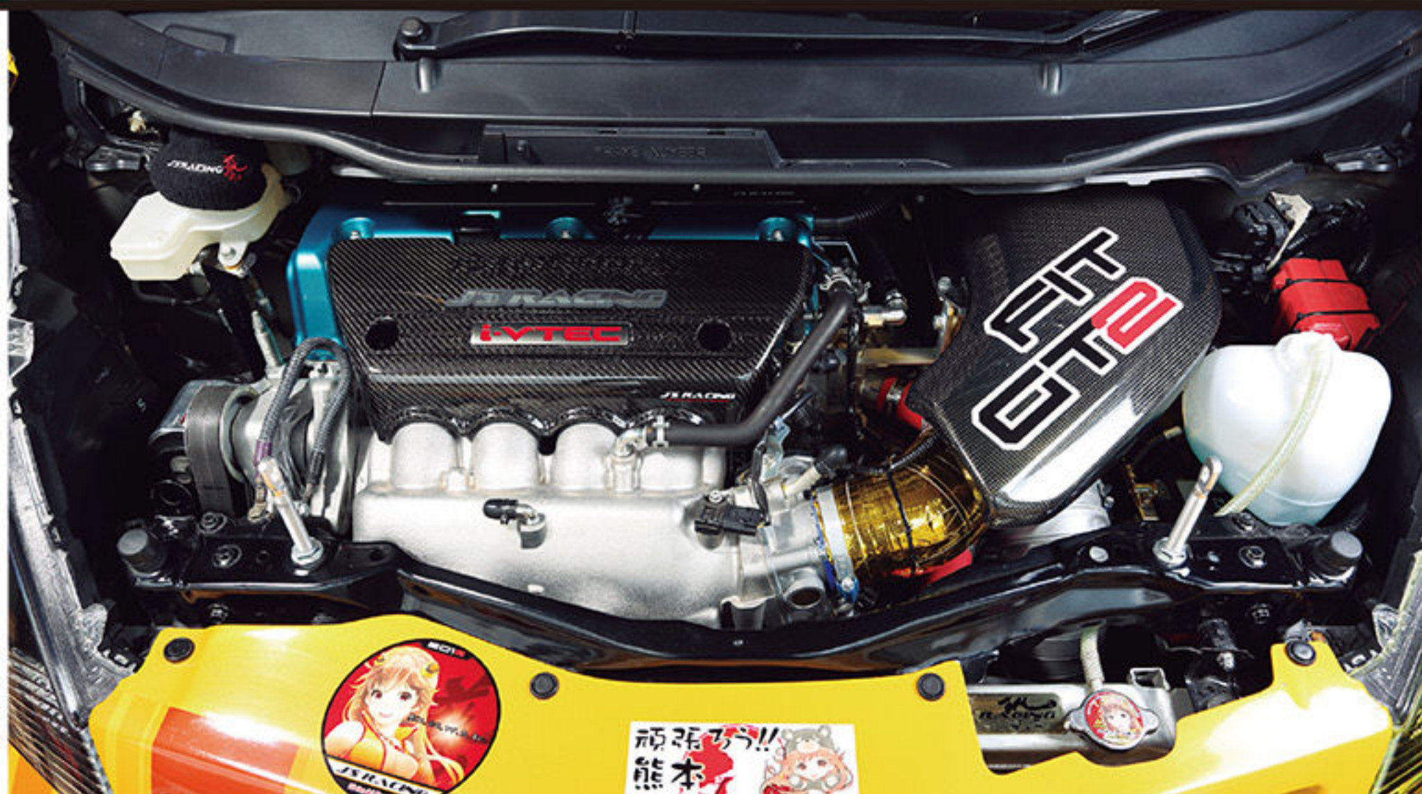
エンジンとトランスミッションは、FD2に搭載されるパワートレインを流用。最高出力は261psで、最大トルクは26.0kgmを発揮するという
