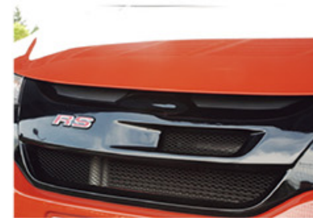
フィットで重要になるのが熱対策。特に吸気温度の上昇を抑えたいので、グリルにはフレッシュエア導入用ダクトを設置（吸気ダクトに連結）
