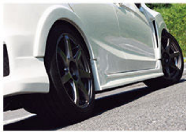
フロントワイドフェンダーはアウトレットダクト付きで一体交換タイプ。リアフェンダーは貼り付けタイプだ。これでタイヤのワイド化にも対応できる
