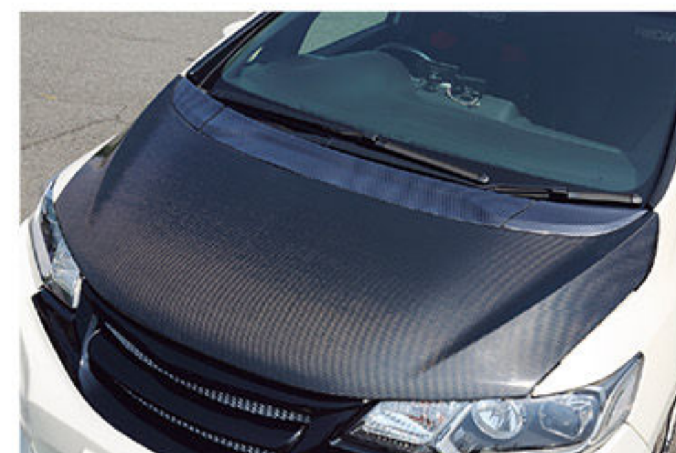
オリジナルのカーボンボンネットは、平織りと綾織りの2タイプを用意。どちらもスポーティなルックスと織り目の美しさが特徴のアイテムとなる
