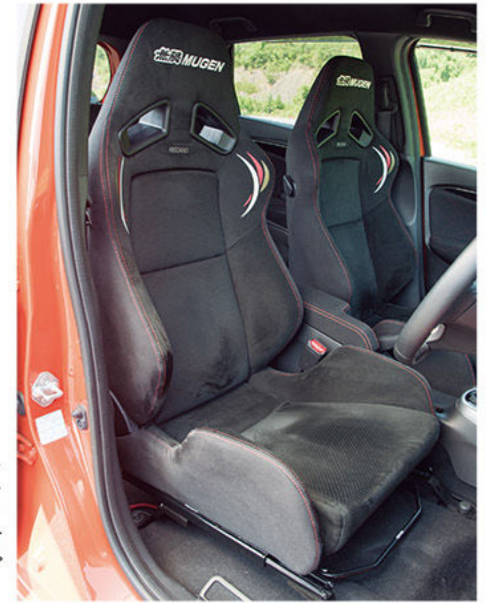
ホールド性と快適性を両立したセミバケットタイプのシートは、レカロ社製ベース。リクライニングすることも可能。他にフルバケットタイプも準備する
