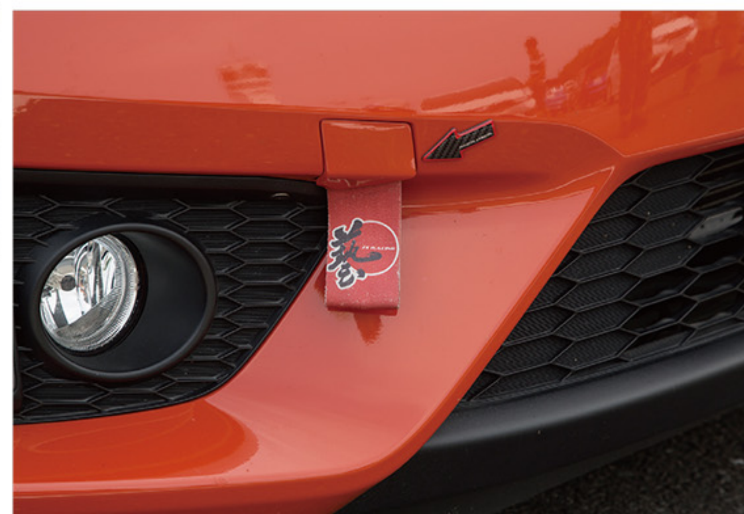
アルミ製フックはファッションアイテム。実際の牽引には適さないなので、牽引するような機会に遭遇した場合は外しておこう
