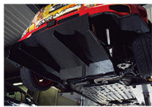
リアアンダーを覗くと、フロント方向へ伸びる大型のディフューザーが確認できる。フロア下を整流しダウンフォースを確保する
