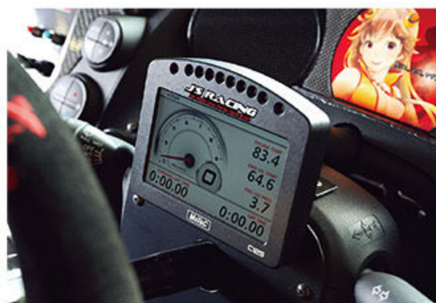
コクピットはシンプルな作りとなっている。運転席から見えるのはMoTecのカラーディスプレイロガーキットだけ。すべての情報が一括で確認できる
