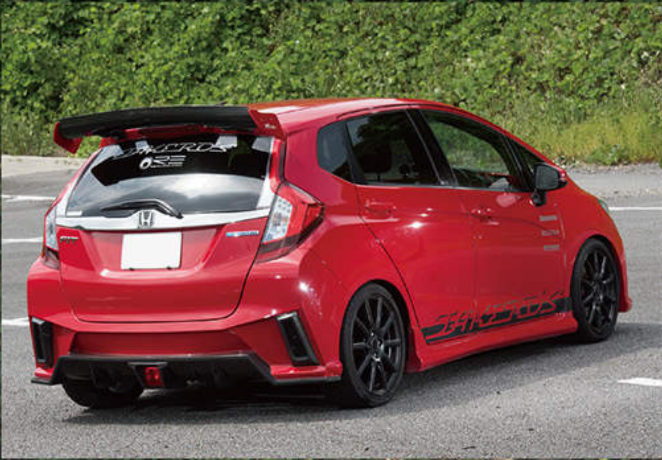
オリジナルのリアウイングには、ウイング後端上部に付け加えるガーニーフラップも用意されている。さらに強力なダウンフォースを得ることができるのだ
