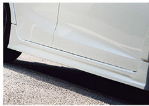
前後のバンパーと同じイメージでデザインされたサイドステップ。ただし純正サイドステップの取り付け位置に準じているので、単独での装着も可能だ
