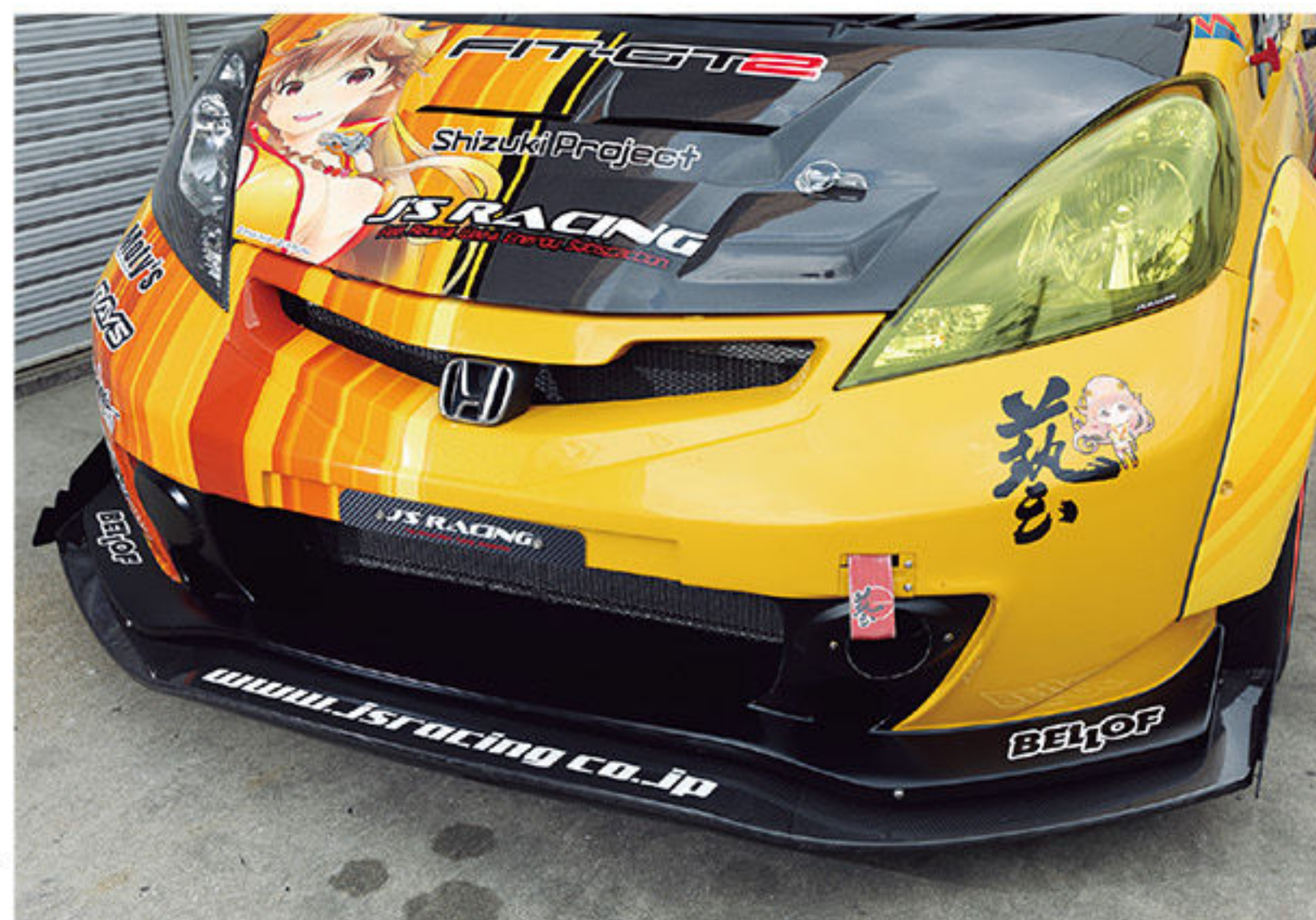
ボンネットやフロントバンパーも自社製のオリジナルパーツを装着。前方に延長しているフロントアンダー部分はワンオフで製作したタイムアタック用
