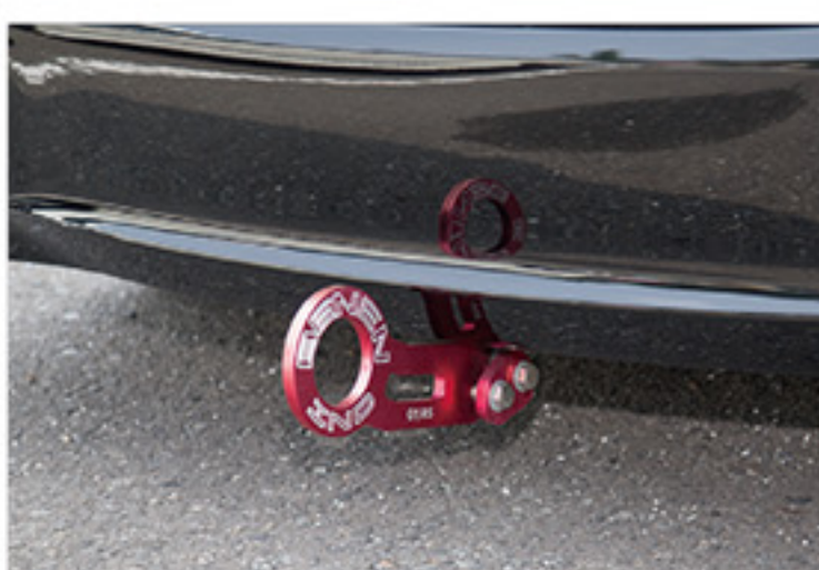
アルミ製フックはファッションアイテム。実際の牽引には適さないなので、牽引するような機会に遭遇した場合は外しておこう
