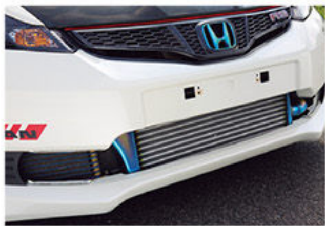
フロントの開口部からは、ターボマシンの象徴となるインタークーラーが顔を覗かせている。エアロは無制限で、ワンオフ加工を施す
