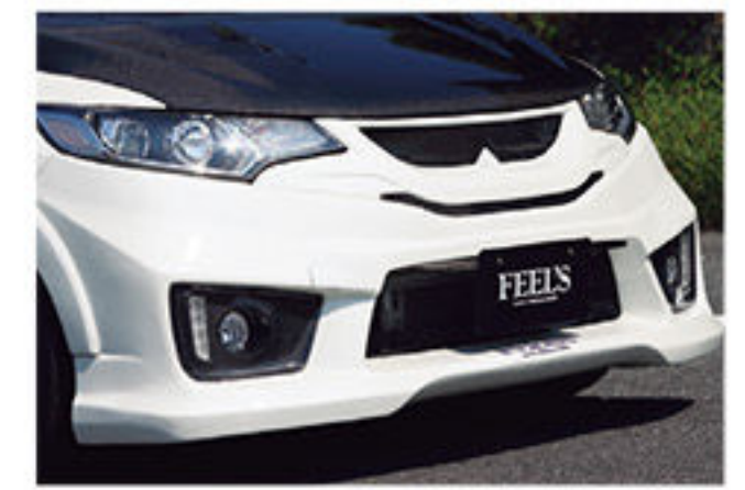
フロントバンパーはリップ部にポリウレームを持たせた独特の形状だ。冷却性能向上を最優先するために開口部を大きくし、グリルは一体式となっている
