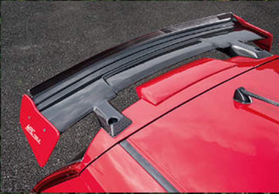
オリジナルのリアウイングには、ウイング後端上部に付け加えるガーニーフラップも用意されている。さらに強力なダウンフォースを得ることができるのだ
