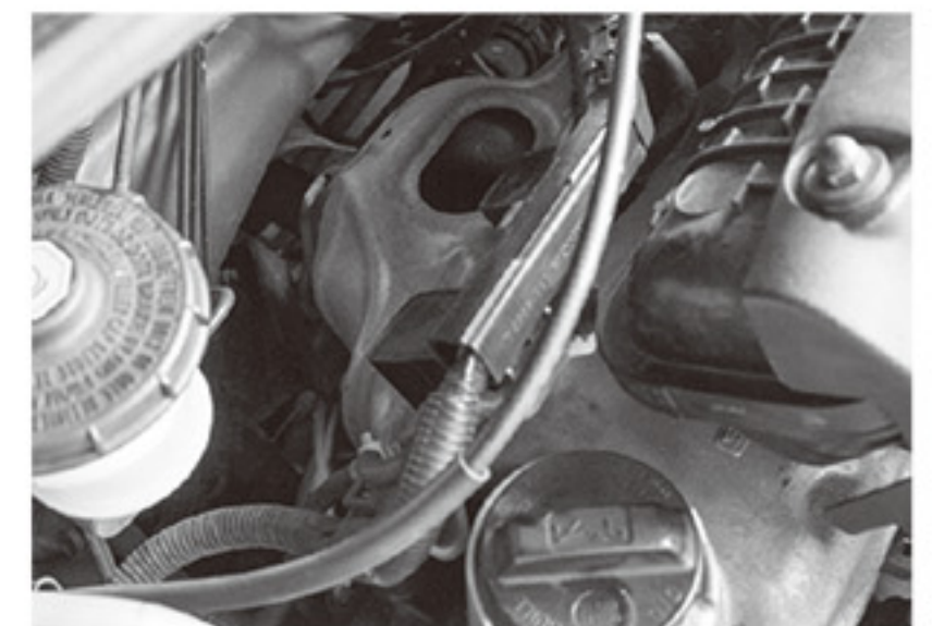
L15Aはエンジンの後ろ側にプラグとコイルがあるため熱の影響を受けやすい。プラグの交換歴が不明なら、この機会に新品にしておくといい
