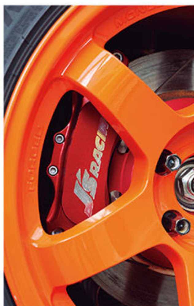
ブレーキはフロントにオリジナルの6POTを装着し制動力を高めた。足まわりは、オリジナルサスペンションをタイムアタック用に改良している
