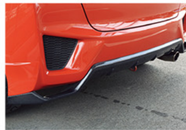
リアアンダースポイラーはディフューザー形状のカーボンタイプ。マフラーはシーカーのオリジナルで、中高回転域での乾いたサウンドが特徴だ
