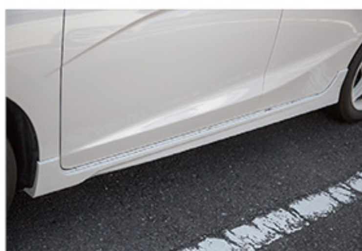
サイドステップはRS用。サイドシル面は両面テープで固定。両サイドのみネジ止め。このパーツを付けるだけで見栄えは変わる
