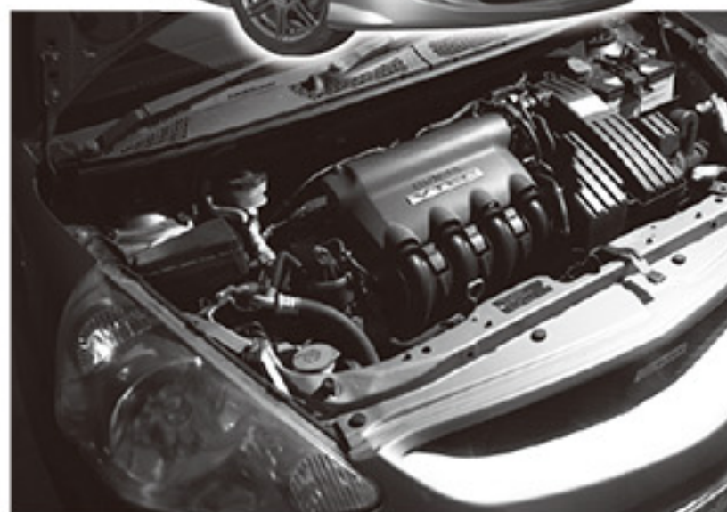
1.3ℓはツインプラグ仕様なのでプラグは8本使う。それだけに数本不調でも走ってしまうので、コイルにリークが起こっていることが結構ある
