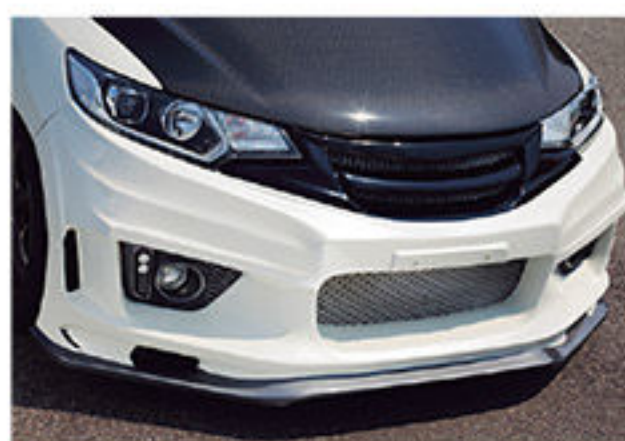
アンダー部分のディフューザなど複雑な造形で作り上げられたフロントバンパー。開口部を多く用いることで、冷却効果にも優れている
