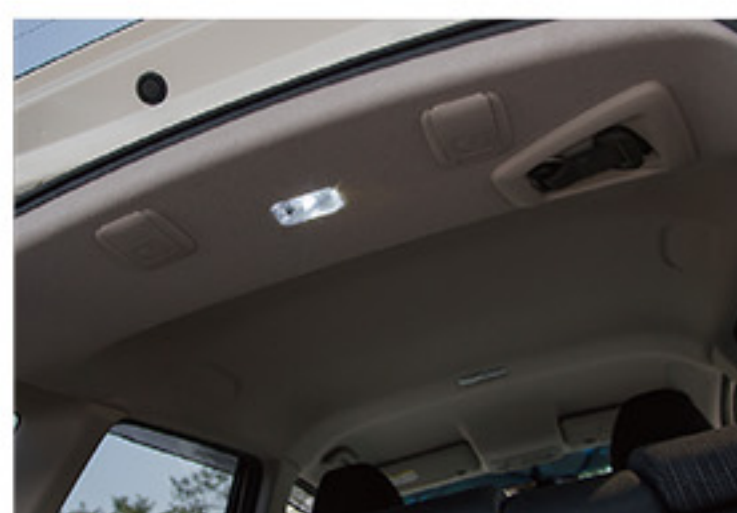
DIYでトランク天井にランプを設置。上から照らすので荷物が入っていても手元が明るいという。使用したランプはストリーム用だ
