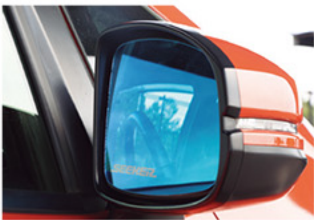
距離感を大きく変えることなく、視野を約2倍に広げたワイドミラー。防眩加工が施され、ブルー仕上げの鏡面だが夜間でも高い視認性を確保する
