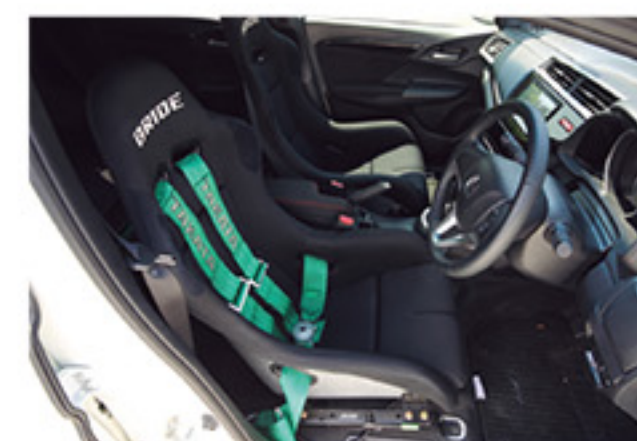
サーキット走行用にブリッドのフルバケットシートとタカタの4点ハーネスを装備。それ以外はいったってノーマル然としている
