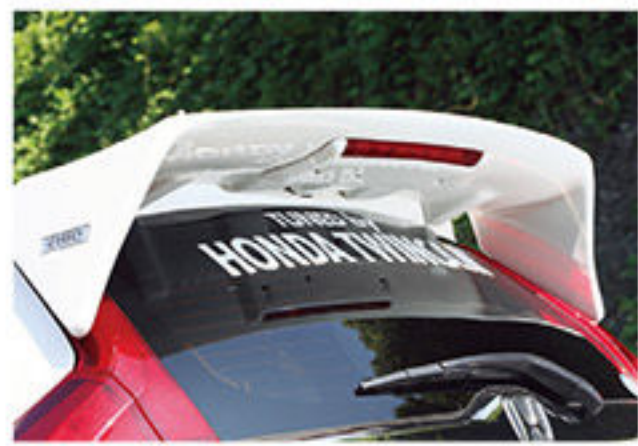
リアウイングはテールランプのデザインをモチーフにした大型タイプ。ハイマウントストップランプは純正のリアスポイラーから移設して装着する
