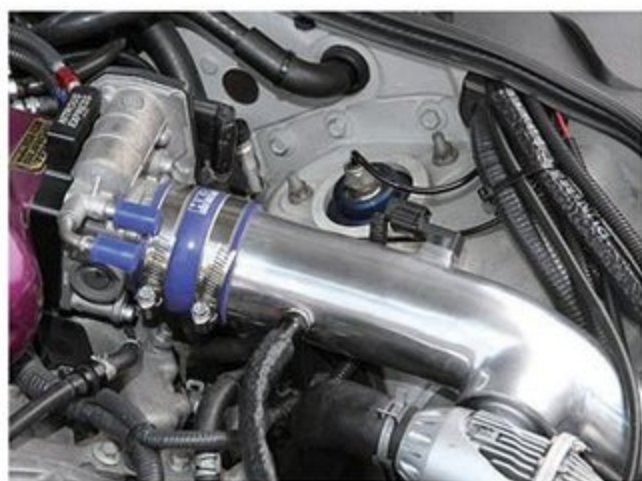
アメリカのドラッグマシンなどに使用されることが多いウォーターインジェクション。アルコールと水を50:50の割合で混合し、ミスト状にしてサクションパイプ内に噴射する。これにより吸気温度が下がり、ノッキングの抑制に繋がる。
