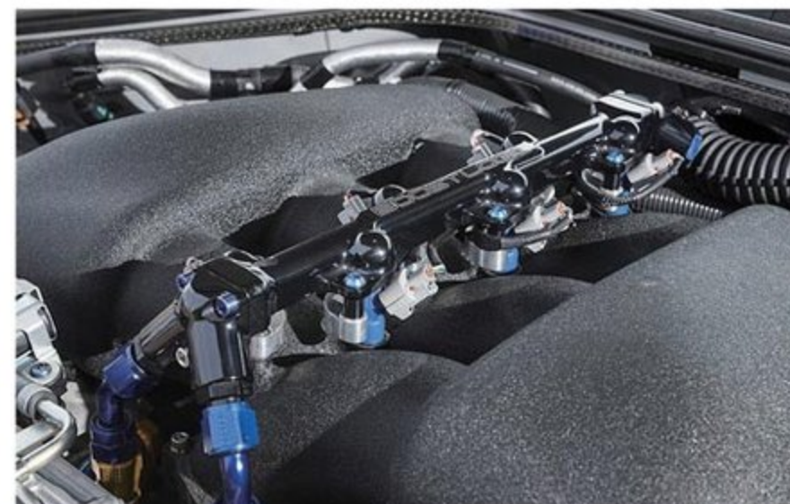
ブラックの結晶塗装が精悍なアメリカのブーストロジック社製サージタンクには、570ccのインジェクターを6本追加。ECUTEKを用いた独自のリセッティングにより、トップエンドはもちろんアイドリングや始動性といった実用域での安定性もクリア。
