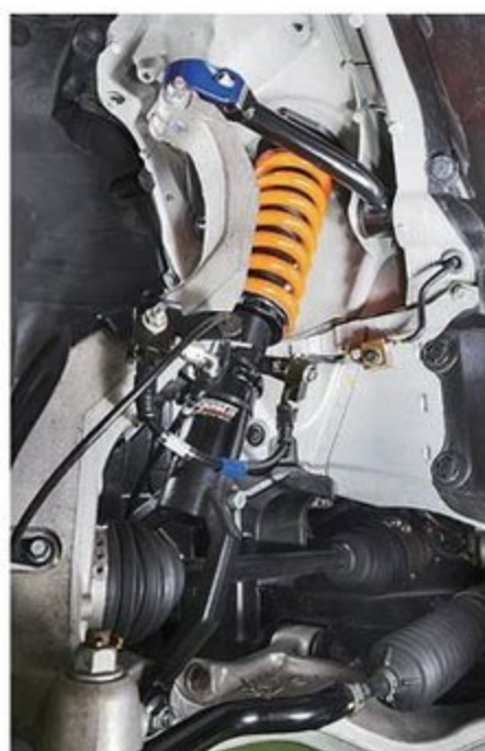
ロールやノーズダイブを抑制する3Gセンサーを内蔵した、ウエストスポーツオリジナルのセミアクティブアラゴスタ車高調。純正スイッチでの減衰力調整が可能という点もユーザーサイドに立った配慮といえる。
