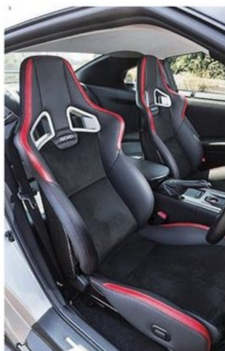
シートは軽量&高剛性を誇るカーボンシェルを持つレカロシリーズの最高峰、SP-Xアバント。バックシェルがカーボンもインテリアのアクセントになっている。これもカーボン好きな亀谷代表流のセレクト。
