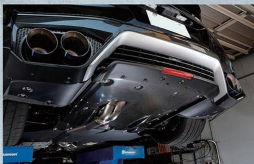
フェニックスパワーの2017モデルは、従来モデルで開発された各種パーツの適合確認とブーストアップ仕様のデータ取りをするため、排気系にトラストのフロントパイプと、RH9のチタンマフラーが装着された状態だ。
