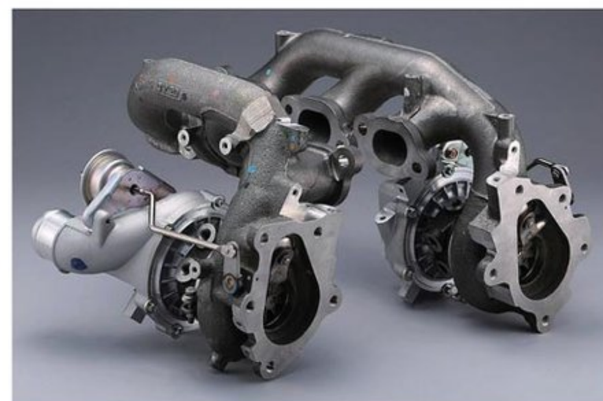
マニホールドごとボン付け交換可能なウエストスポーツのVN7.5ハイスベックタービン。高回転領域での頭打ちを解消し、シャープなレスポンスを実現する。サイズはNISMO-GT3タービンよりひとまわり大きく、ブースト圧1.5kg/cm時に700psを発生。
