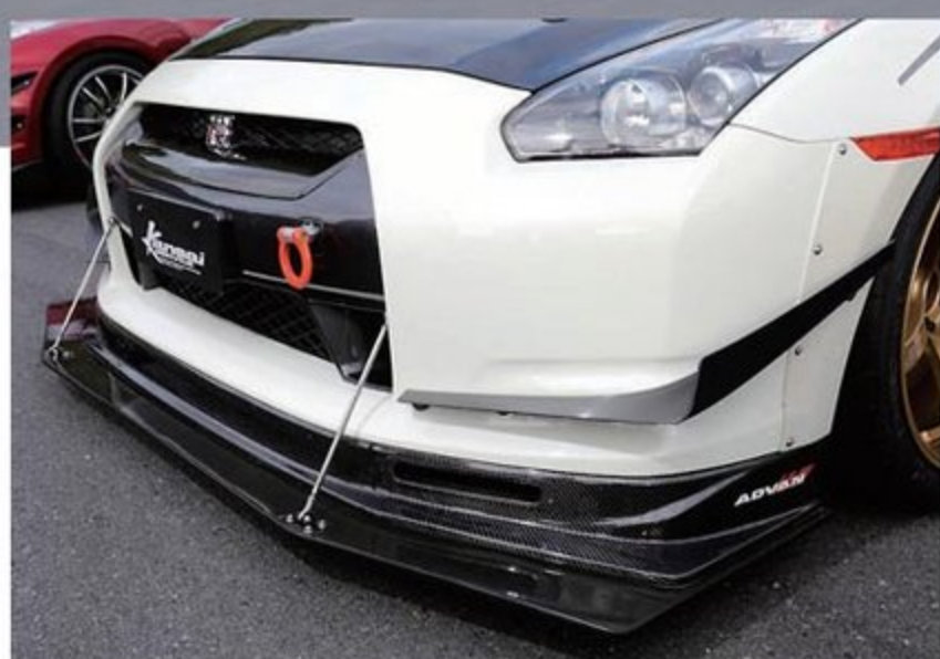
ダウンフォースの増加と同時に、ブレーキクーリングエアガイドとの併用で効果的にブレーキを冷却するブレーキダクトも装備したカーボンフロントリップタイプ2。その下に装着されるのは、試作のアンダーパネルだ。
