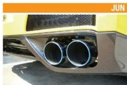
マフラーダクト
