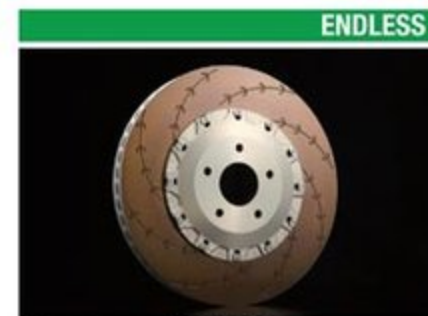
ENDLESS Racing E-SLIT 後期 前期 リア用のリブレイスローター。ローター一部の性能はフロント同様、ベルハウジングはジュラルミン製でインナードラムはスチール製。軽量化も果たしており、バネ下重量も軽くなる。 ■R 13万9000円(1枚) ■エンドレスアドバンス ☎0267-68-6888 材 特殊カーボン配合スチール SLIT 6本
