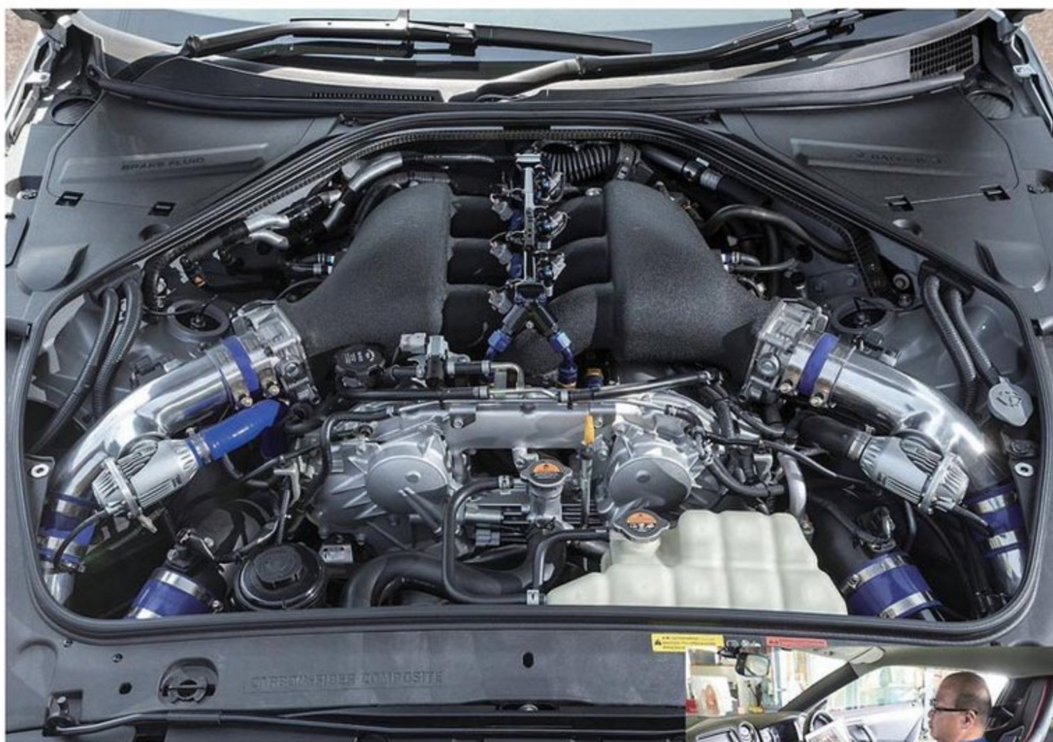
削り出しピストン&クランクシャフトなどで構成されるHKSの4.1ℓキットをベースに、ウエストスポーツ独自のリファインが施されたVR38エンジン。性能一辺倒でなくメタルキャタライザーを備えるなど、リーガルという点にも配慮を忘れない。
