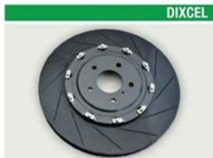
DIXCEL 2ピースローターアセンブリー 後期 前期 純正交換タイプで、追加加工が不要で取り付け可能。キャリパーも純正使用可能で車検対応。前期の380mm、後期の390mmともにラインアップする。ハブボルトがM12仕様の為、GT-R NISMO/M14ハブボルト換装車両は不可。 ■F 6万6000円(380φ) 7万3000円(390φ)/R 5万6000円(1枚) ■ディクセル ☎072-654-0121 材 ハイカーボンFC鋳鉄 SLIT 12本
