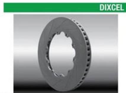
DIXCEL FS 後期 前期 FPタイプにスリット12本を追加したタイプで、スーパー耐久でも使用している同じ素材を採用。純正ローターはベルを再利用するタイプなのでコストを抑えたメンテナンスが可能。SPEC V/NCCB車は除く。 ■F 4万円~5万円/R 3万8000円(1枚) ■ディクセル ☎072-654-0121 材 ハイカーボンFC鋳鉄 SLIT 12本
