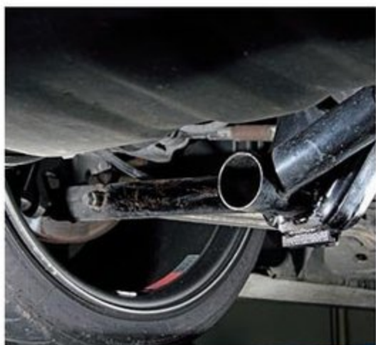
メンバーと同様にアーム類もワンオフで製作。ワイドボディによって広がったトレッドに合わせ、ロワアームは30mm延長してハブ位置をオフセット。ワイトレに頼らずにボディに合わせてトレッド幅を拡大している。
