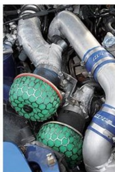
エンジンはFC輸出ローターを組み込んだハイコンプ仕様。ノーマルタービンの組み合わせ。インタークーラーとラジエーターは水平マウントで、純正位置に固定できるように専用ラジエーターを製作している。制御はパワーFCで、最高出力はブースト1.1kg/cm 2 で350psだ。
