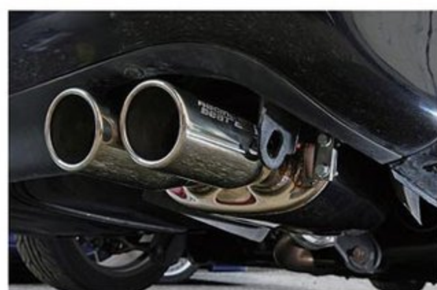
排気系はサードのスポーツ触媒に、アニバーサリーが国内代理店を務めているレーシングビートのデュアルチップエキゾーストの組み合わせとなっている。
