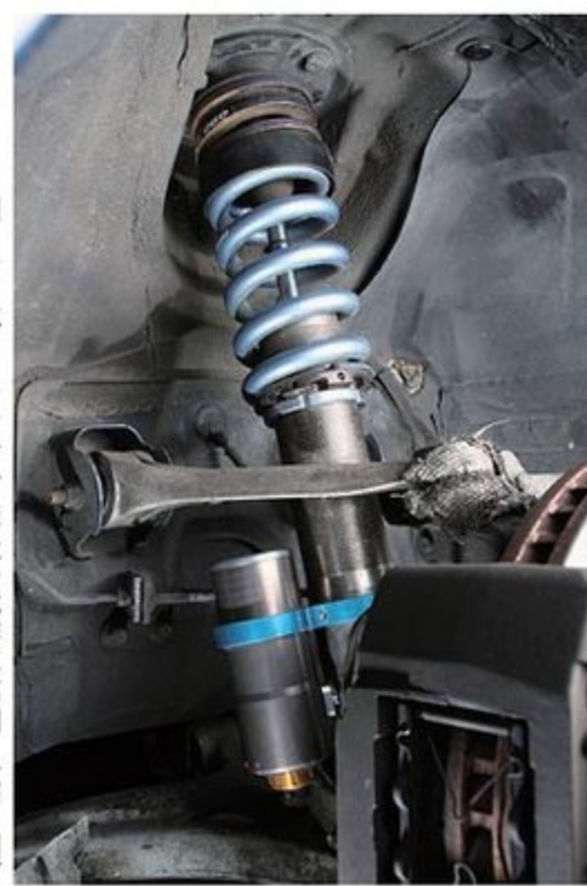
別タンク式ツインチューブ構造の試作車高調は、縮み側が低/中/高速、伸び側が低速、全域の縮み/伸びが調整できる5機構6ウェイ方式。スプリングはフロント28kg/mm、リア26kg/mmをセットする。
