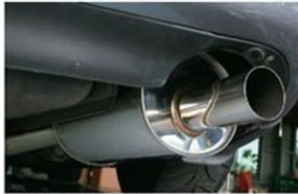
サイレントマフラー (ストレート構造)
