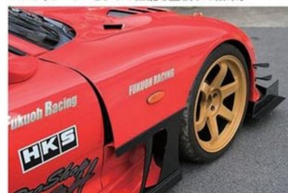
リヤの安定性を高めるためサイドステップにもアンダーパネルやカナードをセット。ひとつひとつのアイテムが効果を検証しながらワンオフされるため、毎年のステップアップにつながっているというわけだ。
