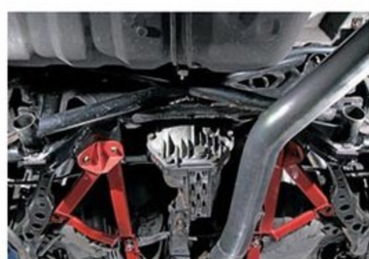
シャシーだけでなく足回りの作り込みも見どころのひとつ。リヤメンバーはアッパーアームの取り付け位置を上に移動させながら、剛性を確保する構造で一新。市販のフロア補強材も活用しさらに剛性を高めている。
