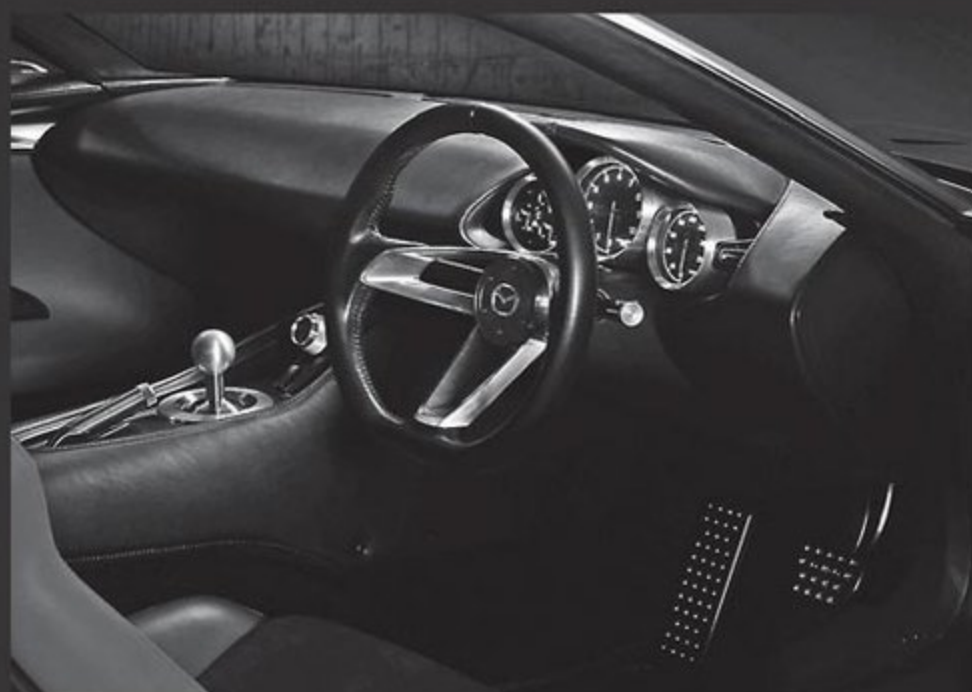
タコメーターは10000回転までカウント。足元はクラッチペダルのない2ペダルで、このクルマがコンベンショナルなMTではないことを示唆している。
