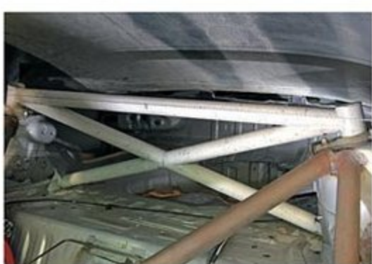
リヤハッチのウィンドウはカーボンパネルで埋められ軽量化を果たしている。フロントエンドやキャビン同様にパイプでストラット同士をつなぎながら、キャビンからのロールケージもがっちり溶接。シャシー全体を完璧に補強し、ボディ剛性を高めている。
