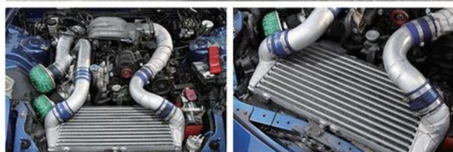
エンジンはFC輸出ローターを組み込んだハイコンプ仕様。ノーマルタービンの組み合わせ。インタークーラーとラジエーターは水平マウントで、純正位置に固定できるように専用ラジエーターを製作している。制御はパワーFCで、最高出力はブースト1.1kg/cm 2 で350psだ。
