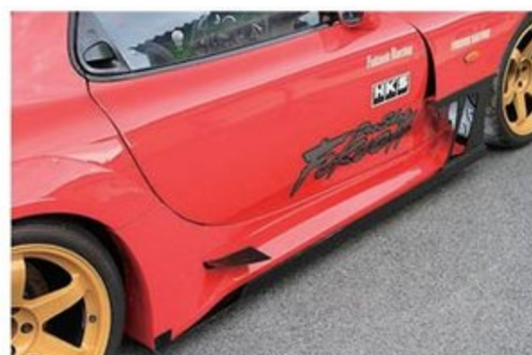
リヤの安定性を高めるためサイドステップにもアンダーパネルやカナードをセット。ひとつひとつのアイテムが効果を検証しながらワンオフされるため、毎年のステップアップにつながっているというわけだ。
