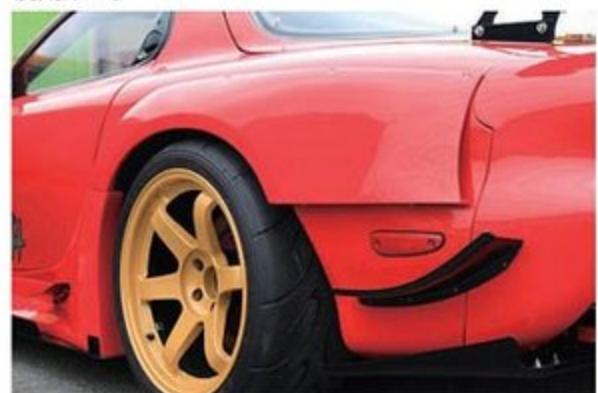
リヤの安定性を高めるためサイドステップにもアンダーパネルやカナードをセット。ひとつひとつのアイテムが効果を検証しながらワンオフされるため、毎年のステップアップにつながっているというわけだ。
