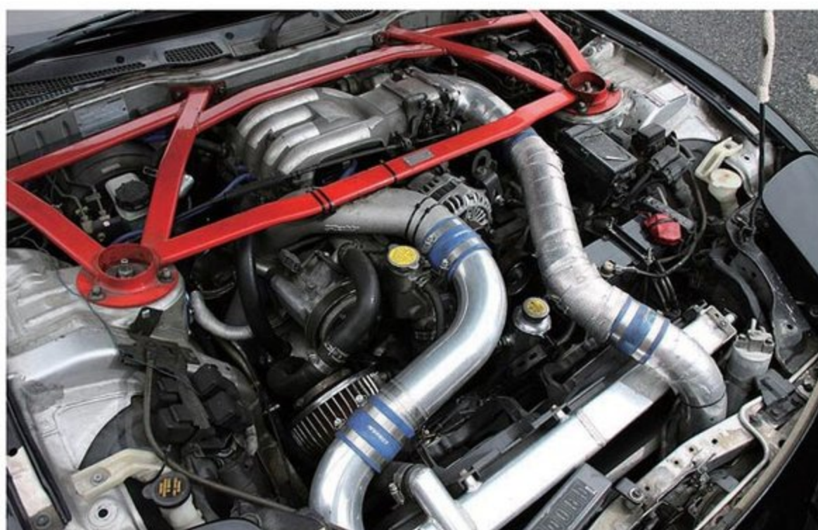
オートエキゼのタワーパーが目を引くエンジンルーム。ストリート仕様ポート加工が施されたオーバーホールされたエンジンに、T67タービンキットとVマウントインタークーラーを装着している。
