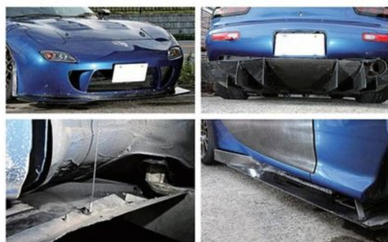
GTマシンのフロアダウンフォースを追求して製作したオリジナルフロントスポイラーとアンダーパネルであったが、その想定を超える効果とのバランスを試行覚悟の結果、サイドとリアもGTマシンようになってしまった。フロアパネルにはスチール製アングラー材をトラス形状で組んで前後メンバーをつないで剛性アップも図っている。
