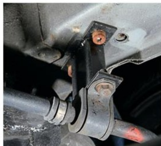
スタビライザーはノーマル状態でもバンザイしているため、新たに製作した足回りに合わせて、延長ブラケットにゲタを新設して角度を適正化。この効果もあって、スタビ本体はノーマルのままでも存在が体感できるほどになったという。
