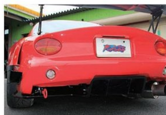
リアバンパーはRE雨宮製をハーフ加工。もちろん切りっぱなしではなく強度を持たせるために底面もしっかりと作り直される。さらにこのハーフバンパーに合わせてディフューザーも上げて装着する。
