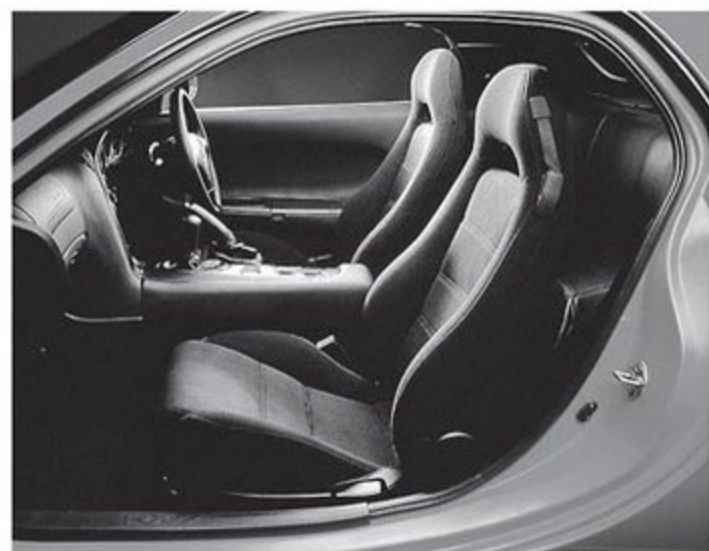
インテリアは細部が変更されたほか、助手席エアバッグの採用によりダッシュボード助手席前の形状が変更されている。
