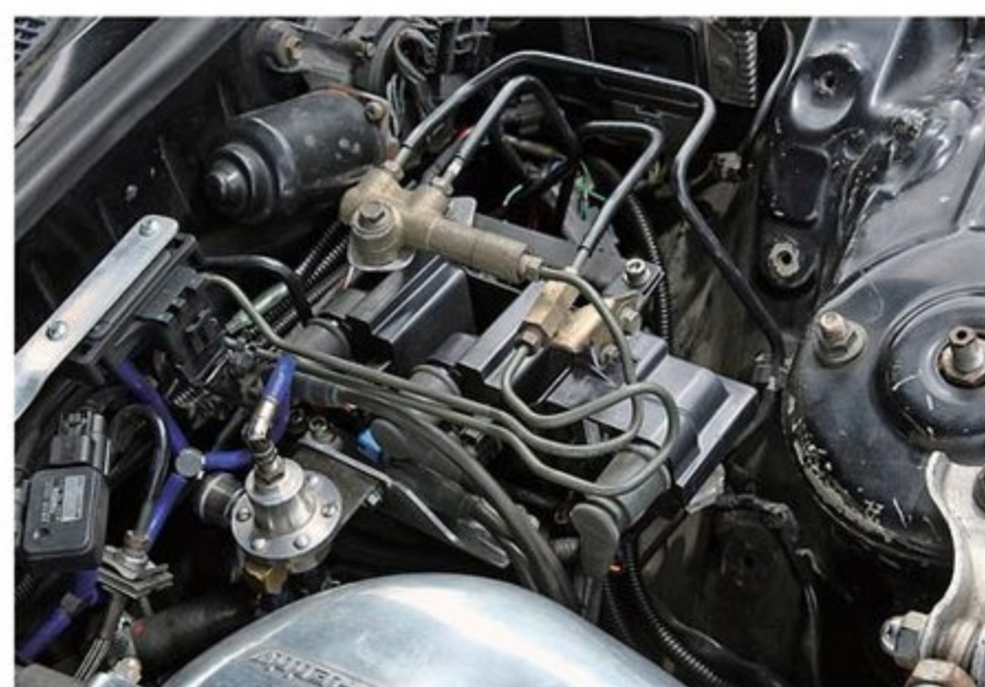
ABSを廃止し、空いたスペースに点火コイルを移設している。インマニ下のノーマル位置は熱の影響でトラブルを引き起こしやすいので、耐久性がアップするのだ。
