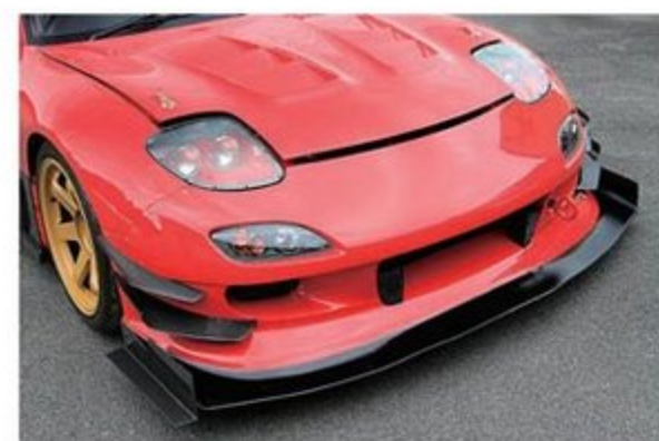
フロントバンパーをはじめ、強力なダウンフォースを生み出すアンダーパネルやカナードは、フクオーのオリジナル。同店ではこうしたFRP加工もお手のモノでワンオフ作業にも対応するため、ストリートカスタムのユーザーからも高い支持を得ている。
