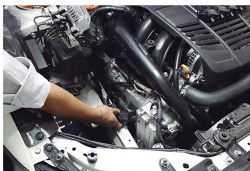
FA20DITやEJ20の場合、左側にエアインテークがあるのでボックスごと取り外して交換を行なう
