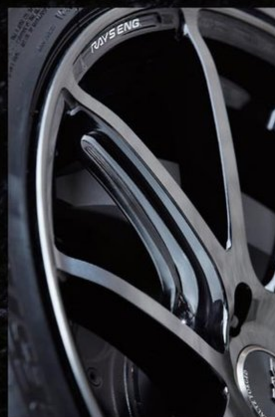
スポーク剛性をあげるために、奥行きを厚みを増した。さらにスポーク側面は肉抜きされ、軽量化と高剛性を両立している
