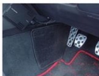
フットレスト周辺のカーペットを保護。マットとすることで、万一の事故の際の安全性にも配慮している
