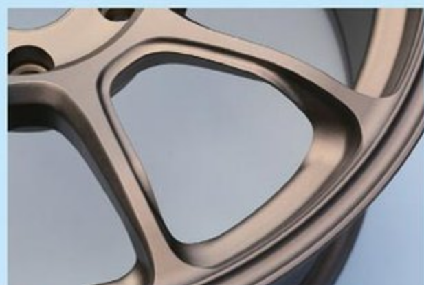
スポークの内側の必要な部分にはリブを立てることで剛性を確保。これも緻密な強度解析により導き出した形状となっている
