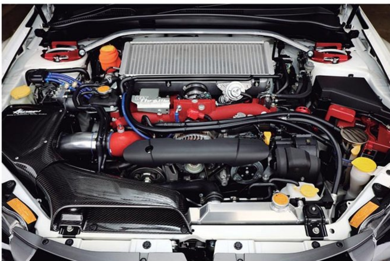
ブーストアップ仕様で最高出力は330ps。数値よりもドライバーのアクセルワークに対応する緻密なセッティングがキモ
