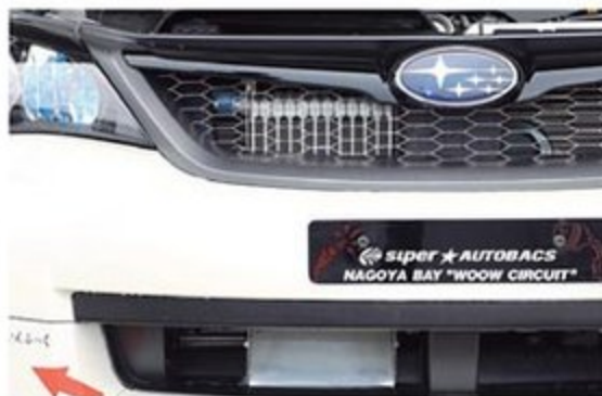
ラジエーターはDRL製でクーラントはケミテックを使用している。この組み合わせは来店客のオーナーカーにも勧めている王道チューン
