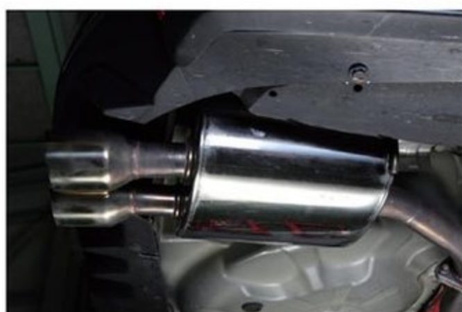
排気効率だけでなく静粛性にも配慮したオーバル形状のリアサイレンサーは上方へとオフセットし、輪止めとの干渉やルックス面へと配慮した
