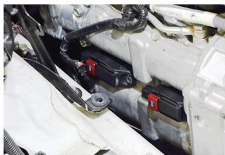
FA20DITやEJ20の場合、左側にエアインテークがあるのでボックスごと取り外して交換を行なう
