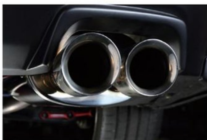
90φデュアルのカールテールがアダルトスポーティなリアビューを演出。搭載予定のスライド機構、バンパー焼けを防止する二重管構造もありがたい
