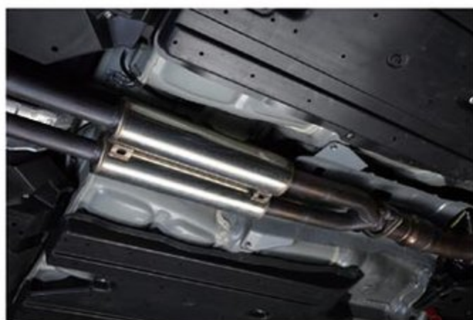
フロントパイプ直後で50φデュアルに振り分け、トルク特性も考慮してセットした89.1φのサブサイレンサーへと導く。内部はパンチングストレート構造だ
