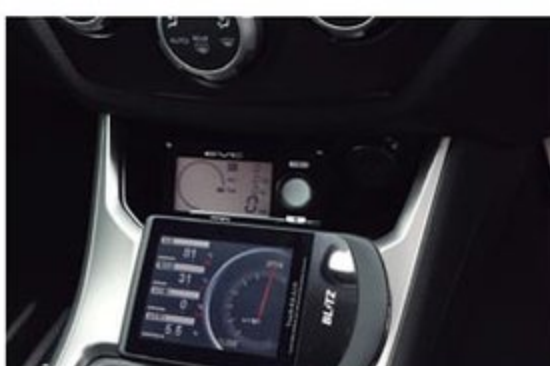
ブーストの制御もノウハウが必要な部分になる。トルクカーブに合わせてブーストが立ち上がっていくように設定している
