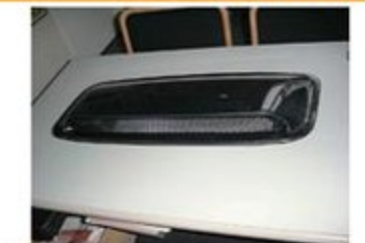
ボンネットエアダクト
