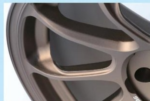
スポークサイドを見ると軽量化のために肉抜きを行なっているところと、行なっていない箇所がある。この見極めこそがレイズの技術
