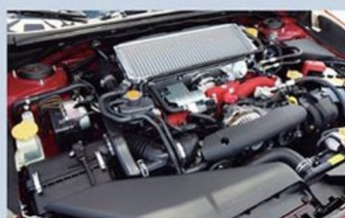
エンジンはデュアルAVCSを装備したEJ25ターボを搭載している。高回転型のエンジンではないが、トルク特性に優れる
