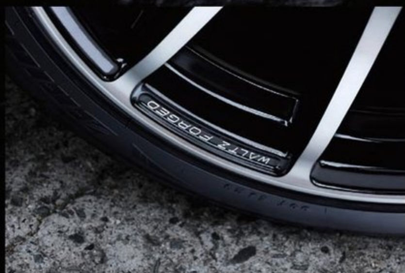
バランスよく配置された3か所のロゴは、マシニングでリムを肉抜きしたうえに、文字を彫り込み質感をあげている
