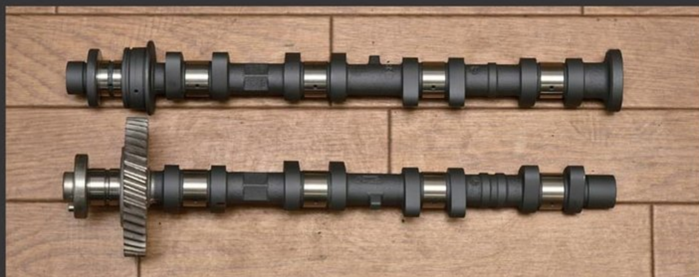
200psまで対応するカムシャフト（272°）は2本で12万6000円。イギリスの専門メーカーへ石川代表みずからプロフィールを伝え発注している。直打式のデメリットとしてバルブリフトを大きくとれない構造があるが、そのなかでも最適なオーバーラップ量を求めた
