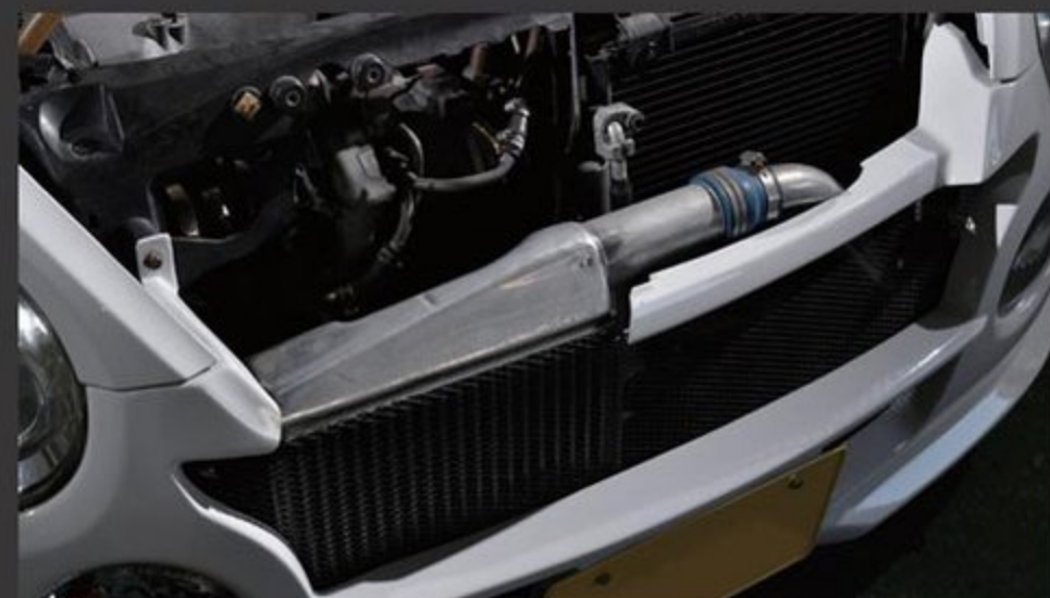
ただでさえスペース難のエンジンルームにFC3S用インタークーラーをおさめるという前代未 聞のモディファイにも、エアロは小加工で対応できた
