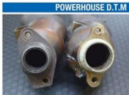
POWERHOUSE D.T.M. 触媒ハイフロー加工
