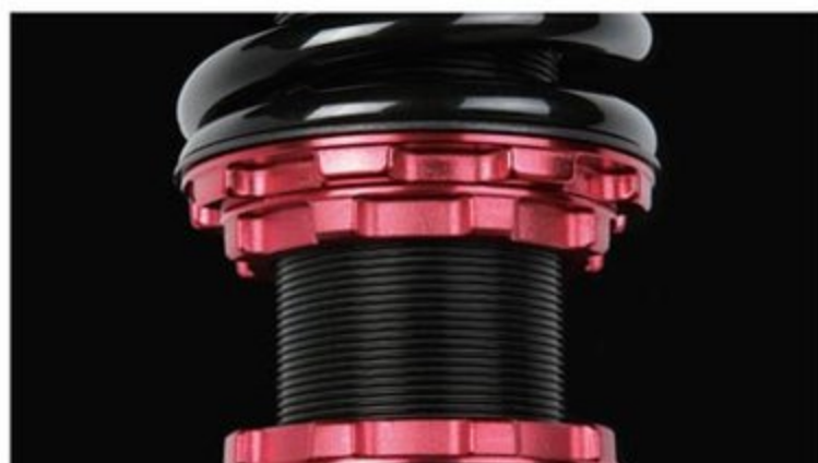
全長調整を行うためのロックシートは軽量なアルミ製を使用。アルミトレッドのカラーが所有欲をくすぐる
