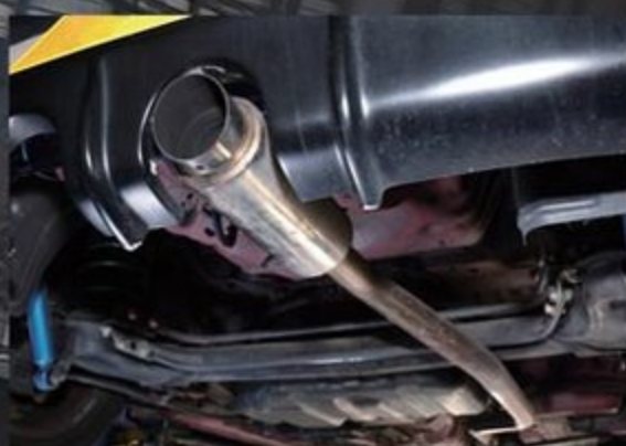
シングル出しマフラーは、江黒代表自らがハンドメイドするもので、直線的なレイアウトとパイプ径により適度な排気抵抗を実現。リアサイレンサーのみでジェントルなサウンドを実現している
