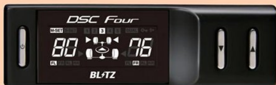
4輪独立制御をする場合の画面表示の例。前後左右それぞれにセッティングが可能で、サーキット走行などで便利な機能だ
