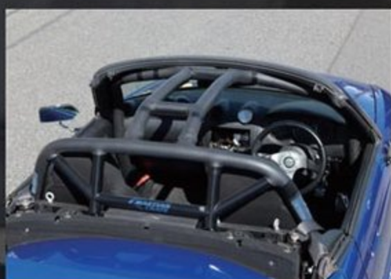
オリジナルの6点式ロールケージは、頭上のバーを中央に寄せることでヘッドクリアランスを確保。オープン時の爽快感を失わずヘルメットと干渉しない作りは、K4GPに参戦し続けているマーシャングレートならではの
