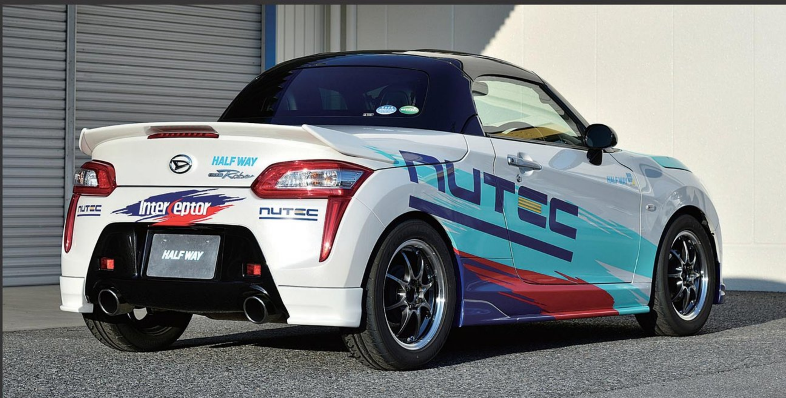
マフラーも市販を前提としたプロトタイプ。駆動トルクが喰われるのを嫌いあての15インチを選択
