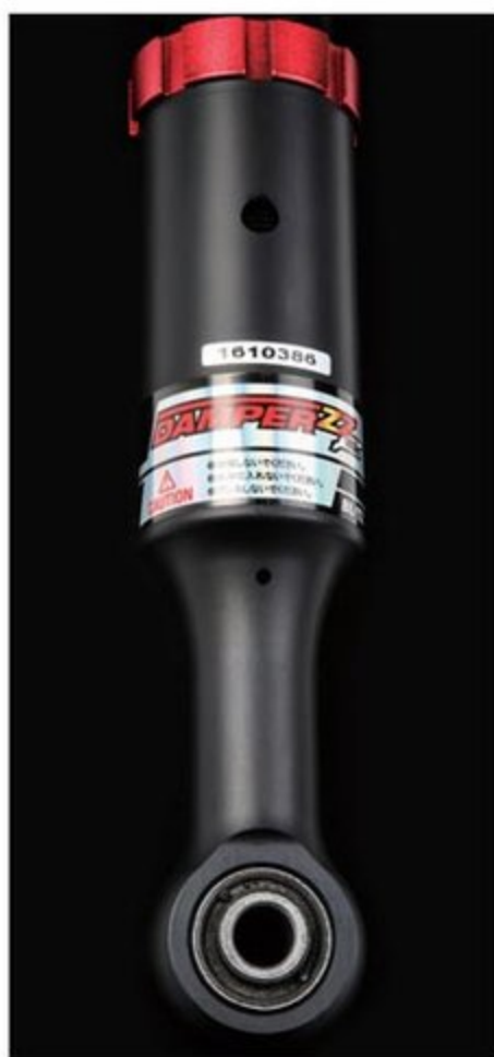
リア用ショックアブソーバーのブラケット部分もアルミ製を採用。可能な限りの軽量化もハイスpekの証だ
