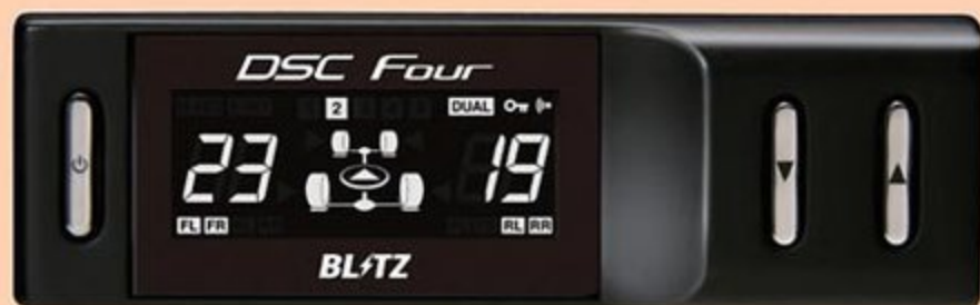
コントローラーの表示画面。これは左右の車高調を同時制御する場合の例。フロントとリアで別々の減衰力設定ができる
