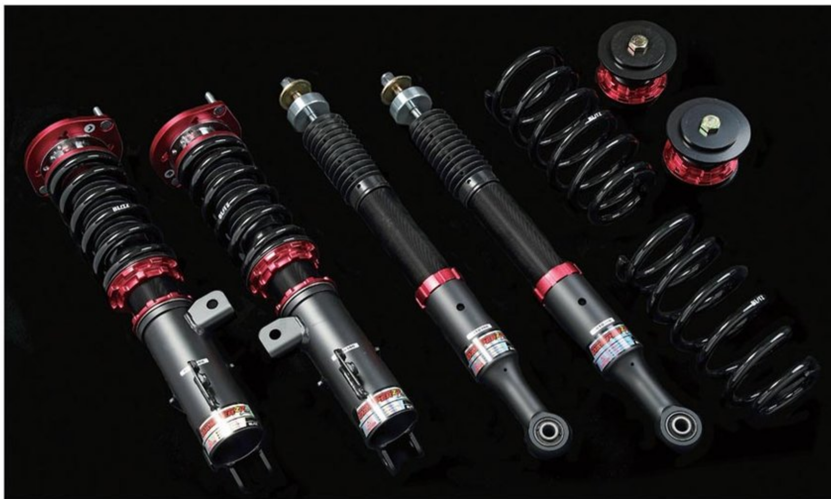
左2本のコイルオーバーがフロント用、右2本のショックアブソーバーと別体式スプリング、スプリングアジャスターがリア用だ。前後共に全長調整と32段階の減衰力調整が可能。ショックアブソーバーは単筒式で、内部のオイル容量を多くできるため、放熱効果が高く耐久性に優れるなどの利点がある
