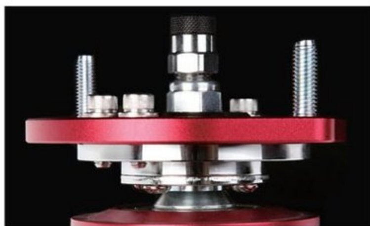
フロント用アップマウントのジョイント部はピロボール式。よりダイレクトなハンドリングを楽しめる本格仕様だ
