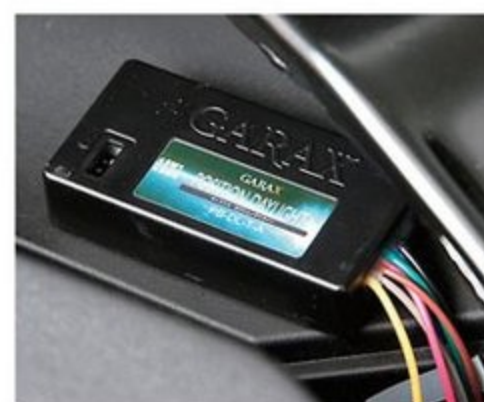
ポジションランプをデイトイムポジションに切り替えるユニット。発光状態を常時点灯やイベントモードとしての点滅モードやぼた点滅など、発光状態も選べる。
