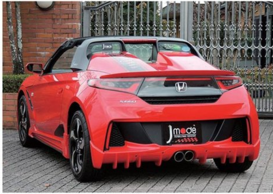
センター出しマフラーに対応したスクーデリア。マフラー周辺部は別体パーツになっている。装着は純正のクリップを使用。
