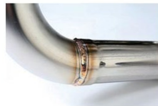
ビードが美しいTIG溶接。カキモトレーシングが 誇る熟練の職人によって施される匠の技が堪 能できる。量より質をとる精神が強く現れるボイ ント。
