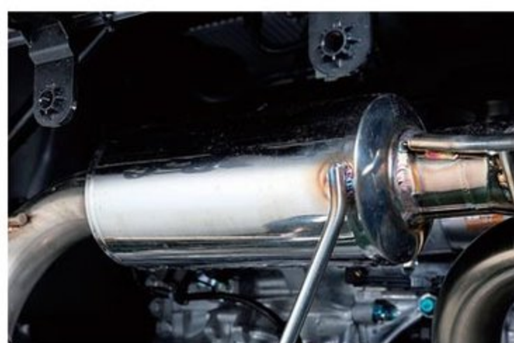
小排気量3気筒特有の排気音を小気味いいエキゾースサウンドにチューニング。納得の音質が得られるまでサイレンサーの内部構造は何度も何度も作り変えられた。
