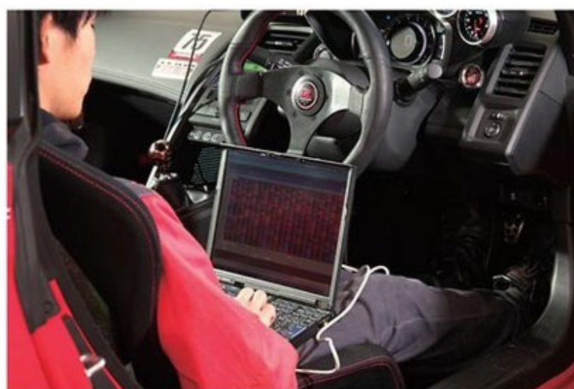
現在、人気爆発中なのがECUチューン。レギュラー仕様のままドライバビリティを向上させたVer.1と、ハイオク仕様でブーストを1.2kg/cmまであげるVer.2がある。
