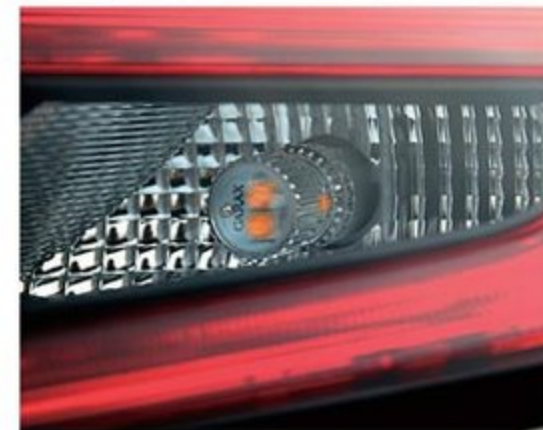
ポジションランプをデイトイムポジションに切り替えるユニット。発光状態を常時点灯やイベントモードとしての点滅モードやぼた点滅など、発光状態も選べる。
