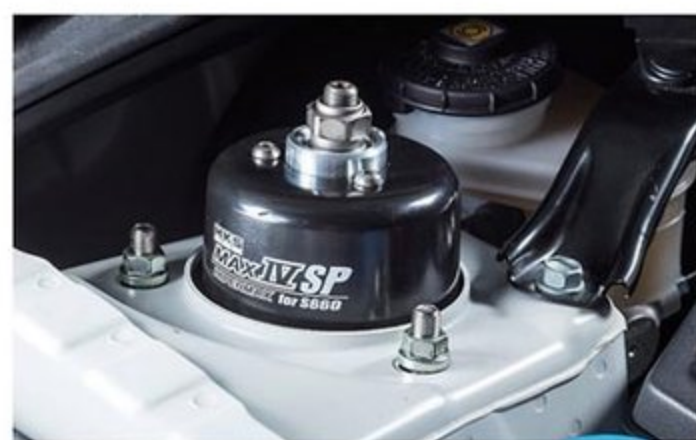
できるだけストロークを確保するためにデザインされたアッパーマウント。タイヤの接地面を有効に使うため、余計なキャンバーはつけないというのがカンサイサービスのセットアップなのだ。
