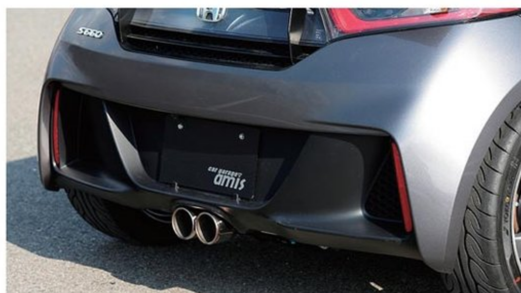
センター出しデュアルデザインを採用。ノーマルバンパーフットングで設計されており、純正とのトレードインでスッキリ収まる。
