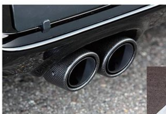
パイプ径50φのセンター出し・ドライカーボンテールマフラー。1万3920円(Highステン/STDステンは12万5280円)。テール部はドライカーボン以外にもステンとチタンタイプもある。
