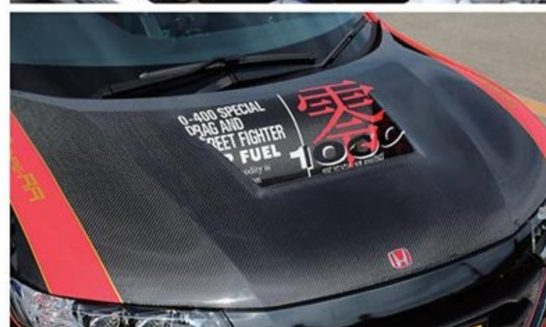
オリジナルの大容量ラジエーターでクーリング性能を強化。さらにその性能を最大限活用するため、アウトレットダクト付きのボンネットを装着している。
