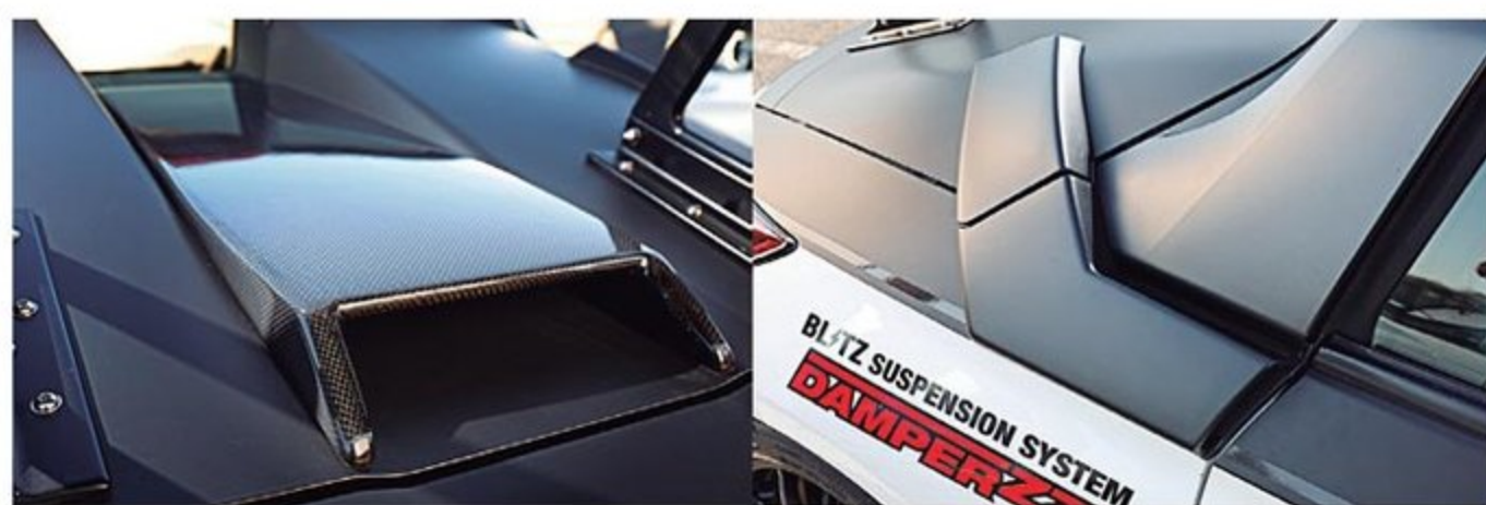
フレッシュエアを効果的に導くエアインテークダクト(右)や、エンジンルームの熱気を積極的に排出するカーボンエンジンフードカバー(左)も用意。フードカバーの装着により雨水の浸入を防ぐ効果も期待できる
