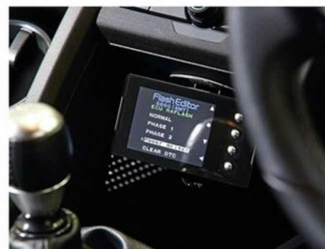
ECUセッティングにはフラッシュエディターを使用。レギュラー仕様のHKSデータ(フェイズ2)に対し、可変バルタイや電子スロットルなど書き換え項目は多岐に渡る。
