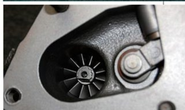
S660のノーマルとオリジナルハイフロータービンの比較。コンプレッサーハウジングとエキゾーストハウジングのポートを拡大し、コンプレッサーホイールとタービンホイールの径を拡大している(比較写真は左がノーマル、右がハイフロー)。
