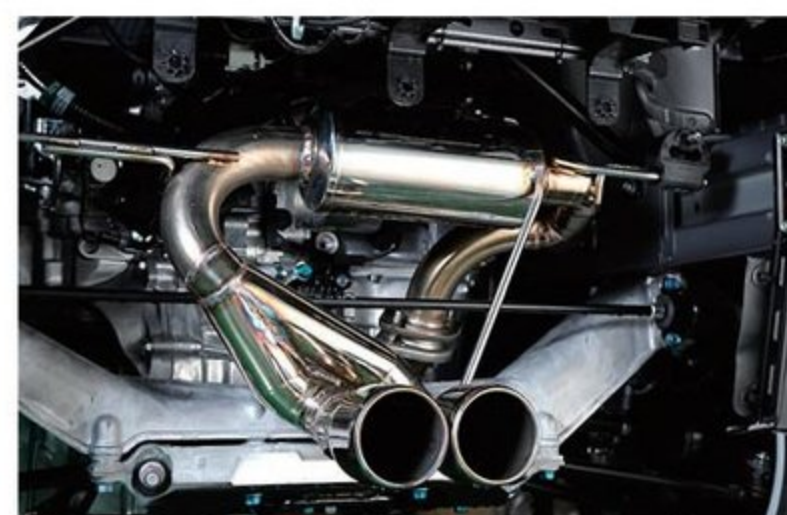
S660のルックスにふさわしい躍動感のあるサウンドを奏でるアミスのセンター出しマフラー（7万5000円/税別）。素材はオールステンレスだ。
