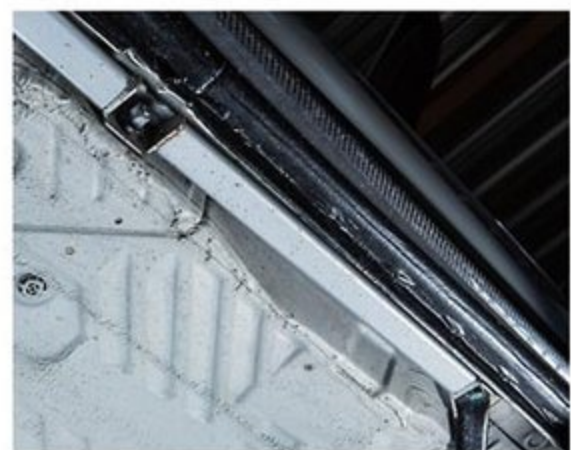
ボディ補強パーツは前後の剛性不足を補うため、リヤにもオリジナルタワーバー(2万5000円)を設定。また、S660のシャシー強化のキモとなるフロアプレスバー(3万5000円)はハンドリング&トラクションアップに大きく貢献する。
