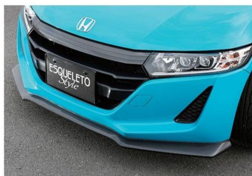
純正バンパーの下側に付けるアンダースポイラー。純正のラインに沿ってセンター部分はちょっと持ち上がるようなデザインとなっている。
