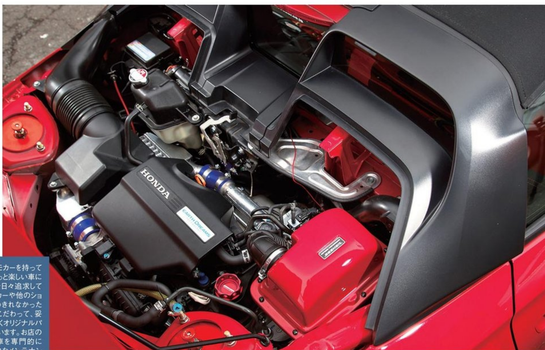
エンジンルームには、サイドの開閉部からエアクリナーボックスまでダクトで導風するエアインテークシステムや、開発中の大容量インタークーラーなどを装着。
