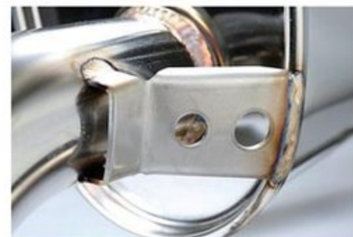
振動によるダメージを防止する補強を要所に配 置。耐久性にも抜かりがない。補強プレートも中 抜き加工し、無駄な重量増を抑え込む。
