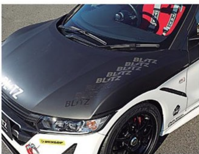
FRP製エアロボンネットはワイド感を強調するデザイン。F/S/RアンダースポイラーはカーボンとFRPを設定。カーボンGTウイングは車検対応とSPLの2タイプだ。
