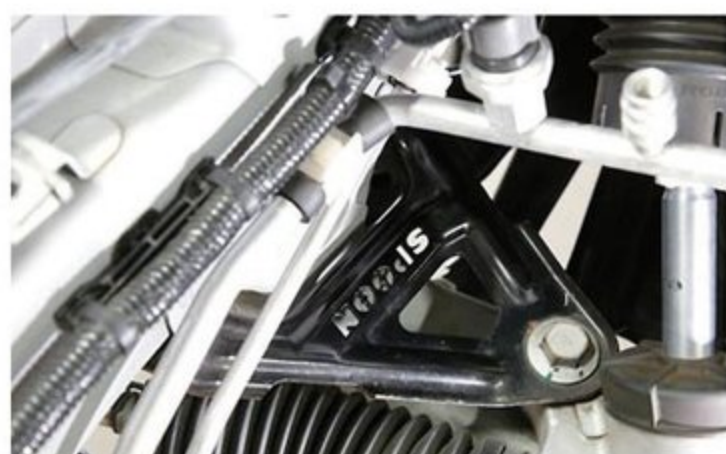
通常は4本以上のボルトでボディに固定されているステアリングラックだが、S660は2本止めで剛性不足。ステアリングスティッフプレート(3万2000円)の装着で、接地感や操縦安定性が向上する。
