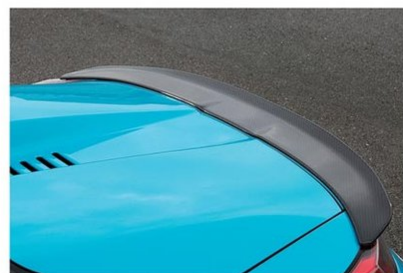
ダックテールタイプのリヤスポイラーはボディまで回り込むような形状になっているのが特徴的。高速走行時の安定性向上も期待できる。
