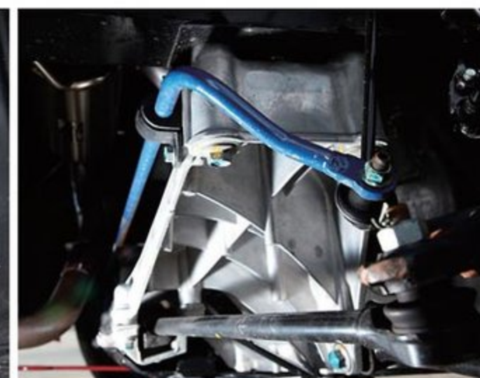
ダンパー&スプリングに加え、前後スタビも強化。シャープなハンドリングを実現するためにひと役買っている部分だ。
