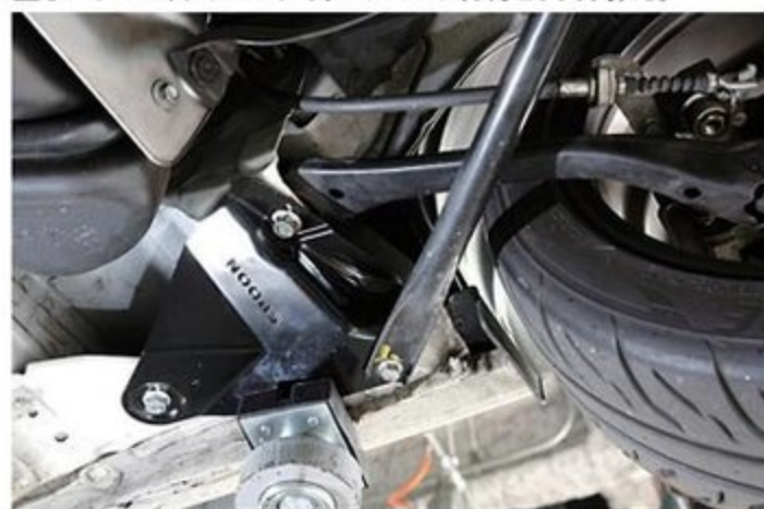
ノーマルでも十分な剛性をもつリヤサスまわりだが、トレーリングアーム取り付け部の剛性アップでトラクション性能と乗り心地を向上させるのが、リヤのスティッフプレート(3万2000円)だ。
