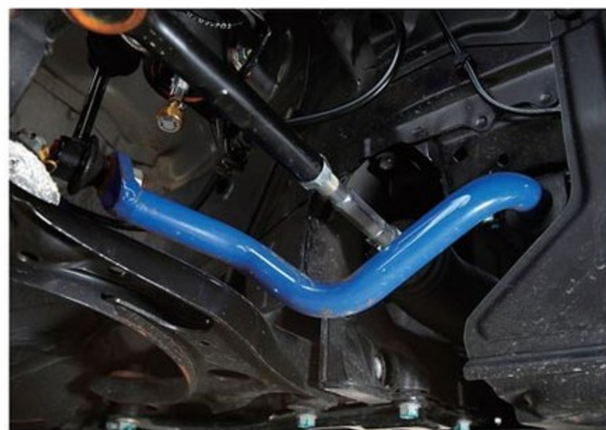
ダンパー&スプリングに加え、前後スタビも強化。シャープなハンドリングを実現するためにひと役買っている部分だ。
