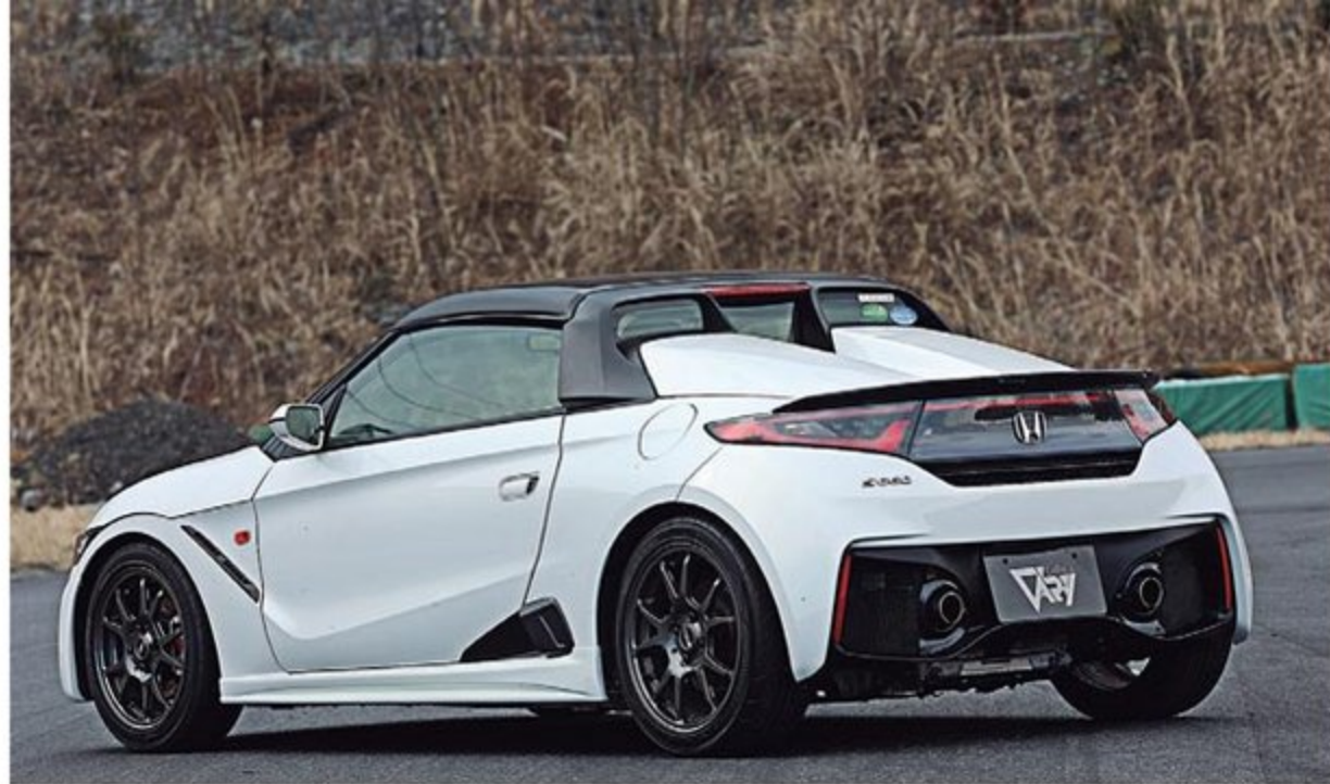
吸排気やコンピュータまで手が加えられるガレージ・ベリーのS660。オリジナルディフューザーにマッチした専用マフラー（8万2000円）は排気効率を考慮したレイアウト。別売りのマフラー用パネル（1万8000円）もラインアップに加わる。
