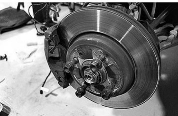
フロントのブレーキローターは見ただけで、摩耗しているのがわかる。
