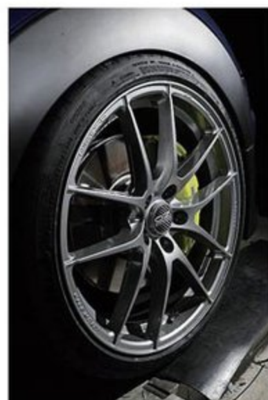
絶妙なツライチぶりで収められたホイールはOZレーシングの18インチ。イエローに彩られたブレーキキャリパーはJCW純正品を加工流用している。
