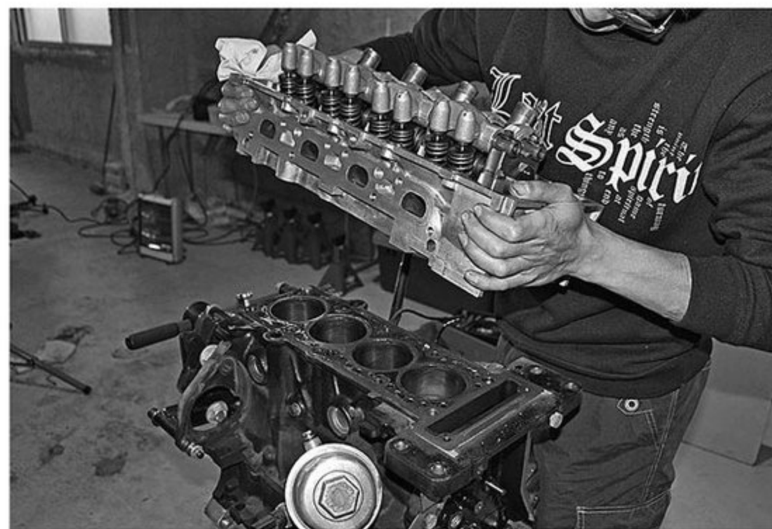
降ろしたエンジンからシリンダーヘッドを外す瞬間。走行15万キロともなれば、かなり重大なトラブルを抱えているかと思ったが、実際にはそうでもなかった。
