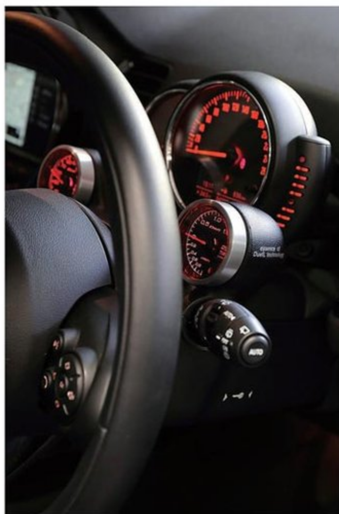
ステアリングコラムに違和感なく追加メーターを付けられるフードもデュエルAG製。視界を妨げないのもうれしい。追加メーターはデフィ製をチョイスした。
