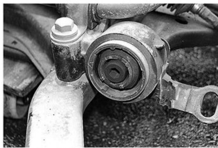
フロントサス・ブッシュの痛みは軽い。もしかすると、1度交換されているのかもしれない。
