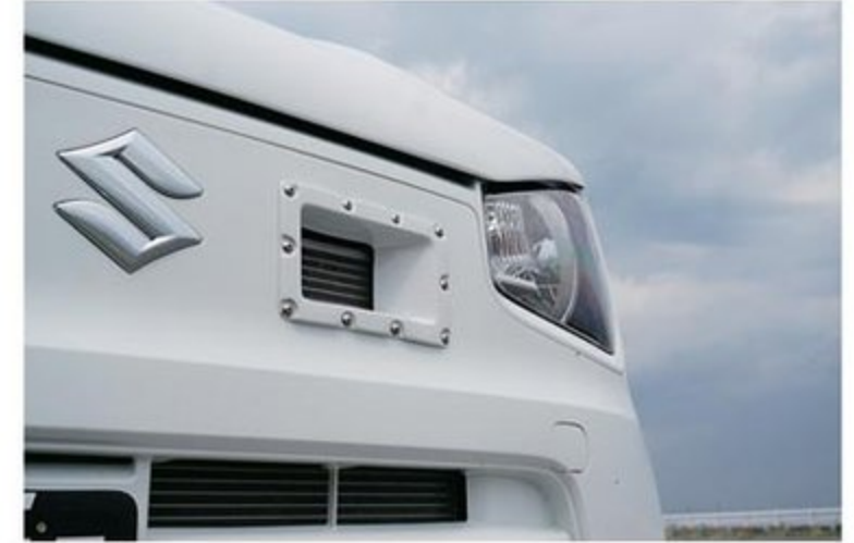
ビスどめで装着する「フロントエアダクト」。純正のダクトをカットして、そこに装着する。黒ゲルコート仕上げなので、カラーコーディネイトするのもO。開口部も拡大
