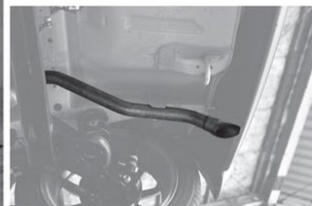
リアピースだけを気軽に交換することができない構造がネックだ
