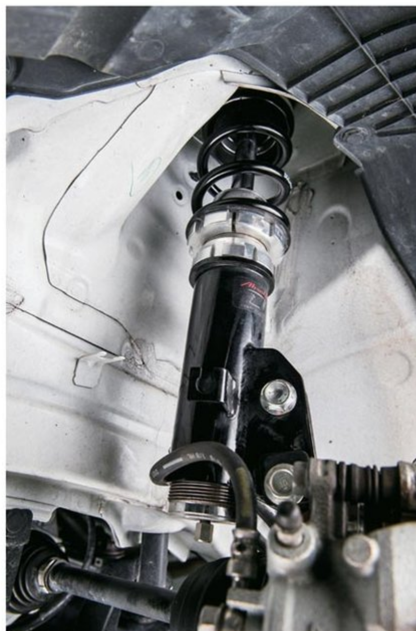
ベースとなるサスペンションは、ボルドワールド「アブソルートDSネクスト」。たとえ1mmでもよく動く足になるよう、リバンプ(伸び)側をどうセッティングしていくかが課題。8月下旬から岡山国際にて実走テストを開始する
