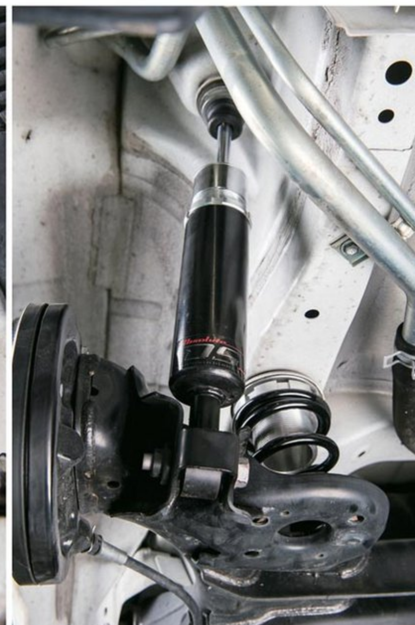
ベースとなるサスペンションは、ボルドワールド「アブソルートDSネクスト」。たとえ1mmでもよく動く足になるよう、リバンプ(伸び)側をどうセッティングしていくかが課題。8月下旬から岡山国際にて実走テストを開始する
