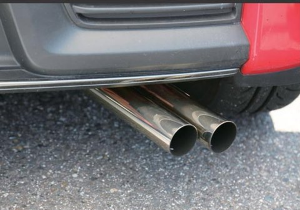
外向き2本出しエンドがスポーティなオリジナルマフラー（競技用）もセット。パイプ径50φの大径タイプの装着で、高回転まで一気に吹け上がるパワー特性を実現している
