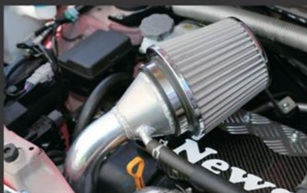
独自に開発したオリジナルの「RHF4ターボキット」には、大容量のエアクリーナー「エアブースター」もセットになっている
