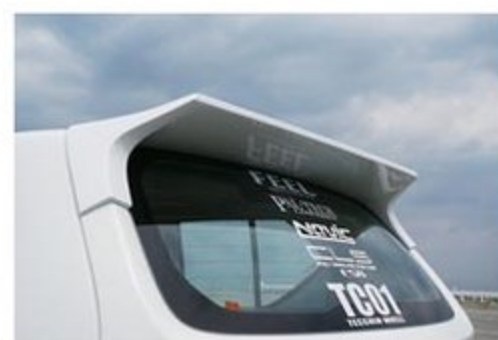
「昔のシビックを意識」(ESB 梶谷さん)したリアウイング。立体感のある形状と、後端に向かってせりあがっていく微妙な曲げがポイント。長めのデザインもレーシーだ
