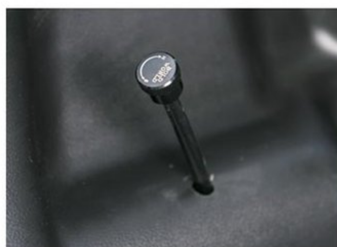
現状のパネレートはフロント8kgf/mm、リア6kgf/mm。減衰力は32段からスイートスポットを探っている段階だ
