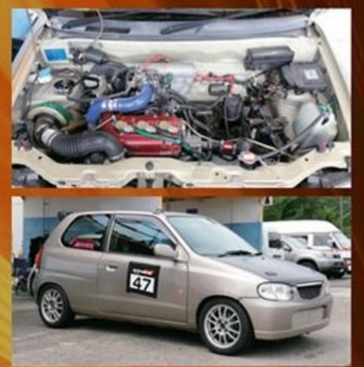
HA23Sにターボエンジンをスワップ。タービンはRHB31ハイフローを使い、この日のレースではオーバーオールを飾った。2位の金澤選手との接近バトルは迫力満点!
