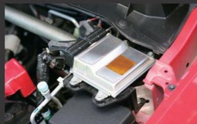
燃料調整などコンピュータのセッティングは、純正ECUのデータを書き換えて対応。リミッターカットやレブリミットのアップなども行っている
