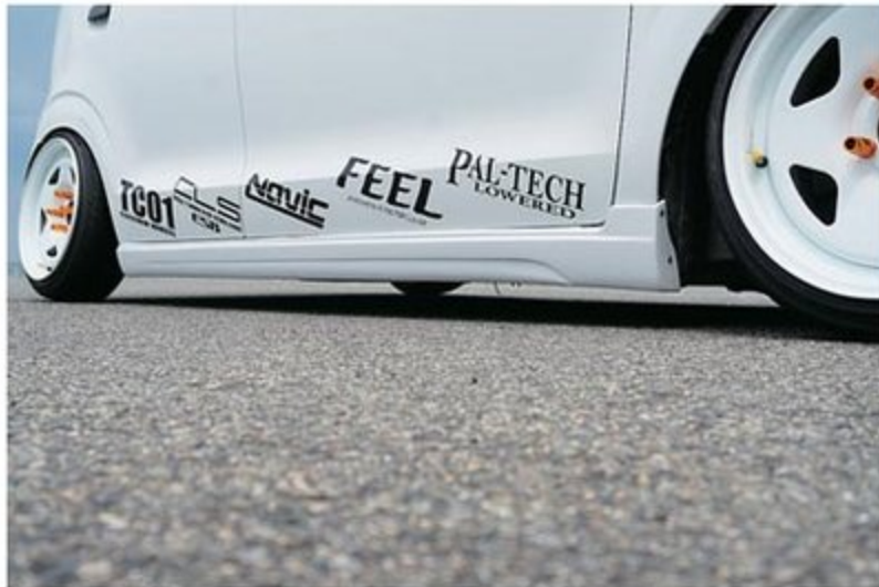
サイドステップはサイドシルの高さに合わせて製作。サイズを純正同等とすることで、ローダウン時の実用性に配慮している。スピード感を感じさせるデザインも秀逸
