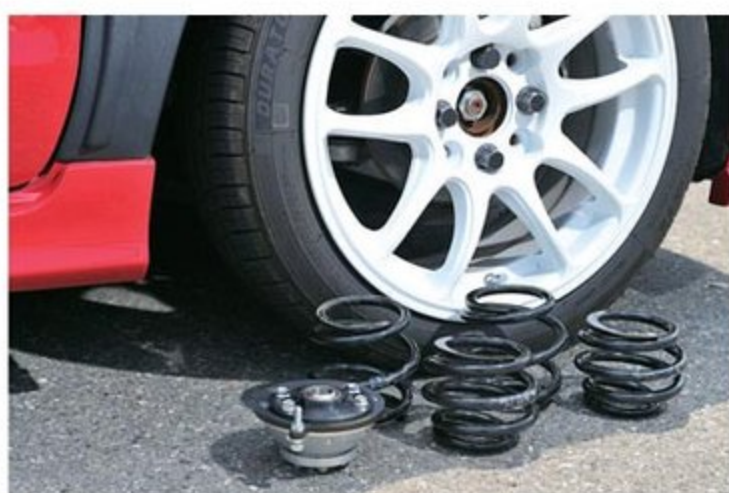
「スポーツベックダンパー」の他車用はリアスプリングの線間密着した部分をカットすることでも車高を調整できるが、HA36用は足まわりの構造上、一般的なアジャスタータイプとなる。レートを選択肢が多いのも大きな魅力
