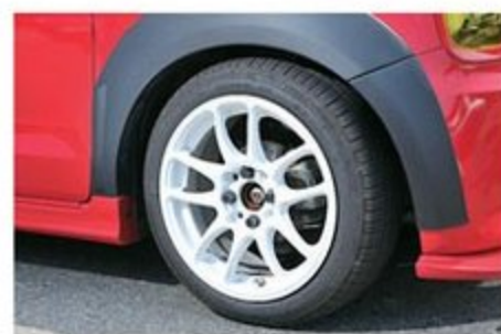
ホイールは「スタンスマジック #140」で前後15×6.5J。オーバーフェンダーなしでは履けないサイズだ。組み合わせるタイヤは「デュラター」の165/55-15
