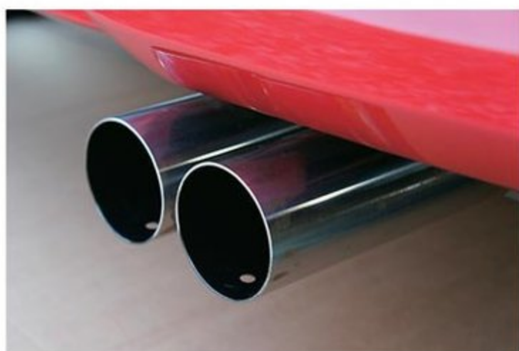
オーバーテックでは「デュアルサウンドマフラー」を設定。サイレンサーとテールエンドの強化ブッシュが付属し、N2の2WD専用で4万8000円だ。オールステンレス製
