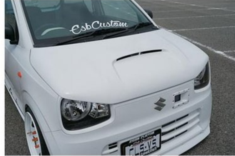
“バッドフェイス”に一変させてくれる「レーシングボンネット」。中央のインターダクトはエンジンルームへの走行風取り入れ口。FRP製でフロント部の軽量化にも貢献
