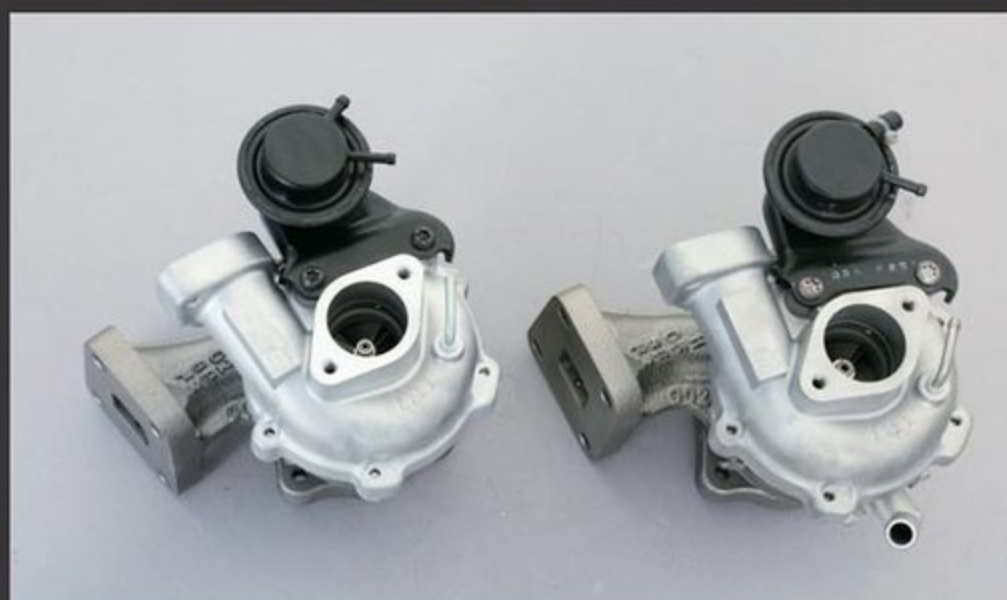
「GT1ターボチャージャー」。左は100psを実現するタービン4枚羽×2仕様（17万円）、右は110ps仕様の5枚羽×2仕様（19万円）
