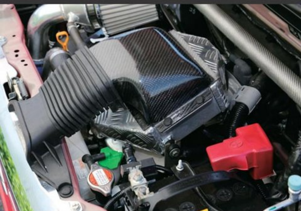
「GT1 インタークーラー&シュラウドセット」でクーリング対策も万全。写真はカーボン製シュラウドのセット（9万8000円）、FRPシュラウドのセットは8万8000円だ
