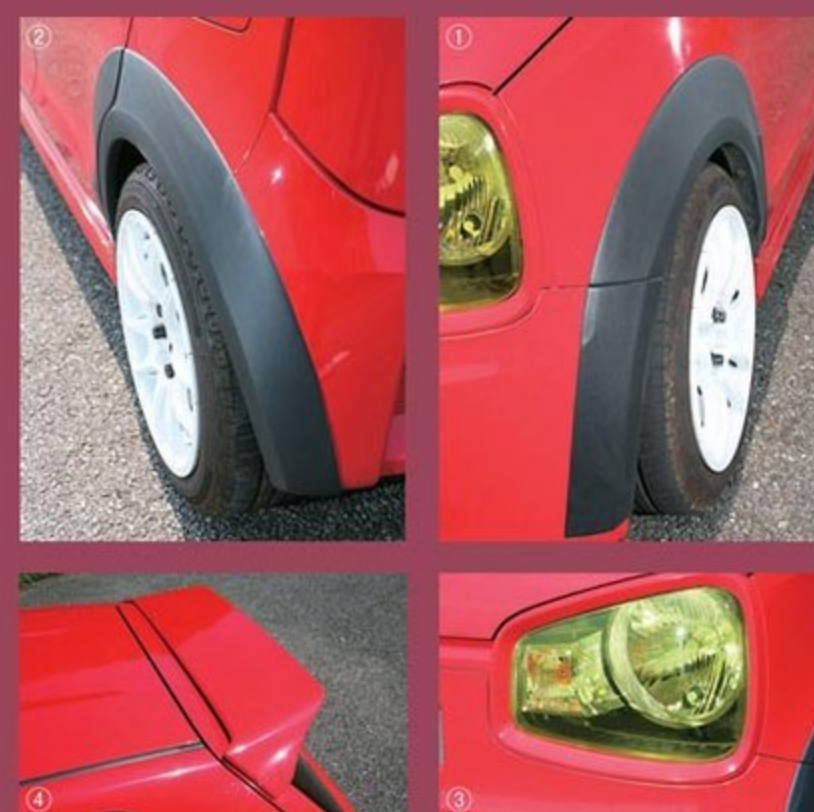
①「ノスタルジックフェンダー」は3万9800円で、NAモデルに装着する際は若干の加工が必要となる。②ワイドになる幅は片側9mm以内。ボディ同様に塗装するのもアリだ。③両面テープで貼り付けるだけの「GT300ヘッドライトカバー」は1万4000円。④かつてのN2レースを想起させる大型リヤウイング。固定は両面テープで4万2000円
